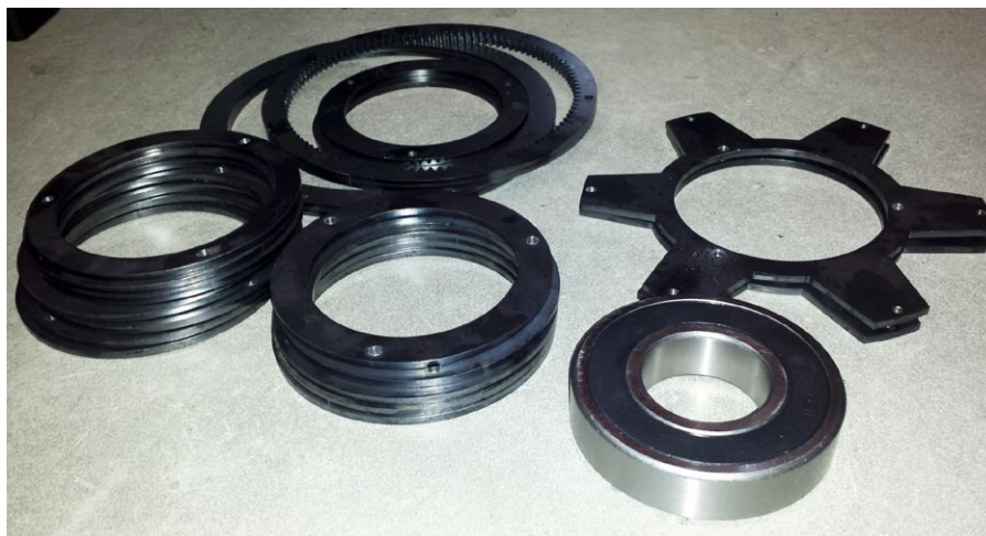
Die obere Trommelaufnahme mit zentralem Lager und Antriebszahnkranz
