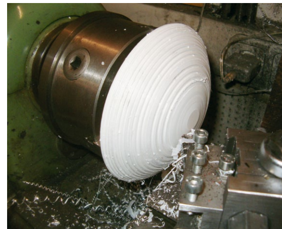
Der gedrehte Luftfilter, der sich am Brenner befindet, auf der Drehbank
