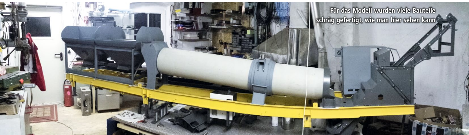
Die Trommel ist nun fertig zum Einbau. Hier ist das untere Lager mit dem zentralen Kugellager gut zu erkennen
