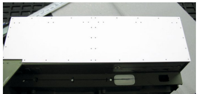
Die selbstgefertigte Bohrschablone für die Seitenwände
