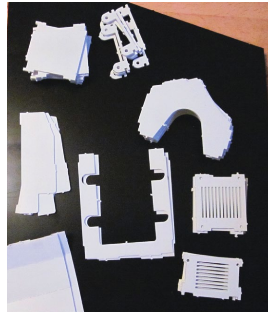
Für die Verkleidung der Trommellagerung wurden Teile aus Polystyrol gefräst
