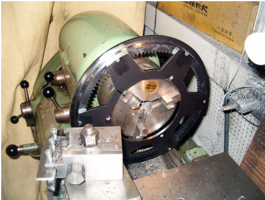
Das obere Trommellager auf der Drehbank. Hier ist nicht viel Platz zum Bett der Bank
