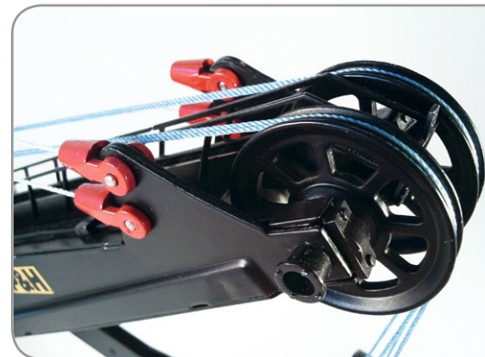
Umlenkrollen und andere bewegliche Teile sind aus Metall gefertigt
