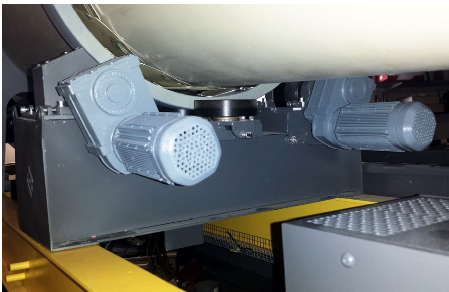
Die Getriebemotoren sind beim Original für die Drehung der Trommel verantwortlich
