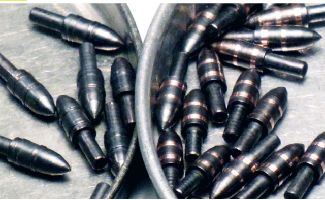
Abbildung 11: Für das Brünieren werden die Teile nicht allzu lange in das Bad gelegt
