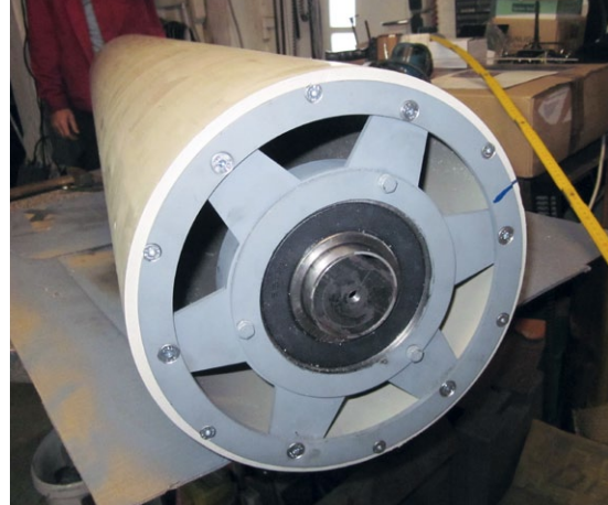
Die Trommel ist nun fertig zum Einbau. Hier ist das untere Lager mit dem zentralen Kugellager gut zu erkennen
