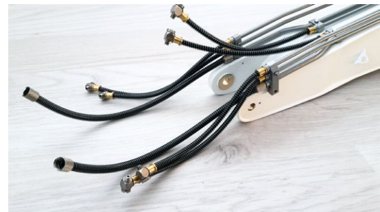
Die Hydraulikschläuche wurden mit Schutzfedern versehen
