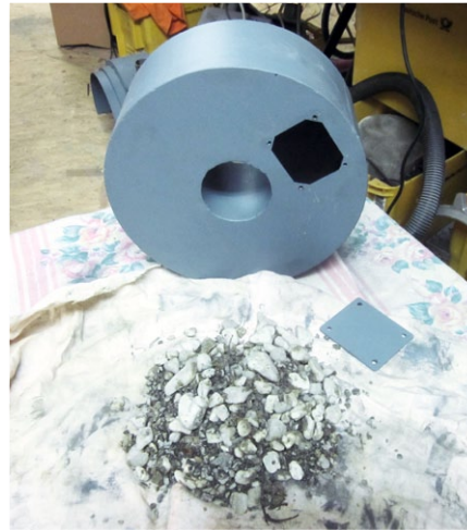
Das „Soundmodul“ für die Trommel: Eine runde Blechkiste, gefüllt mit Steinen und Sand
