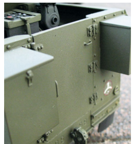
Die Scharnieren an der Hecktür und am Turmschutzschild wurden mit Hilfe von M1,4-Schrauben befestigt
