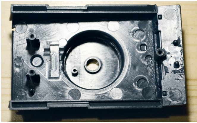
Die Oberwanne ohne Turm. Im angeformten Sockel saß zuvor der Schwenkantrieb
