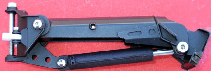
Der hintere Geräteträger, an dem die Fräse montiert wird
