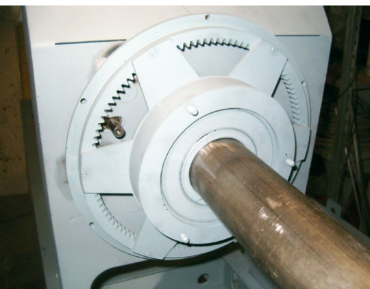
Die obere Trommelaufnahme mit zentralem Lager und Antriebszahnkranz
