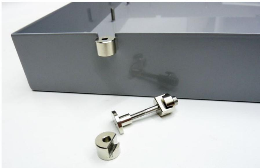
Von oben wird die Einschlaghalterung mit einem Gummihammer in den Schlitz der Wanne eingesetzt, um dann über den unteren Halter und die Schraube mit den Schlitz im Gehäuse der CNC-Maschine verbunden zu werden – simpel und schnell durchführbar
