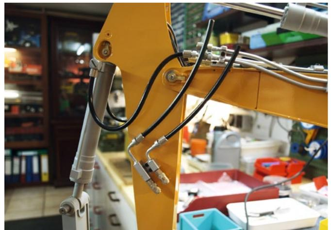
An die Schnellkupplungen werden die Zusatzgeräte angeschlossen
