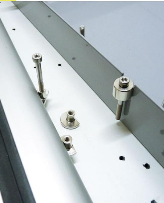
Das Befestigungsprinzip der Wasserwanne nutzt die seitlichen Rillen im Maschinenkorpus optimal aus, um eine solide Halterung zu ermöglichen. Wer zudem eine T-Nutenplatte verwendet, kann auch die schmaleren Stirnseiten arretieren
