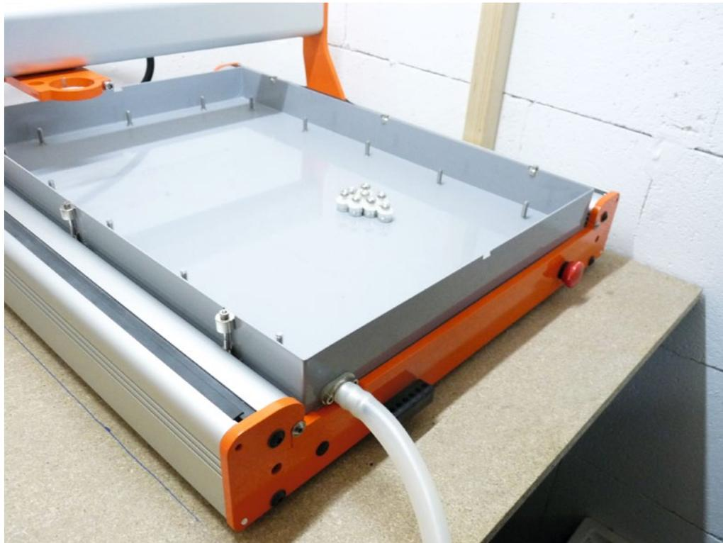
Der Abfluss oder besser der Absperrhahn sollte nicht zu weit entfernt vom Anschluss liegen, der beiliegende, etwa einen Meter lange Silikonschlauch kann aber problemlos an die Gegebenheiten angepasst werden
