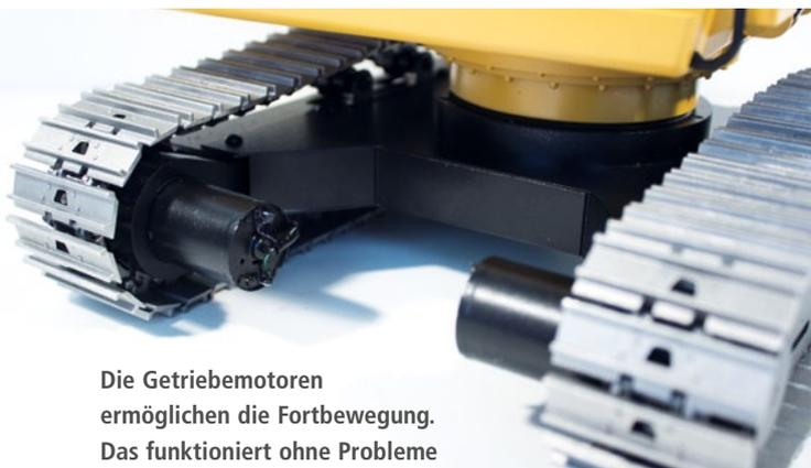
Die Getriebemotoren ermöglichen die Fortbewegung. Das funktioniert ohne Probleme
