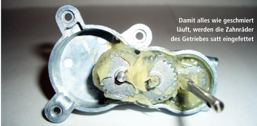
Damit alles wie geschmiert läuft, werden die Zahnräder des Getriebes satt eingefettet
