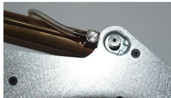
Am Hydraulikanschluss ragt das Blech des Stiels zu weit nach vorne
