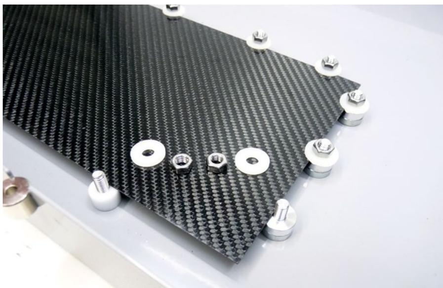
Durch die unterschiedlichen Nylonadapter und die beiliegenden Magnethalter kann eine Platte sowohl direkt auf dem Boden, mit dazwischenliegender Opferplatte oder komplett schwebend montiert werden
