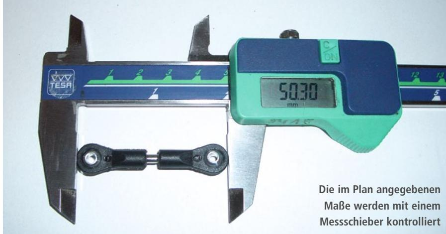
Die im Plan angegebenen Maße werden mit einem Messschieber kontrolliert
