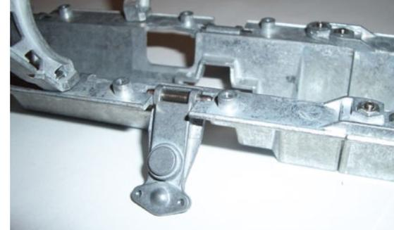
Die oberen Radaufhängungen sind mit Stahlachsen in der Unterwanne eingehängt und durch die aufgeschraubten Halter der Federung sind die oberen Radaufhängungen sicher in der Wanne befestigt
