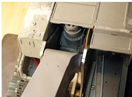
Noch ist die Verkleidung des Schwenkmotors gut zu sehen – so lange, bis alle Leitungen eingebaut sind
