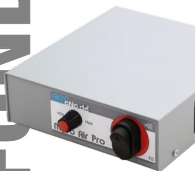
Die Micro Air Vakuumpumpe/Kompressor von GoCNC ist eine 2-in-1-Lösung für diejenigen, die ein Werkstoff gleichzeitig kühlen und es auf einem Vakuumtisch einspannen möchten, ohne dafür zwei Kompressoren zu nutzen. Sie verfügt über zwei 1/8-Zoll-Pneumatikanschlüsse, einen Ein-aus-Schalter und einen Drehregler. Die beiden Anschlüsse fungieren als Vakuumpumpe oder als Kompressor und ermöglichen so schnelles und komfortables Anschließen des passenden Zubehörs.
