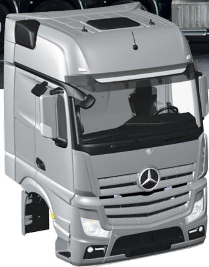
Mit Arocs, Atego und den Schwerlast-Versionen von Actros und Arocs umfasst die Nutzfahrzeug-Flotte von Mercedes-Benz eine ganze Reihe an Modellen für die Baubranche. Die SLT-Zugmaschinen basieren letztlich auf dem „klassischen“ Actros Gigaspace-Fahrerhaus (Abbildung)
