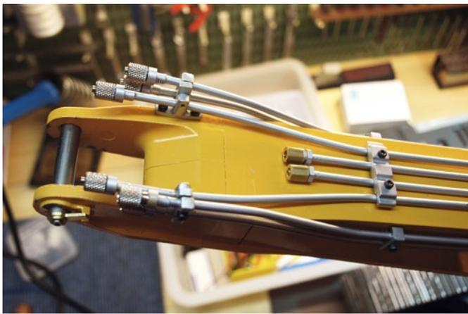
Die mittleren Rohre werden nicht benötigt. Hier wurden die Kabel für das Servo durchgezogen
