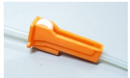
Mit einer solchen Schlauchklemme kann man den Kühlmittelfluss schnell regulieren oder ganz zusperren ohne die Maschine aus den Augen zu lassen. Das Fehlen einer Pumpe warf bisher keine gravierenden Probleme auf und sorgte nur gegen Ende für einen nachlassenden Druck
