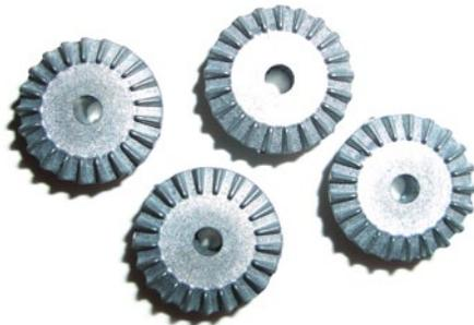
Diese Kegelzahnräder sind für den Antriebsstrang bestimmt und aus Aludruckguss gefertigt. Hier wären Zahnräder aus einem haltbarerem Material im Antriebsstrang wohl besser geeignet
