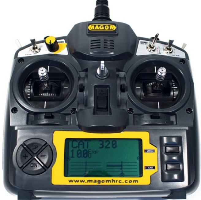
Die optional erhältliche Fernsteuerung besitzt für die Steuerung der Hydraulikpumpe und des Fahrertriebs drei Potentiometer
