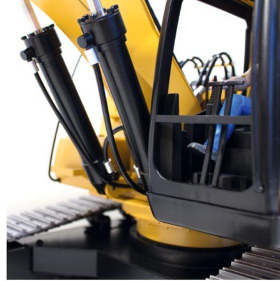
Die Hydraulikzylinder am Fahrerhaus. Bei der Karosserie handelt es sich um ein Bruder-Modell
