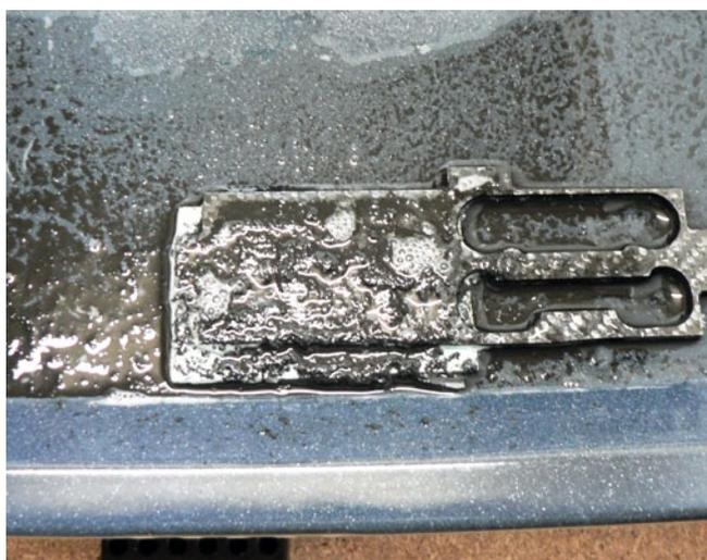
Beim Fräsen von CFK wird nach einem weiteren Bad in einem anderen Becken deutlich, wie viel Schmutz das Wasserbad aufnimmt, so gut gelingt dies mit keinem Staubsauger – egal welche Saugleistung dieser bringt, dafür ist das entstehende Pulver einfach zu fein
