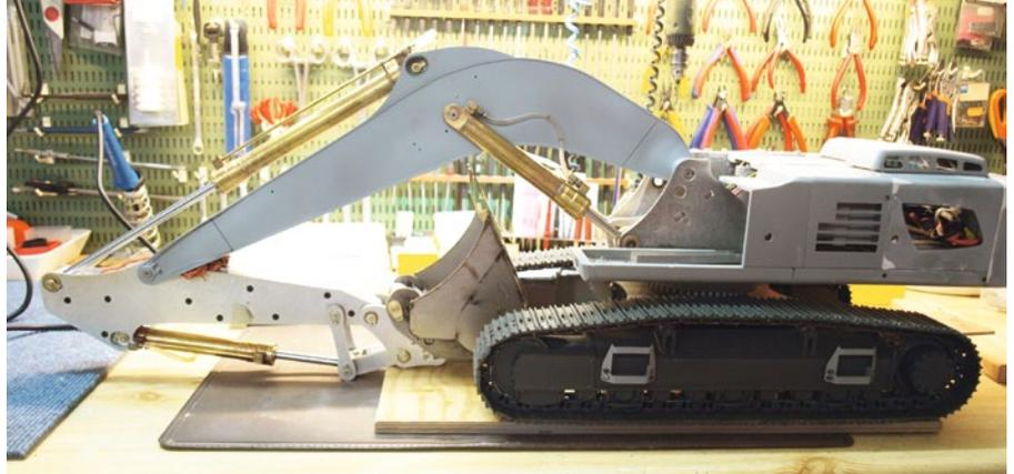
Der provisorische Zusammenbau von Ausleger, Stiel, Löffel und Zylinder. Hier passt alles
