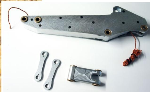
Die Kabel für das Servo sind eingebaut. Die Anlenkungen sind für den Schnellwechsler
