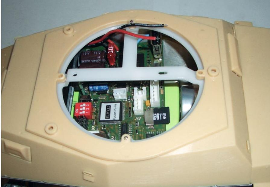
Das FO-Modul darf im Modell probesitzen: der einzige Platz dafür ist unter dem Turm – und da geht es sehr eng zu. Das Servo für die Rohrrelevation kann deshalb nicht auf der Unterseite des Stegs im Turmdrehkranz verschraubt werden
