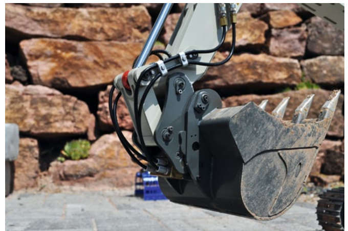
Hier ist der Löffel bereits voll angehoben und ungefähr waagrecht. So stellt man sicher, dass der Löffel perfekt im Wechsler liegt. Das ist gut daran zu erkennen, dass zwischen Löffel und Anschlag am Wechsler keine Luft mehr ist
