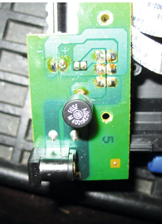
Um den Akku auch in der Fernbedienung laden zu können, wurde die Schutzdiode gegen eine Kleinstsicherung mit 400 Milliampere ausgetauscht
