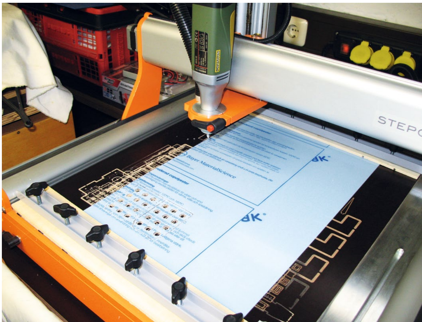
Aus einer 1 Millimeter starken Plexiglasplatte entstand die Abdeckung der neuen Optionsplätze
