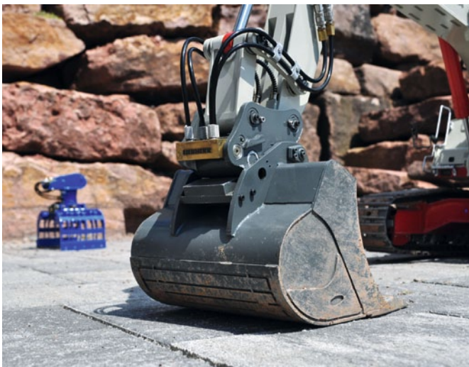
Während der Löffelzylinder geschlossen wird, sollte man mit Arm und Stiel immer leicht korrigieren, um kein Druck auszuüben
