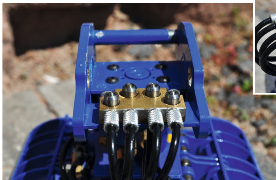
Wichtig ist der Platz zwischen den Platten, damit der Wechsler ungehindert einfahren kann
