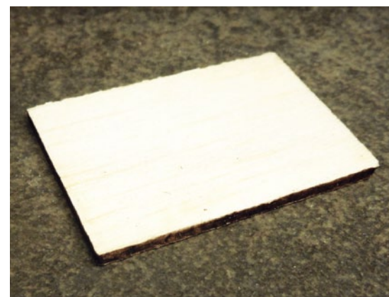
Ein Balsabrettchen lässt sich mit einem Laser leicht zerschneiden – und das völlig kräftefrei
