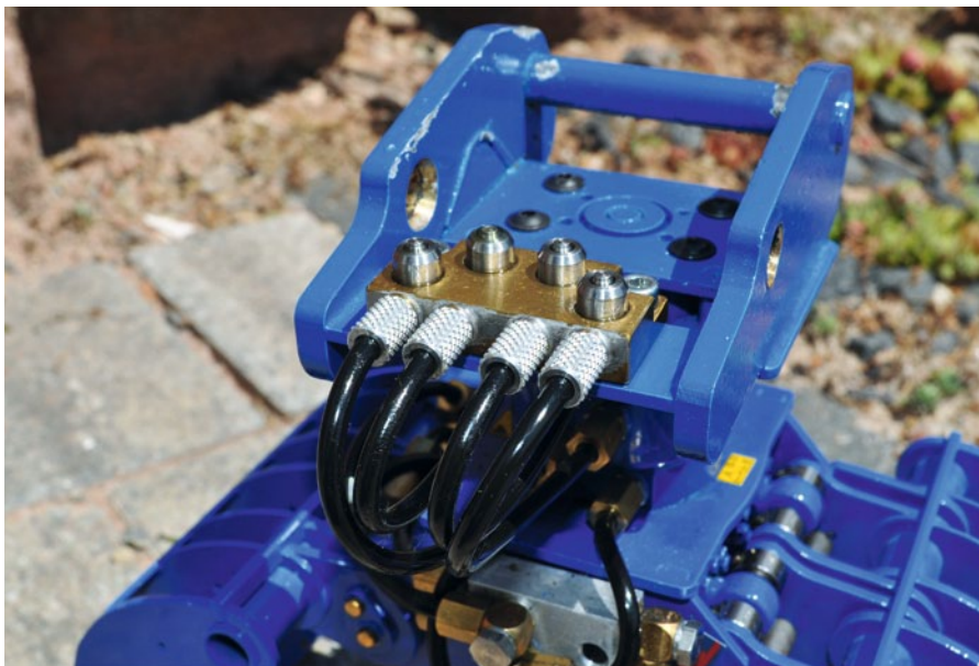
Hier sieht man die vier Kupplungen. Die Messingplatte lässt sich seitlich verschieben
