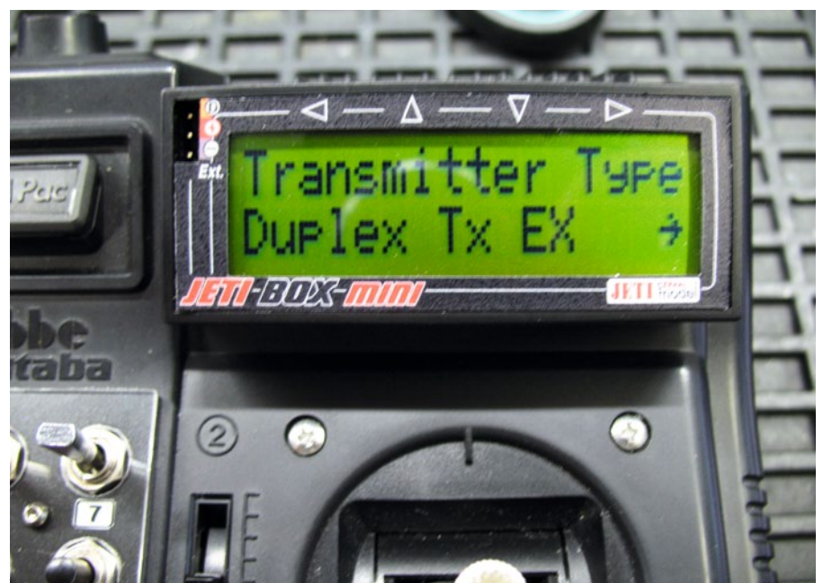
Sämtliche Einstellungen lassen sich mit Hilfe des Displays durchführen, auch das nötige Binden der Empfänger
