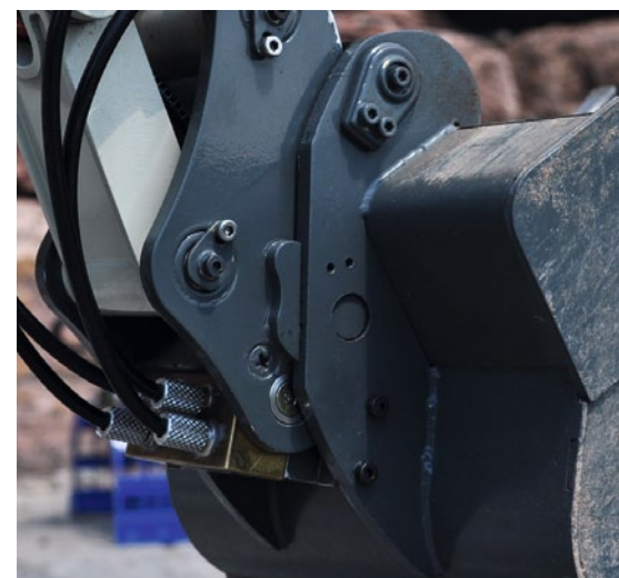
Die Bolzen des Wechslers sind nun ausgefahren und der Löffel somit verriegelt. Ab jetzt sitzt der Löffel fest und es kann gearbeitet werden
