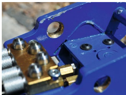
Durch die Fase gleitet der Bolzen des Wechslers in die Bohrung
