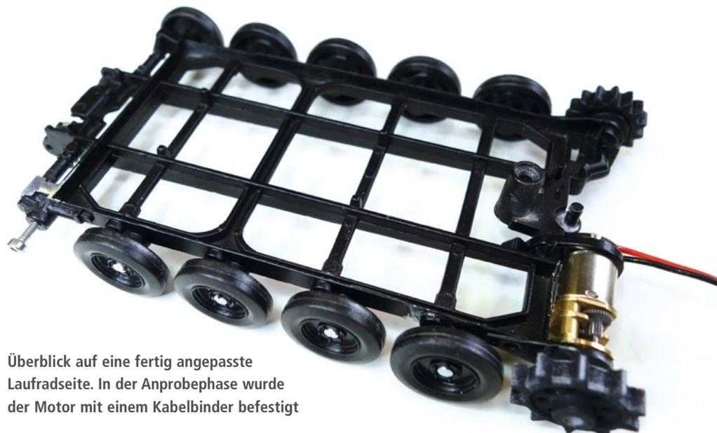
Überblick auf eine fertig angepasste Lauftradseite. In der Anprobephase wurde der Motor mit einem Kabelbinder befestigt
