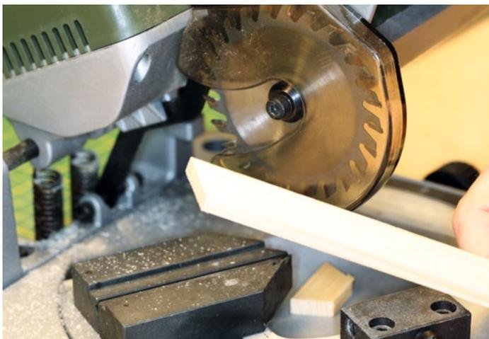
Der Sägeblattschutz fährt zurück, kurz bevor das Sägeblatt die Leiste erreicht
