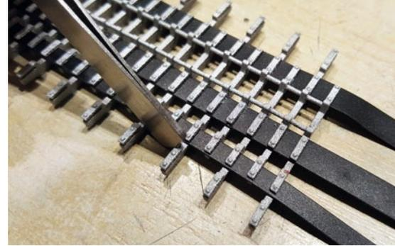
Das Band wird unter die Gegenplatten geschoben
