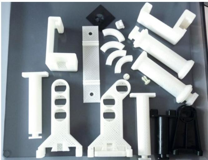
Adapter oder andere Konstruktionen, mit dem man Filamentrollen anderer Hersteller nutzen kann, sind sinnvolle Zusatztteile, die sich drucken lassen
