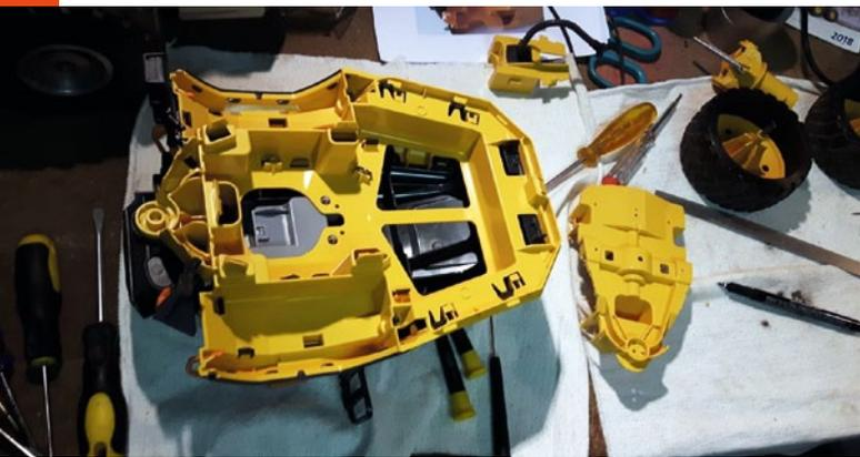
Die Fahrerkabine von unten. Hier muss gezielt Platz gemacht werden für das Fahrgestell aus Aluminium
