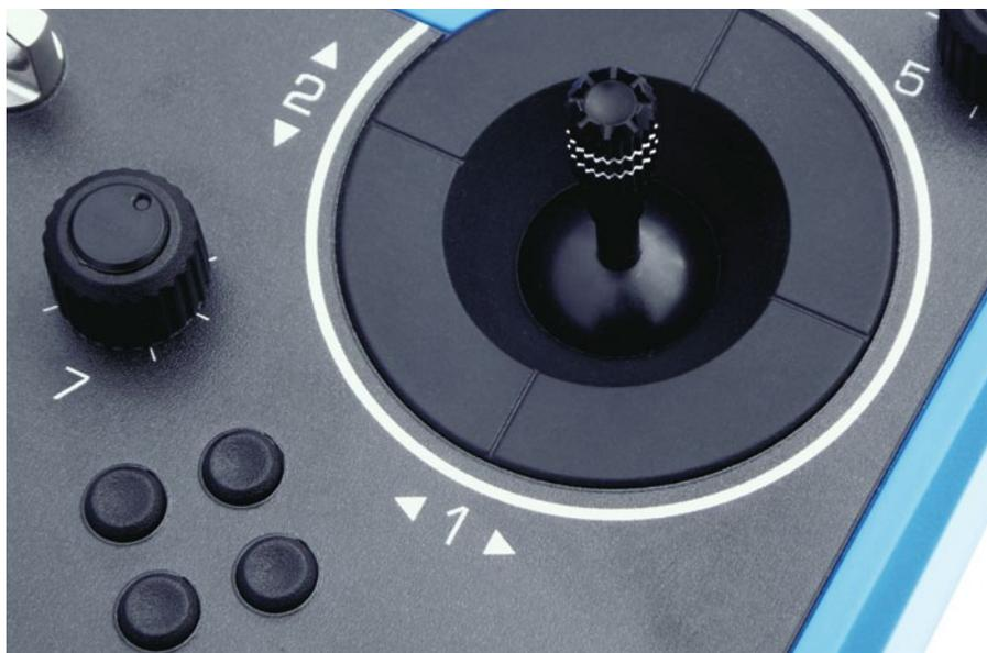
Aus Kunststoff bestehen die präzisen Steuerknüppel. Die Trimmung wird durch vier Tasten realisiert
