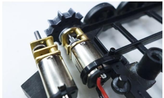
Um einen reibungslosen Kettenumlauf zu ermöglichen, müssen die drei Getriebeplatten vorsichtig abgedreht werden
