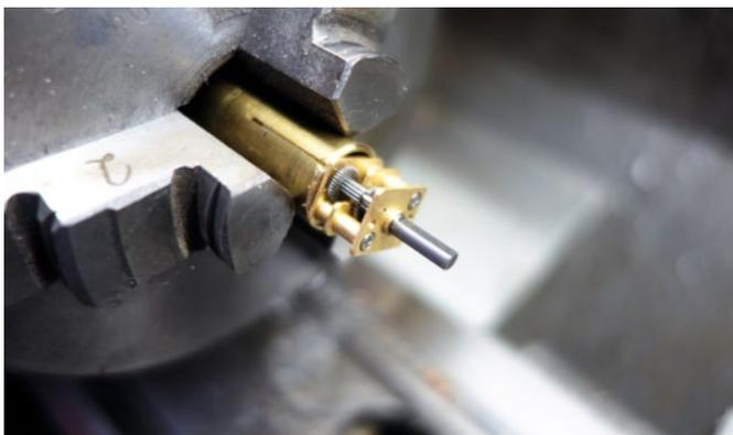
Ein schadenfreies Spannen geschieht am sichersten per selbst gebauter Spannzangenaufnahme
