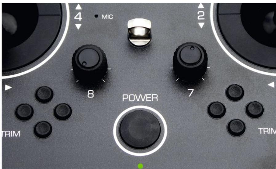
Der Schalter mit Status-LEDs, zwei Drehgeber, ein Mikrofon, sowie die Öse für den Gurt sind mittig platziert
