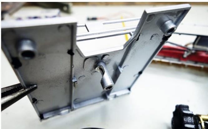
Ein gefühlvolles Ausfräsen des Befestigungsbolzens ermöglicht ein mittiges Ziehen
