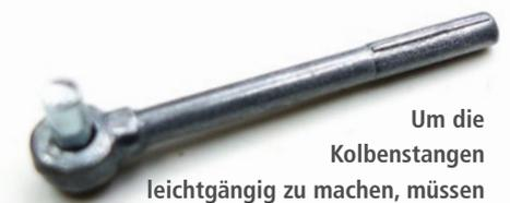
Um die Kolbenstangen leichtgängig zu machen, müssen die abstehenden Bremsfedern abgeschliffen werden
