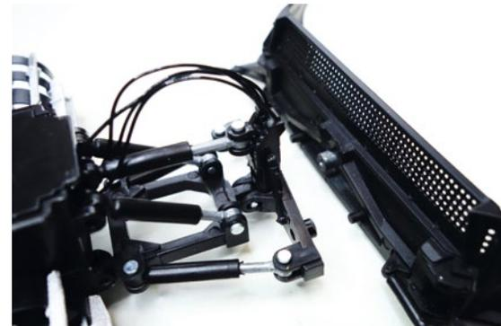
Das Frontschild ist mit einer M2,5-Schraube am Geräteträger befestigt
