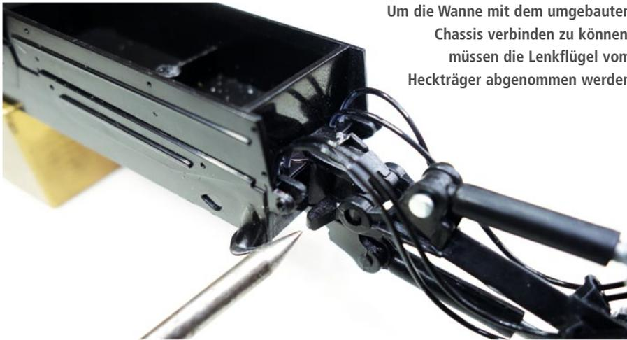
Um die Wanne mit dem umgebauten Chassis verbinden zu können, müssen die Lenkflügel vom Heckträger abgenommen werden
