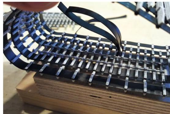
Die Kette wird zu einem Endlosring verschlossen und der Stoß vom Band unter der Gegenplatte unsichtbar versteckt
