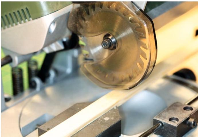
Links hinten im Bild sieht man die Verstelle schraube für den Sägekopf. Sie muss betätigt werden, wenn Gehrungsschnitte gelegt werden. Unterbleibt dies, wird die Klemmbacke beschädigt
