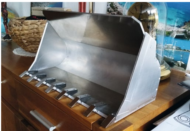
Als erstes entstand die Schaufel aus 5 Millimeter dicken Aluteilen
