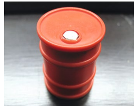
Der Verschluss entstand aus einer passenden M3-Sechskantschraube, Scheibe und passender Mutter
