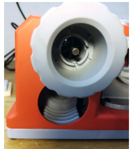
Blick von hinten auf einen Bohrer, der im Spannfutter eingelegt ist
