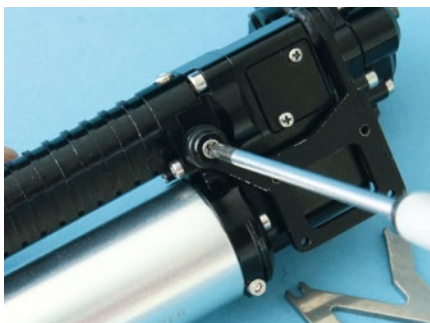
Das Getriebehalter wird mit den montierten Gummipuffern am Getriebe verschraubt
