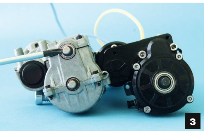
3) Der Nebenantrieb, der beim alten Dreigang-Getriebe (links) optional lieferbar war, ist im Helical-Getriebe (rechts) entfallen. 4) Das Entfernen des Inspektionsdeckels beweist es: Helical-Gear inside
