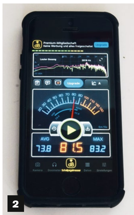
1) Mit einem mittleren Wert von etwas über 80 Dezibel wurde das alte, geradverzahnte Dreiganggetriebe gemessen. 2) Mit über 81 Dezibel liegt das neue Getriebe noch über dem alten; und das nur, weil der Körperschall durch einen Einbaufehler übertragen wurde. 3) Korrekt verbaut, zeigt das Helical-Getriebe nahezu die halbe Lautstärke wie das alte Dreigang-Getriebe
