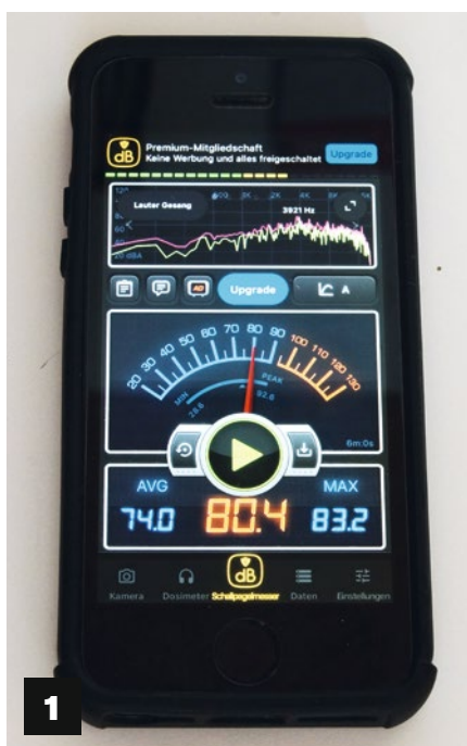
1) Mit einem mittleren Wert von etwas über 80 Dezibel wurde das alte, geradverzahnte Dreiganggetriebe gemessen. 2) Mit über 81 Dezibel liegt das neue Getriebe noch über dem alten; und das nur, weil der Körperschall durch einen Einbaufehler übertragen wurde. 3) Korrekt verbaut, zeigt das Helical-Getriebe nahezu die halbe Lautstärke wie das alte Dreigang-Getriebe
