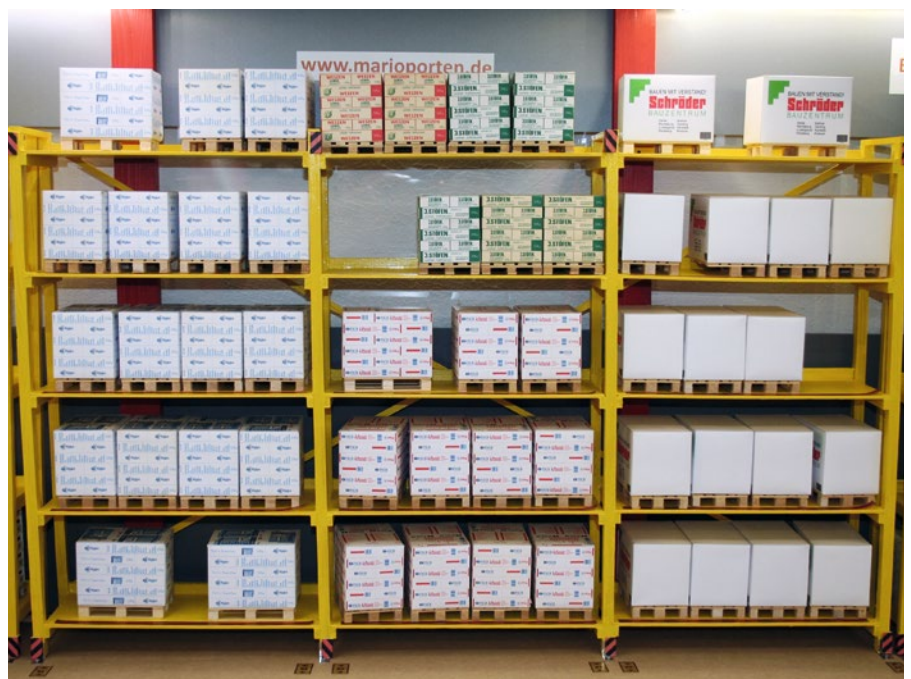
Im Zentrum steht eine Dreifacheinheit der hohen Regale, die insgesamt 60 Paletten aufnehmen kann und von zwei ebenfalls hohen Einzelregalen eingefasst ist
