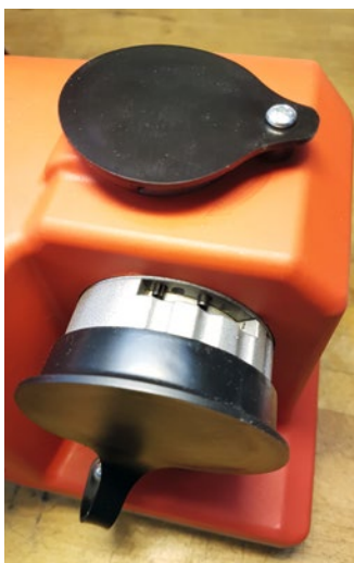
Die Gummiabdeckkappen liegen dem Gerät mit entsprechenden Schrauben lose bei und sind selbst zu montieren
