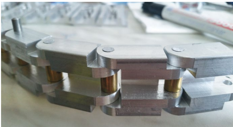
Die Zylinderstifte der Kettenglieder wurden mit Messinghülsen versehen und mit Locktite 638 geklebt
