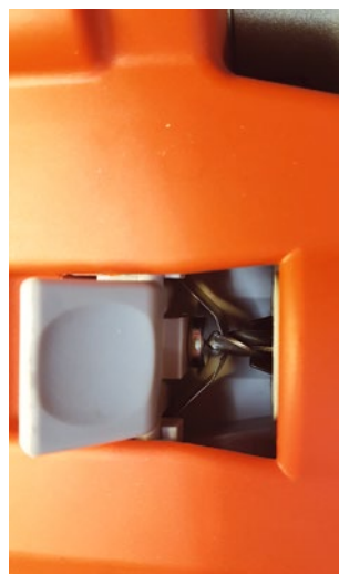
Bohrer im Spannfutter ausgerichtet: Wenn die Klemmfedern richtig in die Spannnuten des Bohrer eingreifen, ist dieser richtig positioniert
