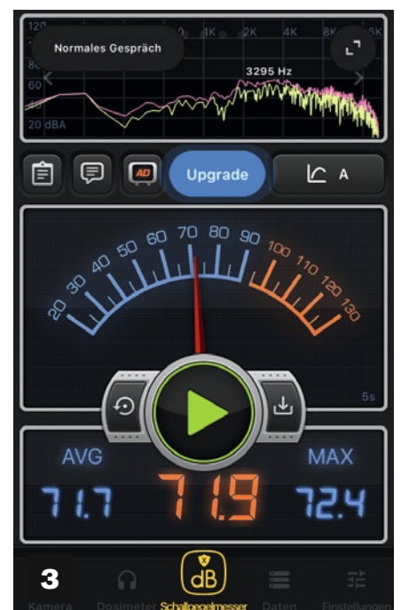
1) Mit einem mittleren Wert von etwas über 80 Dezibel wurde das alte, geradverzahnte Dreiganggetriebe gemessen. 2) Mit über 81 Dezibel liegt das neue Getriebe noch über dem alten; und das nur, weil der Körperschall durch einen Einbaufehler übertragen wurde. 3) Korrekt verbaut, zeigt das Helical-Getriebe nahezu die halbe Lautstärke wie das alte Dreigang-Getriebe
