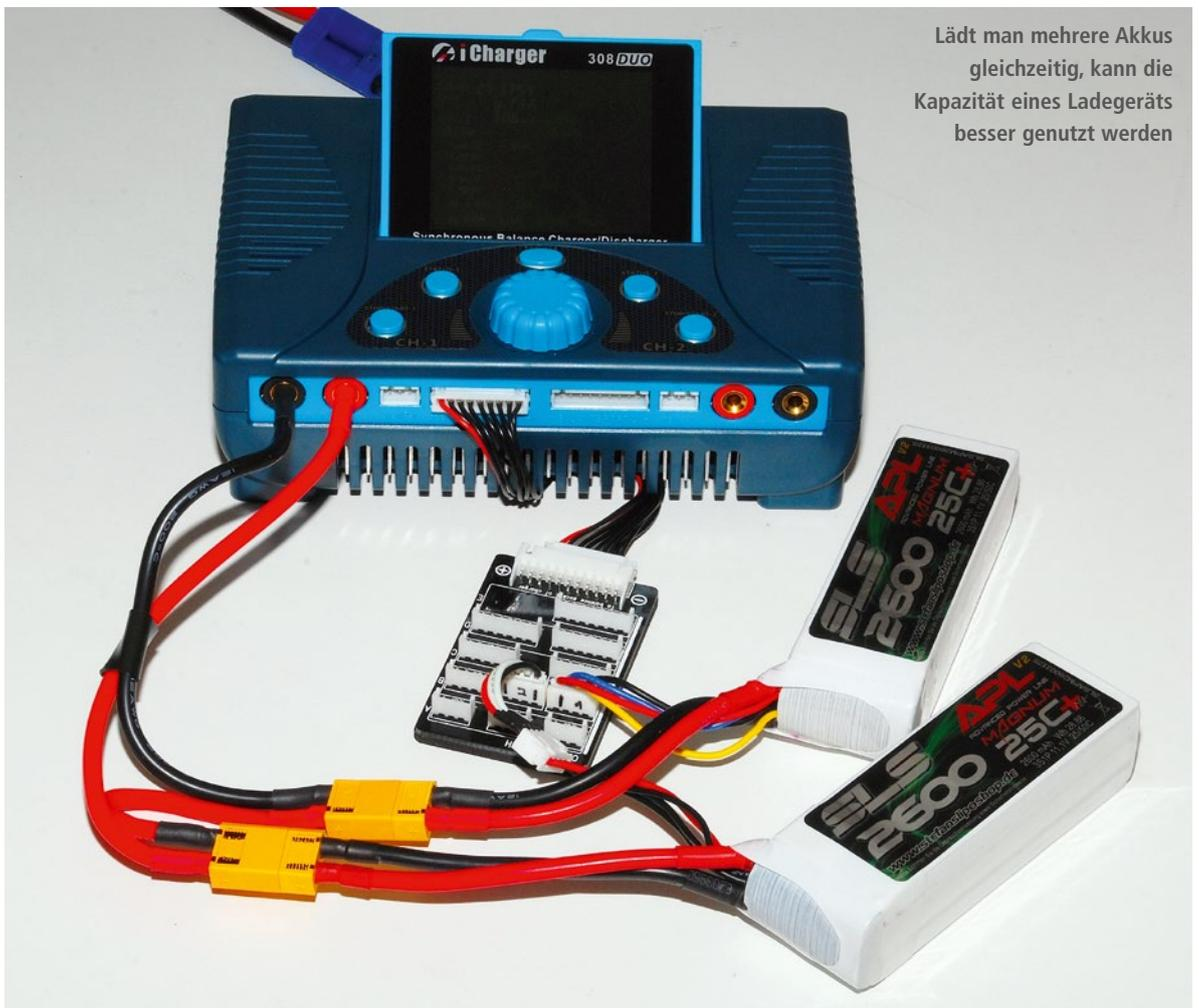
Lädt man mehrere Akkus gleichzeitig, kann die Kapazität eines Ladegeräts besser genutzt werden
