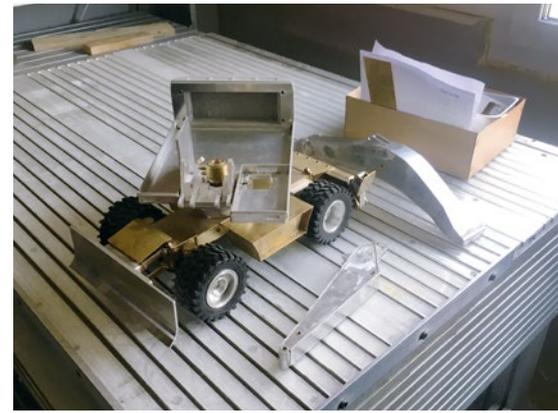
Der Komatsu PW220 im Rohbau. Messing und Aluminium in perfekter Bearbeitung, soweit das Auge reicht
