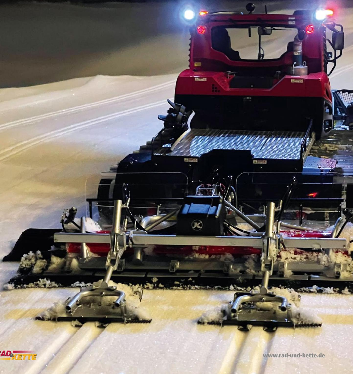
Bei der Pistenraupe selbst hatte ich schon vorgesorgt und ein Ventil für das hydraulische Anheben der Loipenspurplatten eingebaut. Ebenso hatte ich die Schläuche bereits installiert und mit Schnellkupplungen versehen. Diese gibt es nämlich funktionsfähig von ScaleART als winzige Wunderwerke mit M3-Anschlüssen für die kleinen 2-mm-Nippel. Damit ist es mir möglich, den Loipenspurer bei Bedarf einfach montieren und auch wieder entfernen zu können. Die Schnellkupplungen werden im demontierten
