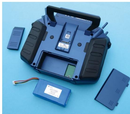
Rückseitig sind das Akkufach und ein Schacht für ein externes HF-Modul untergebracht. Gut erkennbar sind die beiden rückseitigen Tasten
