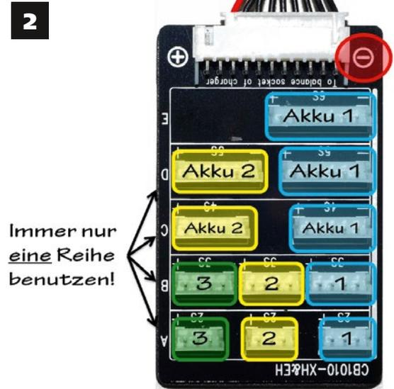
1) Um den Überblick zu behalten und die LiPos in der richtigen Reihenfolge an das Ladekabel anzuschließen, sind Kennzeichnungen an den einzelnen Teilen ratsam. 2) In dieser Reihenfolge müssen die Akkus an die Balancerplatine angeschlossen werden. Akku 1 ist immer der, dessen Minuspol mit dem Minus-Anschluss des Ladegeräts verbunden wird
