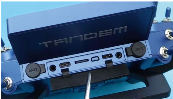
Sämtliche Ports, einschließlich eines SD-Karten-Slots, sind durch eine Abdeckung geschützt, aber trotzdem gut zugänglich
