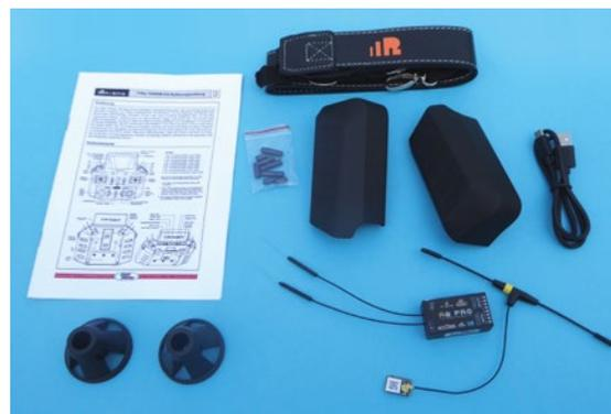
Außer dem voll ausgebauten Sender gehören eine Kurzanleitung, ein Tragegürtel, ein USB-Kabel, Schalterkappen sowie ein 2,4-GHz- und ein 868-MHz-Empfänger zum Lieferumfang
