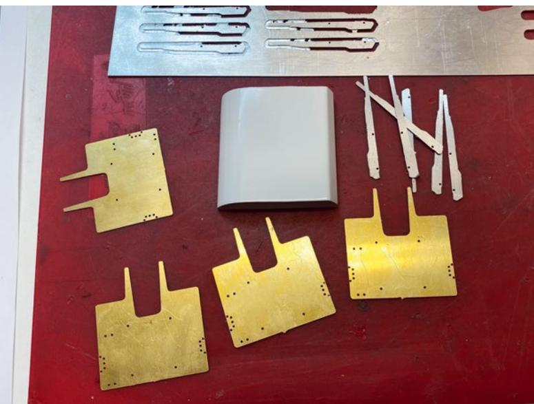
CNC-gefräste Messingplatten mit Bohrungen für die Spurplatten
