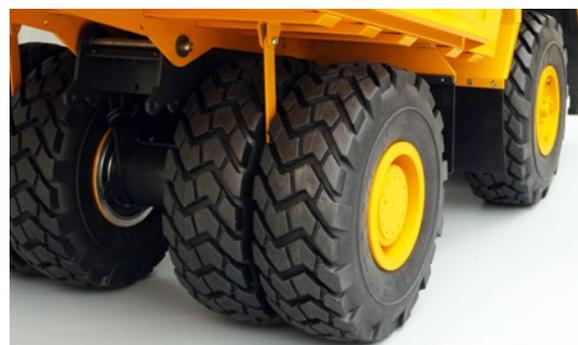
Ein interessantes Detail an der Hinterachse mit Doppelbereifung sind die Steinabweiser, die beim Einsatz in der Kiesgrube wertvolle Dienste leisten können
