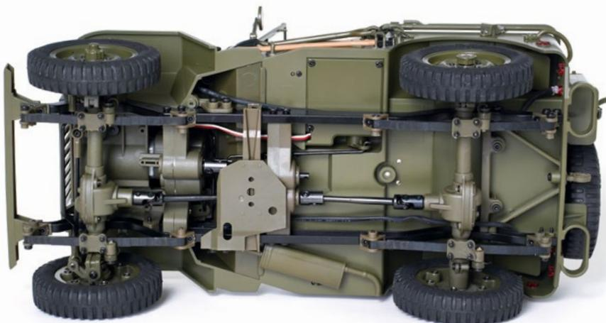
Dass keine Differentialgetriebe verbaut wurden, ist ein Vorteil im Gelände. Drei Servos sind außerdem implementiert. Tragendes Element ist der schwarz lackierte Leiterraum
