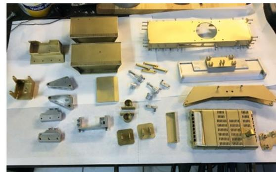
Nach der Demontage stand die Sandstrahlung aller Teile an
