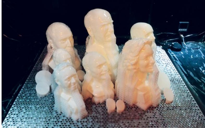
Gedruckte Teile im SLA-Verfahren
