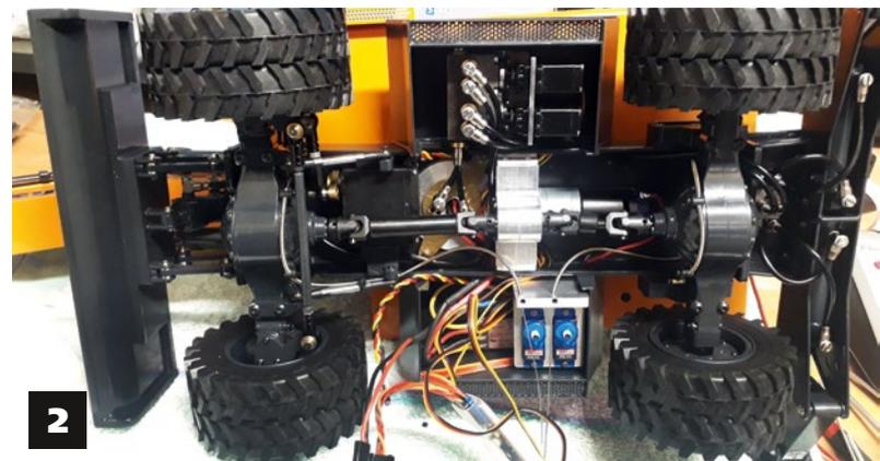
1) Alle Bauteile frisch lackiert auf dem Tisch vor sich zu sehen, bereitet Freude. 2) Die Montage ging durch die Ausgereiftheit des Schweizer Modellbauers sehr gut von der Hand. Zunächst wurde der Unterwagen mit Hydraulikventilen für Schiebeschild und Abstützungen montiert
