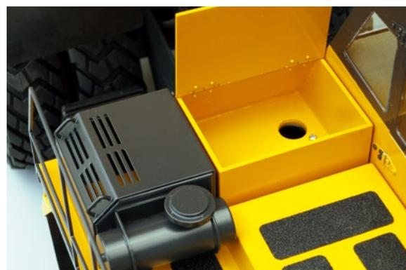
Neben dem Fahrerhaus ist die gut zugängliche Empfängerbox platziert. Auspuff und Luftfilterattrappe sind wie die übrigen Anbauteile aus Aluminium gefertigt
