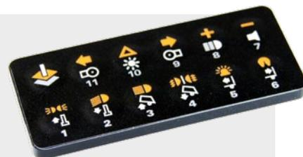
Das Steuerpad Licht und Sound von Kraftwerk regelt alle Lichtfunktionen inklusive Rundumlicht und Sattelkupplung. Auch Aufliegerstützen, Mulde, Rampe, Schaltgetriebe, zwei Servos, Lichthupe, Hupe sowie der Motor lassen sich damit regulieren. Über Ebenenumschaltung sind zudem 22 weitere Zusatzfunktionen vorhanden. Insgesamt verfügt das Steuerpad über 45 steuerbare Funktionen. Das Pad ist kompatibel mit vielen geläufigen Sendern: Ein Erweiterungskanal kann bei Bedarf auch verwendet werden.
