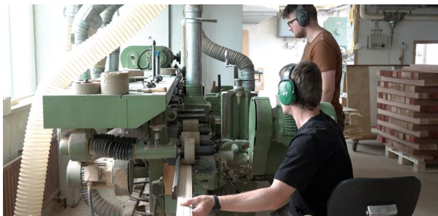
In der Holzwerkstatt kommen präzise, seit Jahren bewährte Industrie-Maschinen zum Einsatz, hier zum Profilieren von Leisten
