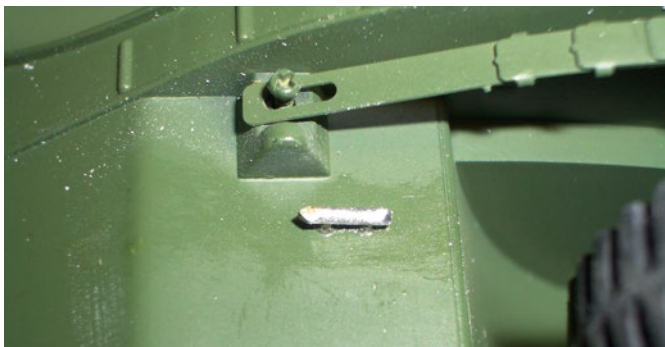
Dank Messingdraht gibt es im Modellteich keine Probleme mit der Leitfähigkeit des Wassers
