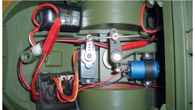
Empfänger und Sender der 2,4-GHz-Anlage sind ab Werk gebunden. Am Empfänger (links unten) leuchtet keine Kontroll-LED
