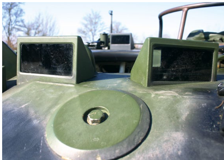
Drei Winkelspiegel umgeben den Platz des Kraftfahrers. Dahinter befindet sich die Position des Richtschützen, welcher zugleich Kommandant ist
