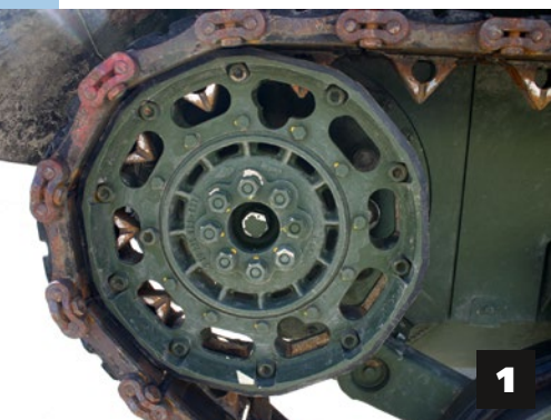
1) Die Antriebsrolle des rund 3,3 t schweren – oder besser leichten – Gefährts. 2) Selbstverständlich verfügt der Wiesel auch über eine Beleuchtungsanlage mit Scheinwerfer und Blinker. 3) Detailaufnahme des Lüftungsgitters
