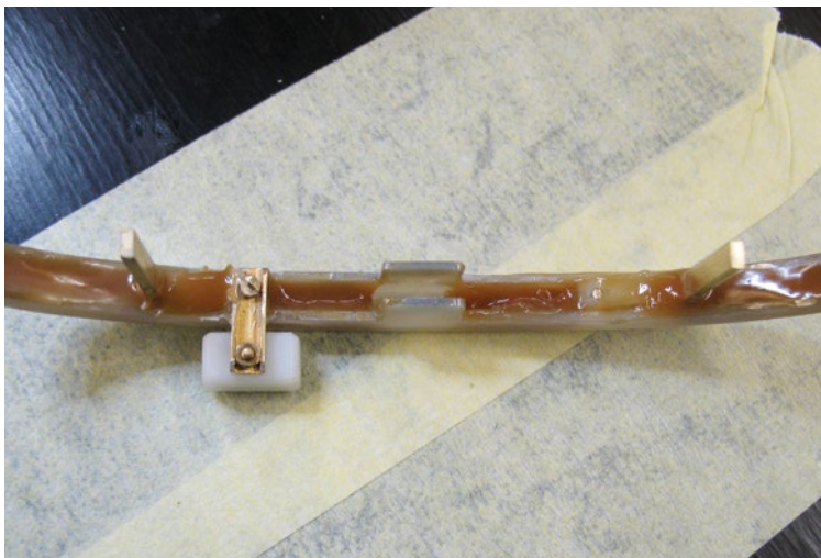
Die hintere Stoßstange erhielt zwei Halterungen aus eingeklebtem Messingflachprofil und ein Scheinwerfergehäuse für die Nebelschlussleuchte
