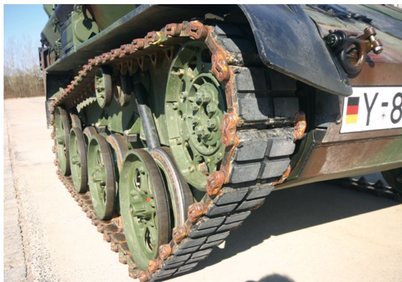
Beim Wiesel 1 folgen dem Antriebsrad drei drehstabgefederte Laufrollen, am Heck des Fahrzeugs befindet sich die große Umlenkrolle
