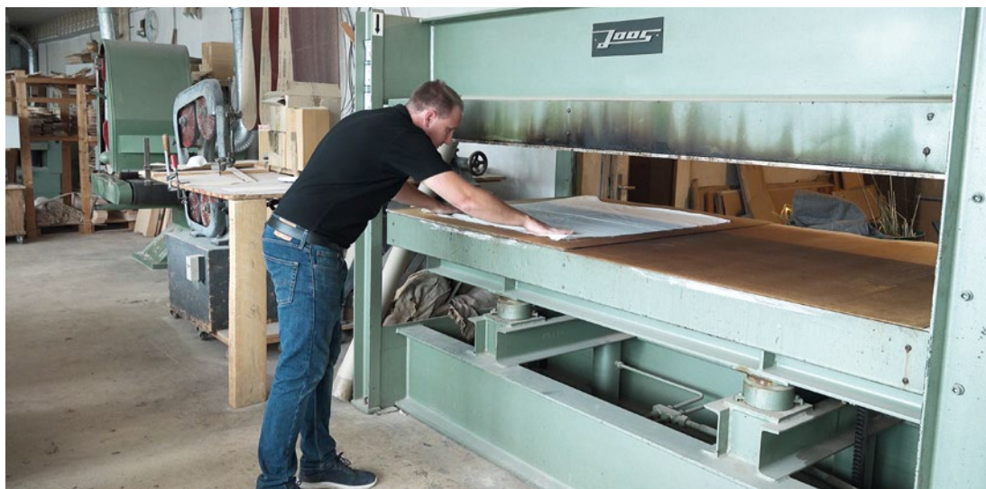
Eine Spezialität von aero-naut sind mit Textil verleimte Furniere, die Fertigung erfolgt direkt in Reutlingen
