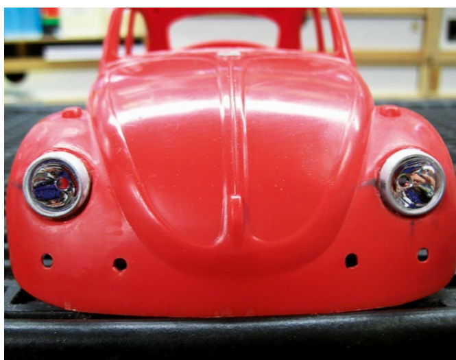
Die Scheinwerfer wurden mit 3-mm-LED im Farbton Warmweiß und einer passenden Streuscheibe bestückt
