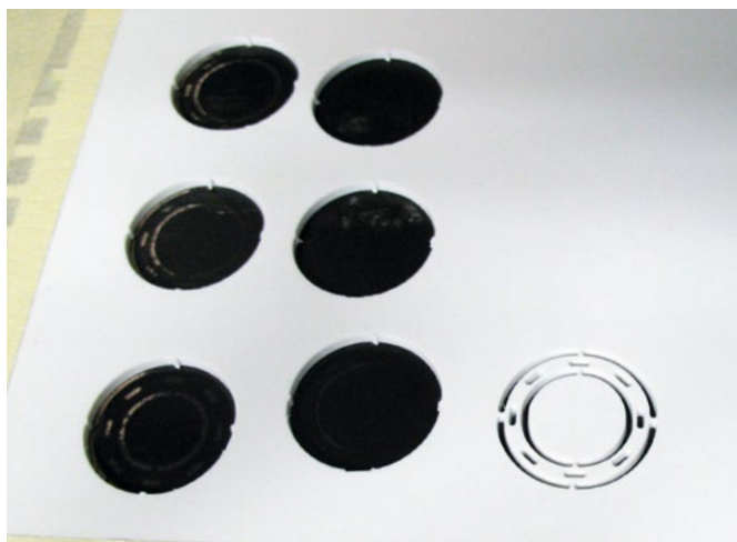
Die benötigten Teile für die Felgen wurden per CAD-Programm gezeichnet und anschließend ausgefräst
