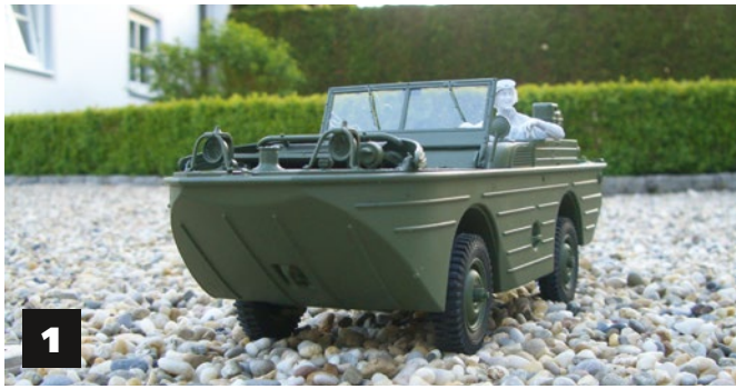
1) Aus dieser Perspektive ist die pontonförmige Karosserie gut zu erkennen. 2) An der Unterseite am Heck ragen die beiden Kontakte aus der Wanne heraus, die den Stromkreis für den Schraubenantrieb bei Wasserkontakt schließen sollen
