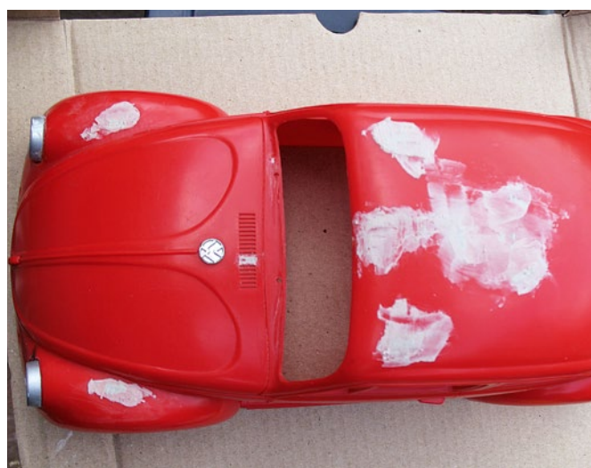
Die durch Demontagearbeiten entstandenen Löcher im Dach wurden verschlossen, gespachtelt und anschließend geschliffen
