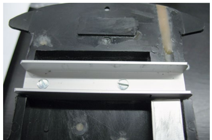
Das im Text beschriebene Alu-U-Profil wurde mit dem Chassis verschraubt und nimmt später die beiden Motoren auf
