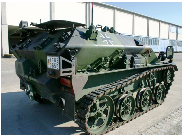
In der Seitenansicht gut zu erkennen: Die sogenannten „Heißösen“ zum Festzurren des Gefährts
