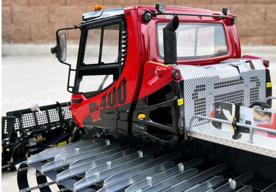
Damit der Modellnachbau in 1:12 realisierbar ist, mussten die Wandstärken der Kabinenkomponenten angepasst werden
