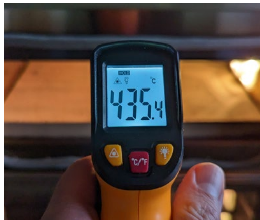
Nach etwa 15 Minuten hat der Ofen die Oberfläche des Biscotto bereits auf 435°C aufgeheizt
