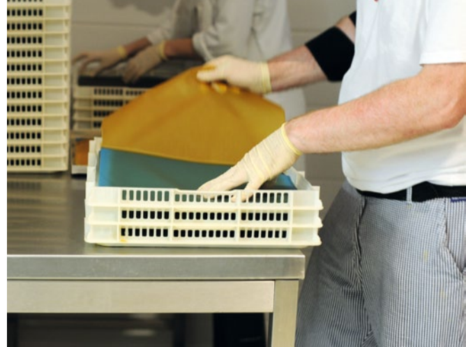
Einblick in die ehemalige Produktion: Abziehen des Fruchtpapiers von den Silikonmatten, nachdem das Fruchtpüree im Dörrföfen getrocknet wurde. Ende 2019 ist die Produktion an einen externen Produzenten abgegeben worden
