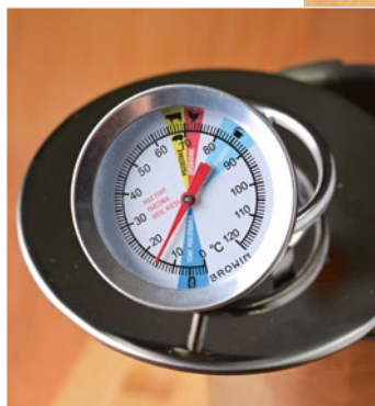
Ein großer Unterschied zur Schinkenfee: das Thermometer zur Messung der Kerntemperatur während des Kochvorgangs
