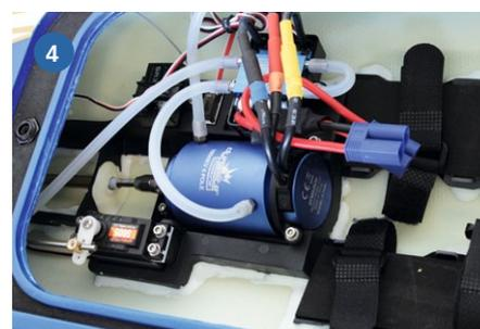
1) Zum Lieferumfang gehört ein stabiler, mit Schaumgummiauflage ausgestatteter Bootsständer. 2) Aus hochfestem Alu bestehen Keilruder und Flex-Wellenanlage. 3) Die Trimbleche fluchtet exakt mit dem Deep-V-Unterwasserrumpf. 4) Über einen Kühlwasserkreislauf wird dem Innenläufer die verrichtete Wärme abgeführt
