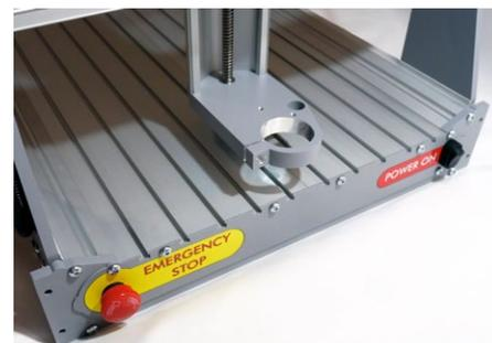
43-Millimeter-Aufnahme an einer sehr dicken Halteplatte. Jegliche Verkabelung ist auf die Rückseite verbannt und somit vor Spänen sowie Dreck sicher
