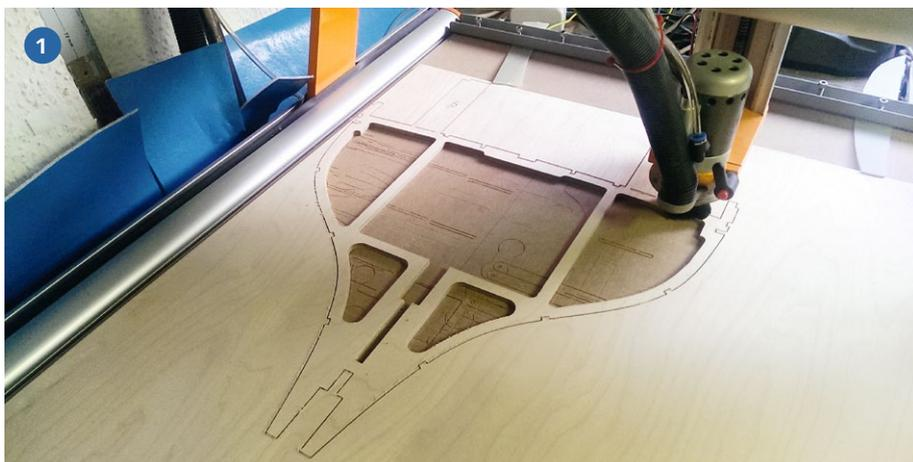
1) Ansicht des Hauptspants der INTEGRITY, einer über 2 Meter langen Kutteryacht. Er ist äußerst zierlich gearbeitet. Ein 0,7-Millimeter-Fräser geht pro Fräsgang lediglich 0,5 Millimeter tief ins Holz, sodass bei 4 Millimeter starkem Material acht Fräsgänge erforderlich sind, bis ein Spant in den Händen gehalten werden kann. 2) Die Rennjolle AERO II brachte für Axel Franzen den Stein ins Rollen
