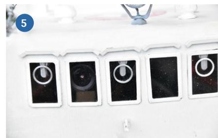
1) Blick auf die im Rumpf verbauten Motoren sowie RC-Elektronik - vorne der Akku. 2) Der Hauptschalter mit Sicherung sitzt versteckt unter dem Lukendeckel auf dem Achterdeck. 3) Die STOLTERA in der Transportkiste. Eine solche ist ratsam, um Schäden am Modell zu vermeiden. 4) Diese Teile, TV-Kamera und Sender, werden im Modell für den FPV-Betrieb eingebaut. 5) Die Kamera sitzt hinter dem Cockpitfenster. So kann man sich wie ein echter Kapitän fühlen
