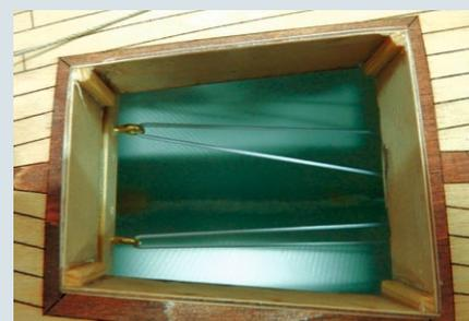
**Die Vorsegelschoten sollten mittels eines Hutgummis gespannt werden, damit sie sich nicht auf der Trommel der Winde verheddern. Die Schraube kommt auf das Servobrett, die beiden Haken werden mit dem Holz unter die vordere Luke geklebt. Die beiden äußeren Enden des Gummis werden mit der Schot verbunden. Zwischen den Haken wird der Gummi nach hinten gezogen und an der Schraube auf dem Servobrett eingehängt**
