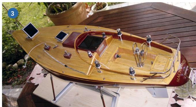
1) Beim Bau des Rumpfs wurde der Innenausbau mit berücksichtigt. Zur Beplankung dienten Mahagoni-Streifen. 2) Als Standmodell war Wasserfestigkeit weniger gefragt, so reichte Parkettlack für die Oberfläche. 3) Durch die Luke kann man in den ausgebauten Innenraum sehen. 4) Die Kalfaterung zwischen den Decksplanken ist aus Pappstreifen gemacht. 5) Der klassische Look ist dem aufwändig gefertigten Holzdeck zu verdanken
