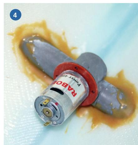
1) Der Bausatzinhalt besteht aus acht Polystyrol-Platten, dem GFK-Rumpf und diversen weiteren Materialien. 2) Im Ausbausatz enthalten sind die separaten Bausätze für den Kran und das Schlauchboot. 3) Ausfräsen der Schlitze für die Schlingerkiele mit der Proxxon-Maschine. 4) Fertig installiertes Querstrahlruder – es stammt aus dem Raboesch-Sortiment
