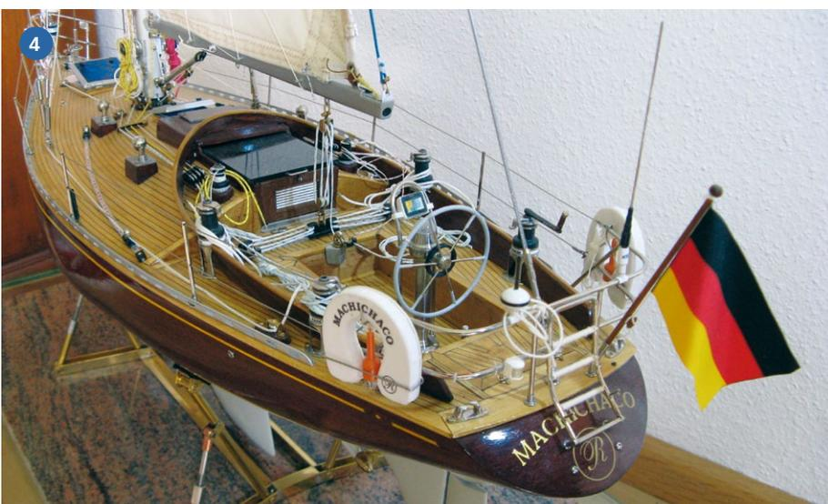
1) Die Fußreling entstand aus Messingstreifen und Draht. 2) Am Mast angebrachter Spinnakerbaum. 3) Die Rettungsringe sind aus Sperrholz und mit beschriftetem Stoff überzogen. 4) Von Schiffsmodellflaggen.de stammt die Deutschland-Fahne
