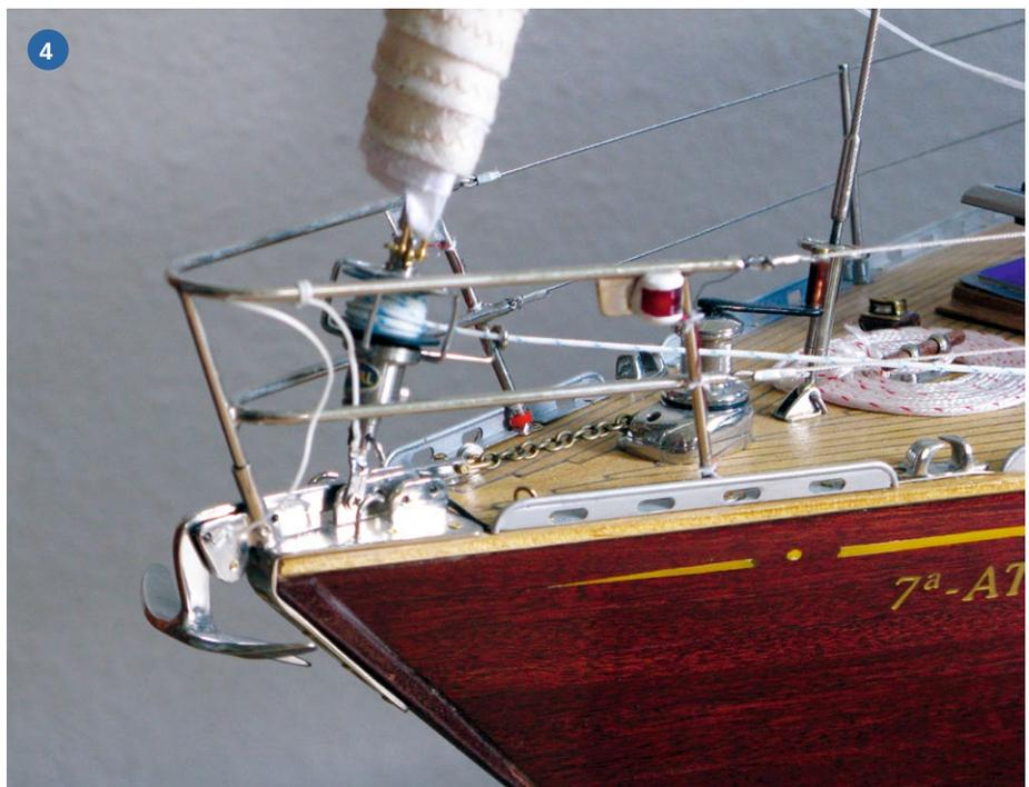
1) Sämtliche Beschlage, die sich an einem Original-Mast finden lassen, sind auch beim Nachbau auf der MACHICHACO-R zu finden. 2+3) Eine gezielte Mischung aus Messingplatten und etwas silberner Farbe lieen das Anbringen der Beschlage am Alu-Mast zu. Letzter kommt aus dem Baumarkt und war mal ein handelsubliches Rohr. 4) Das Segelreff ist voll funktionsfahig und mit Kugellagern bestuckt
