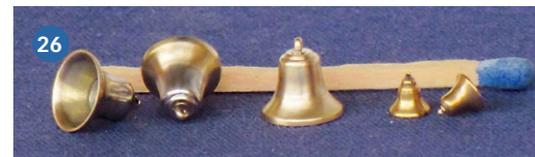
22) Nach dem Entlöten wird die Glocke außen noch einmal poliert. 23) Drehen und Abstechen des Klöppels aus einem recht dicken Materialstück. 24) Für das Biegen der winzigen Ösen habe ich eine Mini-Rundzange (Eigenbau). 25) Die Größe täuscht, der Durchmesser ist nur 8,8 Millimeter. 26) Durchmesser 4,5 Millimeter bei den kleinen Glocken
