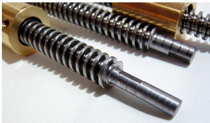
Die Gewindespindeln sollten vor dem Einbau sauber entgratet und anschließend im Seifenbad von allen Metallspänen oder anderen Verunreinigungen befreit werden. Nur so ist später ein seidenweicher Lauf in den Messingbuchsen gewährleistet
