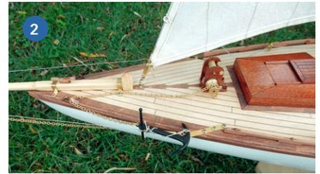
1) Gut zu sehen ist hier die einfache Schotführung der Großschot. Auf den beiden Belegklampen ist der Umlenkblock für die Vorschoten belegt. So kann jederzeit die Vorschot-Spannung justiert werden. 2) Viele kleine Details auf dem Vordeck bereichern die Optik der ANTARES enorm
