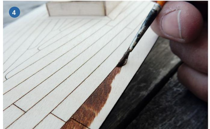
1) Die Decksauflage ist eingebaut und wird zum Verkleben im vielen Klammern gehalten. 2) Der Decksunterbau gewährleistet einen absolut verzugsfreien Aufbau des Decks. 3) Vier Schotführungen sind notwendig, wenn die Vorsegel vorbildgetreu angesteuert werden sollen. 4) Nach der Montage des Oberdecks werden die Wassergänge und die Königsplanke von Hand in Mahagoni gebeizt
