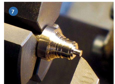
5) Beim Bearbeiten von Drehmessing stets 0 Grad Spanwinkel. 6) Schon drei Glocken sehe ich als Serienfertigung an. 7) Die Kanten der Stufen/Absätze erscheinen hier noch mit viel Grat
