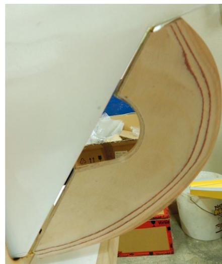
1) Jede Menge sauber gelaserte Holzbrettchen, ein paar Äzerteile und ein sehr gut gemachter GFK-Rumpf sind neben einer hervorragenden Anleitung Bestandteil des Baukastens. 2) Der Antriebssatz ist auf das Modell abgestimmt. Besonders gefallen hat der Motorträger, der optimal an die Winkellage der Welle angepasst werden kann. 3) Das Ruder ist fertig profiliert und hat den Ausschnitt für die Schiffsschraube erhalten
