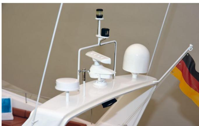
3) Mikro-Koaxialkabel übernehmen auf diesem Geräteträger einer Yacht die Stromversorgung der Beleuchtung
