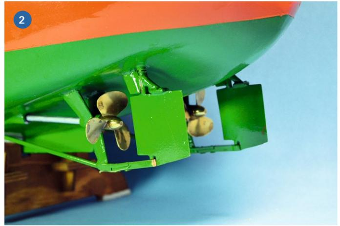
2) Ruder und Propeller im fertigen Zustand
