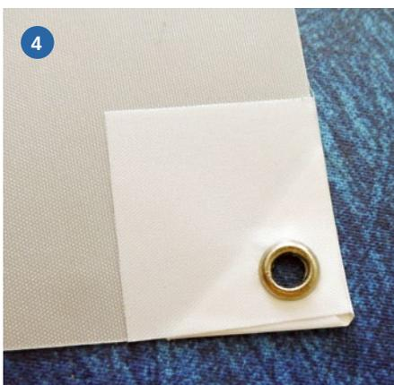
1-4) Das Vorliek wird mit selbstklebendem Segeltuch-Klebeband verstärkt. Das gleiche gilt für die Ecken, die im nächsten Arbeitsschritt ein Loch eingestanz bekommen, in das dann eine Öse eingesetzt wird
