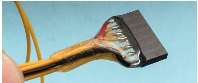
Heißkleber ist ein probates Mittel, um mit wenig Aufwand Steckverbindungen zu stabilisieren und gleichzeitig gegen Kurzschluss zu sichern. Mit etwas künstlerischem Talent entsteht flugs ein transluzenter Stecker
