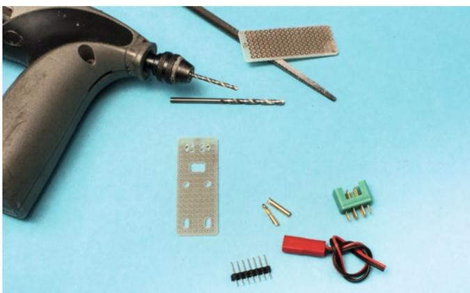
Das Wichtigste ist die Tatsache, dass der Balancer-Anschluss des Ladegeräts einen Stiftabstand von 2,54 Millimeter besitzt. Dafür gibt es Stiftsocket- und Buchsenleisten sowie Epoxid-Punkttraster-Platinen, die ich für die einzusetzenden Stecker nach Bedarf nachbohre und -feile.
