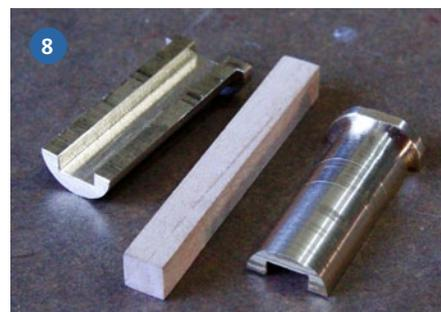
12 mm. Zwischen den Messing-Halbschalen hatte ich einen Spalt von 0,6 mm vorgesehen, damit überhaupt ein Klemmen möglich wird. Man spannt diese drei Teile in ein sehr gut rundlaufendes Vierbacken-Futter. Dabei lässt man nur eine Hälfte der Länge ausragen, dieses Stück wird auf Ø10 mm überdreht. Danach spannt man das Ø10-mm-Stück in ein ebenfalls gut rundlaufendes Dreibackenfutter (besser 10er-Zug(!)-Spann-
