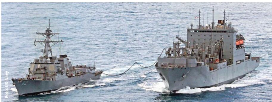
AKE-4 bei der Treibstoffübergabe an einen Zerstörer – gut zu erkennen an dem über das Rigg laufende Trageseil mit Schlauch
