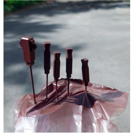
Festmacherpfosten und -kreuz liegen als sehr gut gefertigte, weiße Fertigteile bei und sind noch zu lackieren
