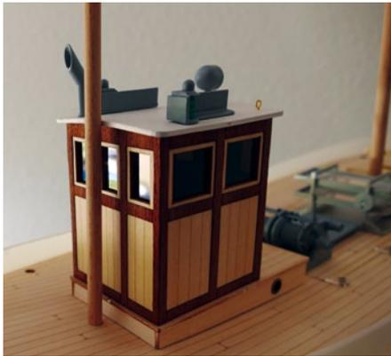
**Die Masten sind entsprechend der Bauplanzeichnung abzulängen und dann einzusetzen**
