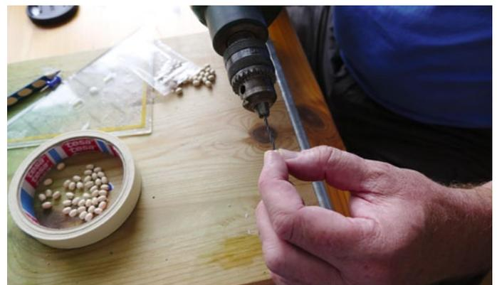
Durch die Netz-Rollen ist die Netz-Kette zu führen. Leider mussten alle Rollen nachträglich aufgebohrt werden
