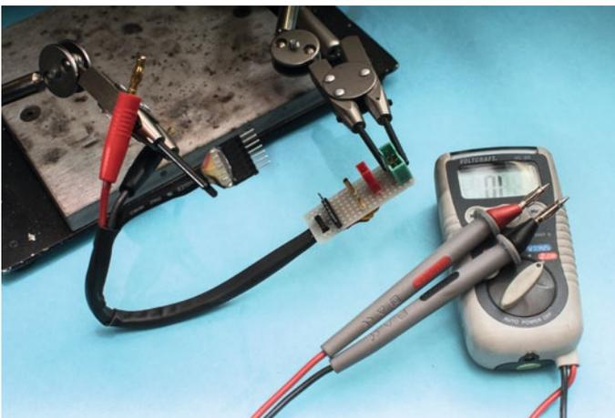
Vor dem ersten Einsatz wichtig: alles in Ruhe durchprüfen, denn schnell hat man sich mal vertan. Also mit dem Durchgangsprüfer checken ob alle Minus-Seiten der Ladestecker auch wirklich Minus sind, und bei Plus genauso. Auch die korrekte Reihenfolge der Balancer-Leisten kontrollieren
