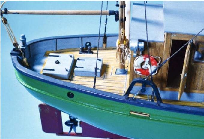
Unter der kleinen Luke auf dem Achterdeck befinden sich die Hauptsicherung, die Ladebuchse für den Fahrakku und der Schalter für den Fahrregler
