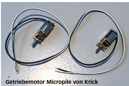
Getriebemotor Micropile von Krick
