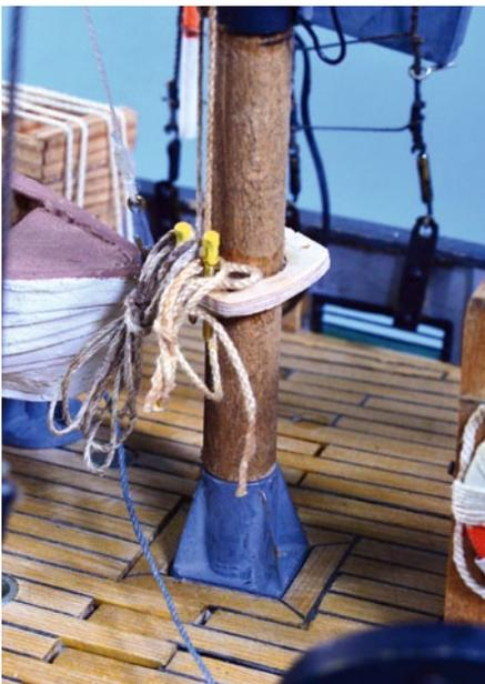
Neben den Details am Mast (Metallfuß und kleine Nagelbank) ist hier vor allem das „verzahnte“ Deck zu erkennen, unter dem sich der Zugang zum Inneren befindet
