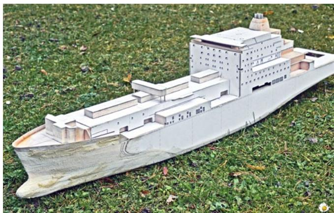
Das erstmals geschliffene Modell. Hier bereits mit den fortgeschrittenen Aufbauten von Deck- und Brückenhäus
