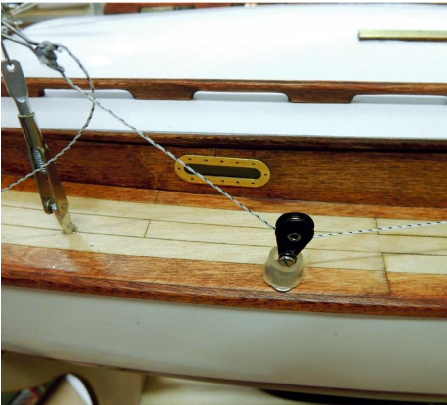
Die Schot läuft über einen kugelgelagerten Block zur Genua
