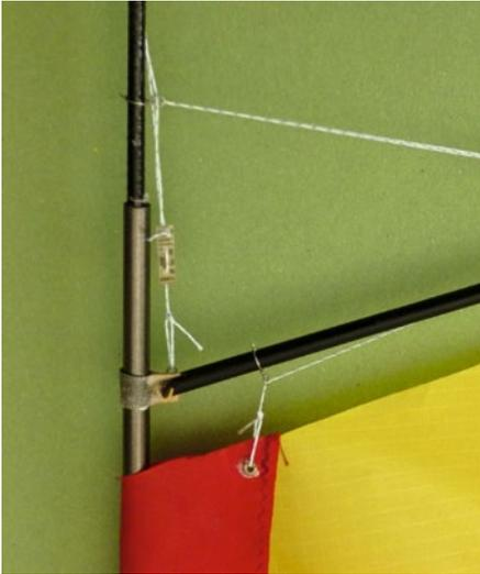
Die Gaffel endet unten in einem Gelenk, das als Rohrschelle den Mast umhüllt. Dazu ist mit Sekundenkleber und Glasseide ein Stückchen Sperrholz an einen passenden Rohrschnitt geklebt
