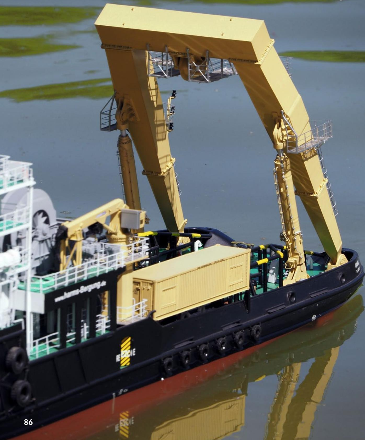
**W**as ist ein A-Frame? Im Fall der URANUS ein Kran mit einem Schwenkbereich von 13 Meter (m) über Wasser und 9 m über das Hauptdeck, der auf vielen Offshore-Schiffen sehr häufig im Heckbereich als Kran eingesetzt wird. Über diesen Bock-Kran werden sehr häufig schwere Lasten direkt von der Pier/Kaianlage auf das Achterdeck des Versorgers gehoben. Dazu wird das jeweilige Schiff entsprechend mit dem Heck so dicht wie möglich an die Pier gefahren und mit mehreren Festmacherleinen gesichert.
