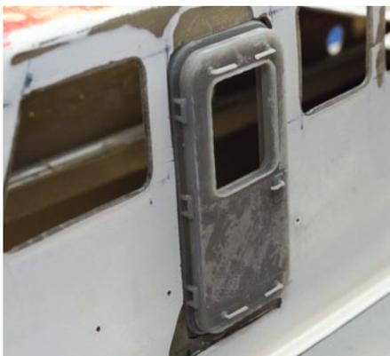
Eine selbst am PC konstruierte und dann ausgedruckte Tür mit Griff, Vorreiber und Scharnieren – innen ist ebenfalls ein Griff Teil des 3D-Drucks
