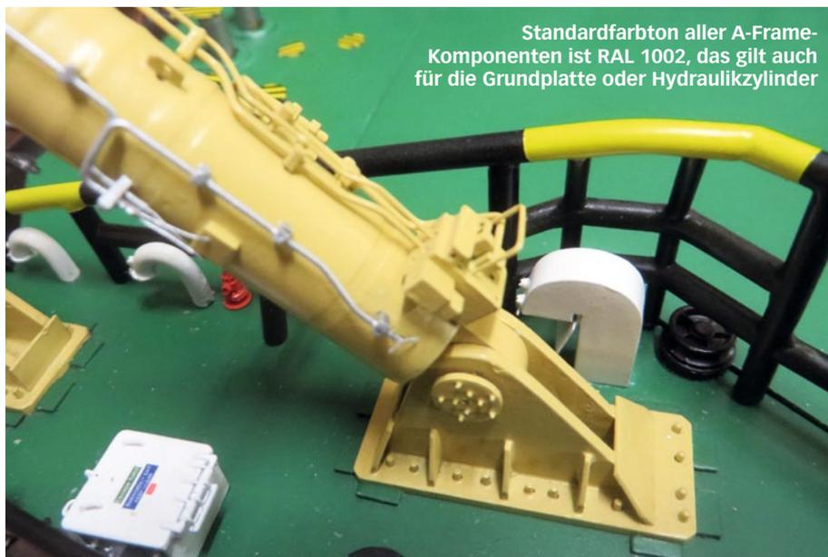
Standardfarbton aller A-Frame-Komponenten ist RAL 1002, das gilt auch für die Grundplatte oder Hydraulikzylinder
