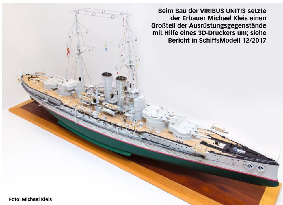
**Beim Bau der VIRIBUS UNITIS setzte der Erbauer Michael Kleis einen Großteil der Ausrüstungsgegenstände mit Hilfe eines 3D-Druckers um; siehe Bericht in SchiffsModell 12/2017**
