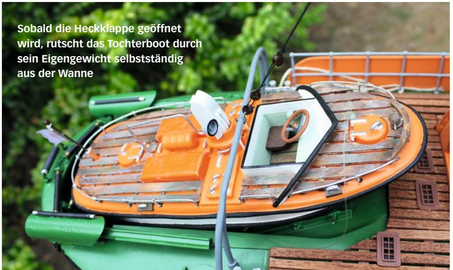
Sobald die Heckklappe geöffnet wird, rutscht das Tochterboot durch sein Eigengewicht selbstständig aus der Wanne
