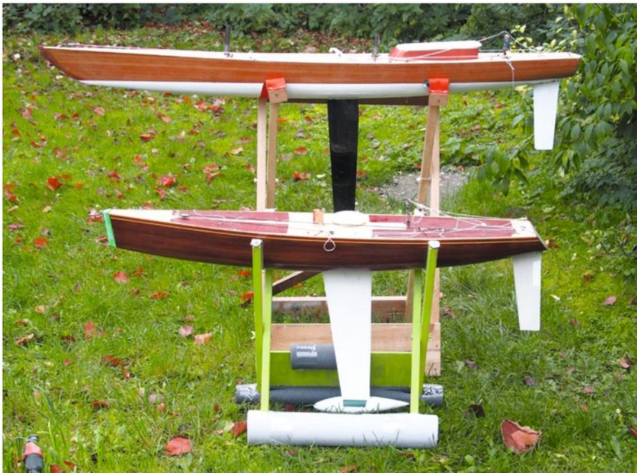
Der Vergleich zwischen Ausgangsrumpf (vorne) und neuem, modifiziertem Rumpf lässt das Konzept der in der Spannhöhe verschlankten Leichtbauweise sichtbar werden. Das Unterwasserschiff des längeren Modells ist viel flacher
