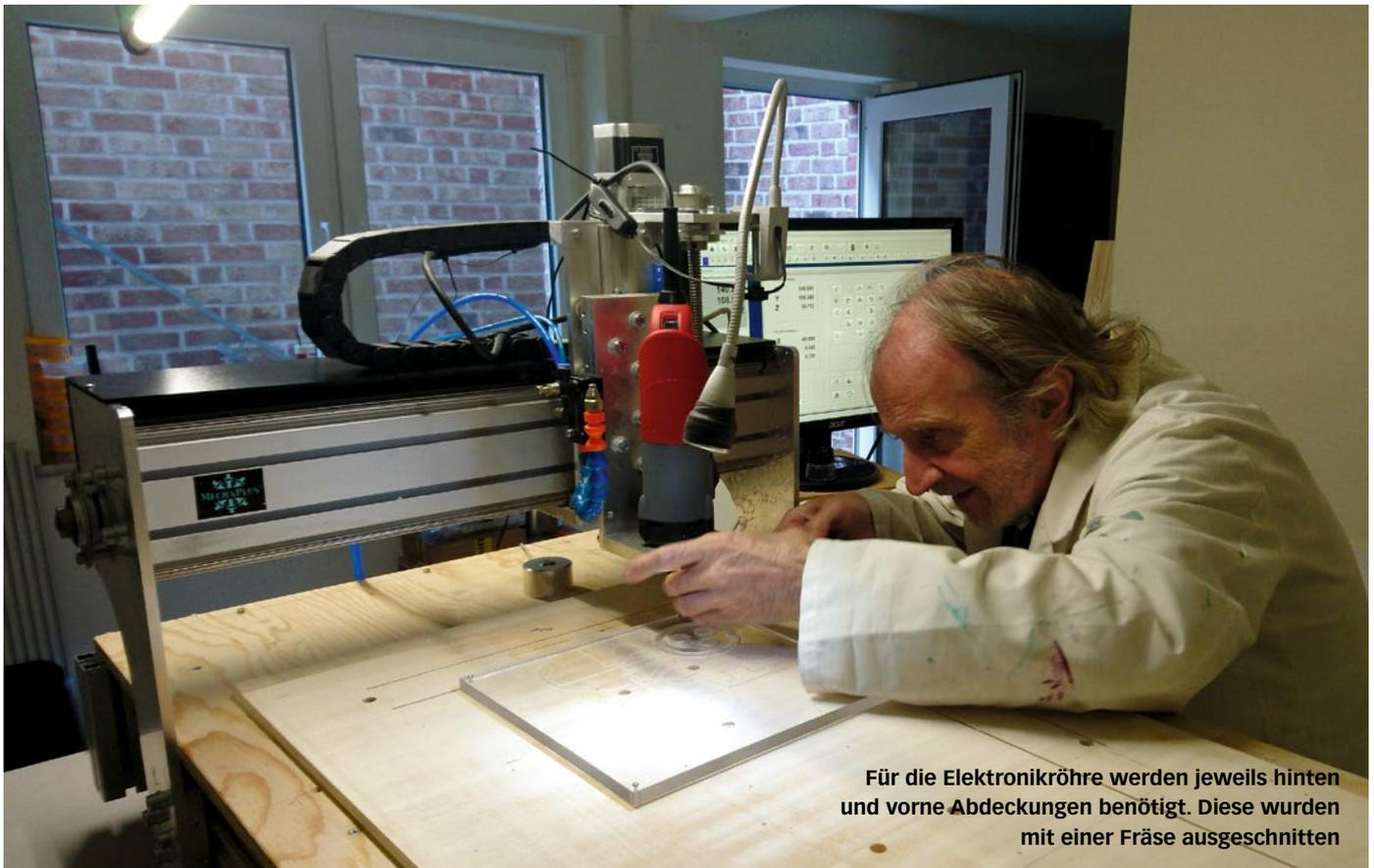
Für die Elektronikröhre werden jeweils hinten und vorne Abdeckungen benötigt. Diese wurden mit einer Fräse ausgeschnitten
