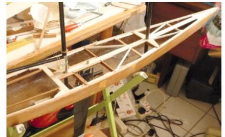
Balkweger, Kielschwein und Auflageleisten sorgen für Stabilität und bieten dem Deck sowie später eingebrachten Ösen für die Wanten Halt. Hier sind auch schon die Masten gesetzt
