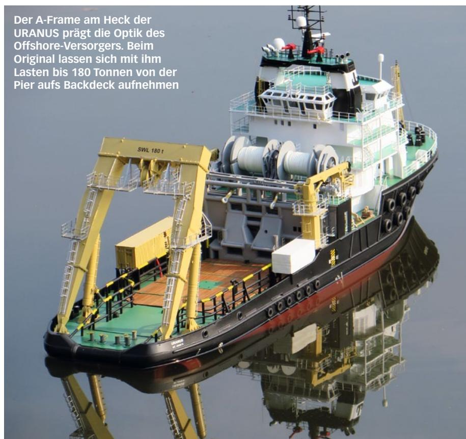
Der A-Frame am Heck der URANUS prägt die Optik des Offshore-Versorgers. Beim Original lassen sich mit ihm Lasten bis 180 Tonnen von der Pier aufs Backdeck aufnehmen
