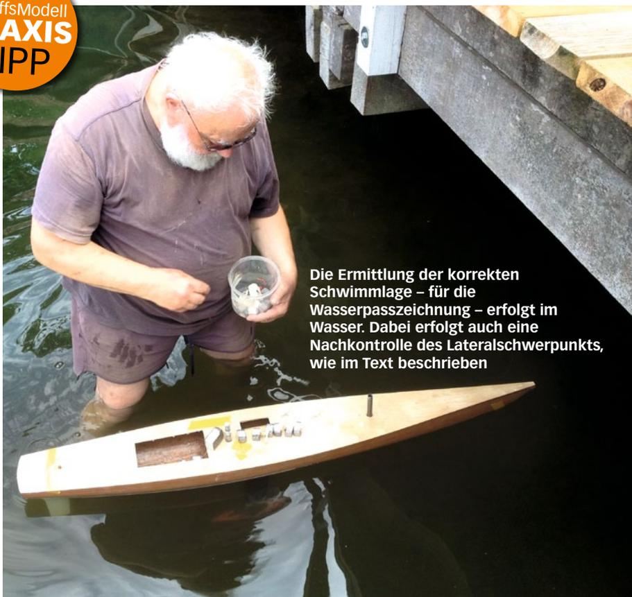
Die Ermittlung der korrekten Schwimm-lage – für die Wasserpass-zeichnung – erfolgt im Wasser. Dabei erfolgt auch eine Nachkontrolle des Lateralschwerpunkts, wie im Text beschrieben
