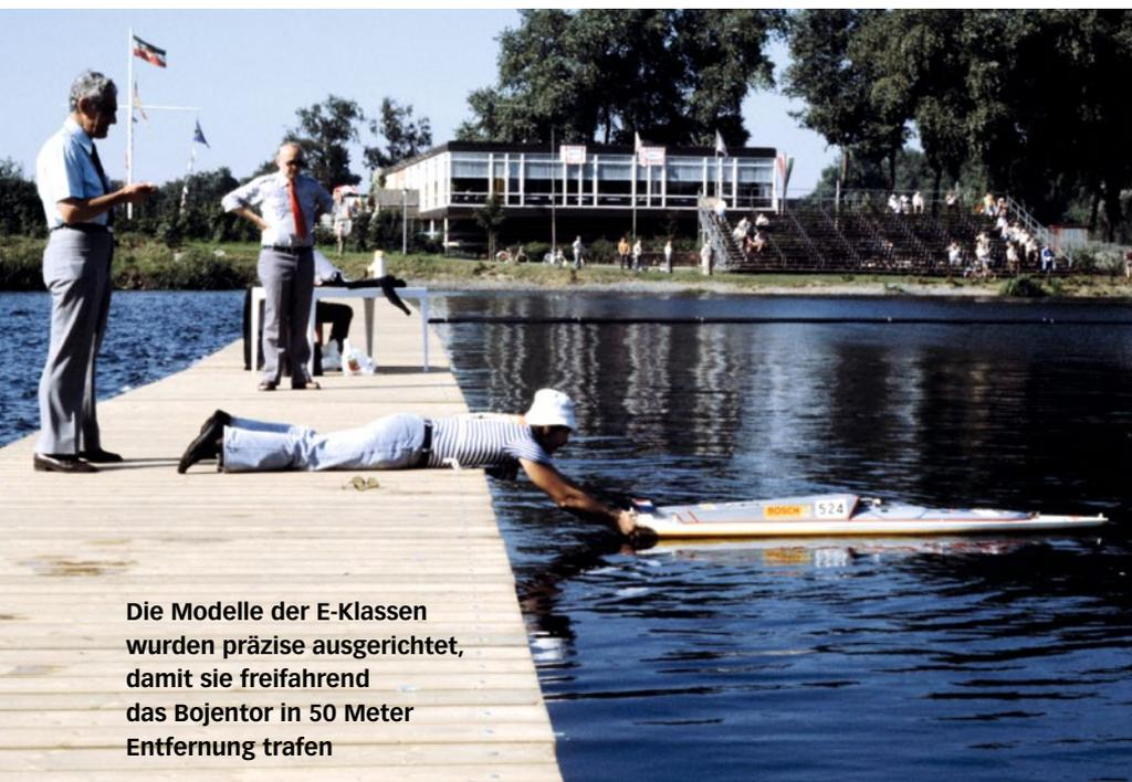
Die Modelle der E-Klassen wurden präzise ausgerichtet, damit sie freifahrend das Bojentor in 50 Meter Entfernung trafen
