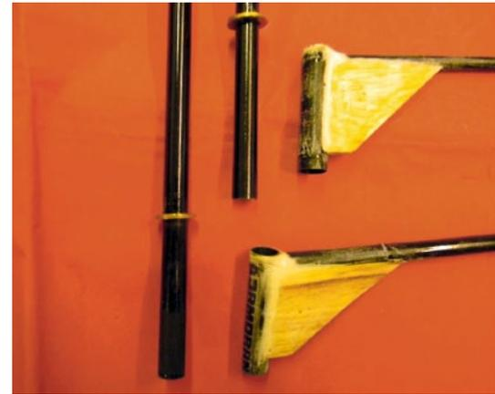
**Verstärkungsdreiecke an den Masten geben den Bäumen nicht nur Halt, sondern tragen auch das CFK-Rohr-Lager. Ein Messingring am Mast hält den Baum auf Position**
