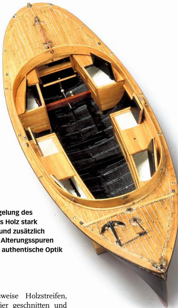
Eine Versiegelung des Holzes mit G4, das Holz stark nachdunkelt, und zusätzlich eingebrachte Alterungsspuren sorgen für eine authentische Optik
