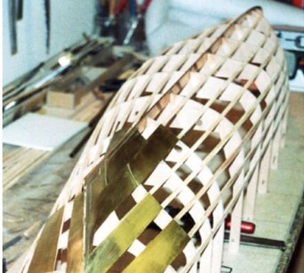
Da jede Platte exakt einzupassen und Kupfer wertvoll ist, sollte man für jede Platte zunächst ein Probestück aus Papier anfertigen und exakt zuschneiden
