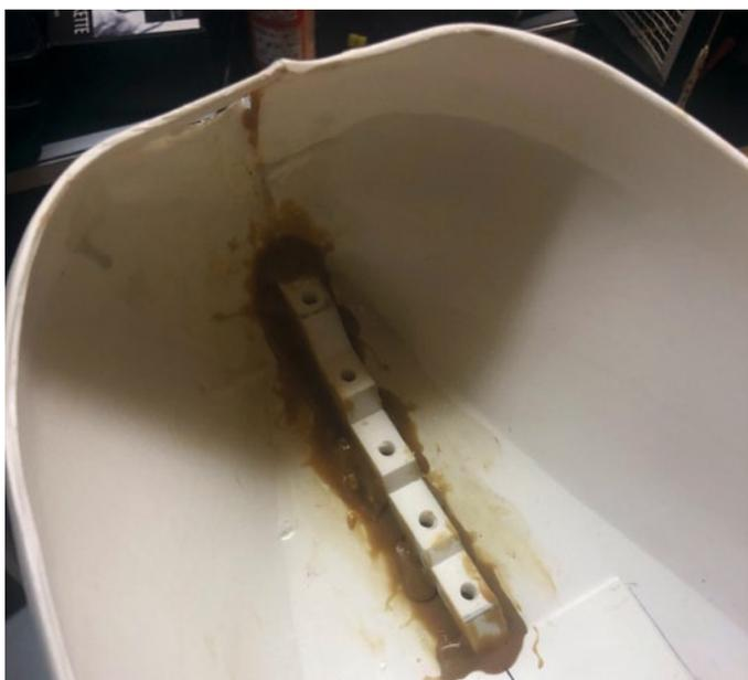
Im Rumpf ist der Sockel zur Finnen-Befestigung mit Stablit Express eingeklebt
