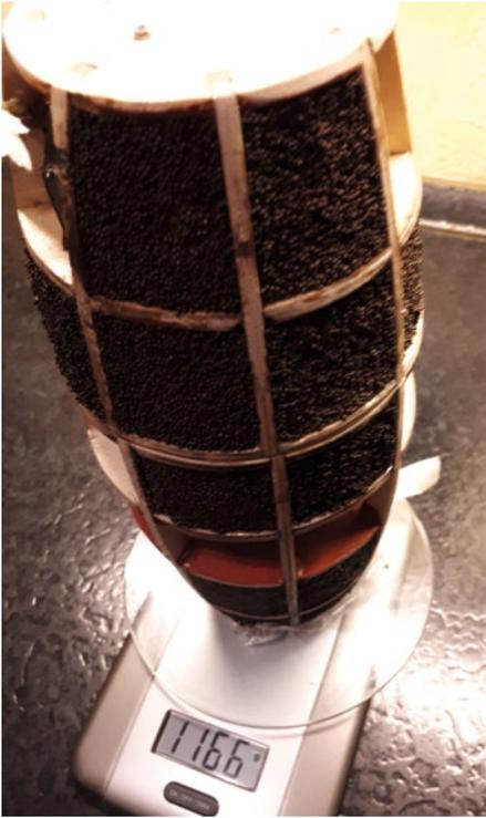
Die Spantzwischenräume wurden mit 0,6-mm-Sperrholzbrettchen verschlossen und eine „Spachtelmasse“ aus Schrot vermisch mit Holzleim in das Spantengerüst gespachtelt
