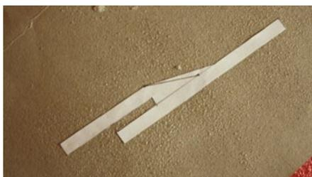
Um perfekt passende Wallschienen zur Aufnahme der Fenderleisten zu erstellen, waren zuerst Schablonen aus Papier zu entwerfen
