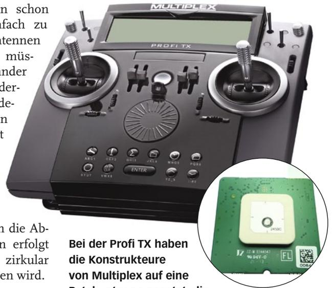
Bei der Profi TX haben die Konstrukteure von Multiplex auf eine Patchantenne gesetzt, die ausgebaut so wie abgebildet aussieht
