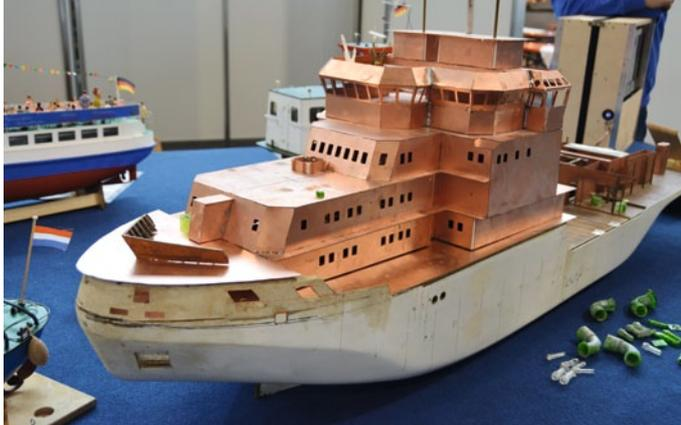
Aus dem Material FR-4 erstellter Decksaufbau – präsentiert am Stand von Schiffsmodell.net
