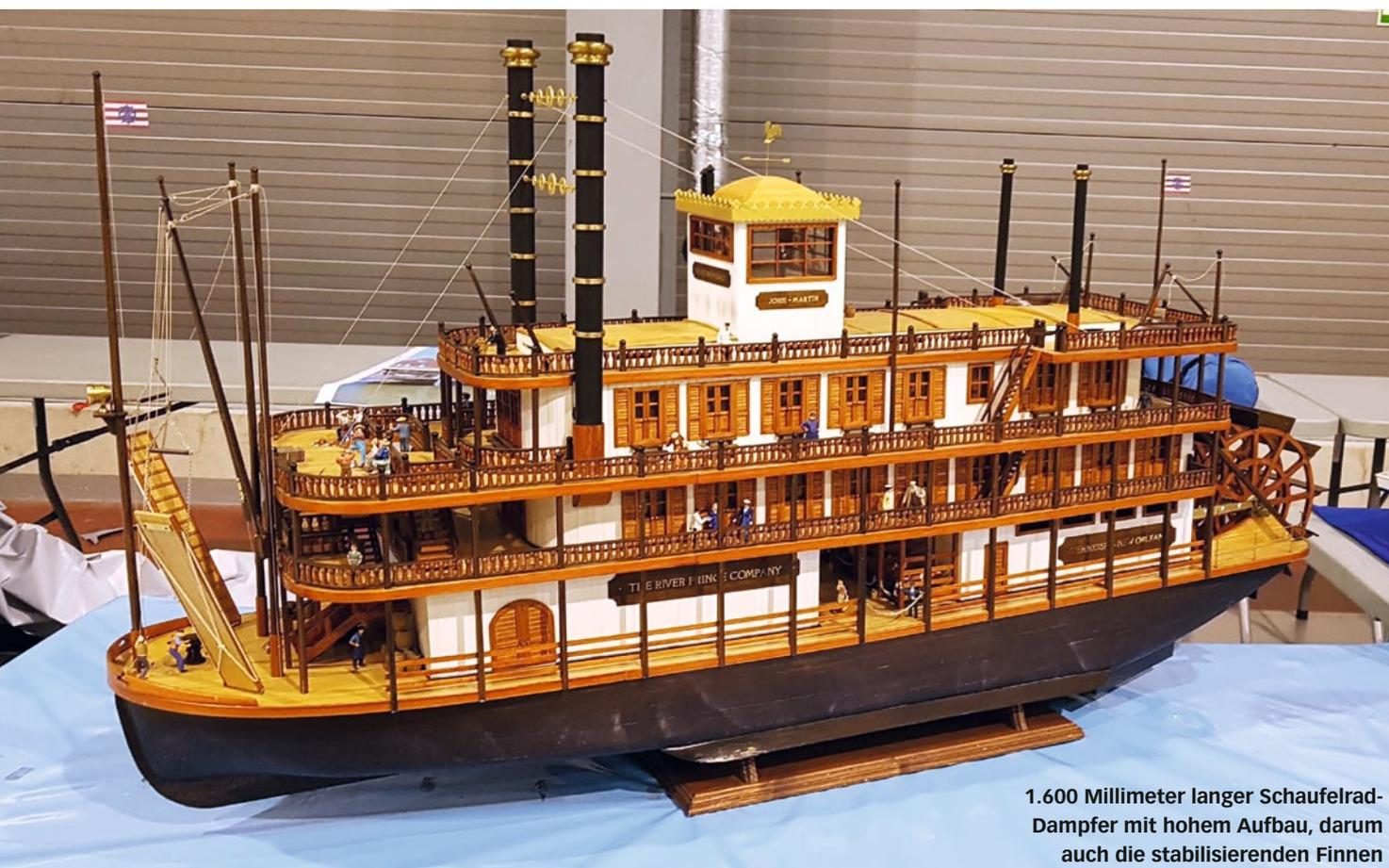
1.600 Millimeter langer Schaufelrad-Dampfer mit hohem Aufbau, darum auch die stabilisierenden Finnen
