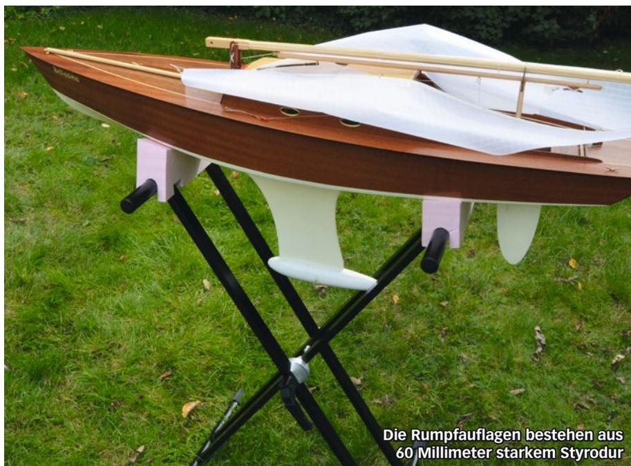
**Die Rumpfaulagen bestehen aus 60 Millimeter starkem Styrodur**
