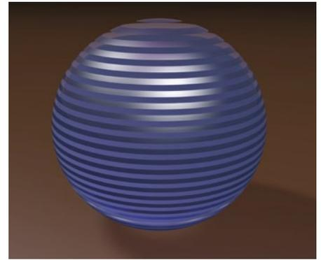
Das ist der am PC generierte Grundkörper nach dem Slicer geschnitten
