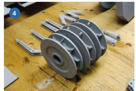
**3) Über Zahnräder erfolgt der Windenbetrieb. PVC- und Plexiglas eignen sich für die Trommeln optimal – insgesamt ist es ein bunter Materialmix. 4) Um auch Ketten ziehen zu können, wurden die großen Kettennüsse, wie sie beim Original anzutreffen sind, auch im Modell realisiert**
