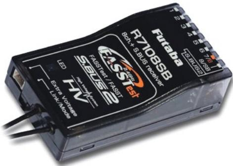
Das Besondere an diesem Empfänger für Futaba-Systeme ist, dass man dank integriertem SBus-Steckplatz insgesamt bis zu 18 Servos ansteuern kann
