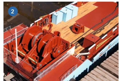
**1) Knapp fünf Kilogramm an Eigengewicht bringt die komplette und funktionsfähige Hauptwinde auf die Waage. Sie kann einen Pfahlzug bis 3.800 Gramm erreichen.**
