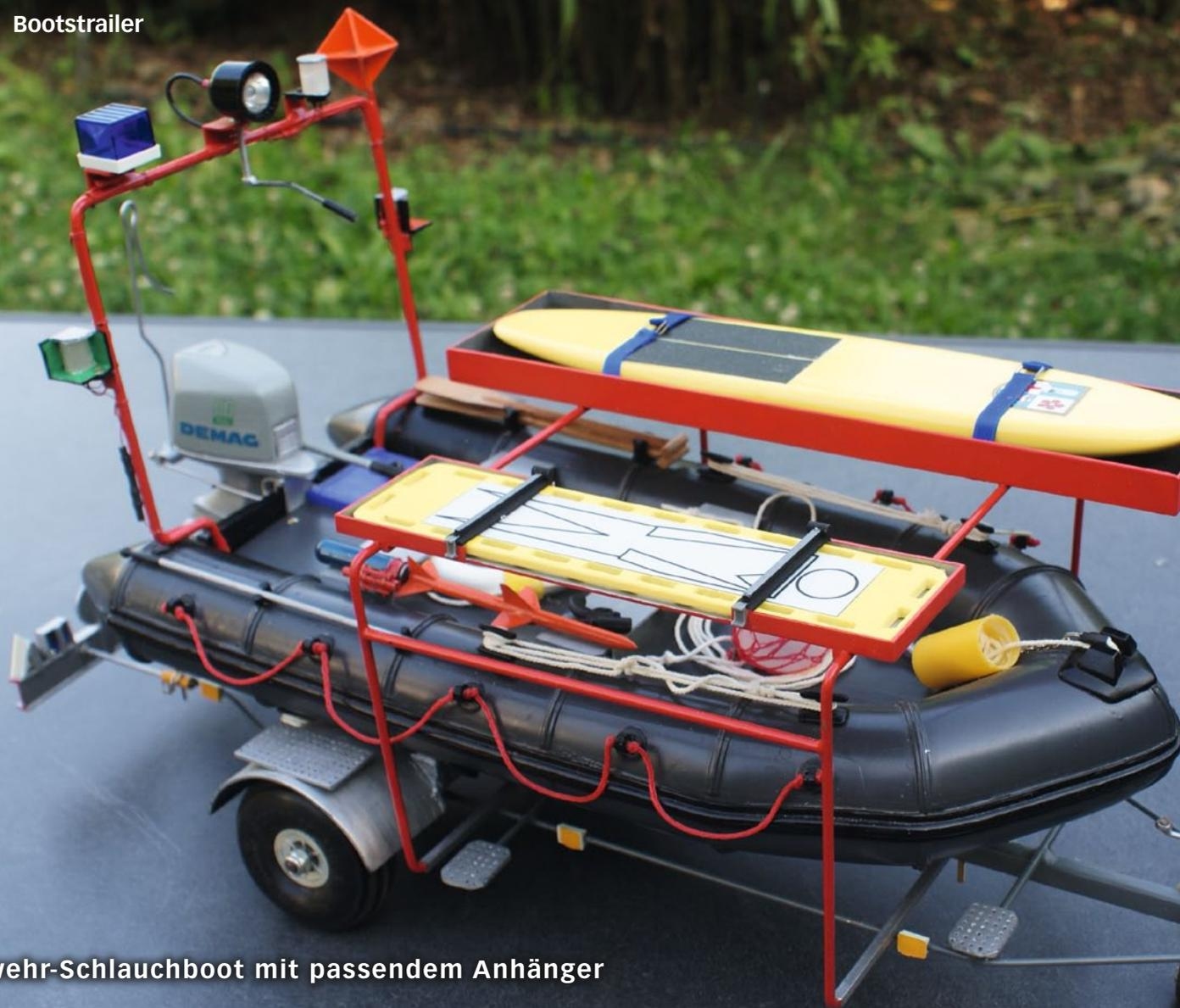
Feuerwehr-Schlauchboot mit passendem Anhänger
