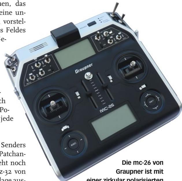
Die mc-26 von Graupner ist mit einer zirkular polarisierten Patchantenne ausgestattet – vor allem für Funktionsmodellbauer ist sie ein idealer Sender
