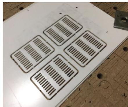
Mal nicht in 3D gedruckt, aber am PC entworfen, die Polystyrol-Teile für die Seekästenabdeckung
