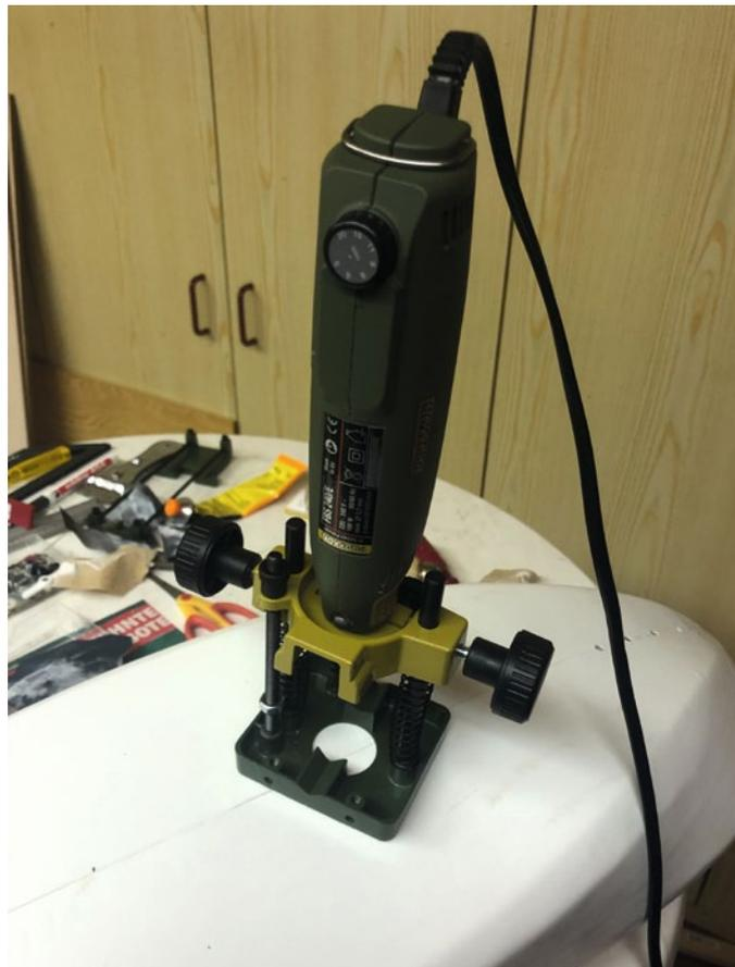
**Der Oberfräsen-Aufsatz mit Tiefenanschlag für das Proxxon-Handwerkzeug ermöglichte saubere Löcher und Ausfräsungen**
