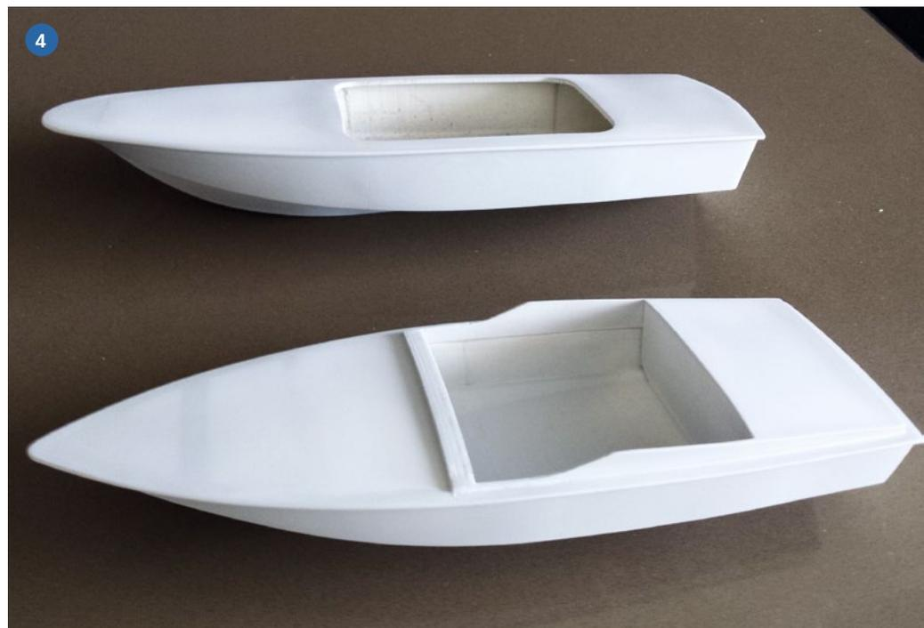
1) Süllwülste sind am Rumpf platziert. 2) Der vordere Aufbau ist fast fertig. 3) Die seitlichen Rumpftreppen können nun eingepasst werden. 4) Die Tenderboote als 3D-Druckerzeugnisse: eine CIGARETTE und eine DONZI
