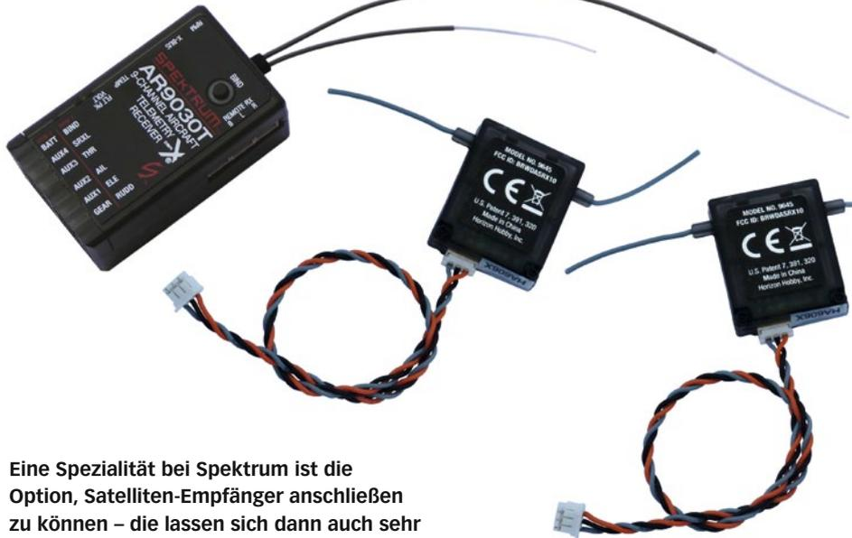
Eine Spezialität bei Spektrum ist die Option, Satelliten-Empfänger anschließen zu können – die lassen sich dann auch sehr schön oben im Modellaufbau platzieren
