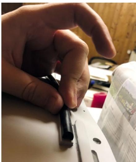
Anpassen der späteren Fenderleisten an der Wallschiene
