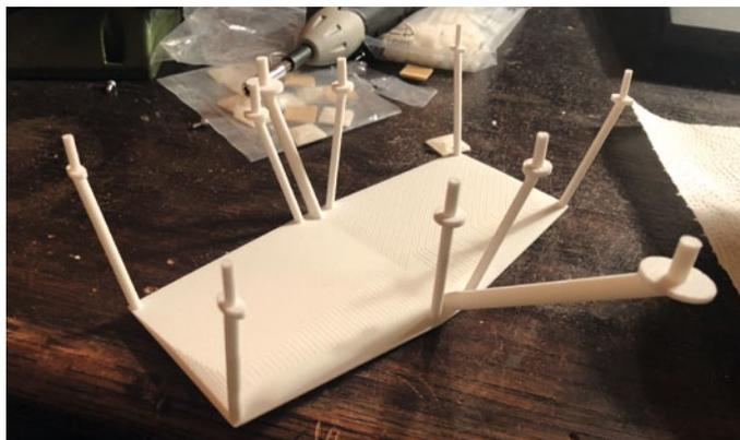
Aus Nylon bei Shapeways als 3D-Teil gedruckt ist die Schutzplatte, vor allem aber das Gestänge, sehr stabil und dennoch etwas flexibel, um nicht zu brechen
