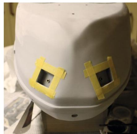
**Einpassen und Einkleben der Ankeraschen. Die Taschen selbst entstanden als 3D-Druck-Teil am PC**
