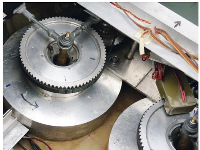
Beide Voith Schneider-Antriebe entstanden im Eigenbau. Hier ein Blick auf die Ansteuerung und den Riemenantrieb
