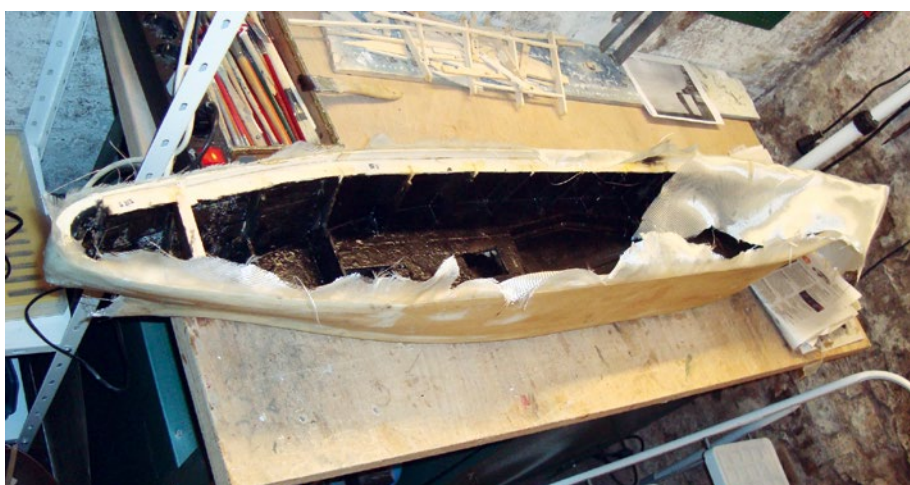
Die Außenseite des Holzrumpfs wurde mit GFK-Matte überzogen, innen wurde alles mit Epoxy wasserdicht versiegelt
