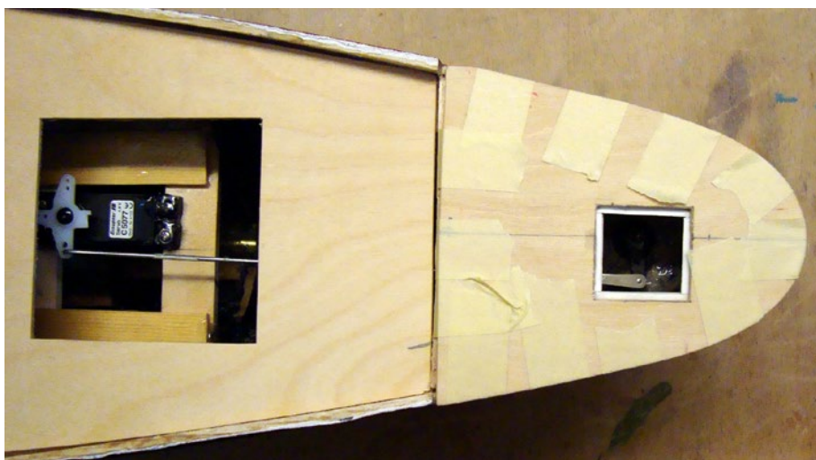
Die Ruderanlenkung am Heck ist über eine kleine Wartungsklappe zugänglich
