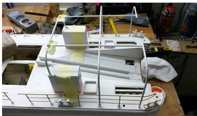
Die Trossenabweise entstanden aus mit Messing versteiften Polystyrol-Rohren – auch hier ist alles steckbar
