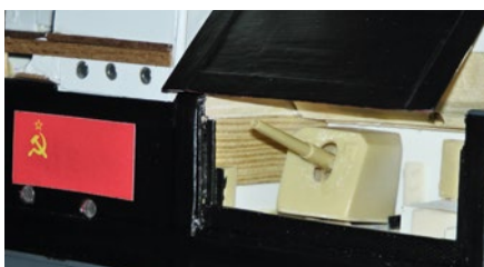
Direkt vor der Brücke sind ebenfalls 150-mm-Geschütze versteckt. Die Klappe kann per Fernsteuerung betätigt werden
