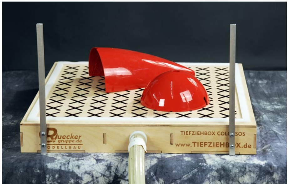
Tiefziehvorgang für die Endkappen eines U-Boot-Modells mit schwarzem Polystyrol. Da sich das Material im unteren Bereich nicht so gut anlegte, war ein weiterer Vorgang erforderlich
