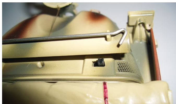
Der Ein-Aus-Schalter ist zwischen Auspuffrohr und Verdeckattrappe untergebracht. Hier stört er das Gesamtbild nicht
