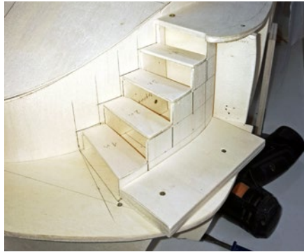
Die Treppen zur Badeplattform entstehen
