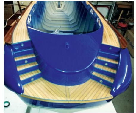
Seiten-Gangways, Treppenstufen und die Badeplattform werden beplankt
