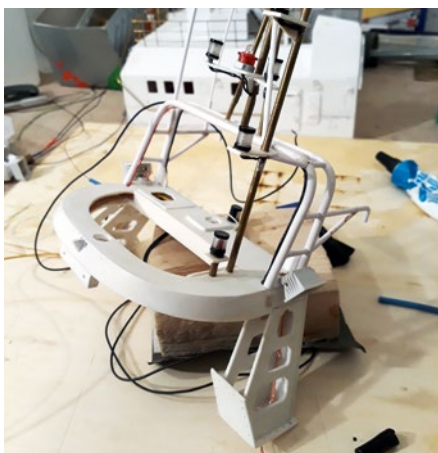
Da in den Rohren nur wenig Platz für Kabeldurchführungen ist, ist der Einsatz von Kupferlackdraht hilfreich
