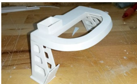
Stilprägend für die neueren Seenotretter ist der Aufbau des Masts beziehungsweise Geräteträgers. Auch hier waren stromführende Leitungen geschickt zu integrieren
