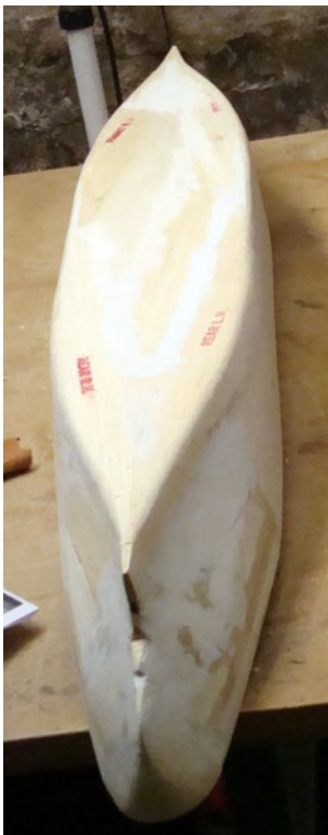
... kann alles verschliffen und verspachtelt werden
