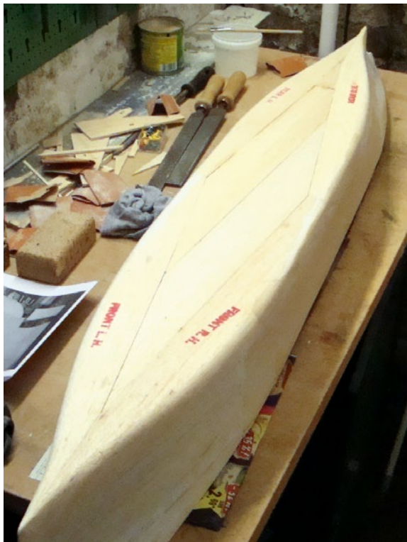
Nachdem auch der Mittelteil der unteren Beplankung angebracht ist, ...
