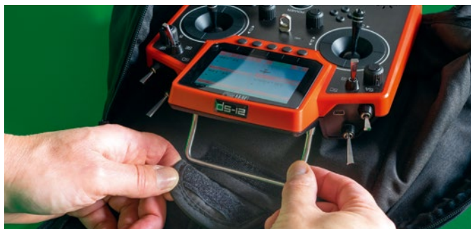
Sichert man den Tragebügel mit der Klettschleufe, hat der Sender guten Halt unter der Haube
