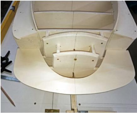
Der Heckbereich zwischen den Treppen entsteht
