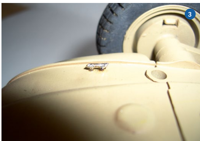
1) Damit kein Wasser in den Heckraum eindringen kann, ist die Heckklappe mit einer Dichtung ausgestattet. 2) An der rechten Unterseite des Hecks ragen die beiden Kontakte aus der Wanne heraus, welche den Stromkreis für den Schraubenantrieb bei Wasserkontakt schließen. 3) Mit diesem Stück Messingdraht, das ich auf die beiden Kontakte gelötet habe, gehören Probleme mit der Leitfähigkeit im „Wild-Wasser“-Einsatz der Vergangenheit an. 4) Rechts neben dem Torro-Aufkleber ist die Abdichtung der Antriebswelle zu sehen
