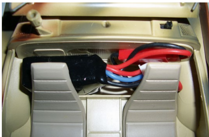
Platz für den Antriebsakku findet sich hinter den Rücksitzen. Klappt man die Verdeckattrappe wieder zurück, ist dieser jedoch nicht mehr zu sehen
