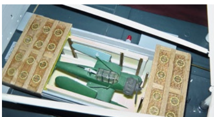
Nachdem die Flügel des Wasserflugzeugs vorbildgetreu eingeklappert sind, kann es per Hebebühne unter Deck verschwinden
