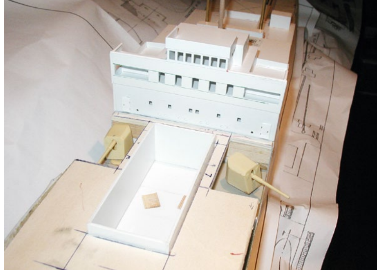
Holz und hauptsächlich Polystyrol waren die Materialien der Wahl für die Decksaufbauten
