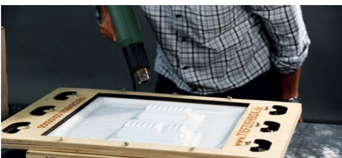
Tiefziehen mit Polystyrol gelingt mit etwas Übung gut. Bei kleinen Falten kann man mit dem Heißlüfter vorsichtig nachhelfen
