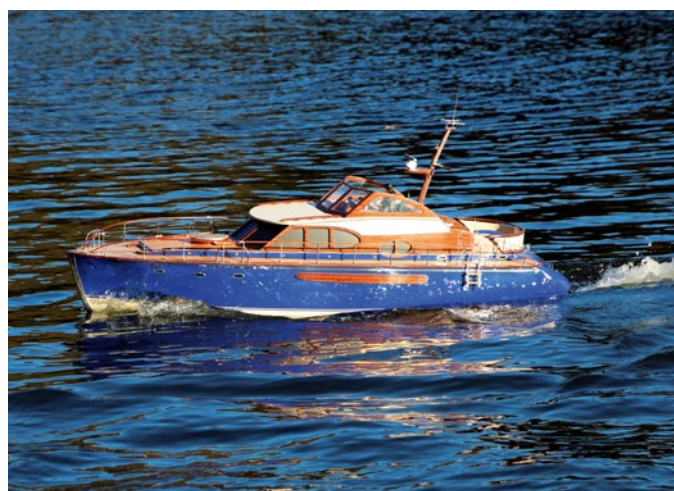
Die beiden Brushlessmotoren mit den Fünfblatt-Propellern sorgen an 4s-LiPos für ein absolut vorbildgetreues Fahrbild
