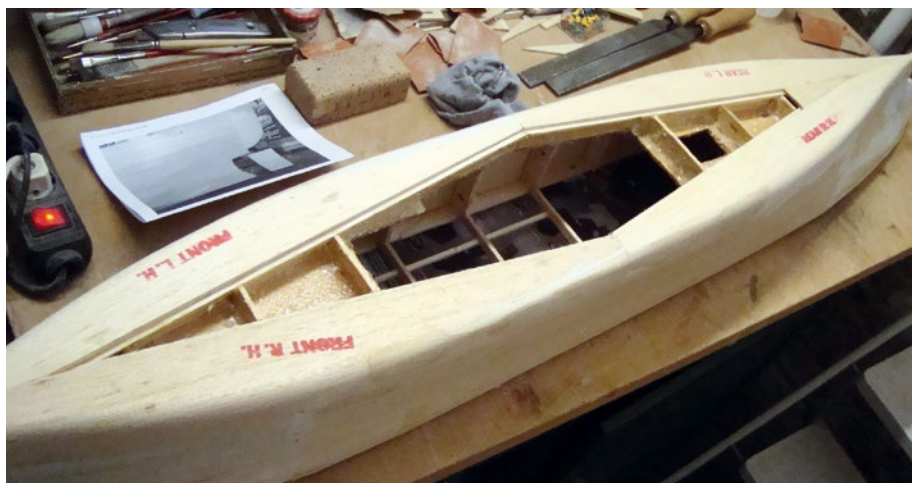
In den Randbereichen ist die untere Rumpfbeplankung deutlich dicker, damit man sie gut verschleifen kann
