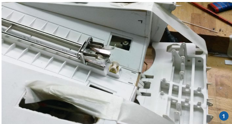
1) Über den Schlitten und der Aufnahme kann das Tochterboot gewässert und aufgenommen werden. Viel Arbeit machte der funktionsfähige Einbau der Heckklappe. 2) Eine Seilwinde steuert den Schlitten zur Tochterbootaufnahme. Zugänglich ist diese über Luken, die mit Fotokleber dicht, jedoch wartungsfreundlich verklebt sind
