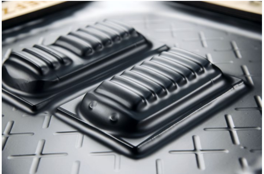
Tiefziehvorgang für Lüfter mit schwarzem Polystyrol
