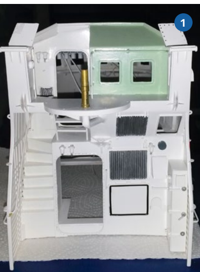
1) Da ein funktionsfähiger Löschmonitor aufs Modell sollte, war das beim Aufbau zu bedenken. Knifflig waren auch die Einzelteile für den integrierten Niedergang. 2) Kästen, Halter, Scharniere, Luke, Knotenbleche, Rundverstrebungen, Verstärkungen und vieles mehr kennzeichnen den Nachbau. 3) Vor allem die Fülle an Schiffsdetails machen den Seenotretter zum Hingucker. Die Rohre sind aus Polystyrol. 4) Gründliches Abkleben ist das wichtigste beim Lackieren
