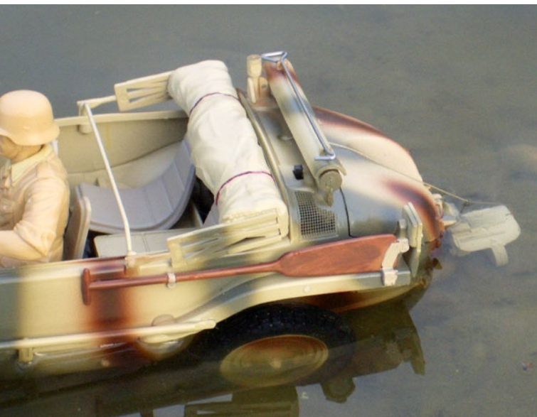
Die Technik funktioniert im Grunde so, wie es sein soll. Mit einer Kontaktbrücke auf den ins Wasser ragenden Kontaktstiften und der Einstellung „H“ (= High) am Geschwindigkeitsschalter des Schraubenantriebs fährt das Modell vorbildgetreu
