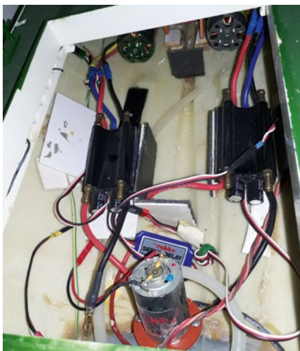
Zwei Brushless-Motoren, gesteuert von zwei Reglern, sorgen, angeschlossen an einem 2s-LiPo, für übermäßige Power
