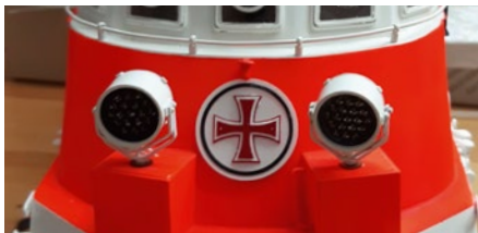
Beide Suchscheinwerfer sind mit hellen LEDs ausgestattet und beweglich gelagert, jedoch (noch) nicht angesteuert
