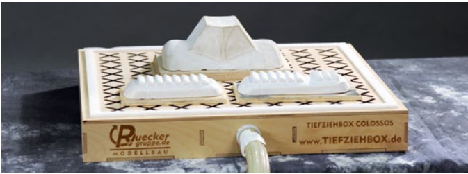
Die Ur-Formen, die tiefgezogen werden sollen, liegen mit etwas Auflage auf dem Vakuumkasten
