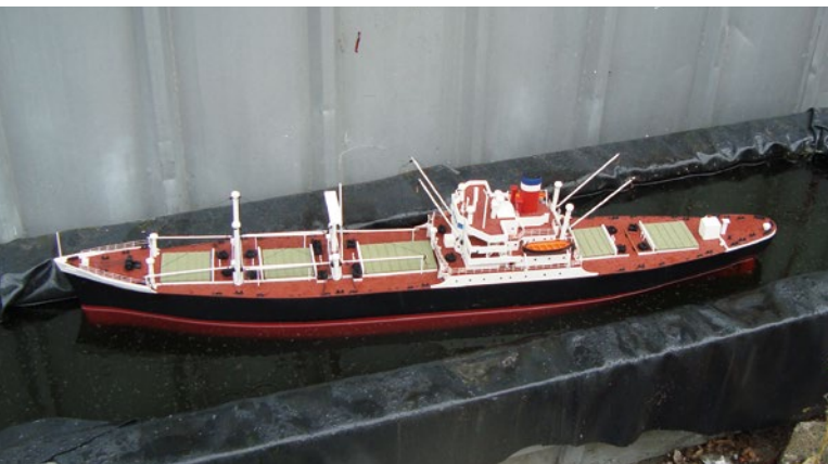
Beim ersten Trimmtest stellt sich heraus, dass rund 3 kg Blei benötigt werden
