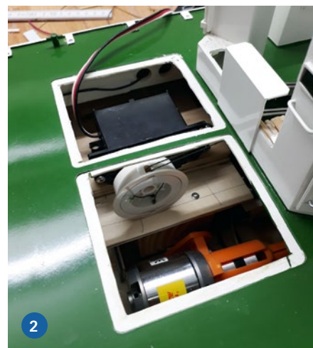
1) Über den Schlitten und der Aufnahme kann das Tochterboot gewässert und aufgenommen werden. Viel Arbeit machte der funktionsfähige Einbau der Heckklappe. 2) Eine Seilwinde steuert den Schlitten zur Tochterbootaufnahme. Zugänglich ist diese über Luken, die mit Fotokleber dicht, jedoch wartungsfreundlich verklebt sind
