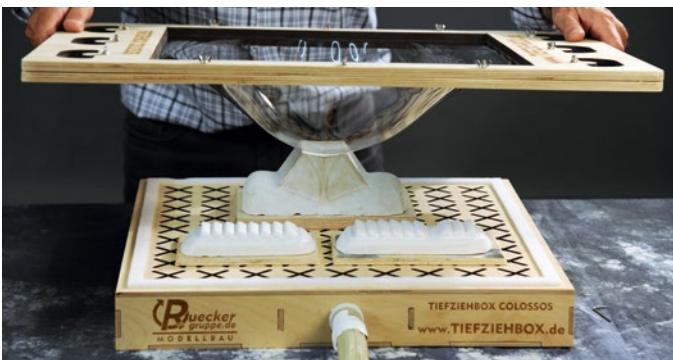
Vor dem Auflegen der erwärmten Platte unbedingt den Sauger am Vakuumtisch einschalten
