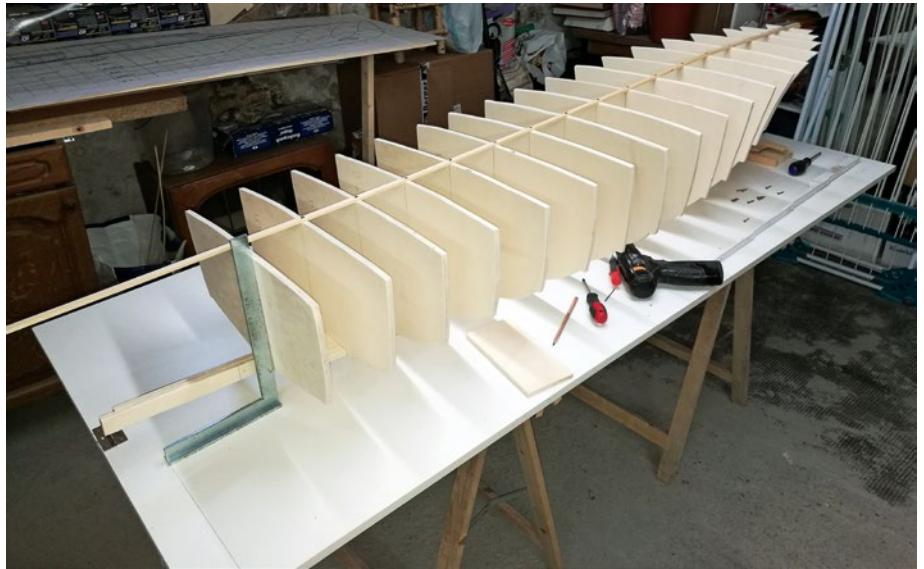
Mit jedem einzelnen Spant wächst der Rumpf
