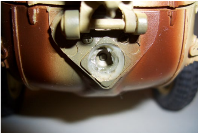
In diese gut gefettete Wellenbuchse rastet der Schraubenantrieb nach dem Absenken ein
