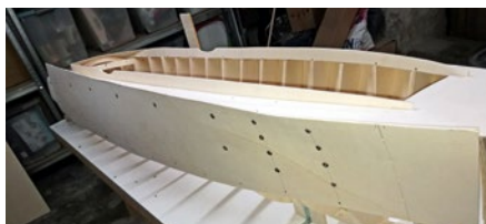
Die Seitenwände wurden beplankt
