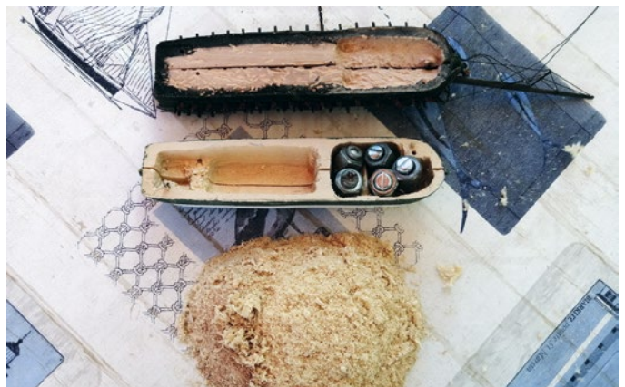
Eine Menge Holz musste aus dem Rumpf, um im Heck Gewicht einzusparen und im Bug Platz zu schaffen für Ballast
