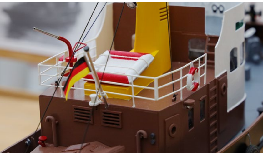
Die Rettungsinsel ist mit einer Angelschnur versehen und schwimmt im Falle eines Untergehens auf, um die Position des Schiffs zu markieren
