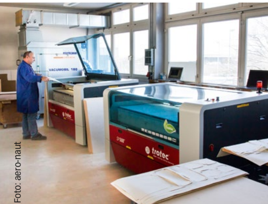
Die modernen Laser-Schneidmaschinen lasern die Einzelteile des BULLSEYE mit höchster Präzision und Passgenauigkeit
