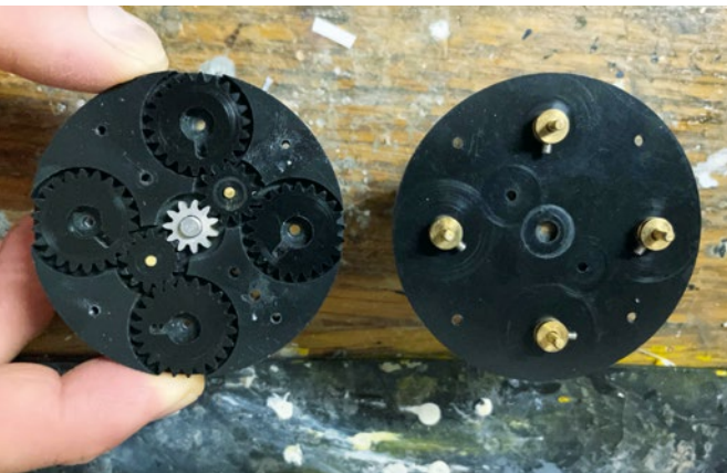
Das Innenleben der Propellerscheiben, das für die Verstellung der Propellerblätter zuständig ist
