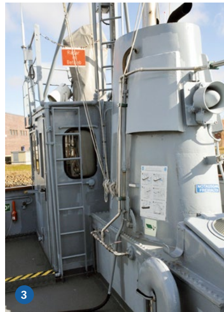
1) Wie sich das gehört, ist an Bord natürlich eine entsprechend signierte Glocke. 2) Blick auf einen Teil der Druckluft-Steuerelemente. 3) Aufbau B-Deck mit Schornstein und Dieseltanks. Dass sich letztere oberhalb befinden, ist schon sehr speziell
