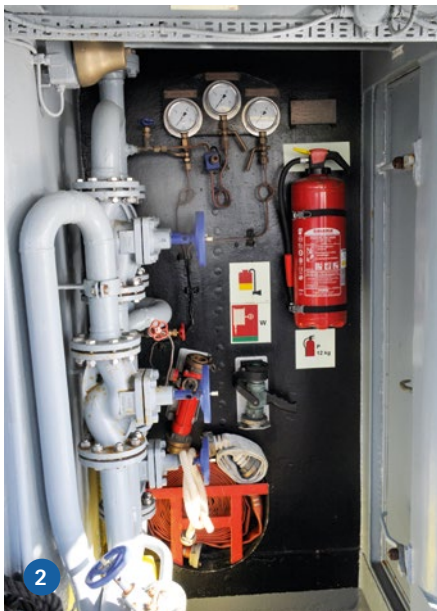
1) Wie sich das gehört, ist an Bord natürlich eine entsprechend signierte Glocke. 2) Blick auf einen Teil der Druckluft-Steuerelemente. 3) Aufbau B-Deck mit Schornstein und Dieseltanks. Dass sich letztere oberhalb befinden, ist schon sehr speziell
