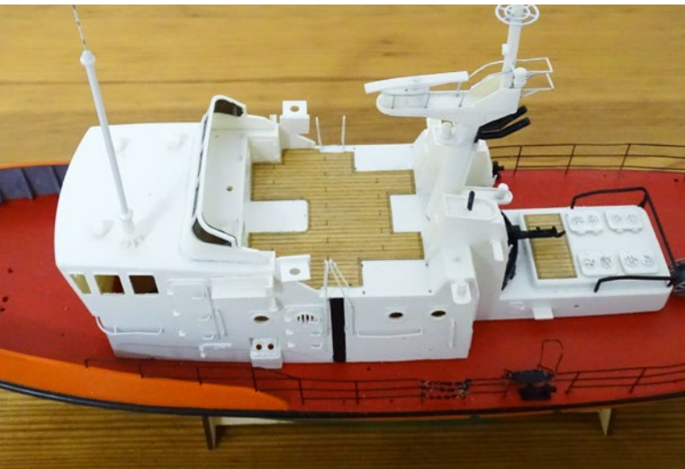
Der Aufbau ist weiß lackiert, mit schwarzen Akzenten versehen und mit vorgefertigten Holzteilen beplankt
