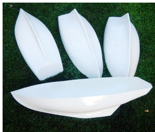
Die ersten ABS-Rümpfe liegen grob besäumt zum Ausbau bereit
