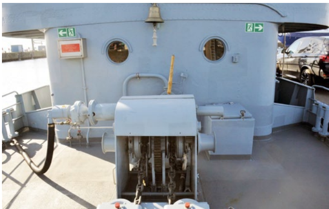
Zu einer der vielen Raritäten auf der BUMS zählt die druckluftbetriebene Ankerwinde
