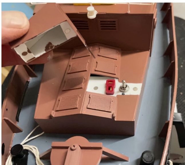
Die Ladebuchse und der Schalter sind gut versteckt, aber dennoch leicht zugänglich platziert
