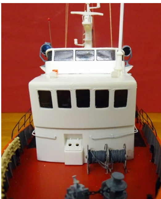
Die gebogene Scheibe des Oberdecks wurde mit Hilfe eines Holzteils und Hitze in Form gebracht
