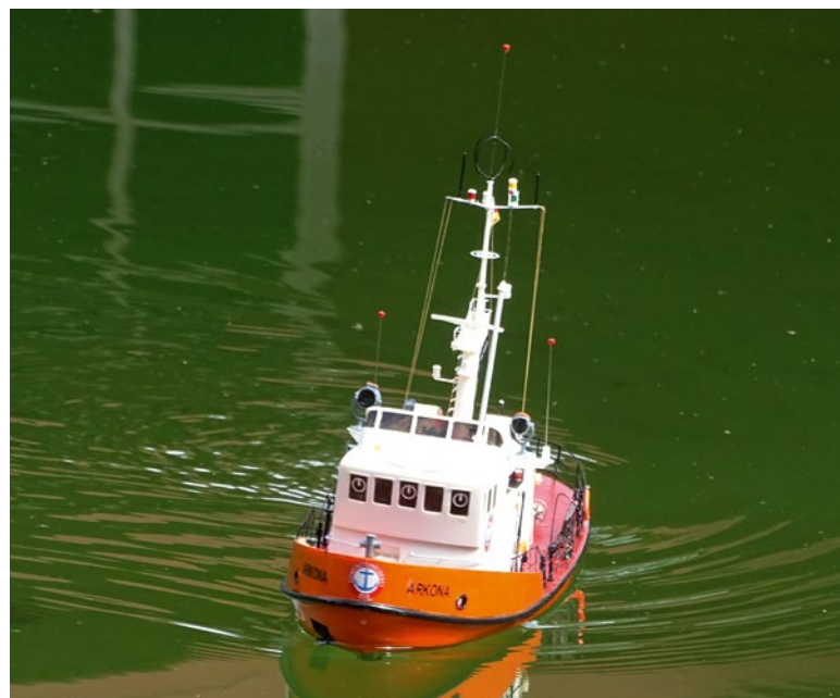
Mit den beiden Bürstenmotoren und einem 2s-LiPo-Akku ist die ARKONA vorbildgetreu motorisiert
