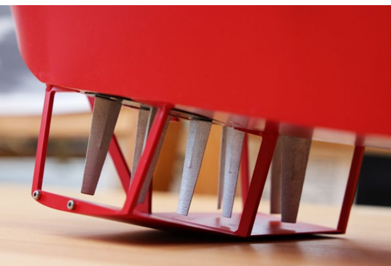
Es könnte auf den ersten Blick auch ein Voith-Schneider-Antrieb sein, jedoch handelt es sich um Kirsten-Boeing-Propeller
