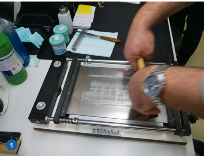
1) Die Platinen werden mit Zinnpaste beschichtet. 2) Qualitätskontrolle: Sauberes Arbeiten ist gerade bei den Platinen wichtig. Stimmt die Grundlage nicht, führt das später zu Fehlern
