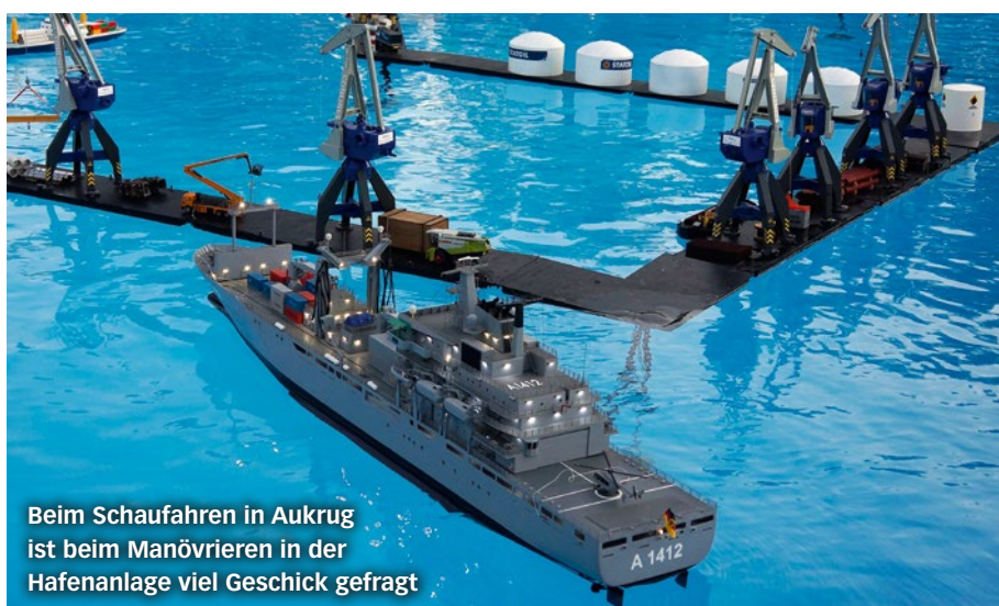
Gut zu erkennen ist hier die Darstellung des rutschfesten Decksbelags durch die Verwendung von sehr feinem Sand
