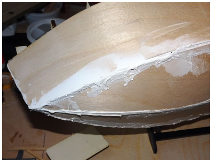
Nach dem Aufbringen der seitlichen Beplankungen werden die Stoßkanten verspachtelt und verschliffen
