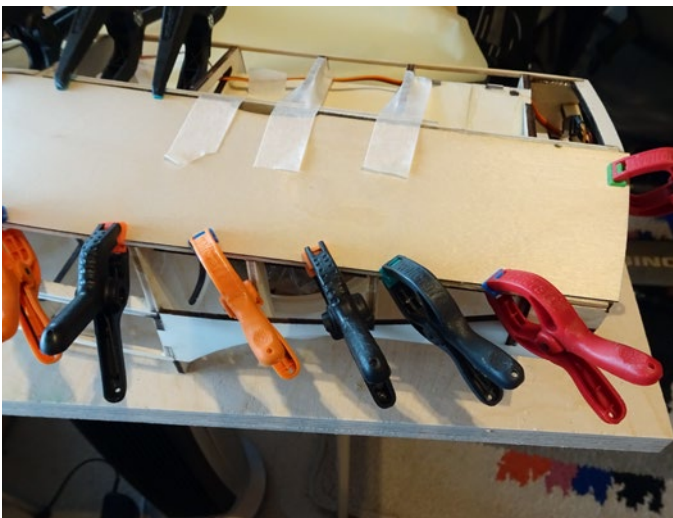
Die erste Rumpfbeplankung wird mit Klammern und Klebeband fixiert
