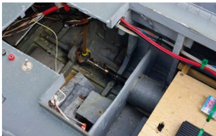
Die beiden Bühler Starmix-Motoren sorgen bei so einem großen Modell für den nötigen Vortrieb
