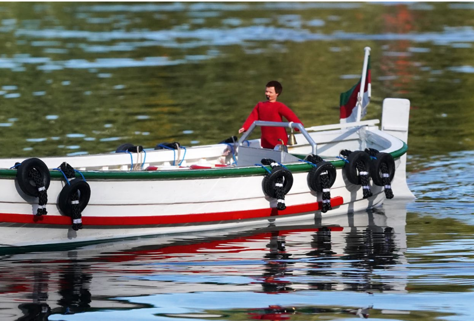
Damit der Kapitän beim Steuern nicht ständig übers Deck huscht, ist die Pinne vom Ruder getrennt
