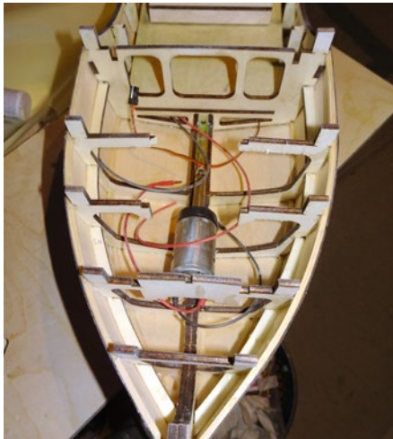
Das offene Spantengerüst mit vorbereiteter Verkabelung
