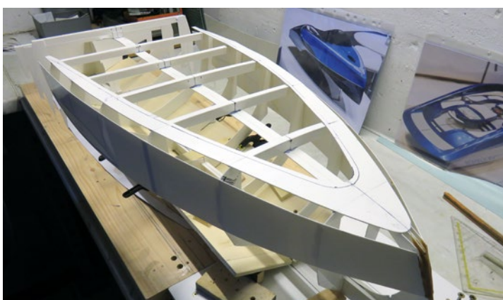
Die Beplankung des Rumpfs wurde jeweils probenhalber aus Pappe geschnitten und dann ebenfalls auf 1 mm starkes ABS übertragen
