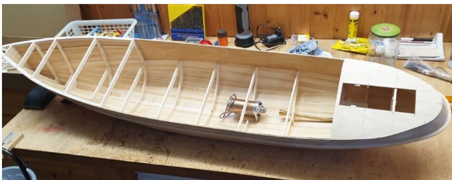
Der Rumpf ist außen und innen mit Ein-Komponenten-Epoxydharz behandelt und nun fertig für die Einbauten
