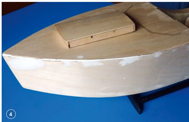
3) Das Heck der ESTRELLJA noch ohne Lack mit der Rückbank und dem Deckel des Lenkservos. Es fehlen noch die Seitenwände der Plicht. 4) Wie gut die gelaserten Teile passen, sieht man an wenigen Spachtelstellen, die nach dem Verschleifen geblieben sind
