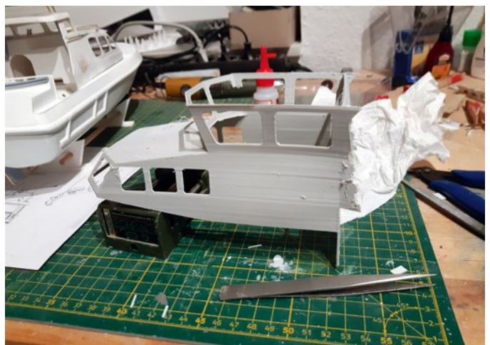
Der fertig gedruckte Aufbau muss noch bearbeitet werden
