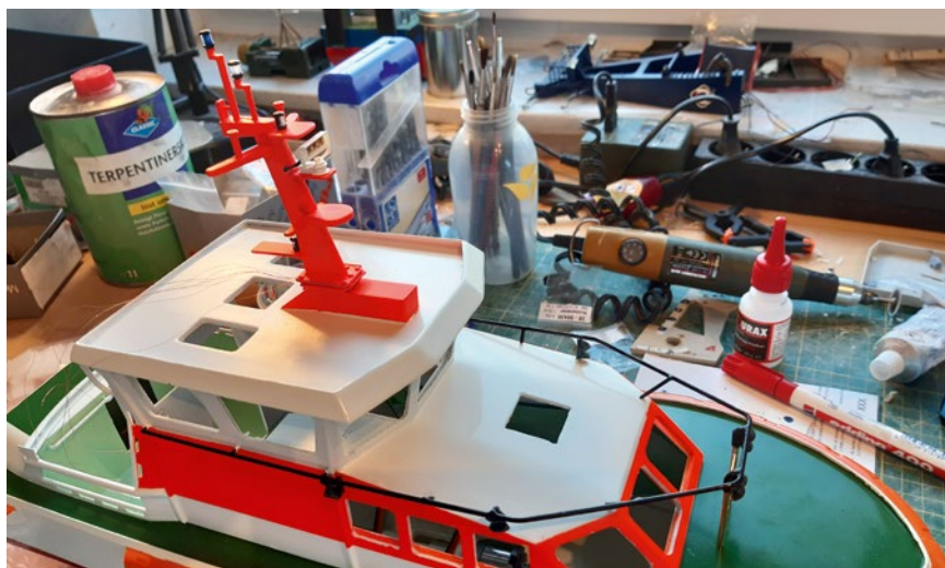
Auch in den Laternen und Scheinwerfern am Mast sind SMD eingebaut
