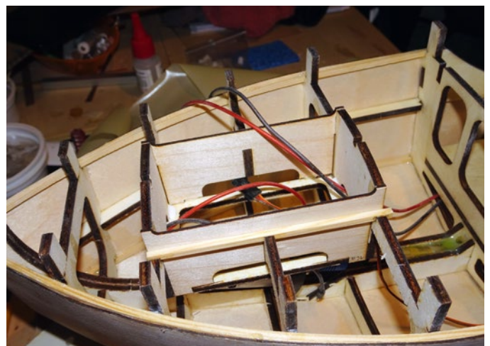
Diese Box unter dem Oberlicht nimmt später den Empfänger und den Regler auf. Daher liegen auch schon alle Kabel an Ort und Stelle
