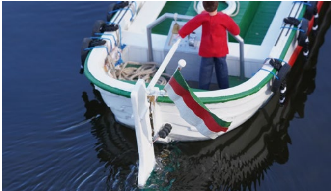
Damit der Kapitän beim Steuern nicht ständig übers Deck huscht, ist die Pinne vom Ruder getrennt
