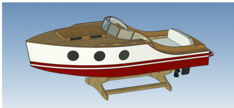
Die ESTRELLJA hat die Form eines klassischen Backdeckers: Langgezogene Back bis mittschiffs, einen geraden Vorsteven, eine schlanke Rumpfform und ein senkrechtes Spiegelheck
