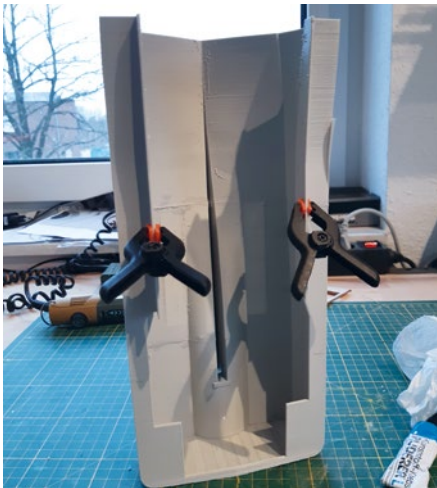
Der Rumpf besteht aus vier Sektionen, die verklebt wurden
