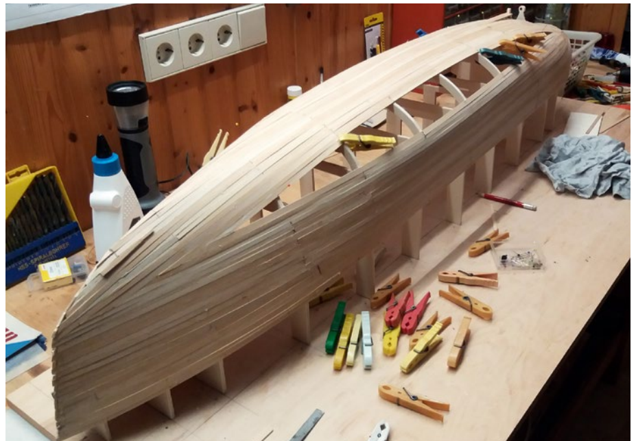
Durch das Beplanken mit 2-mm-Lindenleisten schließt sich der Rumpf Stück für Stück
