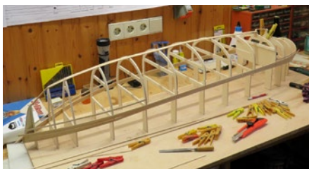
Das Spantengerüst ist komplett und fertig zum Beplanken
