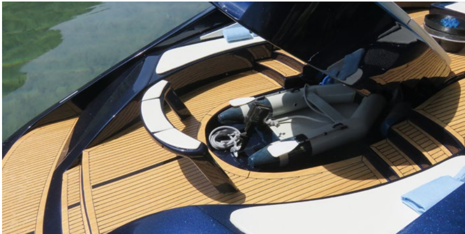
Die Holzdecks bestehen aus Holzfolie mit aufgemalter Kalfaterung. Unter der Liegefläche, die ferngesteuert geöffnet werden kann, befindet sich der Tender, ein Eigenbau-Schlauchboot
