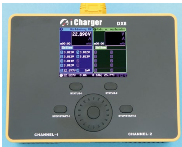
Das Display liegt gut im Blickfeld und lässt sich unter allen Blickwinkeln gut ablesen, die Bedienelemente sind übersichtlich angeordnet
