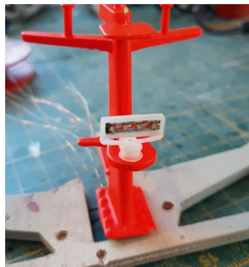
Im Suchscheinwerfer wurden vier LEDs verbaut
