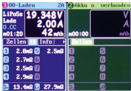
Auf Anforderung werden die Innenwiderstände der Zellen wiedergegeben
