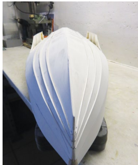
Nachdem der Rumpf fertig geschliffen war, wurden die Gleitleisten aus ABS angebracht
