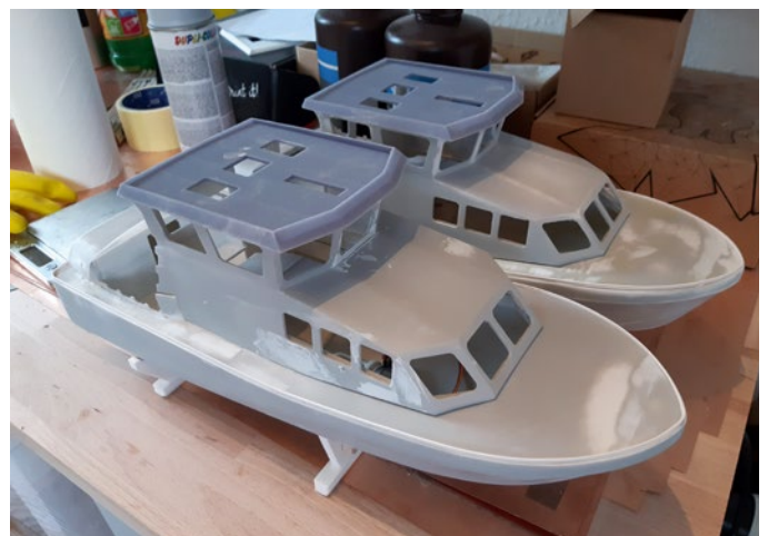
Schleif- und Spachtelarbeiten sind erledigt, nun können die Geschwister lackiert werden
