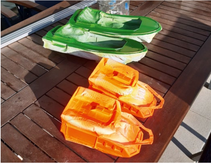
Sorgfältiges Abkleben ergibt saubere Farbübergänge und sorgt für einen gelungenen Gesamteindruck
