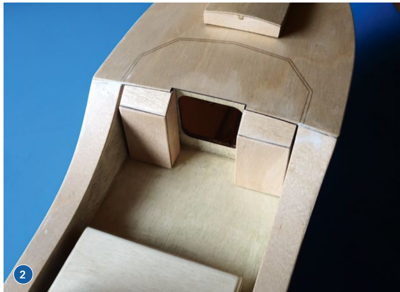
1) Kürzer und knackiger kann eine Ruderanlenkung nicht sein. 2) Diese beiden Konsolen bilden später zusammen mit einem Mittelteil die vordere Wand der Plicht. Auf dem Backdeck sind die gelaserten Linien für die Frontscheiben zu erkennen
