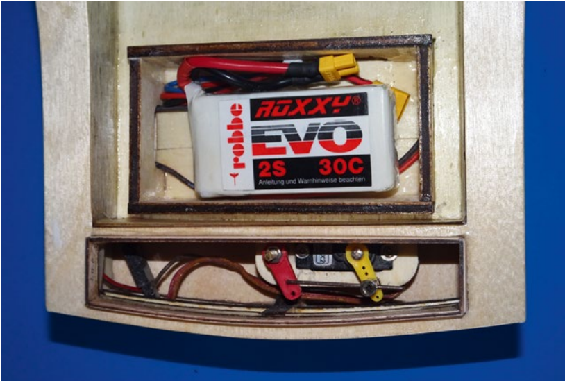
Der 2s-LiPo mit 1.250 mAh Kapazität passt perfekt unter die Sitzbank
