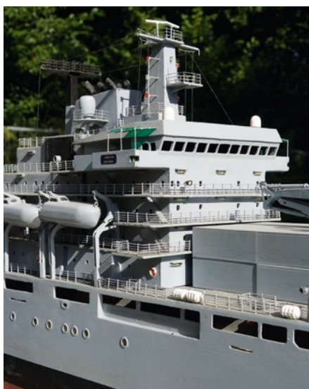
Die vielen Fensteröffnungen der Aufbauten erfordern exaktes Arbeiten beim Aussägen
