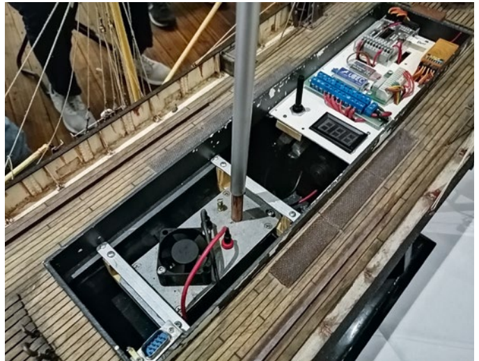
Das Innenleben der BOSTON TYPHOON. Vorne befindet sich der Rauchgenerator, hinten die Schaltzentrale
