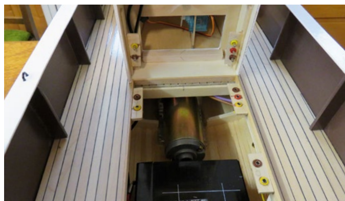
Die elektrische Verbindung zwischen Rumpf und Aufbau wurde mit Ministeckern realisiert
