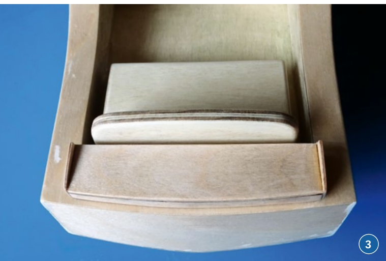
3) Das Heck der ESTRELLJA noch ohne Lack mit der Rückbank und dem Deckel des Lenkservos. Es fehlen noch die Seitenwände der Plicht. 4) Wie gut die gelaserten Teile passen, sieht man an wenigen Spachtelstellen, die nach dem Verschleifen geblieben sind
