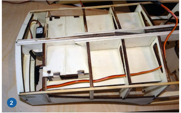
1) Die Stringer am Rumpfboden haben reichlich Spannung und müssen daher von einer resoluten Klammer gehalten werden, während der Kleber trocknet. 2) Das Spantengerüst im Heckbereich. Gut zu erkennen sind der Boden der Plicht und auch der Boden des Akkuraums. Vorsichtshalber wird jetzt schon das Verlängerungskabel zum Lenkservo eingezogen. Das Lenkservo ist ebenfalls schon installiert
