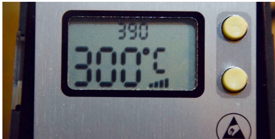
In der obersten Zeile wird die Soll- und darunter die Ist-Temperatur angezeigt
