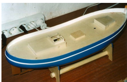
Das Original Deck wurde gegen ein durchgängiges Sperrholzdeck ausgetauscht und später beplankt
