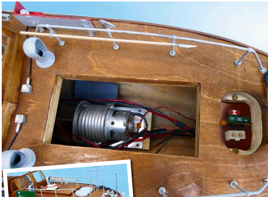
Vorschiff mit kompletter Ausrüstung. Unter der vorderen Luke und dem großen Deckel verbergen sich je ein Zugang zum Antriebsmotor und Ein-Aus-Schalter
