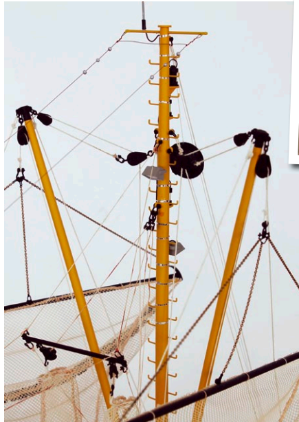
Selbstgebaute Schäkkel sorgen für Authentizität bei Verbindungen von Seilen, Blöcken, Kettengliedern und vielem mehr
