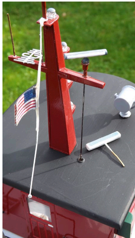
Der Radarballen auf dem rechten Ausleger wird durch einen dünnen Draht angetrieben, der zu einem Motor im Inneren des Modells führt
