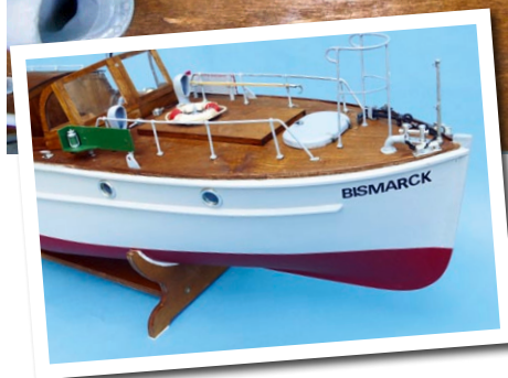
Vorschiff mit kompletter Ausrüstung. Unter der vorderen Luke und dem großen Deckel verbergen sich je ein Zugang zum Antriebsmotor und Ein-Aus-Schalter
