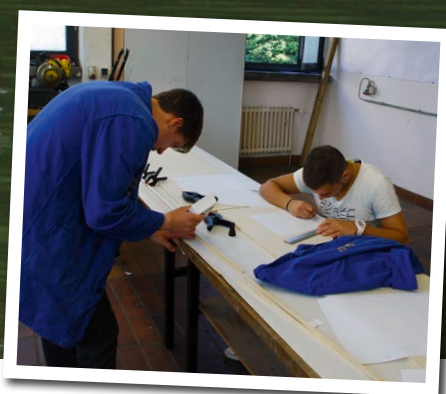
Mit dem Übertragen der Spantenrisse auf Pappelsperrholz und dem Anzeichnen der Spantposition auf der Drei-Meter-Helling geht es los
