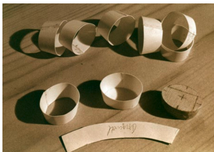
Von einer Holz-Urform auf dünnes Polystyrol übertragene Wände-Abwicklungen gestatten den Bau von Bottichen
