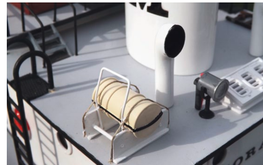
Die Rettungsinsel war bereits vorhanden, wurde jedoch noch mit einem Abwurfbügel und zwei Versteifungsrohren versehen
