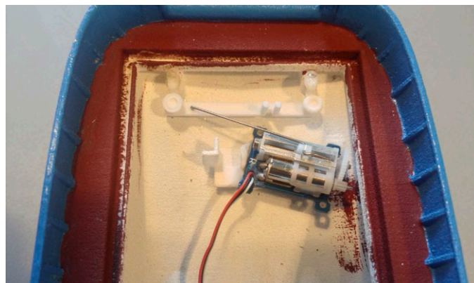
Das flache Linearservo stammt aus der UMX-Serie von Spektrum und wiegt knapp 1,5 Gramm
