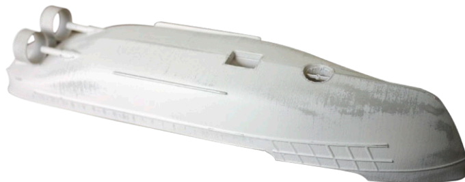
Spachteln und schleifen des Rumpfs – da dieser aufgrund seiner Größe nicht poliert werden kann, hat er eine recht raue Struktur und muss nachbearbeitet werden
