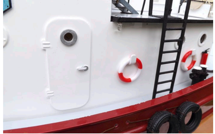
Das Bullauge an der Tür besteht aus einer Unterlegscheibe und einer entsprechenden Verglasung
