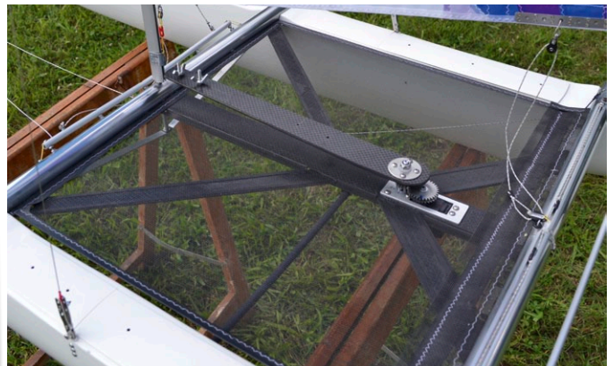
Der über ein Gleitlager drehbare Ausleger kann bis zu 180 Grad ausschlagen und ist mit einem elektronischen Lageregler gekoppelt
