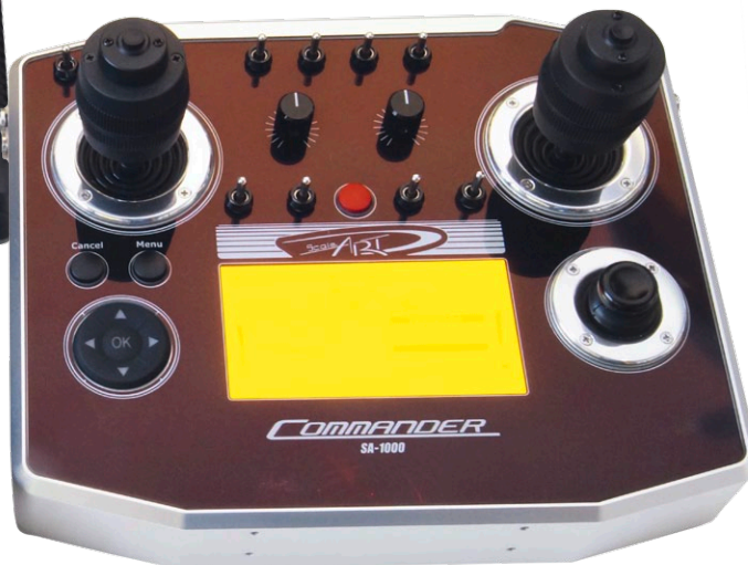
Da das Sendergehäuse aus Metall ist, das die Mikrowellen blockiert, liegt vor dem Gigahertz-Sendemodul ein Ausschnitt mit einer Kunststoffscheibe
