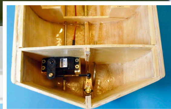
Servoeinbau zwischen Heckspant und Spiegel. Eine Luke sorgt für Zugang bei erforderlicher Wartung
