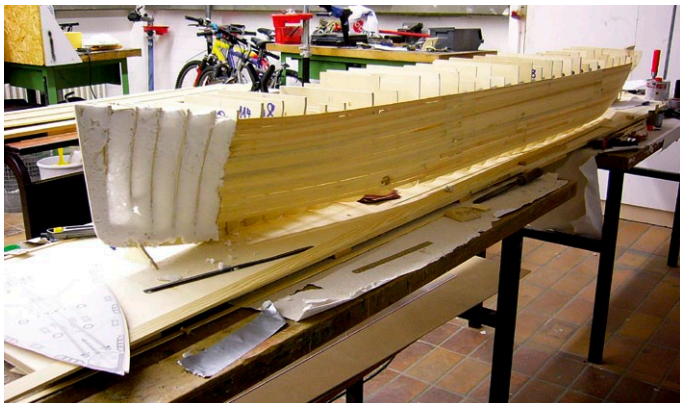
Styropor und Epoxydharz waren das Mittel der Wahl beim vorbildgetreuen Bau der Bugsektion
