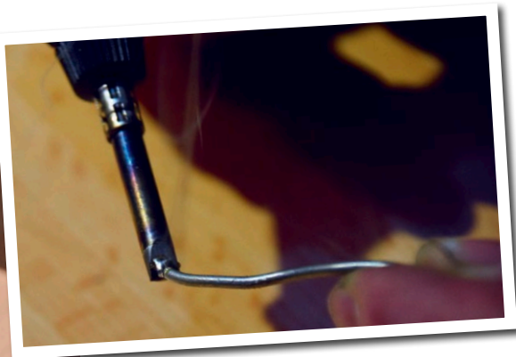
Nach der Arbeit sollten die Lötspitzen immer mit Lot benetzt bleiben
