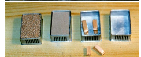
Aus Alu-Blech-Streifen und auf selbstklebender Folie ausgedruckter Lochmuster entstanden die Krabbenkisten
