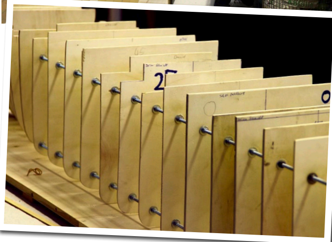
Sehr viel Aufwand steckte im exakten Ausrichten der Spanten, was über Gewindestangen erfolgte und damit eine gewisse Feinjustierung zuließ
