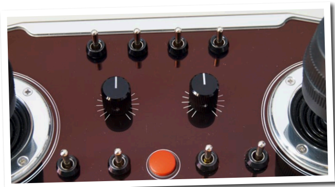
Weitere Schalt- und Proportionalfunktionen finden sich zwischen den Knüppelaggregaten; der rote Knopf ist der Ein-Aus-Schalter
