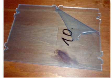
Vor dem Zusammenbauen ist die beidseitig aufgebrachte Schutzfolie abzuziehen. Erforderliche Zapfen und Nuten sind ab Werk gelasert
