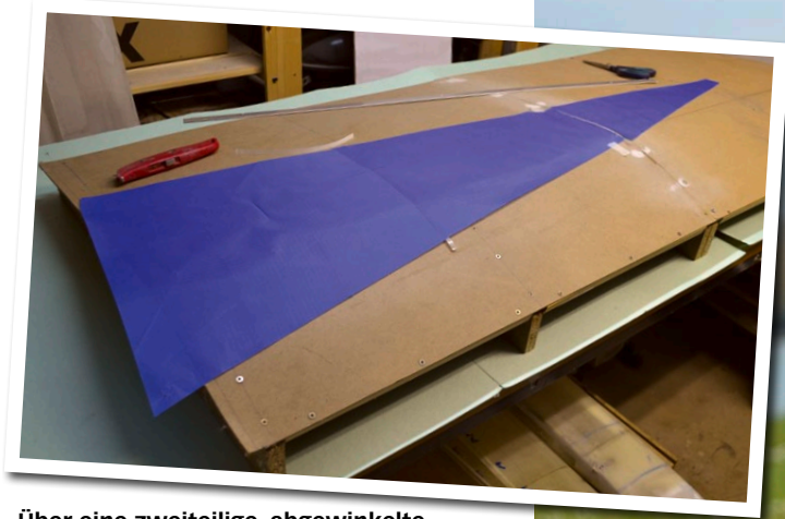
Über eine zweiteilige, abgewinkelte Unterlage wird das Segel Stück für Stück zusammengeklebt
