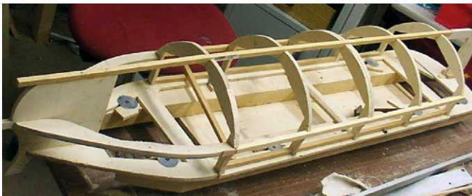
Der Rohbau des Rumpfs mit den Spannten auf dem Deckrahmen
