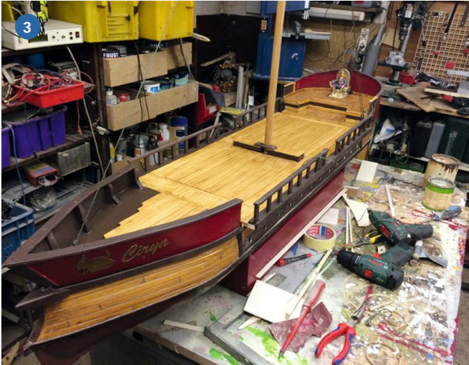
1) Das Antriebsprinzip: Eine Alustange wird über die beiden Kettenantriebe in einer oval-ähnlichen Bahn bewegt und sorgt somit für die rhythmischen Ruderschläge. 2) Jetzt geht es an die Konstruktion des Decks. 3) Der Aufbau des Decks wird mit Balsaleisten beplankt
