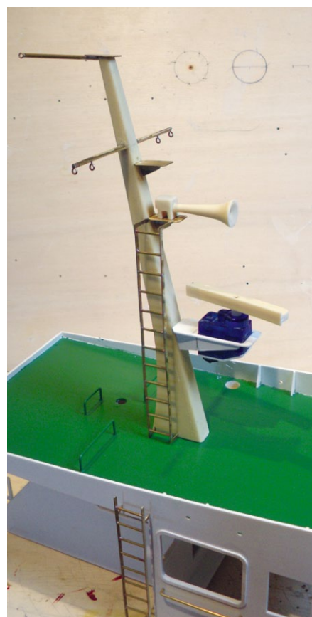
Am Mast wurde statt des statischen Radarbalkens dank eines altes Mini Servo eine drehbare Version realisiert
