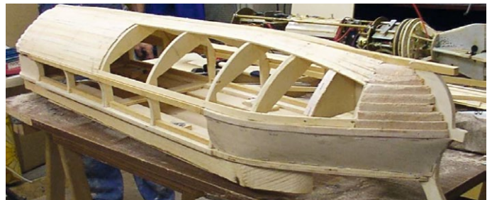
Durch die Beplankung aus Sperrholz bekommt die Galeere ihre Form
