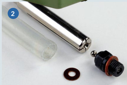
1) Bauteile für den 30-Milliliter-Wassertopf. 2) Verlängerung für die Zündkerze. 3) Auf dem Motor-Kühlkopf befestigter Wassertopf. 4) Die Wassermenge reicht für 30 Minuten Betrieb
