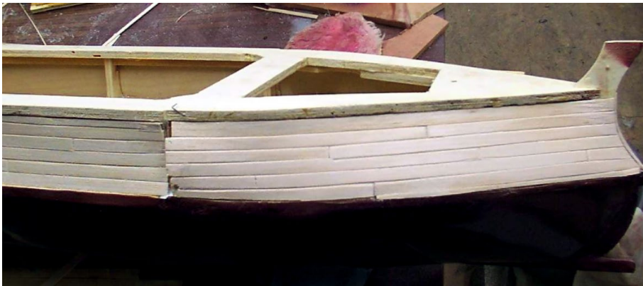
Mit Balsabeplankung entsteht das Überwasserschiff
