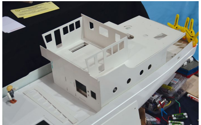
Der Hersteller hat die Decks-Teile für den Aufbau weitgehend vorbereitet, sodass der Bau zügig vorstättgeht
