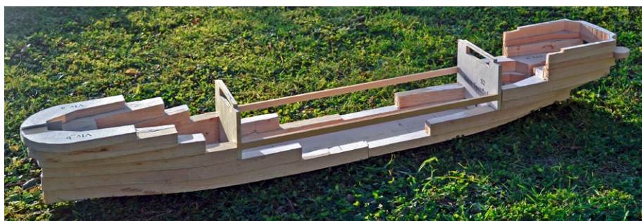
Der Rumpf des Modells besteht zum größten Teil aus Balsa-Holz
