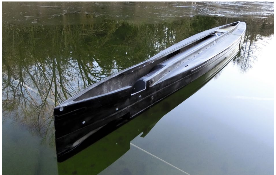
Erstes Probeschwimmen des Rumpfs im frühen Baustadium
