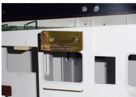
Die Lampenborde für die Positionsleuchten aus Messing
