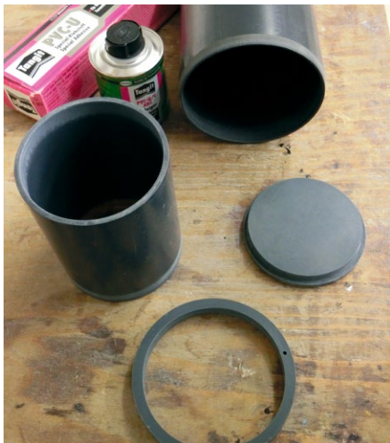
PVC-Rohre und -Deckel für den Druckkörper. Mit 110 Millimeter Durchmesser passen sie optimal in den Rumpf
