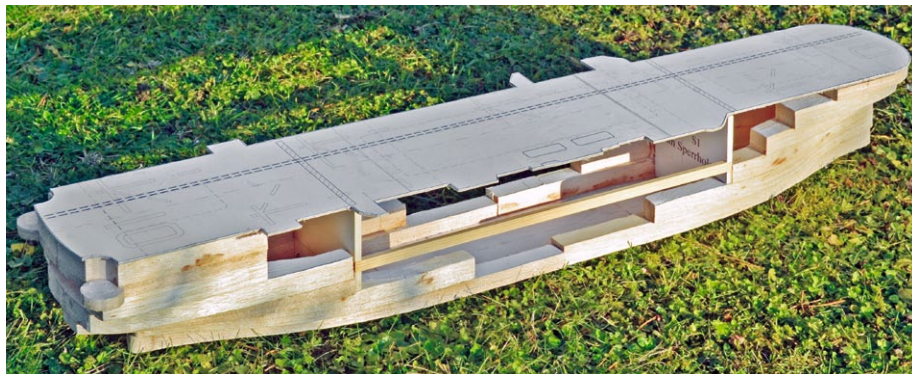
Der noch unbeplankte Rumpf in seiner Rohform
