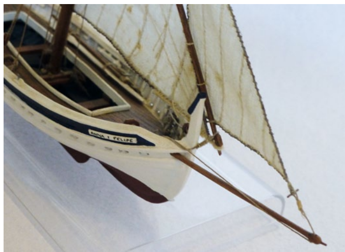
Blick auf den für die Llaut typischen Bugspriet
