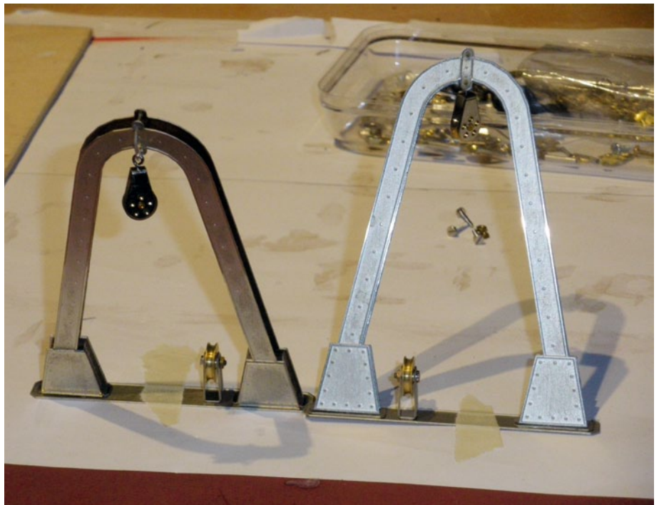
Die Neusilber-Ätzteile kombiniert mit einigen Holzsteilen ergeben optisch sehr ansehnliche Galgen
