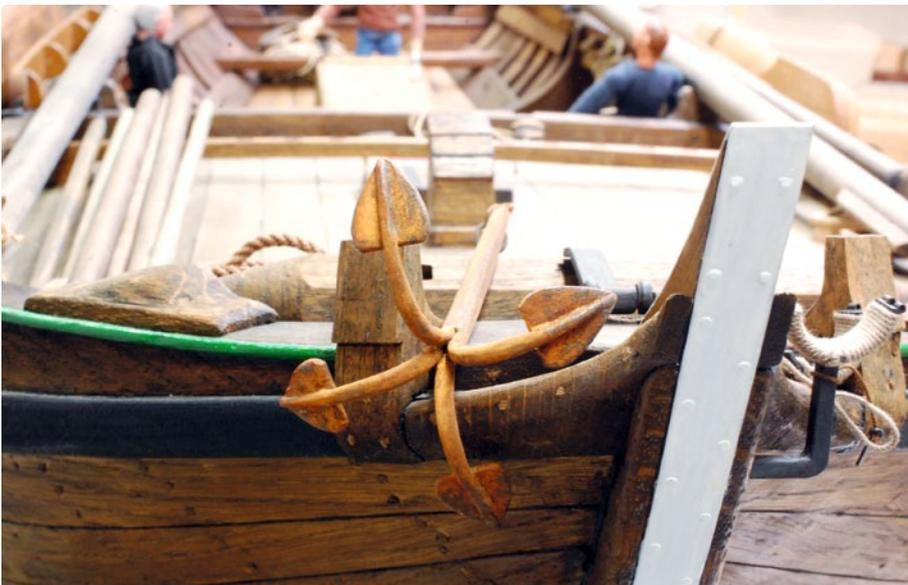
Der Anker ist permanent am Spill belegt
