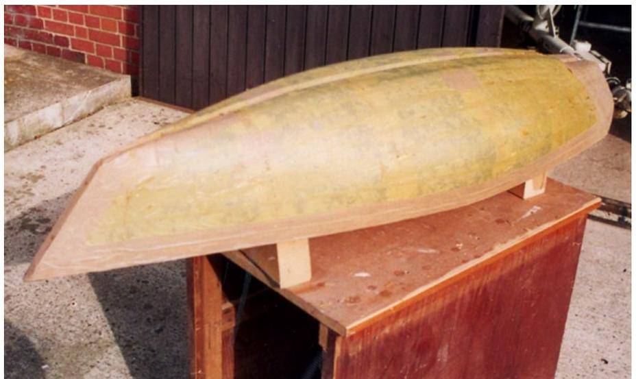
Der in konventioneller Schichtbauweise – aufgrund der erforderlichen Festigkeit keine Spantenkonstruktion – erstellte Rumpf wird zunächst mit Paketband und/oder Trennwachs behandelt
