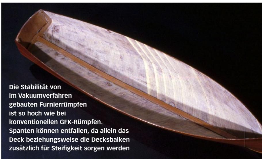
Die Stabilität von im Vakuumverfahren gebauten Furnierrümpfen ist so hoch wie bei konventionellen GFK-Rümpfen. Spanten können entfallen, da allein das Deck beziehungsweise die Decksbalken zusätzlich für Steifigkeit sorgen werden
