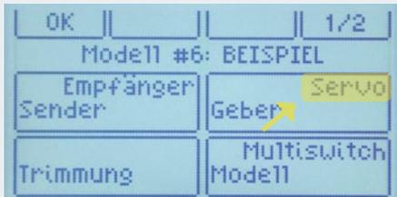
1) Der Programmierprozess startet von der Funktion ausgehend, also beim Empfängerenausgang. Daher ist zuerst „Servo“ statt „Geber“ zu wählen
