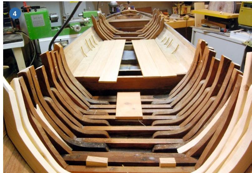
1) Schritt für Schritt, mit vielen Zwingen und mit Hilfe der Berghölzer lässt sich die Beplankung anbringen. 2) Wesentlicher Bestandteil der Kwak ist die Bünn, die beim Modell später die Winden-Technik aufnimmt. 3+4) Nachdem der Rumpf eigentlich fertig ist, werden die „eigentlichen“ Spanten eingepasst und gesetzt. Zahlreiche Spanten wurden mit Beize abgedunkelt, um Eiche zu imitieren
