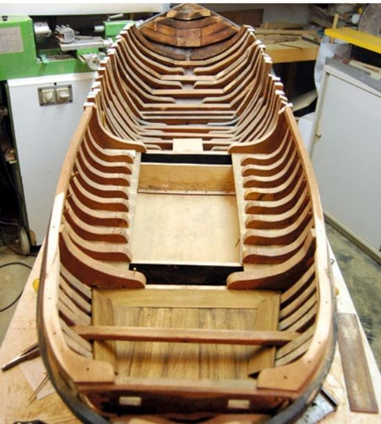
Stück für Stück ließen sich die Mallspanten entfernen, bis der Rumpf an sich fertig „gespant“ war
