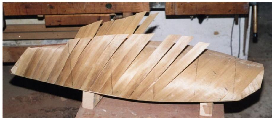
**Ist die erste Furnierschicht aufgetragen und im Vakuumverfahren einmal mit Epoxid-Harz gefestigt worden, folgt die zweite Lage Furnierstreifen – sie ist abschließend ebenfalls mit Epoxy zu festigen**
