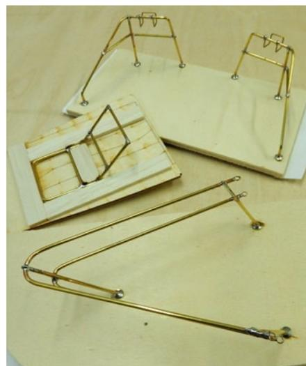
Die Reling ist richtiger Modellbau. Sie ist weich in einer Vorrichtung gelötet und wird noch lackiert
