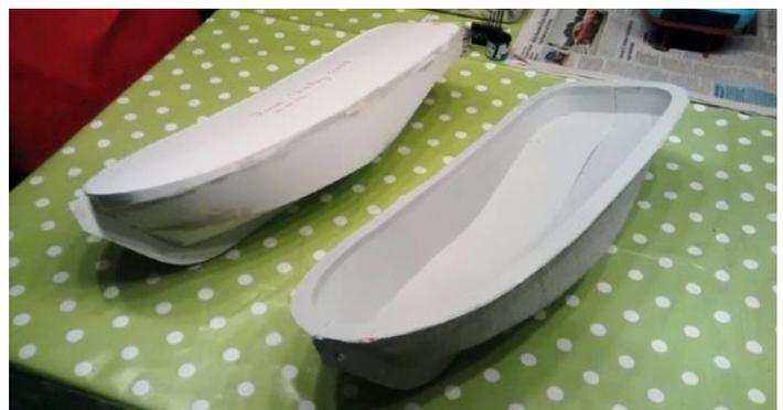
**Links im Bild der Ur-Rumpf, der in Spanten- und Plattenbauweise entstand- Daneben das zweiteilige Negativ**
