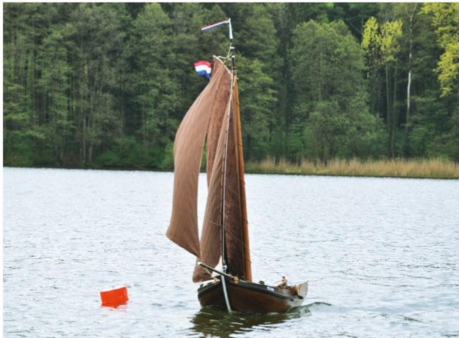
dem Fall ginge Antriebskraft verloren. Die Segelbahnen sind übrigens nur durch Legen der Stoffe angedeutet, das Segel besteht also aus einem einzigen Stück Stoff. Einzelne Bahnen würden eine Vervierfachung der Nähte bedeuten, was das Segel zu schwer werden lässt. Die Liektaue zu setzen, bildete den letzten Arbeitsschritt.
