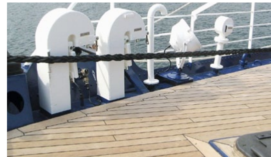
Abbildung 11: Backdeck der SSS GORCH FOCK, traditionelle Plankenstöße, recht kurze Leibholzstücke
