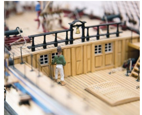
Der Zugang unter Deck wurde ebenfalls zum Teil mithilfe des 3D-Druckers angefertigt: Beispielsweise die Fensterrahmen
