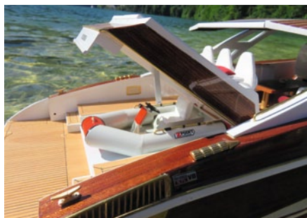
Die Tendergarage beherbergt das Schlauchboot
