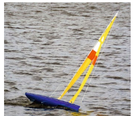
Das Fahr- beziehungsweise Segelbild sieht zwar spektakulär aus, jedoch drückt der Wind das Modell auch stark seitlich weg
