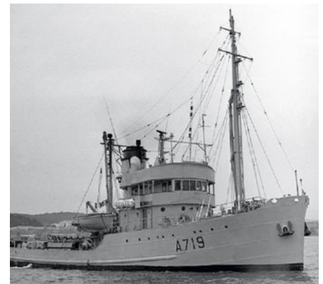
BELIER mit zusätzlichem Mast/Ladebaum hinter dem Kamin, in den Bückennocks schon Rettungsflöße, Reling-Verkleidung am obersten Deck
