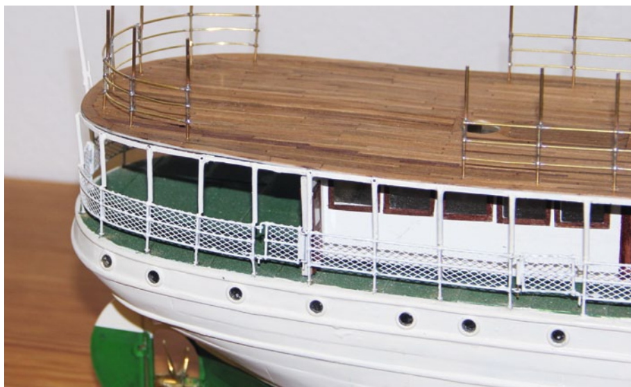
Die Reling entsteht aus 100 Relingstützen, die angebracht werden
