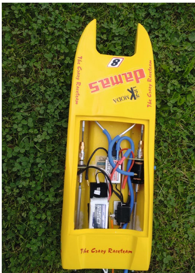
Blick auf das einsatzbereite Kat mit noch kleinem 1.2500-mAh-LiPo. Man beachte den recht aufwendigen Kühlkreislauf
