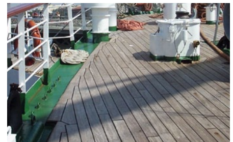
Abbildung 12: „Systemlose“ Plankenstöße beim modernen polnischen SSS DAR MLODZIEZY
