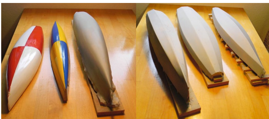
Rundspanter sind widerstandsärmer und wirken formschöner, allerdings lassen sich Knickschiffboote viel leichter bauen
