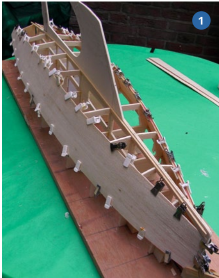
1+2) Holz eignet sich hervorragend zum Bau von Rümpfen – unabhängig von der Spantenform
