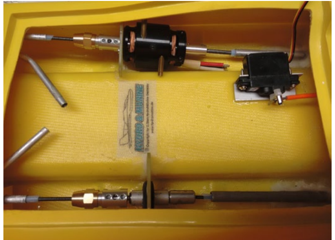
Reibung erzeugt Wärme und um die abzuleiten, ist die Bogenflexwelle Teil des Kühlkreislaufs
