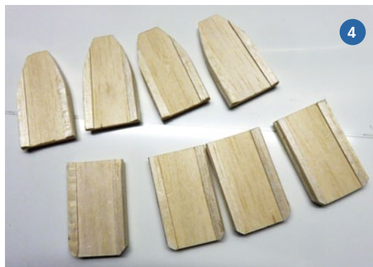
1) Um bei diesem komplexen Aufbau einen nicht sichtbaren Zugang in das Innere des Modells zu ermöglichen, wurden Rumpf und Aufbau an der Seitenlinie getrennt. 2) Auch nachts ist die TUNDRA dank der Beleuchtung ein absoluter Hingucker. 3) Zwei Propeller bringen die TUNDRA in Fahrt. 4) Die Sonnenliegen werden aus Balsa-Holz angefertigt. 5) Bereit zum Probeliegen und Sonnen
