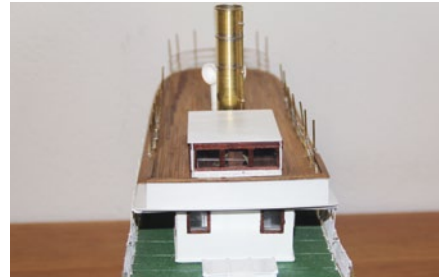
Der Rohbau des Schornsteins aus einem beiliegenden ABS-Rohr. Die Positionslichter sind auch schon vorbereitet
