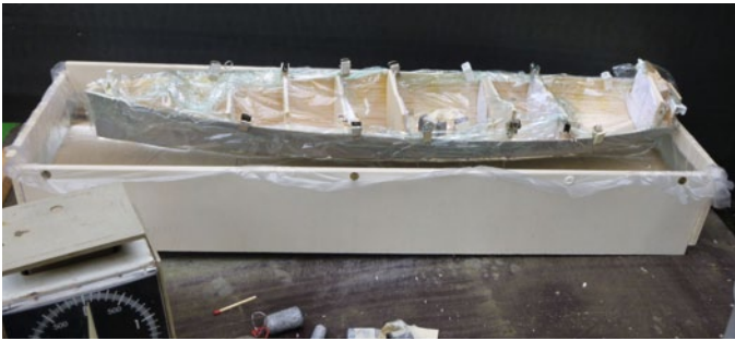
Zum Ermitteln der erforderlichen Verdrängung eignet sich auch ein selbst gebauter Wassertrog
