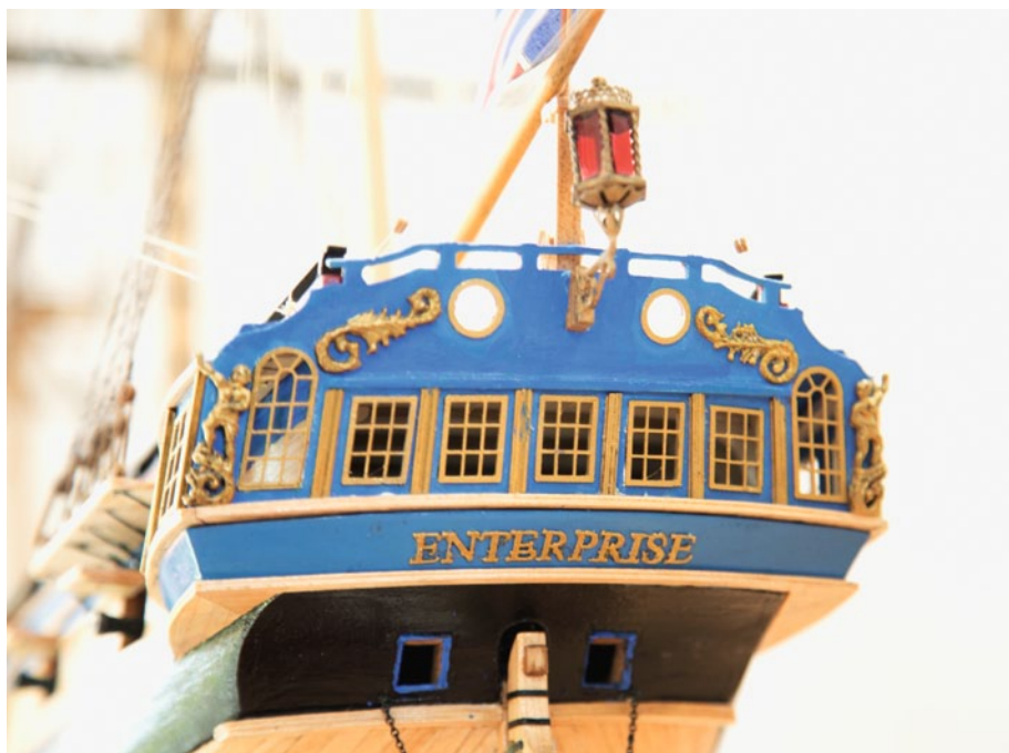
Michael Kleis hat die HMS ENTERPRISE in Anlehnung an Pläne der Firma Shipyard aus Polen angefertigt und dazu sowohl Holzteile als auch welche aus dem 3D-Drucker verwendet
