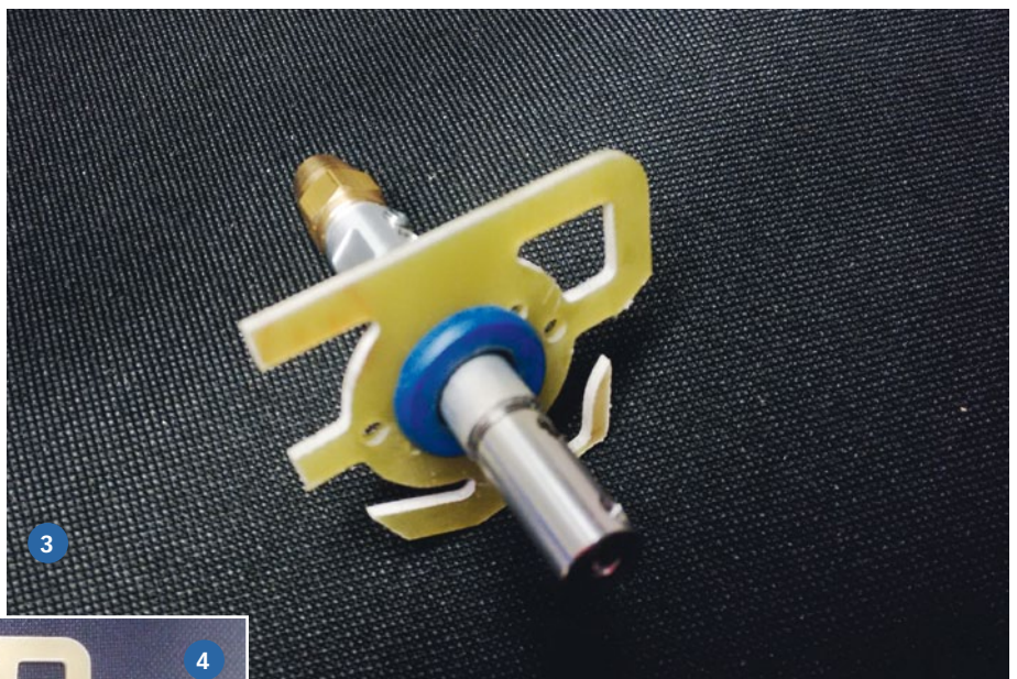
1) Zwischen Bogenflexwelle und zweiter Antriebswelle ist eine Wellenverlustrsicherung eingebaut, die aus Alurohr, Teflonrohr, Buchsen, Stahlwelle und Kupplungen besteht. 2+3) Die Wellenverlustrsicherung wird auf einem dem Motorspant ähnlichen Träger montiert. Dabei hilft ein Plastikzwischenstück. 4) Vorlage für den Träger der Wellenverlustrsicherung war der Motorspant
