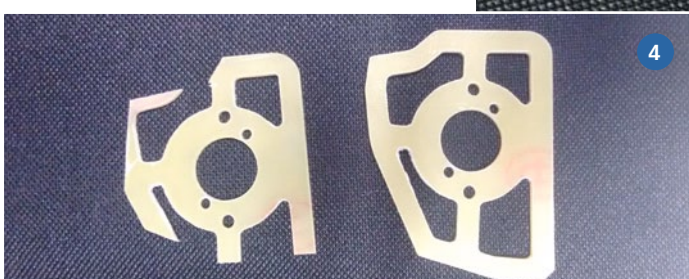
1) Zwischen Bogenflexwelle und zweiter Antriebswelle ist eine Wellenverlustrsicherung eingebaut, die aus Alurohr, Teflonrohr, Buchsen, Stahlwelle und Kupplungen besteht. 2+3) Die Wellenverlustrsicherung wird auf einem dem Motorspant ähnlichen Träger montiert. Dabei hilft ein Plastikzwischenstück. 4) Vorlage für den Träger der Wellenverlustrsicherung war der Motorspant
