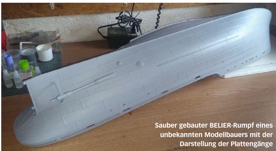
Drei Schleppbügel sind bei BELIER demontiert, der Propellerschutz hier unterhalb der (Stahl-)Scheuerleiste
