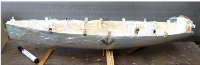
Den Verdrängungsschwerpunkt ermittelt man abschließend mit Hilfe von Gewichten und einem Rundstift
