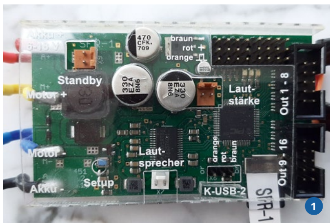
1) Der Soundfahrregler 1, kurz SFR-1, von Beier-Electronic vereint Motorregler, Multiswitch und Soundsteuerung in sich. 2) Fertig montiertes Steckmodul des SFR-1, wie es als Einheit in mehreren Modellen verwendet werden kann – in der Konfiguration kann auch der Kühlblock optimal wirken
