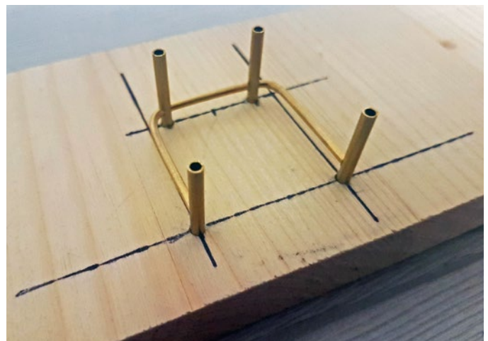
Der Bau der abgeänderten Sitzgestelle mittels Lötlhilfe
