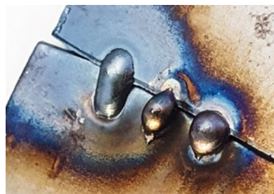
Nahaufnahme von drei Schweißpunkten, die zwei Stahlbleche von 1 mm verbinden. Es wurde nur sehr wenig WSGII-Zusatz genutzt
