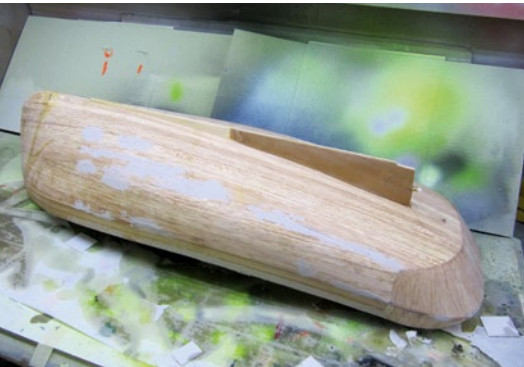
Sobald der Rumpf vollständig beplankt ist, beginnt das übliche Prozedere aus Schleifen und Spachteln
