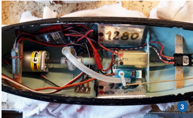
1) Der Innenausbau beginnt. Der Antriebsmotor der 280er-Größe ist schon zu kräftig für das Modell. 2) Nachdem die Lackierarbeiten abgeschlossen sind, kann der finale Zusammenbau beginnen 3) Im Rumpf geht es zwar eng zu, aber es findet alles seinen Platz. 4) Die Verkabelung des Deckshauses nimmt aufgrund des kleinen Maßstabs schon ein wenig Zeit in Anspruch. 5) Mittels Zahnradgetriebe dreht ein Mikroservo die Wasserleitung und damit den Löschmonitor auf dem Turm
