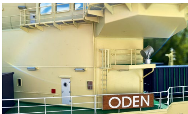
Unter der Lackierung versteckt sich ein massiver Aufbau aus dünnem Bronzeblech
