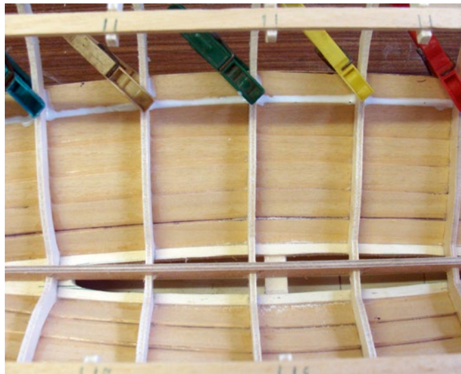
Blick auf die Kieltasche, die später das Blei aufnehmen wird. Hier ist gerade eine Planke eingeklebt worden
