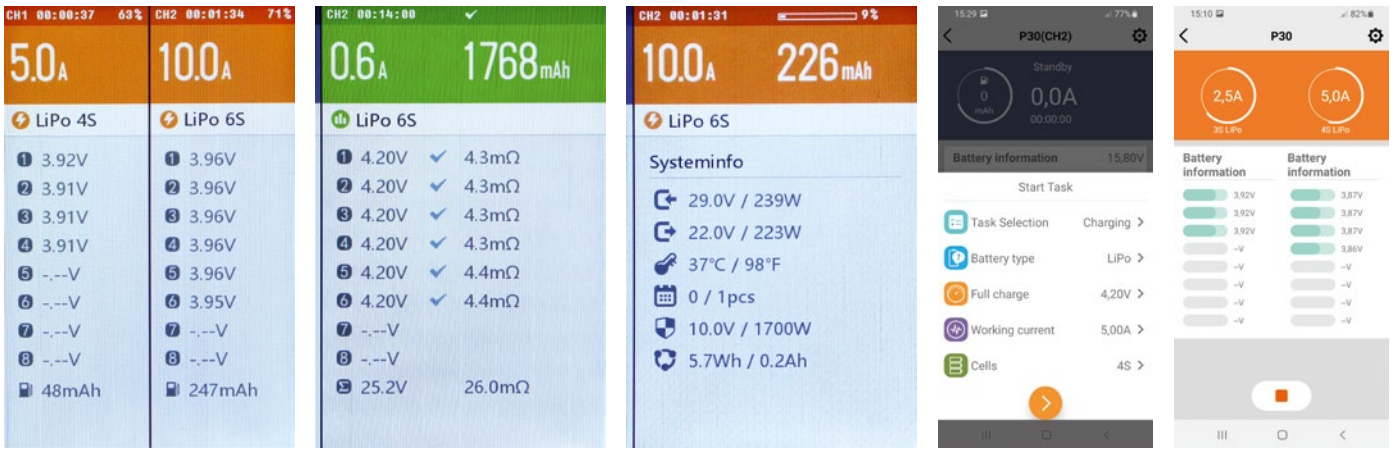
1) Beim Laden werden die wichtigsten Parameter übersichtlich visualisiert. 2) Der Akku ist geladen, die Ladeschlussspannungen sind erreicht, es wird aber noch weitergeladen, bis der Akku absolut randvoll ist – die Displayfarbe wechselt dann von grün auf blau. 3) Während eines Vorgangs können die wichtigsten Systemparameter abgerufen werden. 4) Auch eine Bedienung über die App ist möglich – über dieses Menü gibt man die Akkuparameter vor. 5) Auch mit der App hat man alles optimal im Blick
