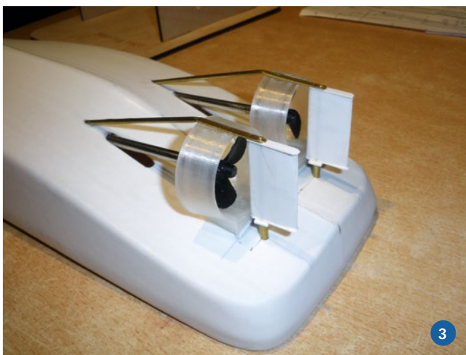
1) Die Ruder entstanden in Eigenregie aus drei Lagen Polystyrol. 2) Obwohl man es in diesem Maßstab von außen kaum erkennen kann, ist auch das Deckshaus innen komplett ausgebaut
