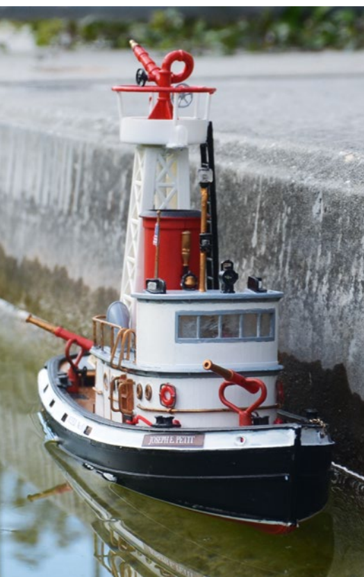
1) Details an Deck lassen das Feuerlöschboot richtig erwachsen wirken. Rechts unterhalb des Turms ist das Zahnrad zu Drehung der Wasserleitung samt Löschmonitor zu sehen. 2) Der filigrane Löschmonitor auf dem Turm sollte trotz – oder gerade wegen – des kleinen Maßstabs nicht fehlen
