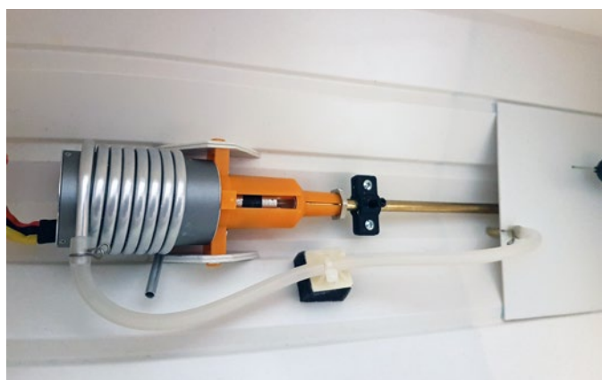
Der komplett eingebaute Antriebsstrang
