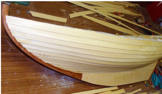
Jede Planke ist ein Unikat und wurde individuell eingepasst, was die Bauzeit in die Länge zog
