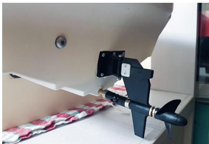
Der Pseudo-Z-Drive mit dem Kardan-Gelenk für das Ruder
