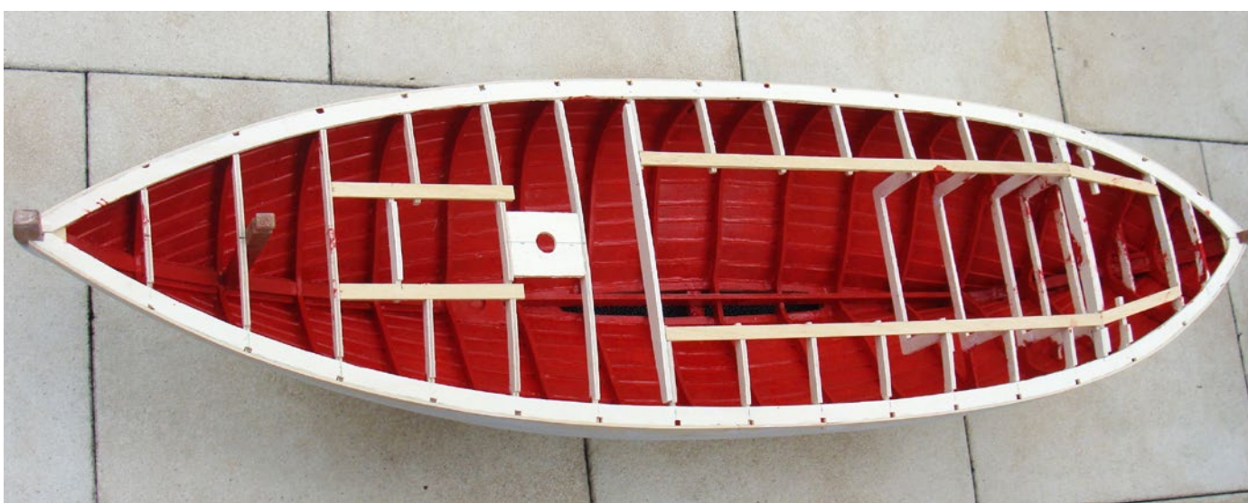
Das Boot wurde gut von innen abgedichtet. Jetzt kann das Deck aufgesetzt werden
