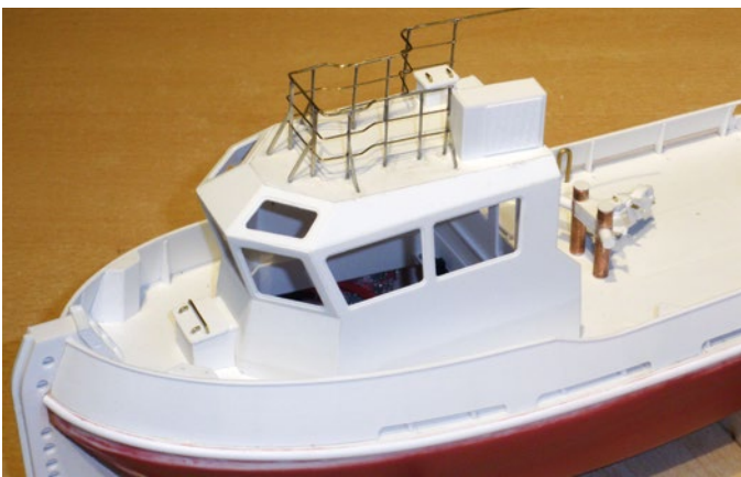
Die Reling und Leiter wurden aus Messingdraht gelötet
