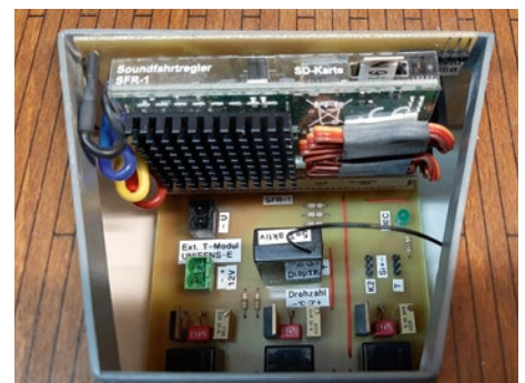
Unterhalb des abnehmbaren Niedergangs befindet sich der Zugang zu der im Modell montierten Basisplatine. Gut erkennbar sind die verschiedenen Aufnahmen und Anschlüsse für die steckbaren Module SFR-1, Empfänger und Unisens-E. Das rechte Bild zeigt die eingesetzten Module und wie knapp der Platz in der Öffnung für das SFR-1-Modul ausgereicht hat
