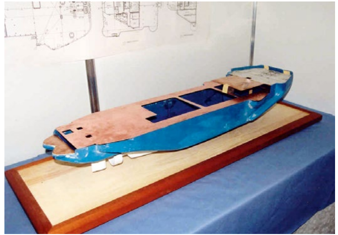
Alle Decks sind eingeklebt und der Innenausbau weitgehend abgeschlossen – es folgen die Decksaufbauten
