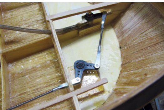
Über Umlenkung eingebaut, kann die Ruderansteuerung gut unter dem Achterdeck verschwinden
