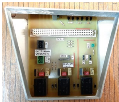
Unterhalb des abnehmbaren Niedergangs befindet sich der Zugang zu der im Modell montierten Basisplatine. Gut erkennbar sind die verschiedenen Aufnahmen und Anschlüsse für die steckbaren Module SFR-1, Empfänger und Unisens-E. Das rechte Bild zeigt die eingesetzten Module und wie knapp der Platz in der Öffnung für das SFR-1-Modul ausgereicht hat
