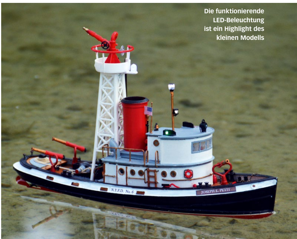
1) Details an Deck lassen das Feuerlöschboot richtig erwachsen wirken. Rechts unterhalb des Turms ist das Zahnrad zu Drehung der Wasserleitung samt Löschmonitor zu sehen. 2) Der filigrane Löschmonitor auf dem Turm sollte trotz – oder gerade wegen – des kleinen Maßstabs nicht fehlen
