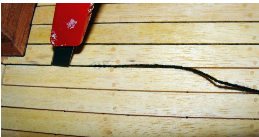
Die Planken wurden nicht genagelt, sondern geklebt. Die Nagellöcher imitieren das ähnlich wie der Faden die Kalfaterung
