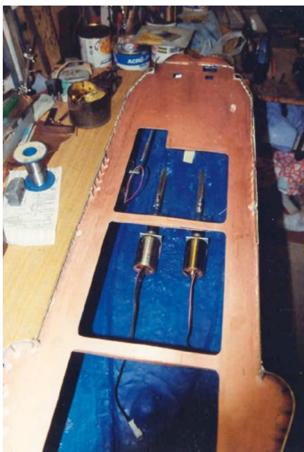
Zwei Industriebürstenmotoren sind die Idealbesetzung für den Antrieb
