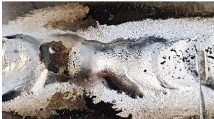
Blick auf eine Stumpfnahht zweier Alubleche von je 1,5 mm Stärke
