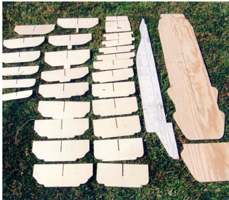
Nachdem die Planunterlagen vorlagen, wurde klassisch mit dem Aussägen von Spanten begonnen
