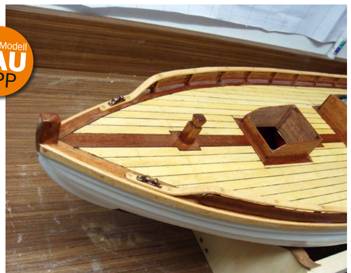
Ordentlich gewässert und vorgebogen, lassen sich die beiden vorderen Elemente der Handläufe in Form pressen
