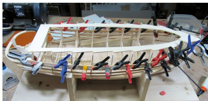
Sobald die unteren Planken befestigt sind, kann man oben die Planken für die Rumpfwand anbringen
