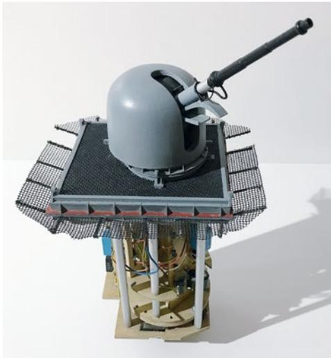
Unter dem Geschützpodest befinden sich Elektronik und Motoren zur Steuerung
