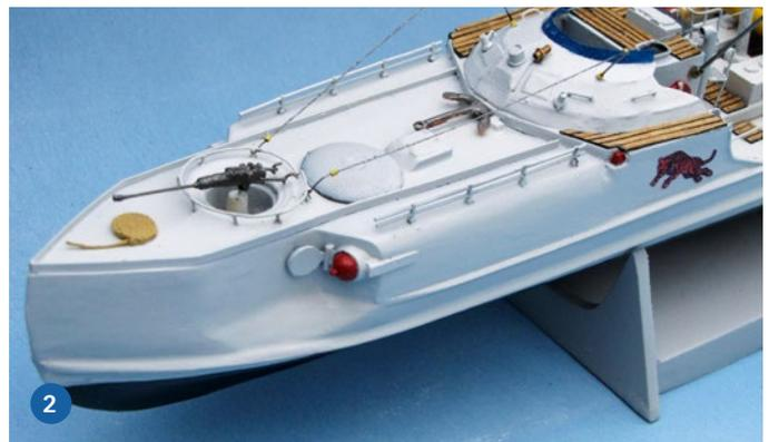
1) Deutlichste Veränderung bei S100 ist der Wegfall der klassischen Kajüte zugunsten der Panzerkalotte. 2) Die Torpedoröhre – hier mit geöffneter Klappe – sind nun vollständig vom Bootskörper umschlossen und integriert. Im Bug ist eine 20-mm-Flak eingesetzt
