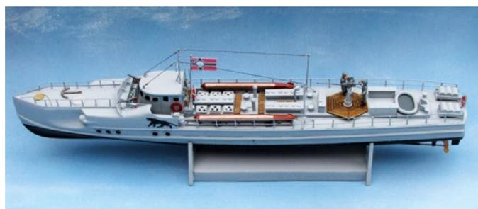
Bei Schnellboot S30 sind die vorderen Torpedorohrbereiche umschlossen, aber noch nicht voll in den Rumpfaufbau integriert
