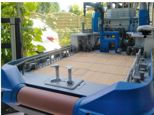
Die Towingpins am Heck lassen sich ferngesteuert ein- und ausfahren
