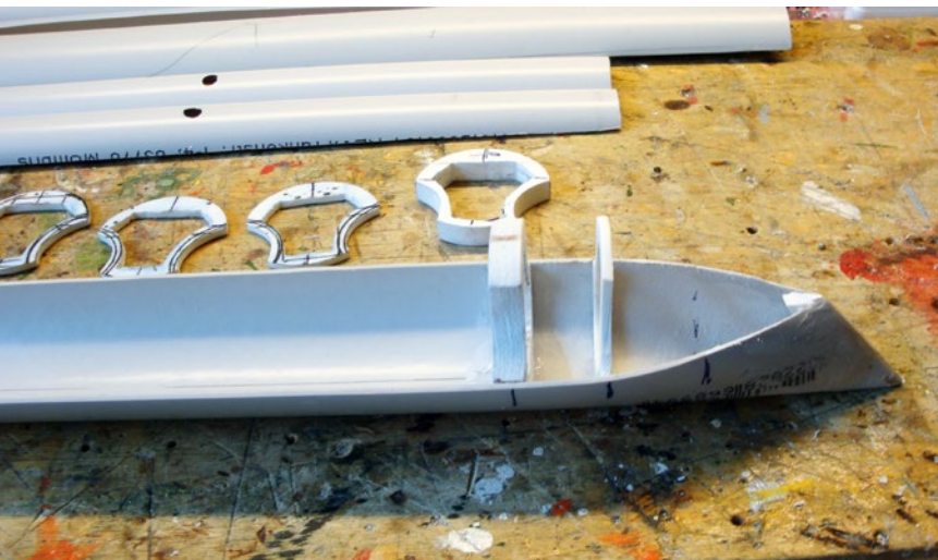
Um die Bugform wiederzugeben, wurde das Kunststoffrohr warmverformt. Anschließend ließen sich die stabilisierenden Spanten einsetzen
