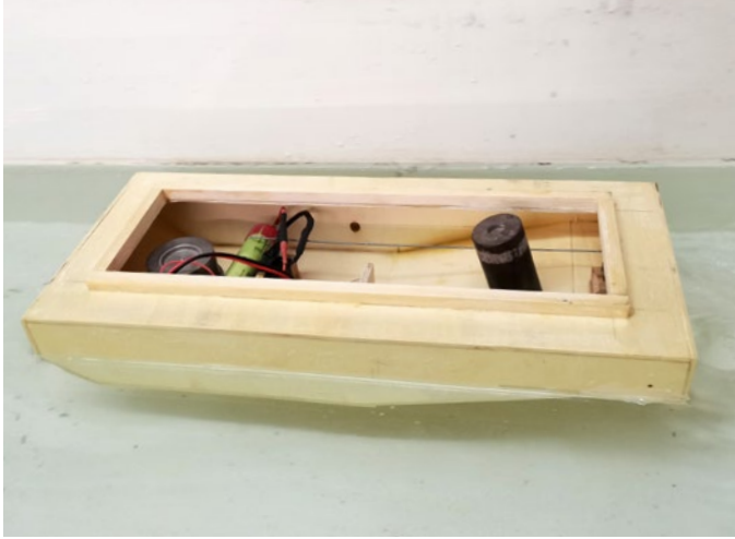
Erster Schwimmversuch des Rumpfs zur Ermittlung der Zuladung
