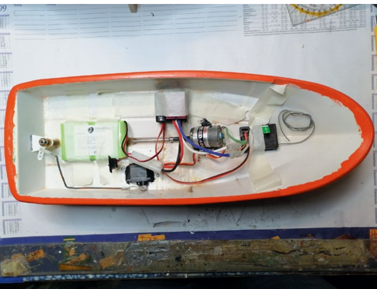
Für die erste Testfahrt wurden die Einbauten provisorisch im Rumpf befestigt
