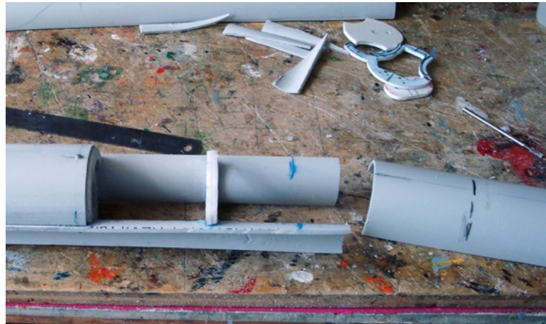
Die einzelnen Rumpfsegmente werden mit Sekundenkleber verbunden
