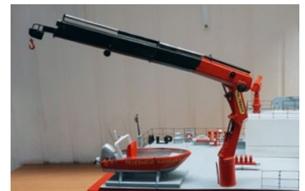
Der Bordkran ist natürlich voll funktionsfähig. Alle Elemente des Auslegers können ausgefahren werden
