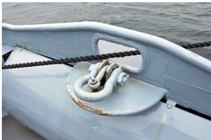
Durch die achtere Umlenkung führt der Beiholer zur Schleppleine
