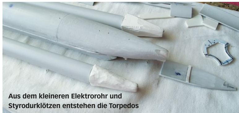
Die einzelnen Rumpfsegmente werden mit Sekundenkleber verbunden
