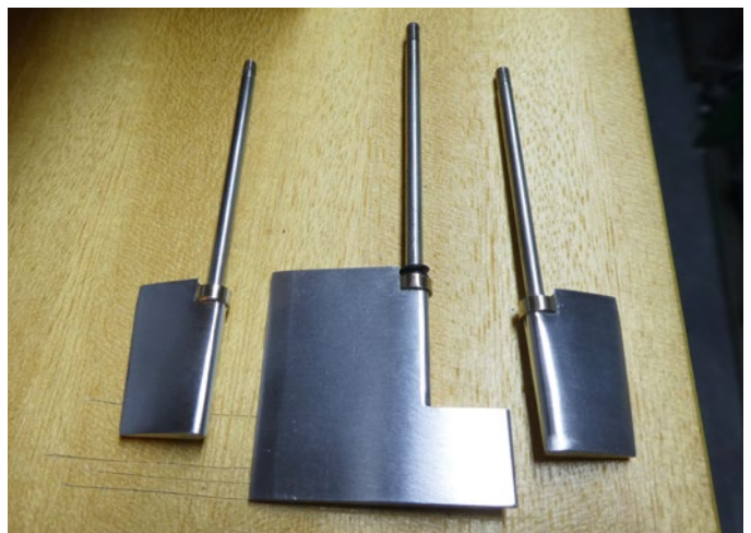
Ruderblätter mit Welle, Druckring und O-Ring
