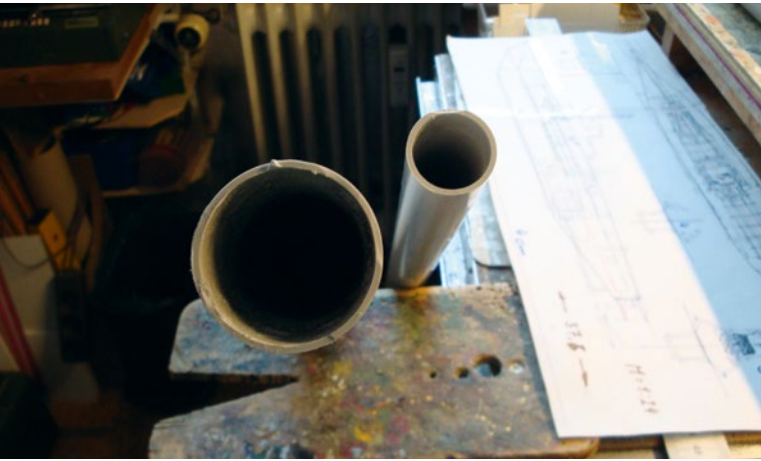
Das Basismaterial besteht aus Rohren für Elektroinstallationen, wie man diese aus dem Baumarkt kennt
