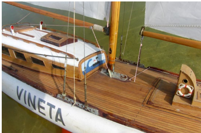
Blick aufs Deck, rechts der neue Niedergang zu sehen
