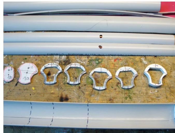
Die restlichen Spanten liegen zum Einbau bereit
