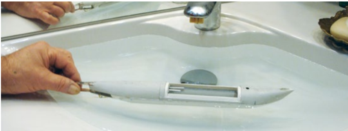
Für die erste Schwimmprobe reicht das Handwaschbecken
