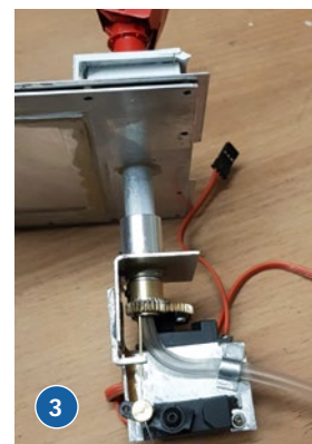
1) Der Fertigrumpf der HAPPY HUNTER erforderte vor allem am Heck einige Umbauten. 2) Die beiden Schottelpropeller werden von der Rumpfmittle aus mit Zahnriemen angetrieben. 3) Mit jeweils zwei Servos können die Löschkanonen gedreht und in der Höhe verstellt werden
