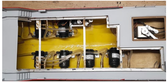
Der geräumige Rumpf bietet die Möglichkeit, jede Löschkanone individuell mit Wasser zu versorgen
