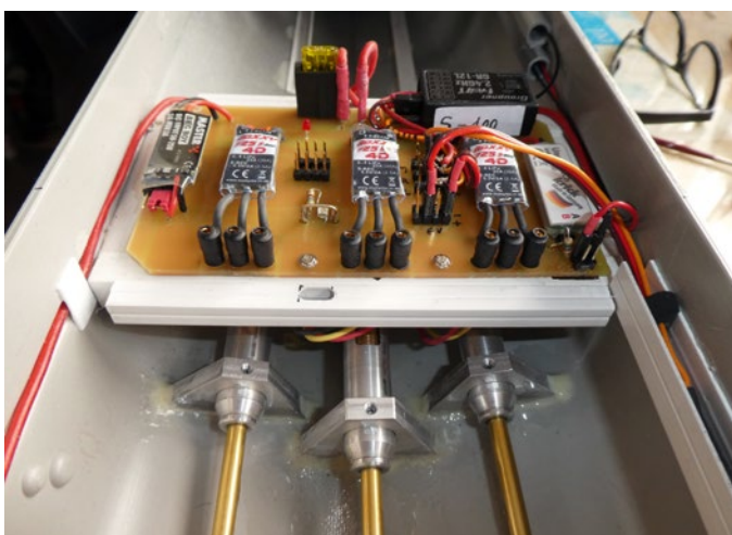
Um Kabel und Gewicht zu sparen, wurden alle elektronischen Bauteile auf einer Platine untergebracht
