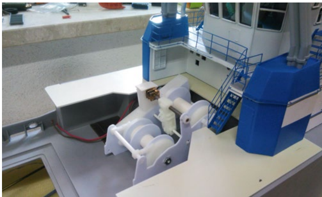
Damit die FAIRPLAY-30 auch arbeiten kann, wurde die Schleppwinde funktionsfähig gestaltet
