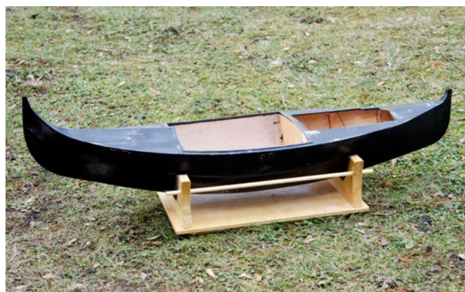
Im Rumpf wurden eine Bodenplatte und Trennwände eingesetzt
