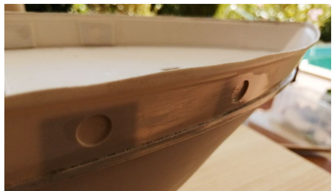
Die vorgebohrten Bullaugen werden großflächig wasserdicht verschlossen
