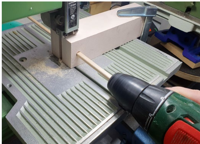
Grundlage des Hilfswerkzeugs ist ein PUR-Hartschaum-Kunststoffblock
