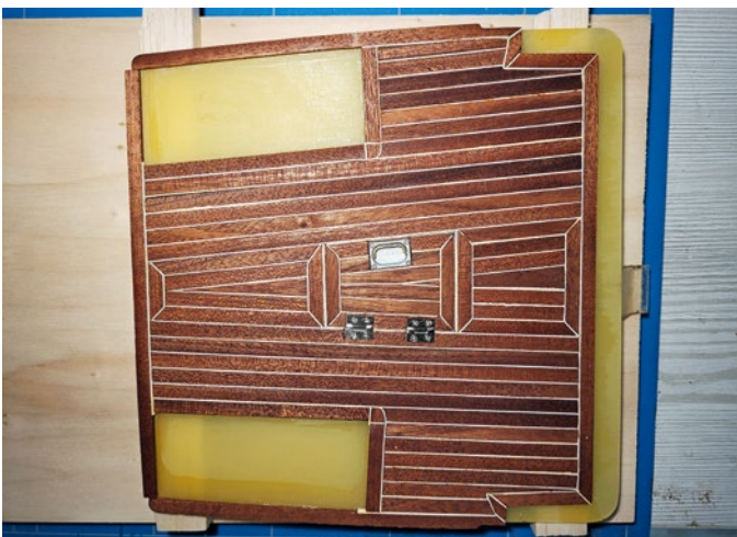
Der fertige Plichtboden, noch ohne die Magneten für die Sitzbänke
