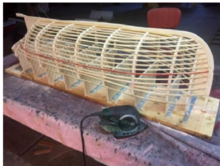
Der Rumpf der BERTUS FREEDE entstand in klassischer Holzbauweise
