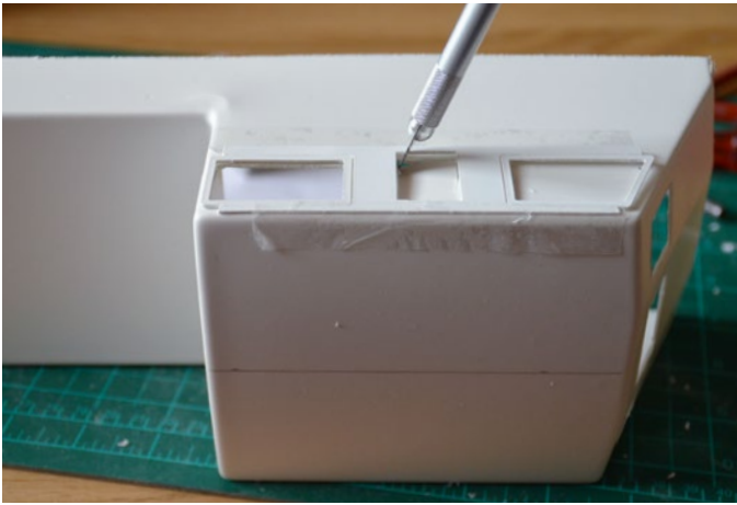
Mit der Lehre lassen sich die Fenster exakt positioniert ausschneiden
