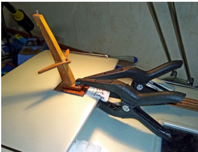
Die Kabelchen der Positionslampen sind verlötet und der Mast wird verklebt
