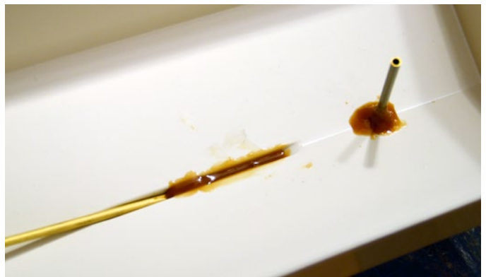
Stevenrohr und Ruderkoher werden mit Stabilit Express eingeklebt
