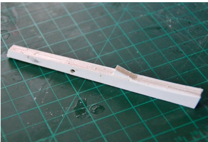
Der Geräteträger wird aus mehreren Lagen Polyester zusammengeklebt
