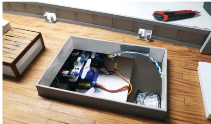
Für das Schalten der Beleuchtung sind Servos mit Tastschaltern installiert
