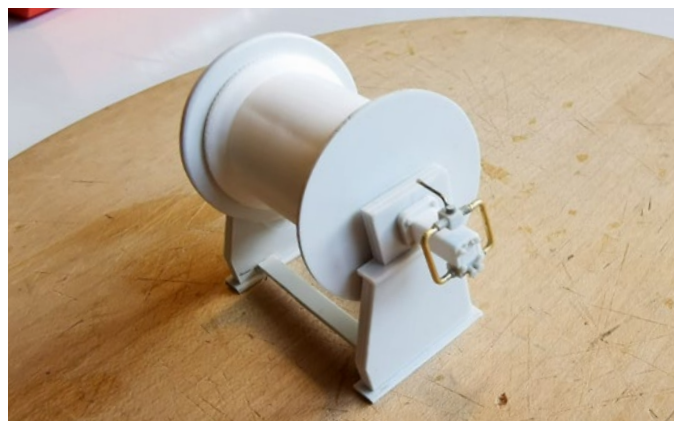
Die Netzwinde besteht aus PS, einer Garnspule und etwas Draht
