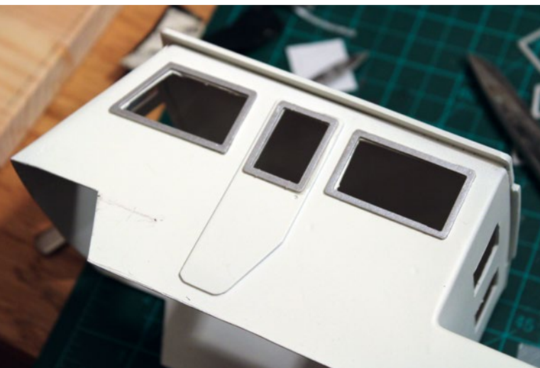
Die äußeren Fensterrahmen wurden vor dem Aufkleben lackiert
