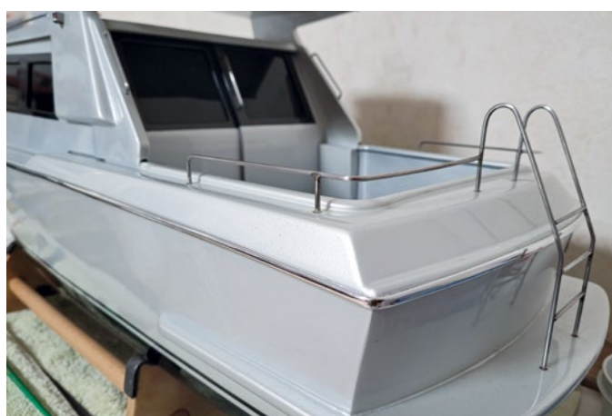
Die fertige verchromte 3-mm-Zierleiste stammt aus dem KFZ-Bedarf
