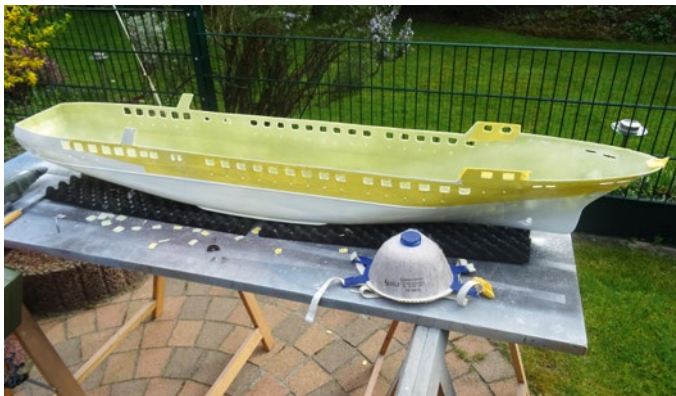
Nach und nach werden die Bohrungen für Bullaugen und Fenster in den Rumpf eingebracht
