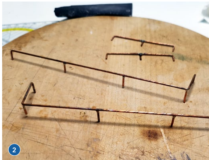
1) Die Rettungsringe wurden über einem Kupferrohr gebogen, passend abgeschnitten und dann mit Farbe, Garn und roten Streifen aufgehübscht. 2) Die Reling wurde aus einem passenden Kupferdraht zusammengelötet
