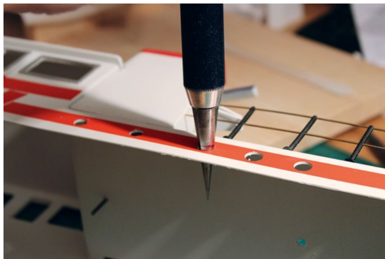
Bei den Bullaugen des Aufbaus kommt ein Karosseriebohrer zum Einsatz
