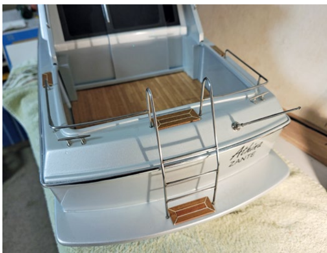
Das fertige Heck der CORONET P32 mit allen montierten Details
