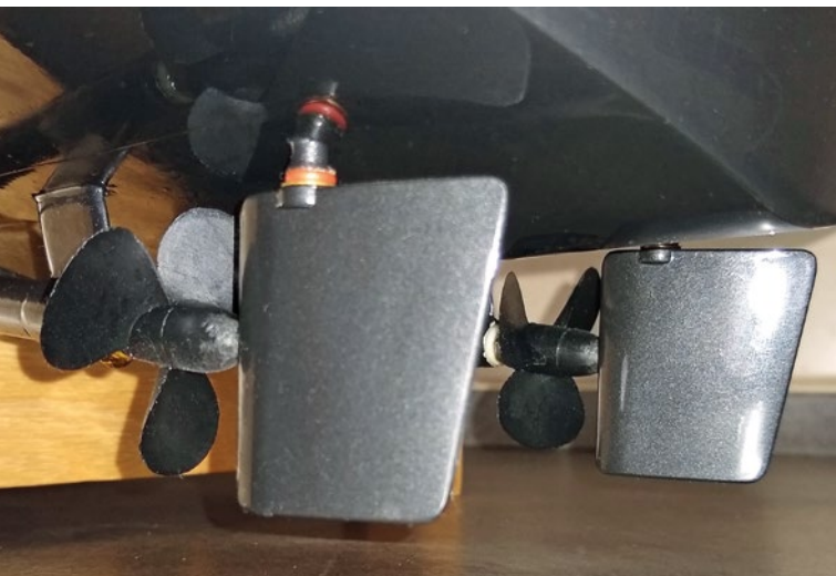
Diese Kombination von Rudern und Propellern sorgte bei Vollgas für Probleme
