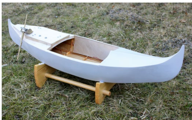
Der Rumpf wurde mehrfach gespachtelt und geschliffen
