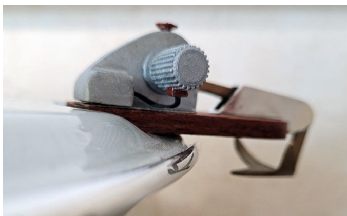
Die fertige Ankeranlage ist auf dem CORONET-Bug montiert
