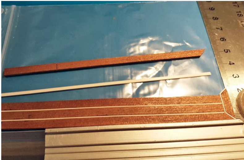
Der Laufsteg auf dem Dach wird aus Teakholzleisten zusammengesetzt
