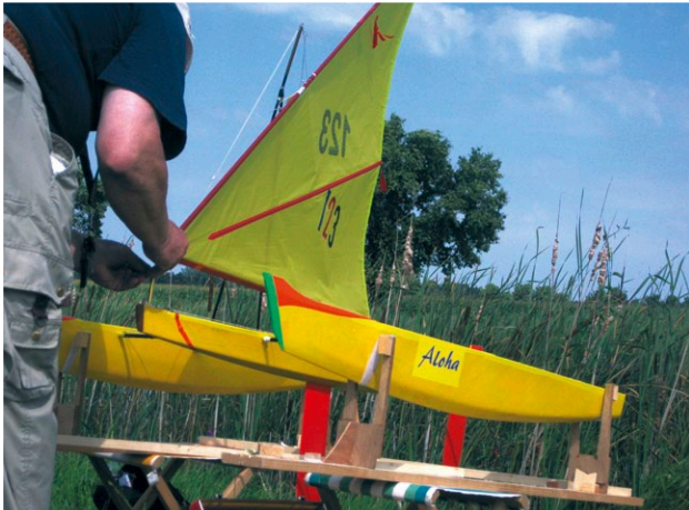
Hier ist gut zu erkennen, dass der mittlere Rumpf flacher gebaut ist und die Wasseroberfläche kaum berührt
