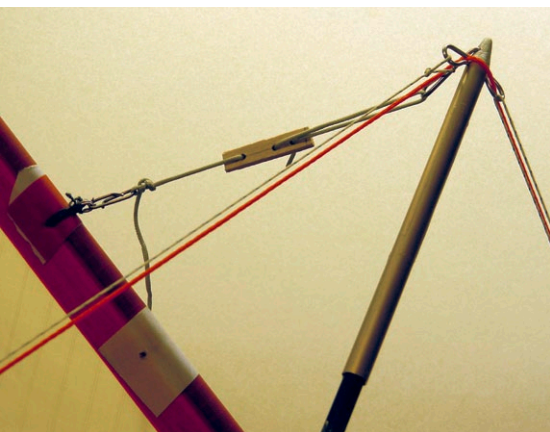
Auf dem CFK-Mast sitzt ein Messingrohr zur Aufnahme der Abspannpunkte sowie der Segelhalterung
