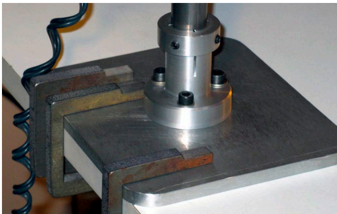
Abbildung 5: Der Bereich der Schlitzung hat einen recht dünnwandigen (1 Millimeter) Absatz
