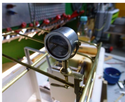
Der Suchscheinwerfer auf dem Dach besteht aus einem Dreh- und einem Frästteil, beide aus Aluminium
