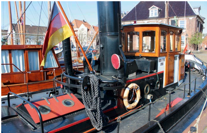
Typisch für Schlepper wie der Bertus Freede ist der schwarze Schornstein hinterm Ruderhaus
