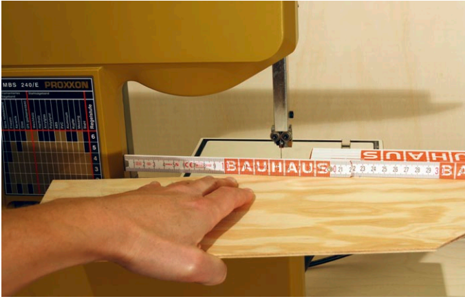
Alles, was links über 150 Millimeter breit ist, lässt sich nicht durchschieben
