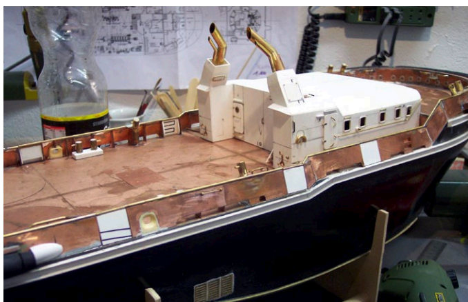
Erste Stellprobe des Bridgedecks, das aus Polystyrol entstand und mit Messing-Bauteilen bereichert wurde
