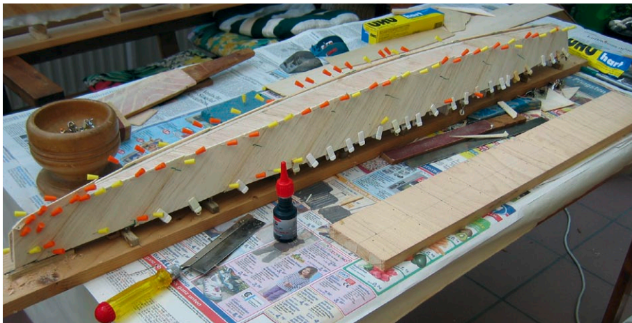
Sobald die Rumpfe fertig beplankt waren, erhielten sie einen Festigkeit gebenden Überzug mit Glasfaser und Harz
