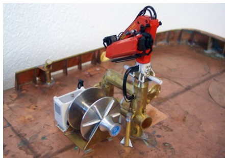
Achtere Speicherwinde noch ohne Lack. Obendrauf ist der mit Details ausgeschmückte Fertig-Kran aufgesetzt
