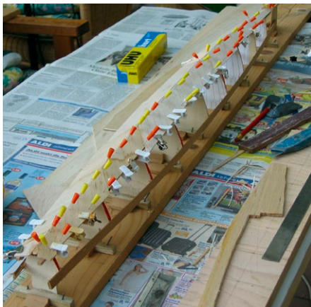
In Spantbauweise aus verschieden starkem Balsaholz entstanden die Rumpfe
