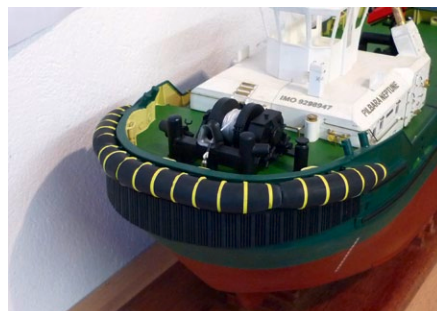
Winde und Schleppbock haben endgültig ihren Platz auf dem Vordeck gefunden. Markant sind auch hier wieder die Gummifender
