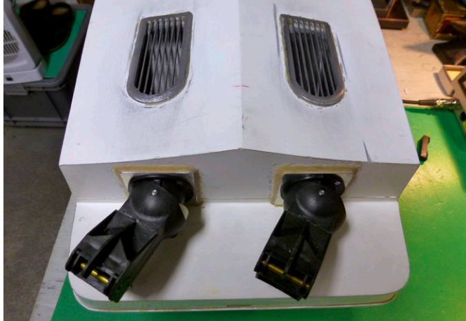
Hier sind die Lagerpunkte der Jet-Düsen zu erkennen. Die Sauggitter sind bereits eingesetzt
