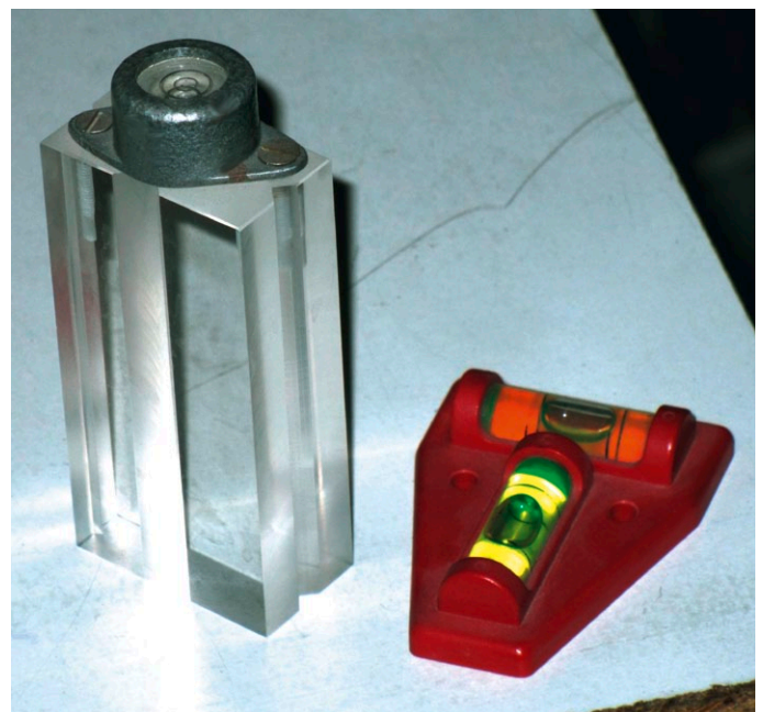
Abbildung 2: Der Plexiglas-Klotz muss genau winklig gefräst werden. Auch die gefrästen V-Nuten liegen gut parallel
