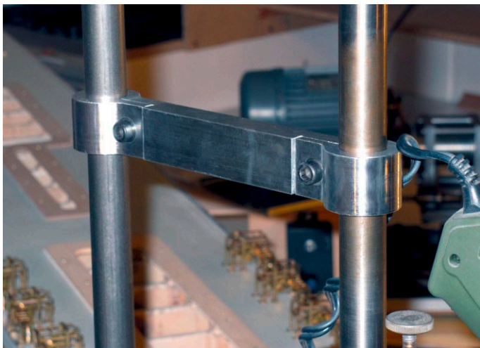
Abbildung 6: Die beiden 20-Millimeter-Bohrungen werden als Schiebeseitz ausgespindelt. Wer hat, der verwendet eine 20-Millimeter-Maschinenreibahle
