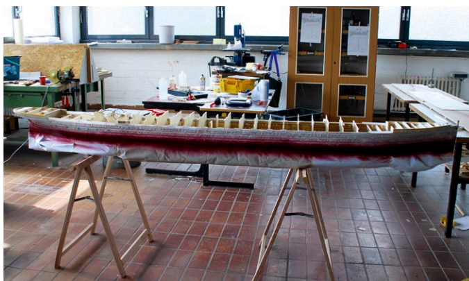
Farbe kommt ins Spiel und die Titanic gewinnt an Authentizität. Verstärkt wird der gelungene Eindruck durch die umgesetzten Plattenbauweise und Bullaugen
