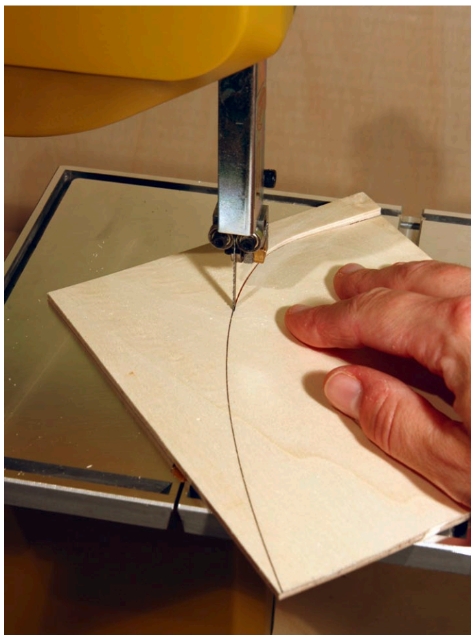
Präzise Kurvenschnitte in großen und engen Radien – maximal 30 Millimeter – sind mit der Proxxon-Bandsäge hervorragend zu meistern
