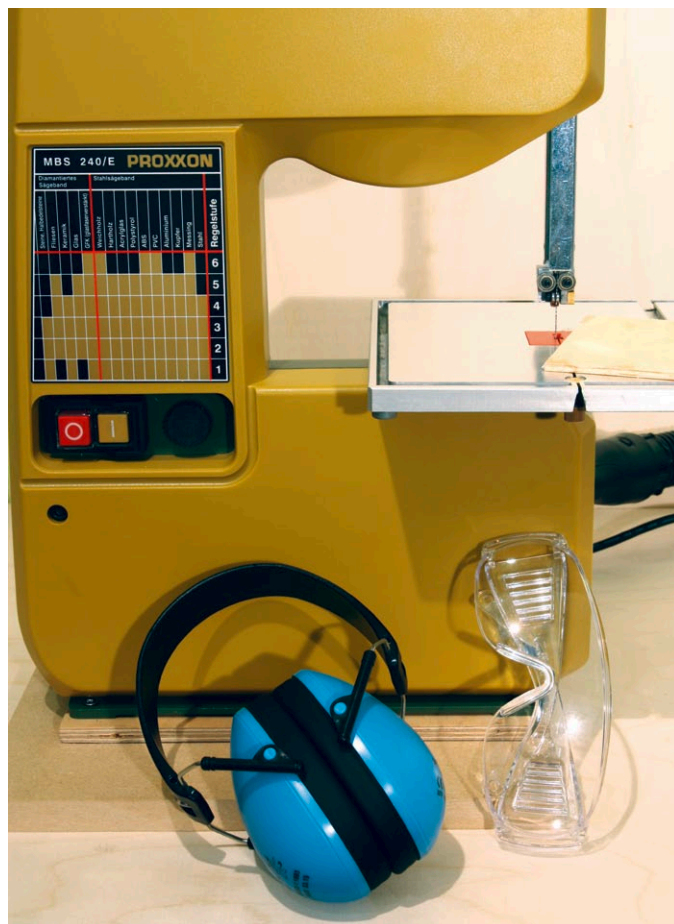
Die Lärmentwicklung der MBS 240/E ist moderat, aber nicht zu unterschätzen. Ein Gehörschutz und eine Augenschutzbrille sollte man immer tragen
