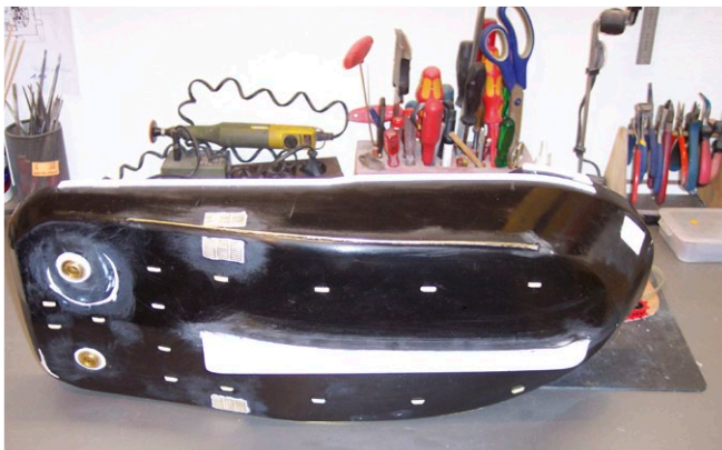
Rumpfunterseite mit Kokern und allen Opferanoden sowie Vorbereitungen für die Antriebe
