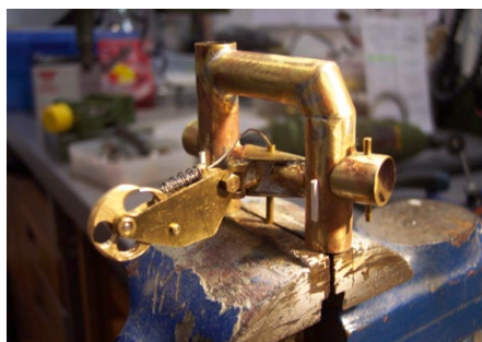
Der Schlepphaken ist funktionsfähig ausgeführt und kann eine eingeklinkte Schleppleine auslösen
