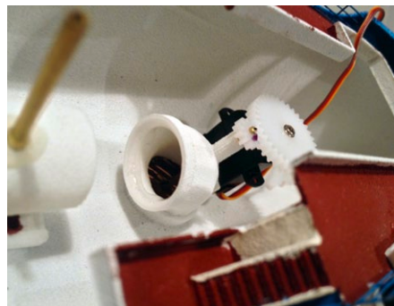
Vorderer Impellerbereich und Leitscheibe samt Servo zu deren Ansteuerung sind eingebaut
