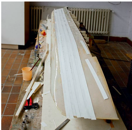
Um die Stahlplatten des Originals zu imitieren, wird der Holzrumpf mit 0,3 Millimeter starken Polystyrolplatten beplankt
