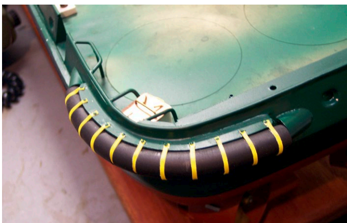
Die achteren Fender sind fertig mit Spanngurten fixiert. Diese bestehen aus farbigem Tesa-Gewebeband
