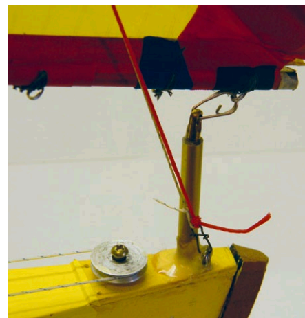
Befestigung des Baums mit einfachen, aber bewährten und effektiven Mitteln
