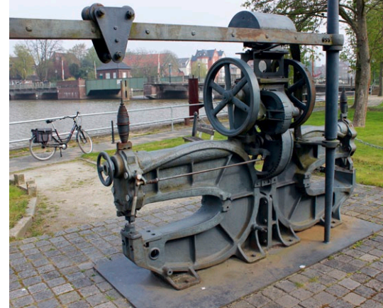
Schiffbau-Schere und -Stanze von 1916 bis 1988 auf der Janssen-Werft in Leer
