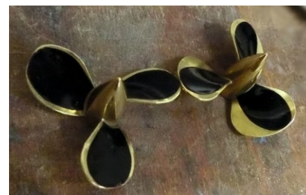
Die Propellerblätter waren auf das erforderliche Maß zu trimmen, wobei Masken halfen
