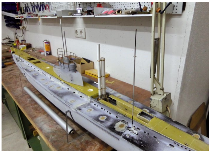
Der Rohbau nimmt zunehmend Gestalt an – hier fluchten Funkmasten, Sehrohre und Schornsteine
