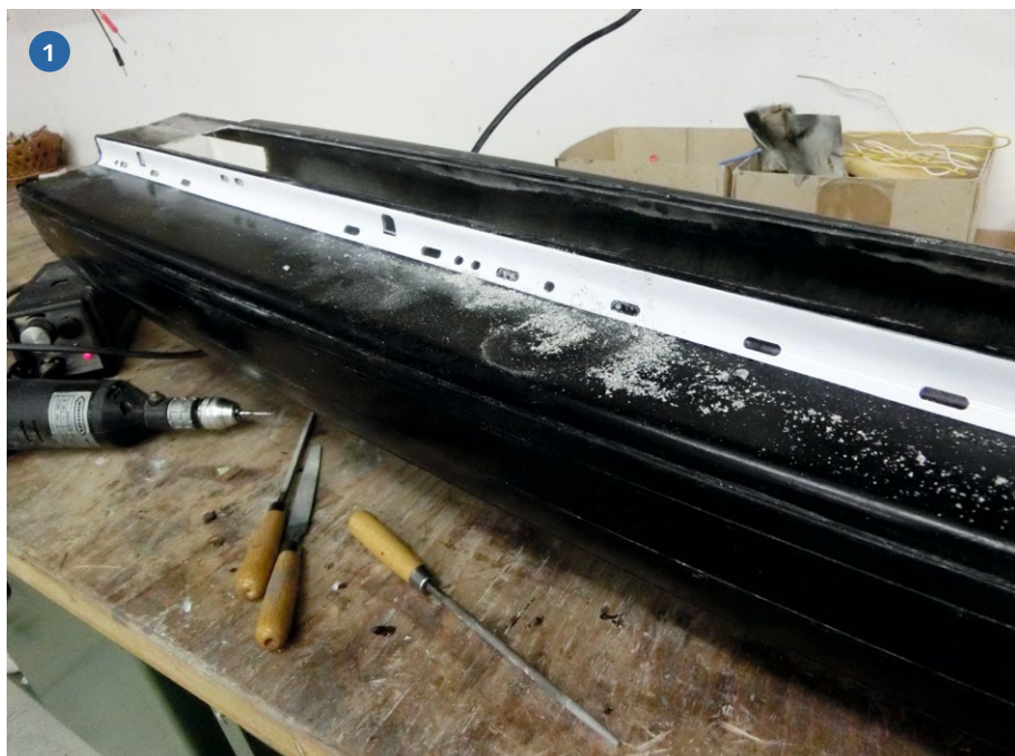
1) Aufgeklebte Maske zum Bohren und Feilen der Flutschlitze. 2) Blick ins Heck mit Durchführungen – die Schraubbefestigungen sind bereits angebracht. 3) Blick in den Vorderteil mit Trimm tanks rechts und links, den Pumpenaufnahmen und den Gewichten, die sich der Rumpfform anpassen
