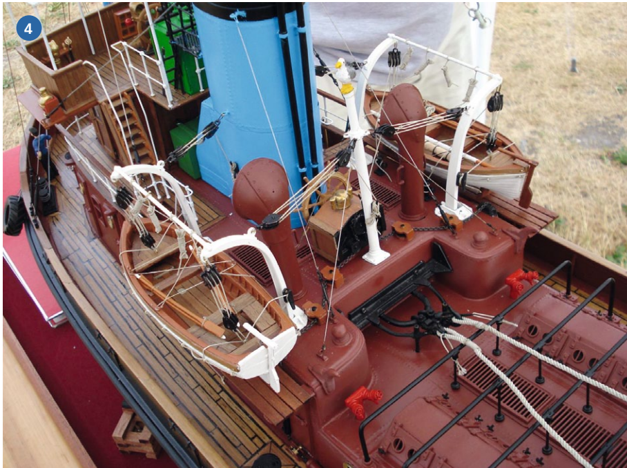
1) Der Behälter für Trossen und die Grätung am Heck entstanden aus Holz. 2) Die offene Brücke und Salon mit Besatzung sowie Kompass. 3) Das Deck achtern mit Tampenkiste, Möwe und etlichen weiteren Schiffsdetails. 4) Zu den Besonderheiten zählen Rettungsboote mit Davits, achterer Steuerstand und der blaue Schornstein. 5) Vorderes Deck mit Ankerwinde und Niedergang
