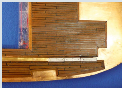
Die Beplankung erfolgte auf Bronzeblech. Hier ist bereits die Kalfaterung eingearbeitet und das Deck geschliffen
