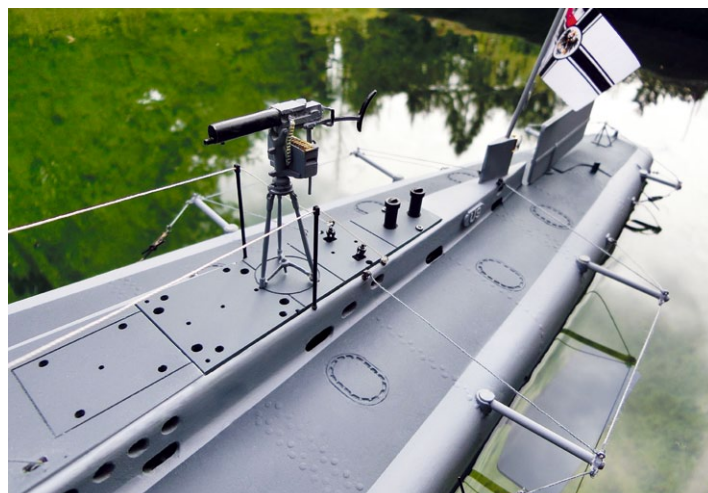
Das Heck mit Abweisern und Maxim MG
