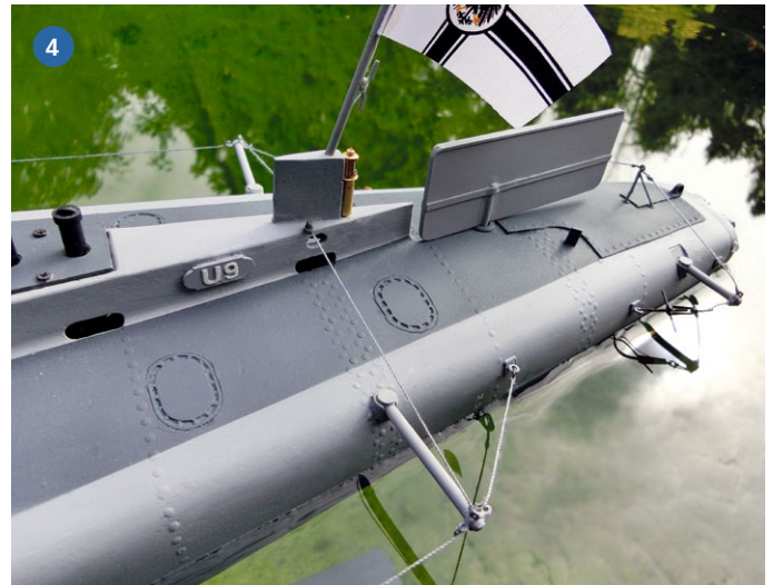
1) Heck und Technikgerüst mit den beiden Kolbentanks. 2) Vor der großen Ausfahrt ist U9 auszutrimmen, damit die Wasserlage in Normal- und Unterwasserfahrt stimmt. 3) Im Vergleich mit modernen U-Booten bietet die SM U9 noch reichlich Gelegenheiten vorbildgetreue Details umzusetzen. 4) Auf dem Achterschiff ist auch oberhalb ein Seitenruder platziert – die Ingenieure glaubten damals, es sei nötig
