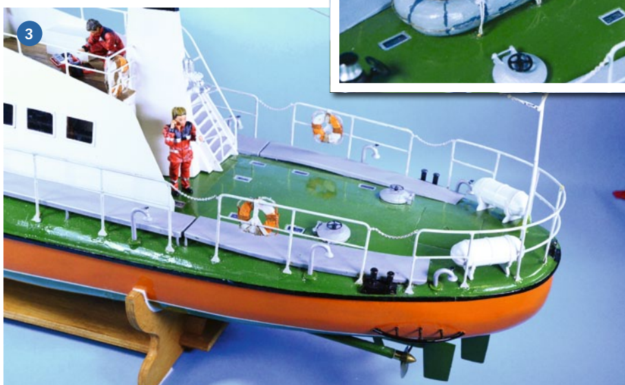
1) Der obere Fahrstand mit dem beleuchteten und voll beweglichen Suchscheinwerfer. 2) Oberlichter im Deck und Fenster im Deckshaus. Das Schlauchboot entstand aus Balsaholz. 3) Der Heckbereich des Modells. Die beiden Figuren tragen zwar ein modernes Outfit, sorgen aber für etwas mehr Leben an Bord des Schiffs. 4) Die Propeller stammen aus dem Sortiment der Firma Bauer Modelle. Eine Besonderheit ist der Abweiser am Rumpf (schwarz lackiert)
