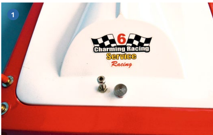
1) Bereits eingelassene Rändelschraube zur Deckelbefestigung an der Rückseite. 2) Der Kurzschlussstecker ist in Eigenleistung eingebaut worden. Praktisch ist die mit einem Gummistopfen gedichtete Entwässerungsbohrung
