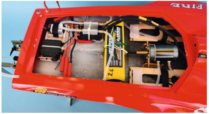
Vorgesehen sind eigentlich zwei 2s-LiPos, doch zum Erreichen einer korrekten Schwerpunktlage ist ein 2s-LiPo hinten quer zu platzieren
