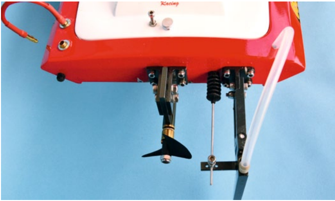
Die anpassbare Propeller- und Ruder-Anlage ist von guter Qualität
