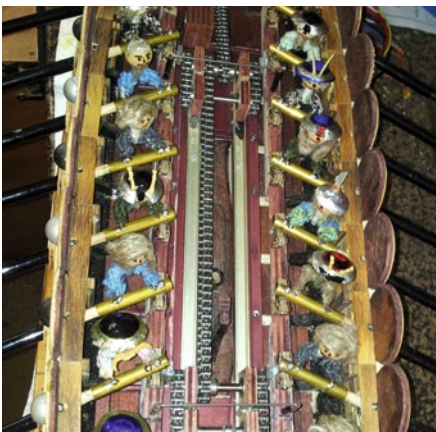
Die Ruder sind alle in Pulkanordnung miteinander und darüber mit dem Exzenter-Antrieb verbunden
