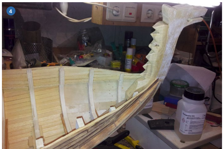
1) Der Bau erfolgte klassisch auf einer Helling. 2) Das Musterstück für die Klinkerbeplankung. Unterhalb ist eine gerade Beplankung und darauf kleben die Klinkerplatten. 3) Um die typische Klinkeroptik zu erzielen, ist etwas Aufwand zu betreiben. 4) Besonders beim Drachenkopf lohnt sich etwas Mühe
