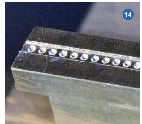
Abbildung 12) Zwei Körnungen, um die Seiten nicht zu verwechseln. Abbildung 13) Die Abstände macht der X-Support sehr genau. Bei „komischen“ Maßen ist höchste Konzentration erforderlich. Abbildung 14) In die Nut wird später der Folienstreifen gelegt
