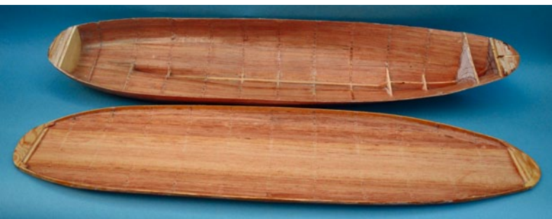
Fertiger Rumpf und Deck. Die Spanten sind herausgebrochen und alles wurde innen und außen laminiert
