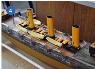
3) Eine Fülle an Ausrüstungsgegenständen entstand als Massenware in Handarbeit, hier die 88-Millimeter-Geschütze. 4) Mit Holzleisten sind die Träger der Barring angepasst. Auf diese Weise lässt sich leicht festlegen, wo Querstreben entlangführen müssen, damit sie später nicht mit Lüfterhauben oder Oberlichtern kollidieren
