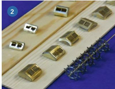
1) Welchen Vorteil ein Einlege- oder auch falsches Deck hat, liegt auf der Hand. Man kann es einfach aus dem Modell herausnehmen und auf der Werkbank weiterbearbeiten. 2) Oberlichter und Notruderstand aus Messing
