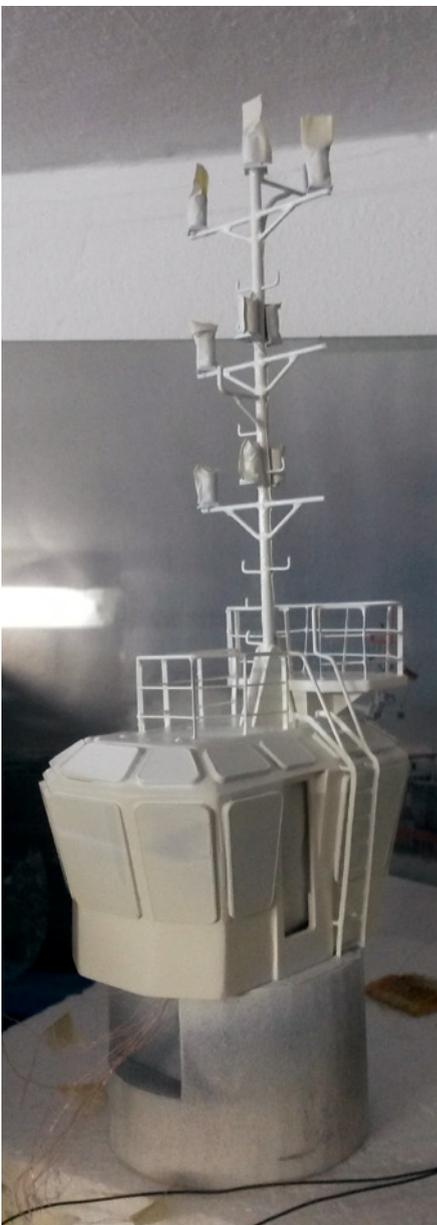
Da alle Fenster mit einer Schutzfolie versehen sind, können das Grundieren und Lackieren direkt erfolgen
