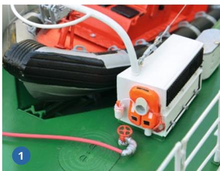
1) Details wie Schlauchanschluss und Decks Luke sind originalgetreu nachgebaut. 2) Auch die Ankerwinde – wie im Original – darf nicht fehlen. 3) Ein Beier-Soundmodul wurde verbaut. Die Zuordnung der jeweiligen Schalter zu den Funktionen wurde am PC dokumentiert. Am Sender sind diese auf einem Hinweisschild, das am Antennenausgang befestigt ist, aufgeführt
