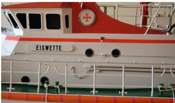
Die Bohrungen in den Relingstützen wurden mithilfe einer aus Messing-Vierkantrrohr gefertigten Schablone angebracht. Die gewählte Bauweise spart Gewicht, erreicht aber nicht die Stabilität einer gelöteten Ausführung
