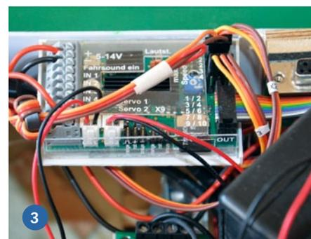
Kapazität für den Fahrmotor, Pumpe und Soundmodul und einen 2s-LiPo mit 5.000 mAh für Empfänger und Bugstrahlruder. Dem Empfänger ist ein Spannungsregler vorgeschaltet. Die elektrische Verbindung vom Rumpf zum Aufbau wird mittels einer fest eingebauten, 15-poligen SUB-D-Steckverbindung hergestellt. Als Radar kommt ein von Bauer-Modelle bezogenes, funktionsfähiges Radar vom Typ Furuno zum Einsatz, das durch eine eigengefertigte Beschriftung ergänzt wurde.
