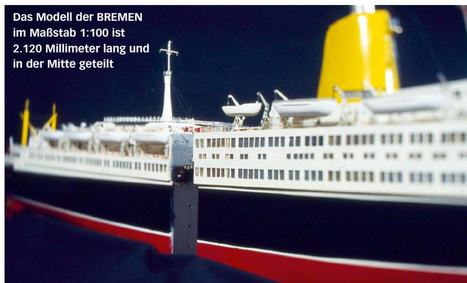
Das Modell der BREMEN im Maßstab 1:100 ist 2.120 Millimeter lang und in der Mitte geteilt
