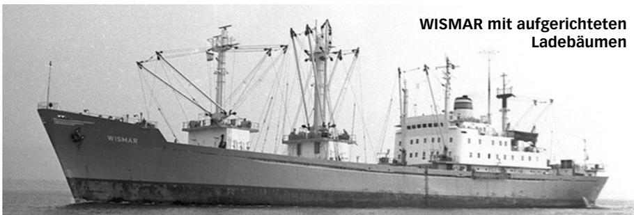
Der Völligkeitsgrad der Verdrängung ( $\phi$ ) beträgt bei großen Frachtern unterschiedlich 68 bis 82 Prozent (%) des umschreibenden (eingetauchten) Quaders (Länge in der KWL  $\times$  Breite (KWL)  $\times$  Tiefgang in m). Der Afrika-Frachter hat  $121,4 \text{ m} \times 17,3 \text{ m} \times 7 \text{ m} = 14.701 \text{ m}^3 \approx 14.701 \text{ ts} \times 75\%$  (mittlerer Völligkeitsgrad  $\phi$ ) = 11.025 ts Verdrängung. ■
