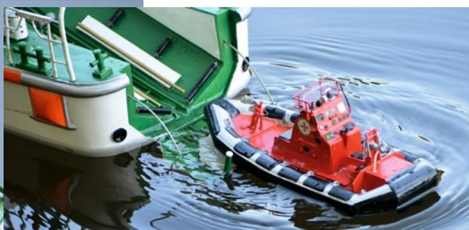
Das Herausrutschen der NOVIZE aus dem Mutterschiff funktionierte nicht auf Antrieb. Die Auslassdüse des Jets verhakte sich an der mittig angebrachten, unteren Führungsrolle. Sie wurde daraufhin entfernt und am oberen Teil der Wanne angebracht. An die seitlichen Auflagen kamen Messingstangen, auf denen das RIB reibungsvermindert aus der Wanne gleiten kann
