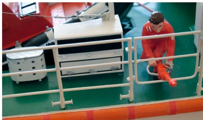
Die EISWETTE verfügt im Original über einen mobilen Löschmonitor. Vom backbordseitigen Anschluss führt ein funktionsloser Schlauch zum knienden Rettungsmann auf die Steuerbordseite
