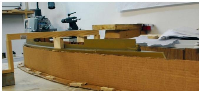
Der charakteristische Streifen zwischen Ober- und Unterwasserschiff ist kein Wasserpass, sondern eine chemische Reaktion des Muntzmetalls auf Salzwasser. Um diesen zu imitieren, half beim Lackieren eine Pappkante
