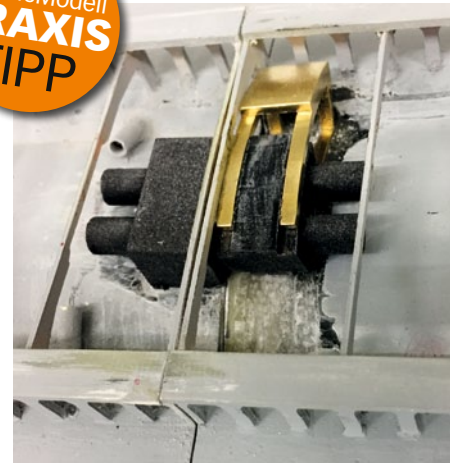
Die beiden Rumpfhälften werden über einen Bajonettverschluss sicher miteinander verbunden. Allerdings erforderte das auch zum Beispiel eine clevere Luftkupplung für die Schläuche des rauchenden Schornsteins. Die Luftkupplung greift in eine Messinggabel und drückt sich an den Rumpf
