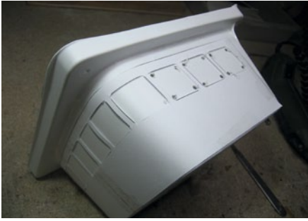
Mit Hilfe einer Schablone lassen sich die exakten Fensterpositionen festlegen und diese dann ausschneiden
