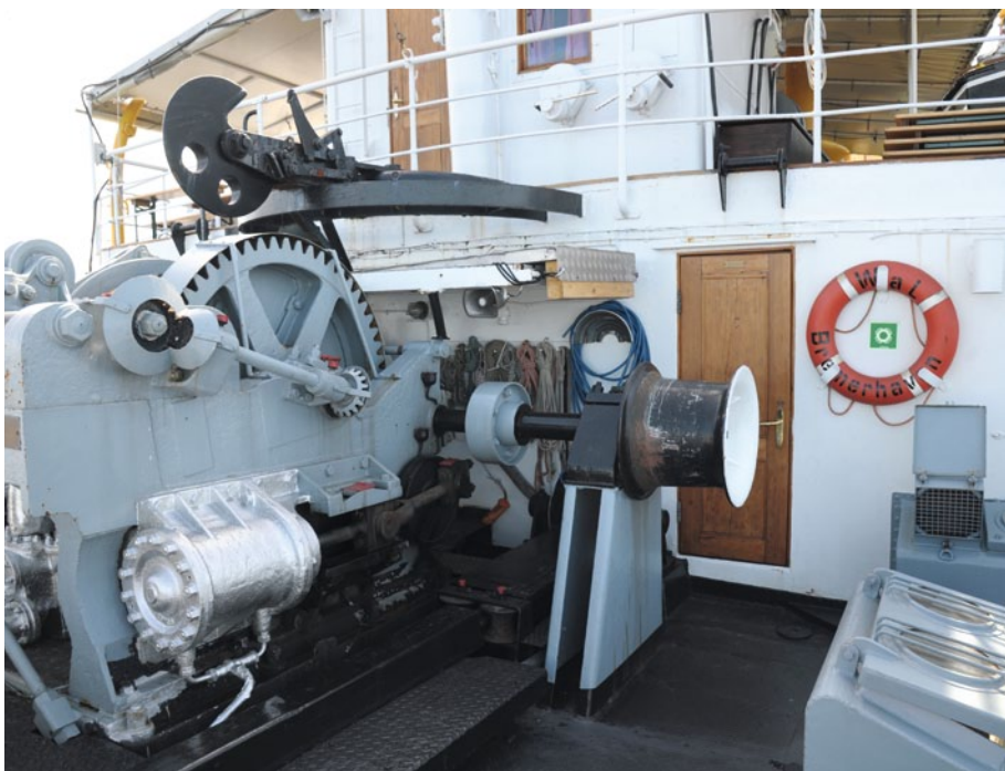
Blick auf einen Teil der imposanten Dampf-Schleppwinde mit Schlepphaken auf dem Schiffsheck
