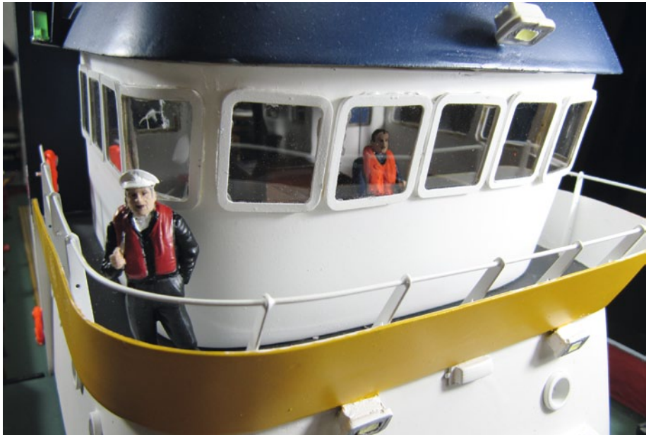
Der Aufbau setzt sich aus einem bunten Materialmix in Form eines GFK-Grundkörpers, Tiefziehteilen und Plattenmaterialien zusammen
