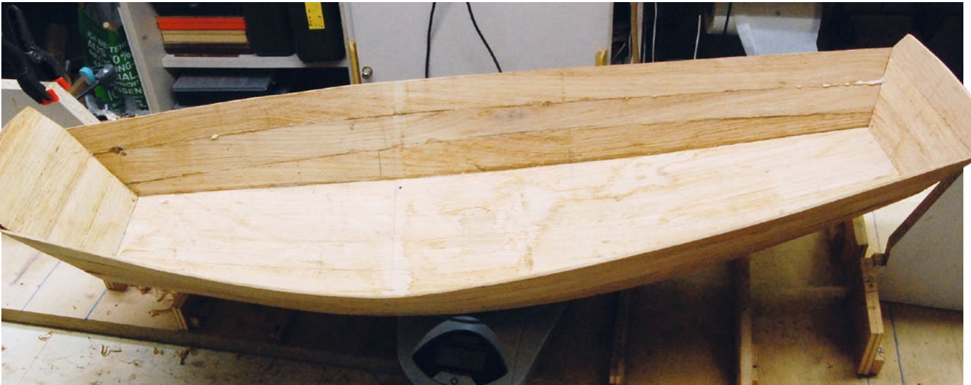
Die Rumpfschale im Rohbau. Die Form wird einzig gehalten, weil das Holz entsprechend gezwungen wurde
