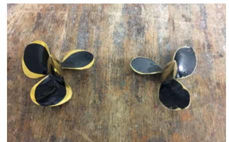
Die Propeller werden verschlankt, um der Optik des Originals zu entsprechen
