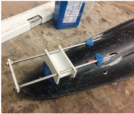
Die Lehre für die Wellenanlage half beim exakt parallelen Einbau
