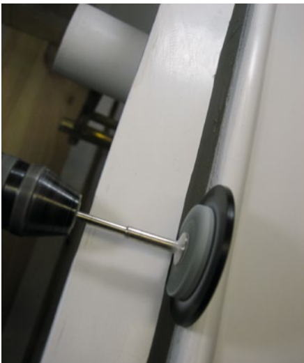
Eine etwas modifizierte Schleifscheibe sorgt für gratfreie, saubere Schlitze
