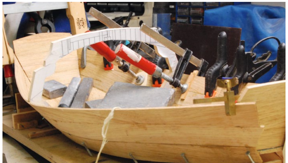
Das Anbringen der letzten Seitenplanke. Ohne den Einsatz von vielen Zwingen wäre dies unmöglich
