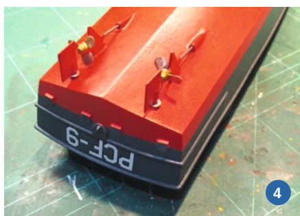
1) Die Wellenanlagen entstanden im Eigenbau, wobei die Wellen aus Silberdraht und die Rohre aus Messing sind. 2) Zwei noch vorhandene China-Noname-Motoren erhielten den Vorzug als Antriebsaggregate. 3) Ein sehr leichter Empfänger mit kleinen, leichten Steckkontakten ist Pflicht – ebenso der Thor-Regler. 4) Glücklicherweise fanden sich in einer Restekiste passende Propeller
