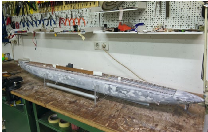
Die Passarelle ist eingebaut und es folgt eine erste Anprobe des Brise-lames
