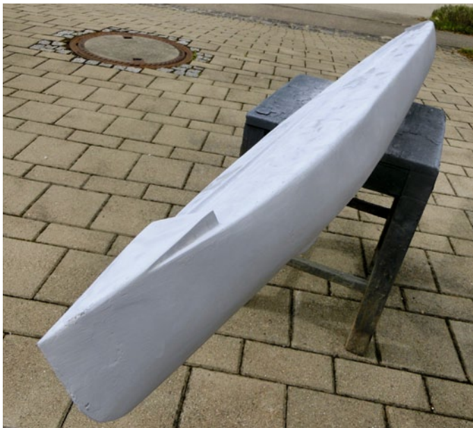
Der Schäumling erhielt ein Gips-Kleid, was im Nachhinein jedoch noch Epoxid-Auflagen erforderte
