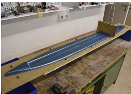
Im Prinzip sollte der Rumpf aus vier Teilen entstehen, darum war das Urmodell mit Trennbrettern vor dem Laminieren zu teilen
