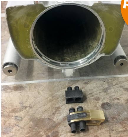
Die beiden Rumpfhälften werden über einen Bajonettverschluss sicher miteinander verbunden. Allerdings erforderte das auch zum Beispiel eine clevere Luftkupplung für die Schläuche des rauchenden Schornsteins. Die Luftkupplung greift in eine Messinggabel und drückt sich an den Rumpf
