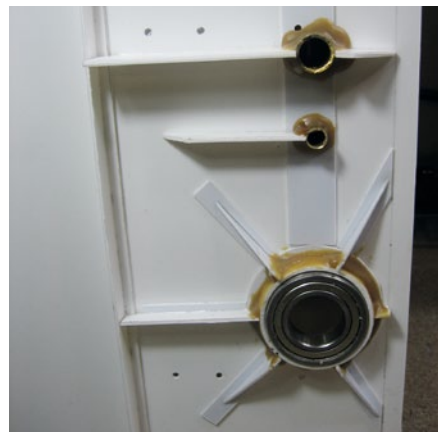
Blick auf die Kranaufgabe mit integriertem doppelten Kugellager und Durchführung der Energiezuführung der Kranbewegung
