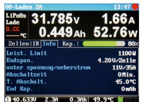
wird endgültig dadurch klar, dass auch die Höhe der Balancerströme als farbiges Balkendiagramm dargestellt werden. Außerdem lassen sich die aktuellen Einstellungen für die Sicherheit des Vorgangs sowie der Spannungsquelle abrufen.
