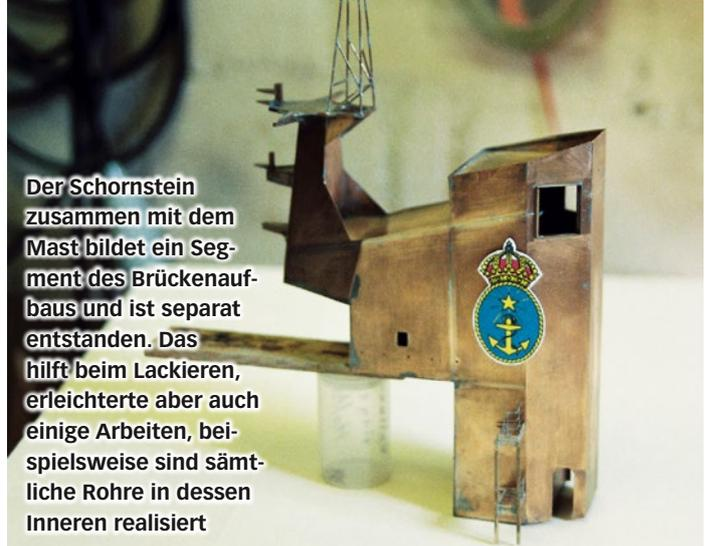
Der Schornstein zusammen mit dem Mast bildet ein Segment des Brückenaufbaus und ist separat entstanden. Das hilft beim Lackieren, erleichterte aber auch einige Arbeiten, beispielsweise sind sämtliche Rohre in dessen Inneren realisiert
