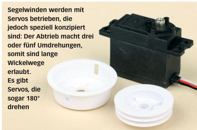
Segelwinden werden mit Servos betrieben, die jedoch speziell konzipiert sind: Der Abtrieb macht drei oder fünf Umdrehungen, somit sind lange Wickelwege erlaubt. Es gibt Servos, die sogar 180° drehen
