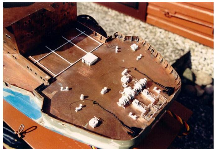
Auf dem Backdeck markant sind die Ankerwinden samt zugehörigen Ausrüstungsgegenständen – hier schon grundiert, aber noch in der Rohbauphase
