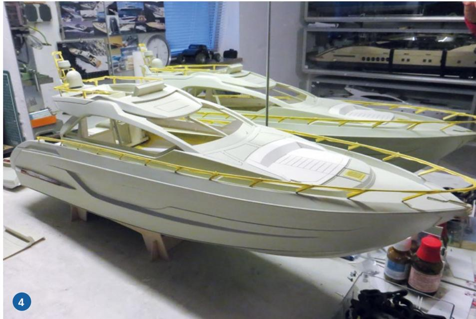
3) Das fertige Sonnendeck am Heck. Das Original verfügt hier über eine Badeplattform, die sich unter die Wasseroberfläche bewegt. Die Umsetzung im Modell wurde jedoch für zu aufwändig erachtet. 4) Die fertig geschliffene und grundierte Yacht. Den Farbanstrich übernahm ein professioneller KFZ-Lackierer
