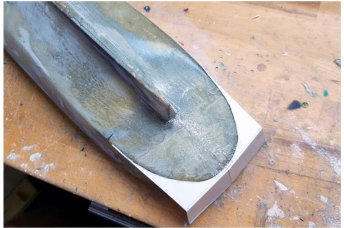
Bei den Originalbooten passte man später das Heck an und so erhielt auch der Nachbau ein Spiegelheck
