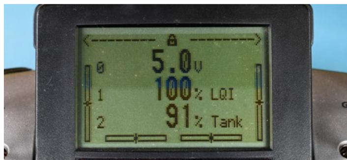
**Anzeige des LiPo-Savers Adresse 2 am Sender direkt nach dem Einschalten für zirka 10 Sekunden (Akkuladezustand in %)**
