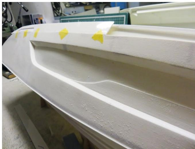
Ein schwerer Schritt, aber einer, der sein muss: Nachdem die Rumpfform steht, werden seitlich Einschnitte angefertigt ...
