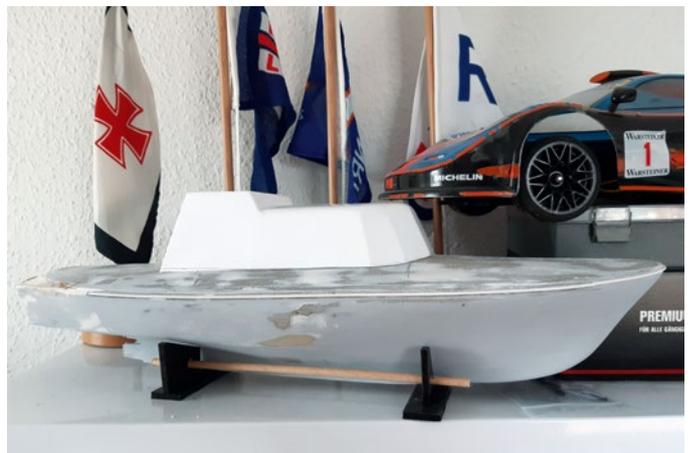
Eine extra hergestellte Tiefziehform der Kabinenhaube erleichtert den Aufbau erheblich
