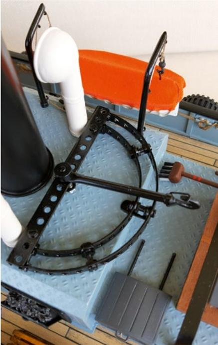
Der Schleppbock entstand aus Zubehör eines Metallbaukastens und dem manuell aus Alublech gefeilten Haken
