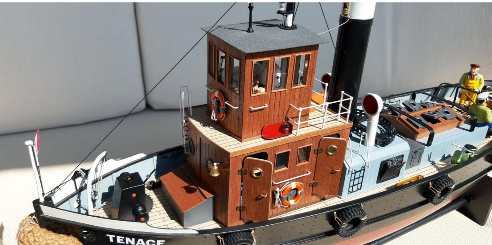
Die italienischen Dampf-Hafenschlepper verfügen über einen dreistufigen Hauptdecksaufbau mit Aufenthalts- und Arbeitsräumen auf dem Vorschiff. Darüber und fest verbunden ist das Ruderhaus montiert. So wurde es auch bei der TENACE umgesetzt
