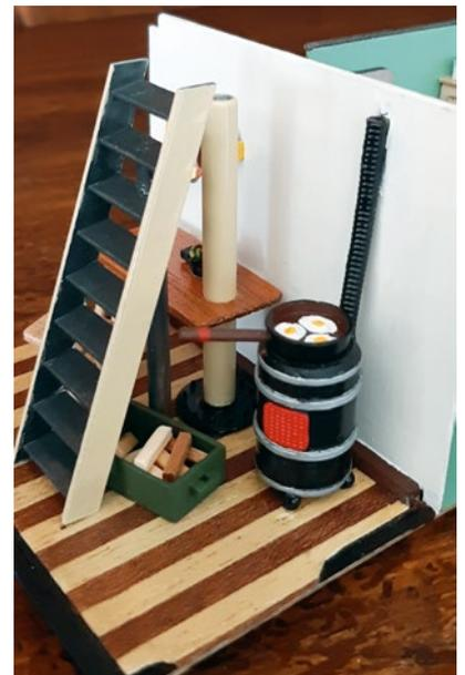
Die Inneneinrichtung der TENACE im Hauptdeck-Aufbau ist mittels einer Stellschraube im unteren Mastende fixiert und en bloc herausnehmbar. Neben einer Werkstatt gibt es ein „Schiethus“ sowie eine kleine Kombüse
