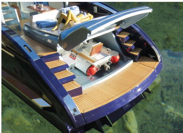
Die Heckklappe kann über einen Servoantrieb ferngesteuert geöffnet werden. Darin befindet sich ein ebenfalls selbstgebautes Tenderboot
