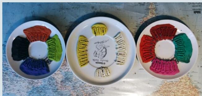
Die Serienproduktion der Kanonenhälften erfolgt ganz simpel mit Knetmasse und Gießharz
