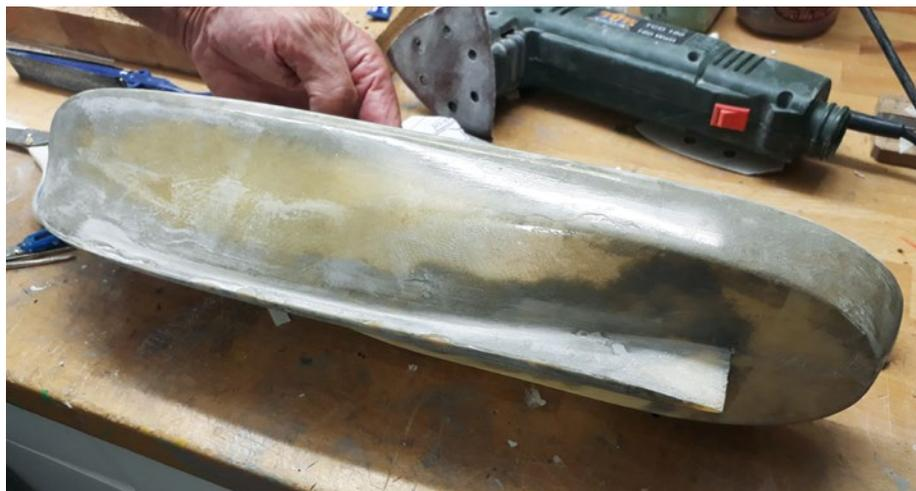
Das Urmodell wurde so gebaut, dass durch die vertikale Teilung der Negativform eine linke und rechte Rumpfhälfte entstanden, die zu verkleben waren
