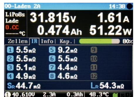
1) Beim Laden werden die wichtigsten Parameter übersichtlich visualisiert. 2) Hier dargestellt ist die Anzeige der Innenwiderstände. 3) Darstellbar ist zudem die ge- oder entladene Kapazität der einzelnen Zellen. 4) So können während eines Vorgangs die wichtigsten Systemparameter abgerufen werden
