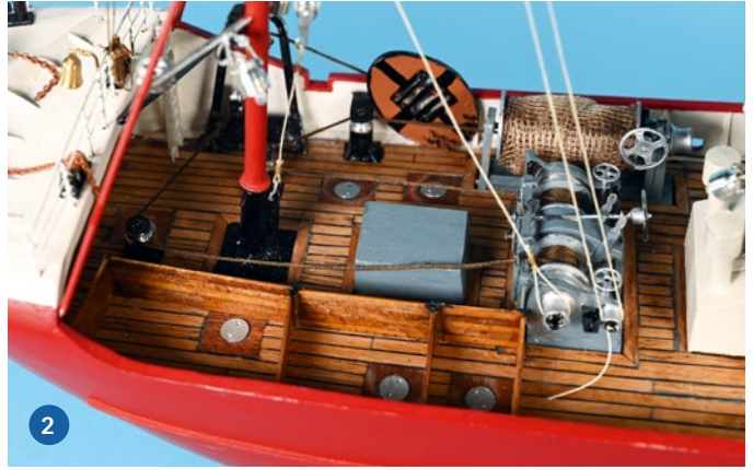
1) Die Ankerketten wurden einer künstlichen „Rostkur“ unterzogen. Schließlich sind sie beim Original auch nicht mehr taufersch. 2) Blick auf das Mittschiff. Unter der grauen Abdeckung ist der Ein-Aus-Schalter versteckt. 3) Der Mast mit Antennen und Beschlügen unterstreicht den vorbildgetreuen Charakter des Modells. Die komplette Beleuchtung darf natürlich nicht fehlen
