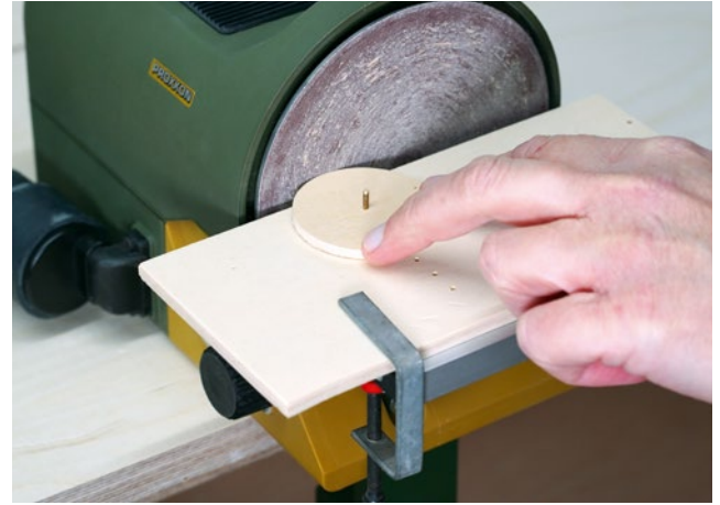
Absolut kreisrunde Scheiben gelingen unter Verwendung einer Hilfsvorrichtung
