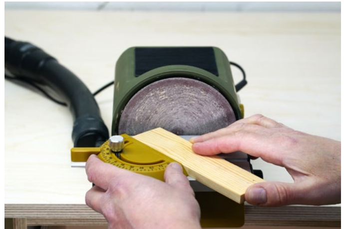
Mit Anschlagwinkel sind Schrägen zwischen 1° und 89° beziehungsweise rechte Winkel umsetzbar
