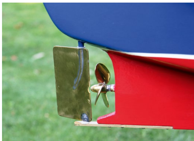
Eigenbau-Ruderanlage und zugekaufter Messingpropeller
