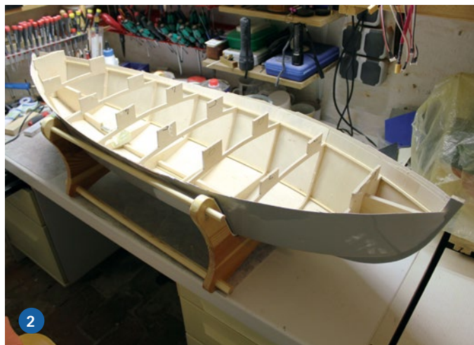
1) Der Rumpf entsteht über Kopf aus Sperrholzspanten. 2) Nachdem das Spantengerüst fertiggestellt war, konnte es ans Beplanken gehen. 3) Der Einbau der Wellenanlage erfolgt. 4) Der Bürstenmotor Power 755/40 von robbe hat ausreichend Leistung für das Modell
