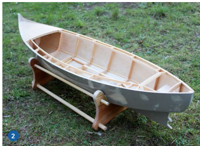
1) Im Heck ist alles vorbereitet für den Einbau der Ruderanlage. 2) Der Rumpf wurde in mehreren Gängen gespachtelt und geschliffen, um ihn auf die Lackierung vorzubereiten. 3) Auch die Kajüte nimmt langsam Form an. 4) Aus Platzgründen wurde bei der Ruderanlenkung ein Riemenantrieb gewählt
