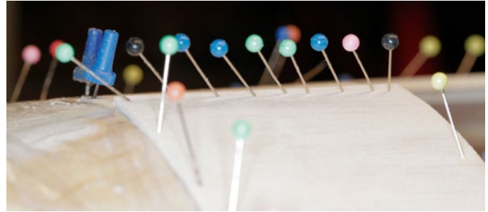
Scharf geschliffene Langstielier werden dicht zusammen schräg eingebracht und fixieren so im Verschränkungsprinzip die Planke
