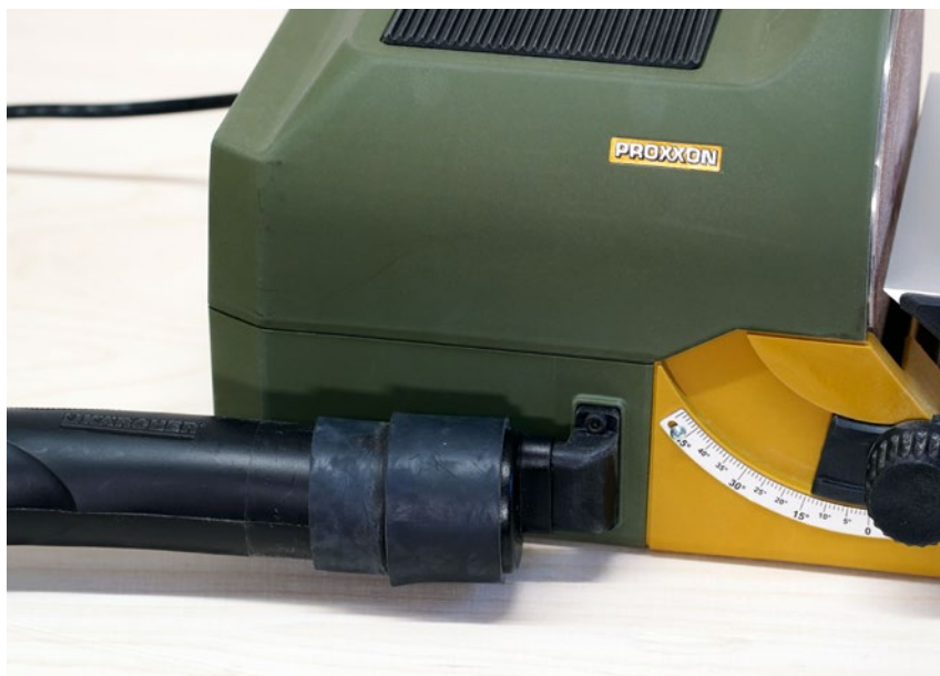
Ein absolutes Muss ist die Nutzung der Staubabsaug-einrichtung, die zudem sehr effektiv arbeitet
