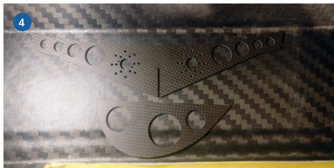
1) Auch die Akkugehäuse wurden via CAD modelliert. 2) Fertige Gehäuse inklusive Abstandsbolzen und 6-mm-Einbaubuchsen. Der „kleine“ Motor (wird nicht eingesetzt) schafft eine Perspektive für die Größe, es ist ein LMT 3080. 3) Selbstverständlich entstand auch der Motorspant zunächst als CAD-Entwurf. 4) Aus 3,5-mm-CFK-Material wurden dann die Motorspantteile gefräst
