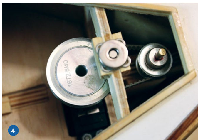
1) Im Heck ist alles vorbereitet für den Einbau der Ruderanlage. 2) Der Rumpf wurde in mehreren Gängen gespachtelt und geschliffen, um ihn auf die Lackierung vorzubereiten. 3) Auch die Kajüte nimmt langsam Form an. 4) Aus Platzgründen wurde bei der Ruderanlenkung ein Riemenantrieb gewählt
