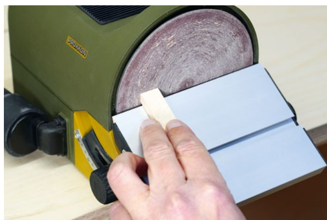
Exakte Winkel schleifen, ist mit dem TG 125/E sehr gut möglich, da der Arbeitstisch im Bereich -10° bis 50° verstellbar ist
