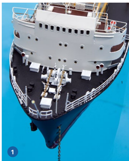
1) Die Ankerwinde verfügt über eine Freifallfunktion. Damit sie richtig arbeitet, musste allerdings der Anker beschwert werden. 2) Ihre Jungfernfahrt erlebte die MS LINDENFELS in Wildeshausen
