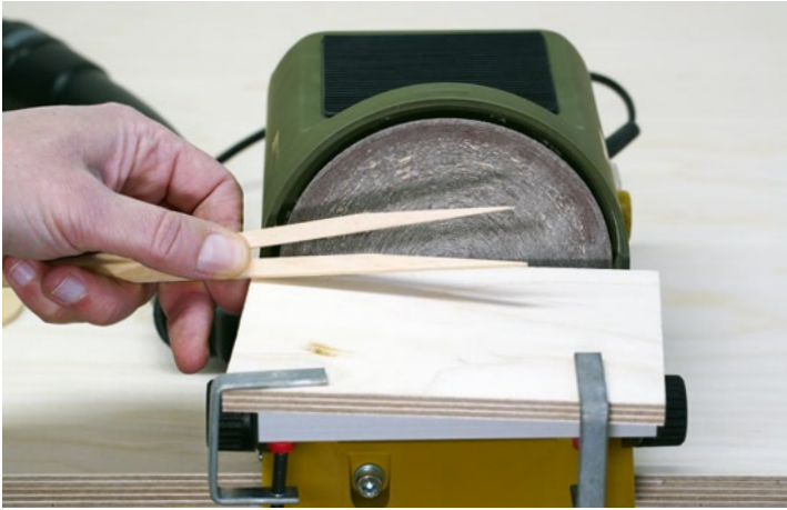
Unter Zuhilfenahme von Hilfswerkzeugen, hier ein festgeklemmtes Brett, kann man lange Schrägen zum Schäften schleifen
