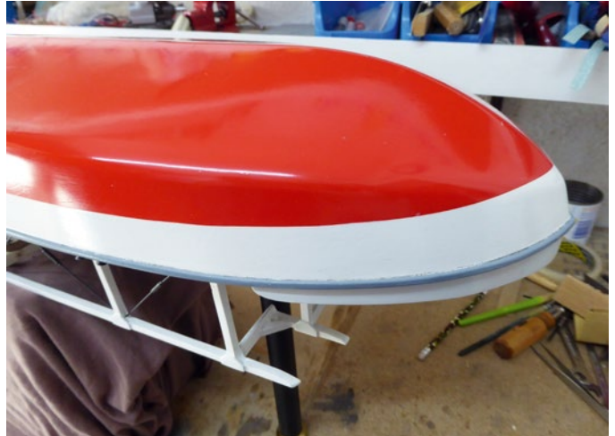
Das Original-Unterwasserschiff sollte eine Aufdoppelung erhalten, um den Auftrieb beziehungsweise Tiefgang zu erhöhen
