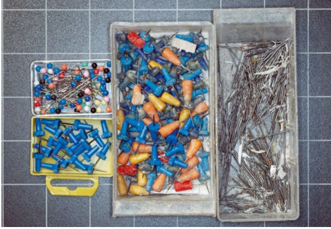
Verschiedene Nadeltypen: links Stahlnadel halbstumpf (oben) und Blaukopf kurz scharf (unten), mittig altgediente Nadeln und rechts langstielige, scharfe Nadeln
