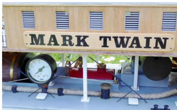
Über den Druck im Kessel informiert das maßstäblich etwas überdimensionale Manometer
