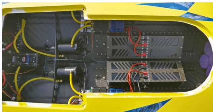
Die vollständig ausgerüstete HUNTER mit MBP-Motoren und Turnigy-Regler sowie -LiPos ist bereit für die erneute Jungfernfahrt
