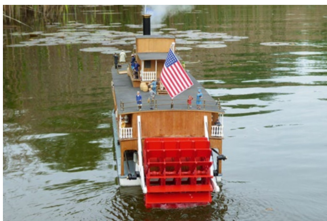
Der Betrieb über ein Heckrad ist etwas Besonderes – die Manövrierfähigkeiten aber sind denkbar schlecht
