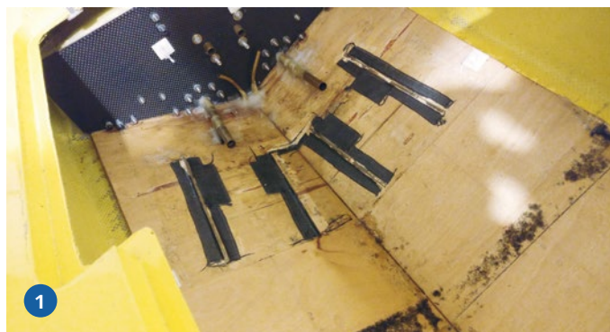
1) Die Motorhalter mit wassergekühltem Flansch sind draußen, jetzt beginnt der schwierige Teil. 2) Stück für Stück wird das Sperrholz mit Hilfe von Schraubendreher ausgestemmt. 3) Nicht alle Sperrholzteile lassen sich direkt entfernen, sondern Farbe und Harzreste müssen abgeschliffen werden. 4) Abdeckung des Deckelausschnitts mit Folie und gleichzeitiges Absaugen helfen, den Schleifstaub nicht in der ganzen Werkstatt zu verteilen
