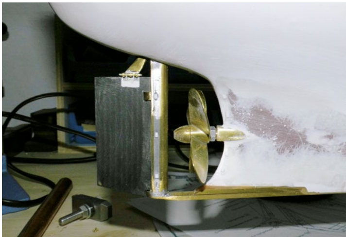
Ein Nachteil dieser Ruderkonstruktion besteht darin, dass man die Welle mit Propeller nicht einfach nach hinten herausziehen kann
