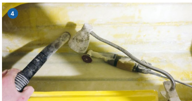
1) Die Motorhalter mit wassergekühltem Flansch sind draußen, jetzt beginnt der schwierige Teil. 2) Stück für Stück wird das Sperrholz mit Hilfe von Schraubendreher ausgestemmt. 3) Nicht alle Sperrholzteile lassen sich direkt entfernen, sondern Farbe und Harzreste müssen abgeschliffen werden. 4) Abdeckung des Deckelausschnitts mit Folie und gleichzeitiges Absaugen helfen, den Schleifstaub nicht in der ganzen Werkstatt zu verteilen
