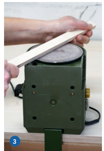
1) Zum Demontieren des Arbeitstischs ist eine Inbusschraube zu lösen. 2) Dank Silikonbeschichtung lassen sich Schleifscheiben einfach lösen und mehrfach verwenden. 3) Ohne Arbeitstisch und in Hochkant-Position ist möglich, aber eine Lösung für die Absaugung erforderlich
