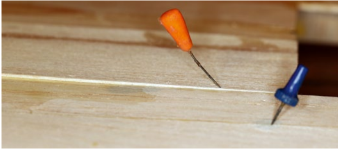
Eine Nadel ohne Charakter verbiegt sich beim Einstechen in einen härteren Untergrund
