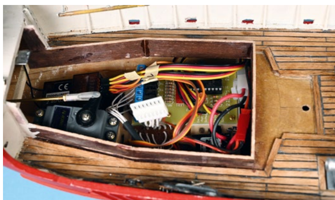
Unter Deck geht es eng zu, aber der Einbau der RC-Anlage gelang auch im Modell problemlos
