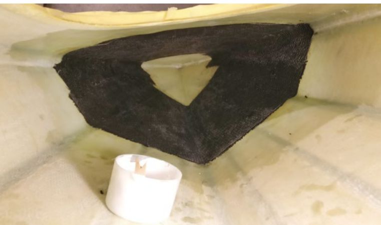
Verstärkung im Vorschiff mit je zwei Lagen Biaxialgewebe
