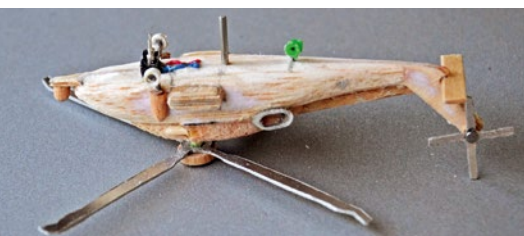
Das Rohmodell des Seahawk-Hubschraubers von unten. Zu sehen sind die Stromzuführung und der zusätzlicher Haltestift
