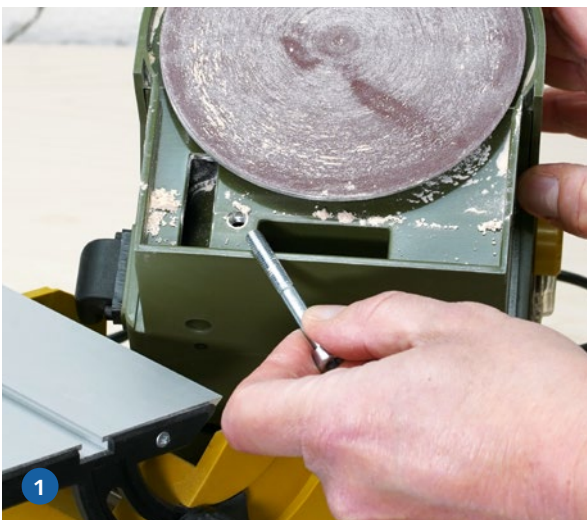
1) Zum Demontieren des Arbeitstischs ist eine Inbusschraube zu lösen. 2) Dank Silikonbeschichtung lassen sich Schleifscheiben einfach lösen und mehrfach verwenden. 3) Ohne Arbeitstisch und in Hochkant-Position ist möglich, aber eine Lösung für die Absaugung erforderlich
