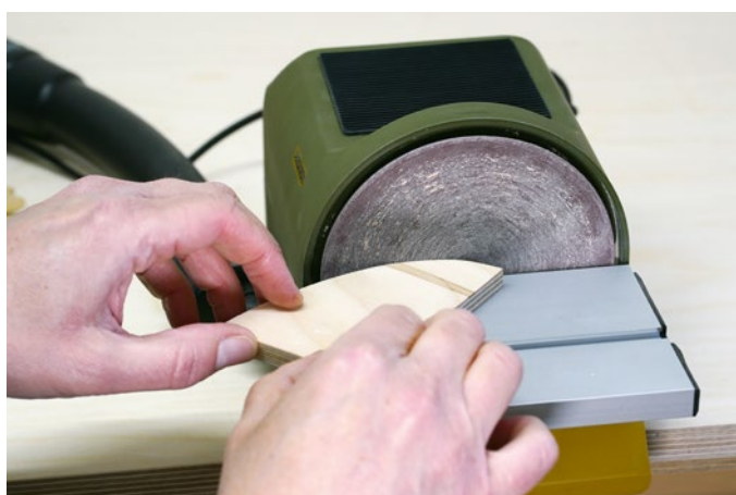
Freihand geführte Schleifarbeiten lassen sich sehr gut umsetzen. Der Abtrag bei Harthölzern ist sehr gut
