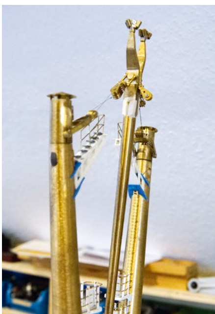
Der 120-t-Ladekran entstand aus zahlreichen verlöteten Messingteilen und Polystyrol
