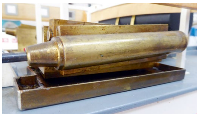
Blick auf einen der beiden in die Jahre gekommene Kolben. Korrosion hat sichtbare und versteckte Spuren hinterlassen
