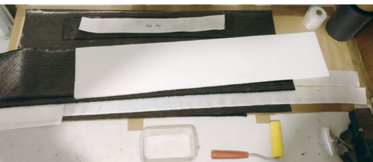
Diverse Gewebezuschneitte und die beiden Sandwichplatten zur Verstärkung des Rumpfbodens
