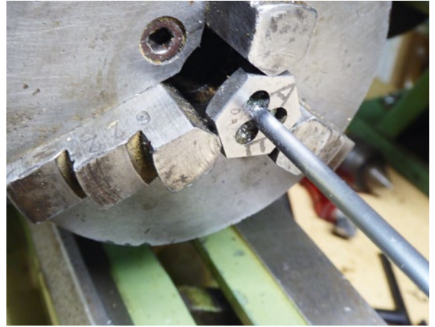
Es waren eine Reihe von Gewinden zu schneiden, die auch Spuren bei den Gewindeschneidern hinterließen
