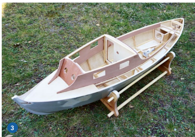
1) Im Heck ist alles vorbereitet für den Einbau der Ruderanlage. 2) Der Rumpf wurde in mehreren Gängen gespachtelt und geschliffen, um ihn auf die Lackierung vorzubereiten. 3) Auch die Kajüte nimmt langsam Form an. 4) Aus Platzgründen wurde bei der Ruderanlenkung ein Riemenantrieb gewählt
