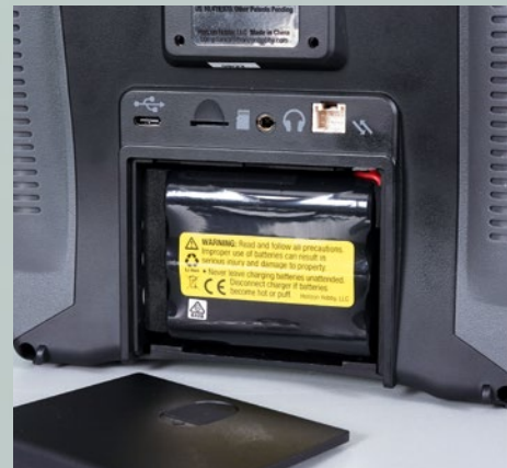
Ein 1s-Li-ion-Akku mit 10.500 mAh Kapazität gestattet viele Stunden Betriebsbereitschaft
