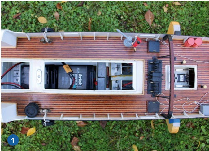
1) Akkus und Servo sind von oben gut zugänglich. 2) Ein Soundmodul darf bei einem solchen Modell natürlich nicht fehlen. Der Lautsprecher war zunächst im Aufbau platziert, wanderte dann aus Schwerpunktgründen jedoch in den Rumpf
