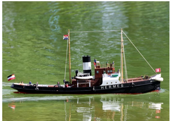
Die Verspannungen bestehen aus dünner Gummilitze, da die Masten beim Transport abgebaut werden
