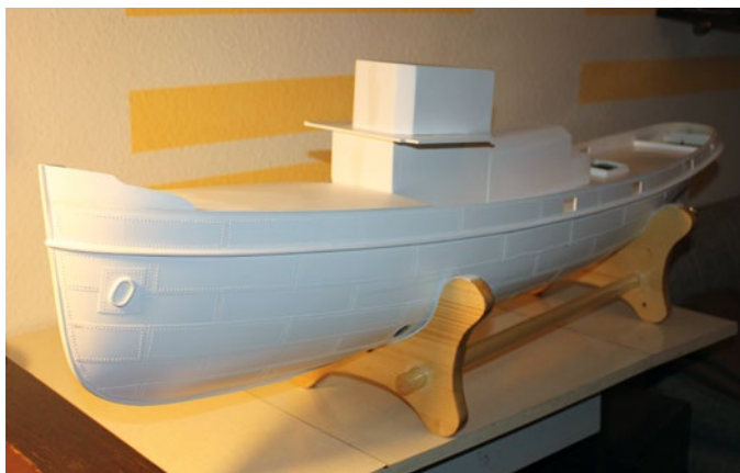
Rumpf und Aufbauten der HERMES bestehen komplett aus GFK
