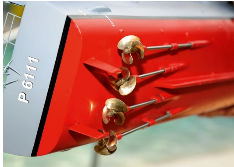
Die Propeller sind aus Messingguss und haben die typische Plattform der Sboot-Props mit den großen Blättern
