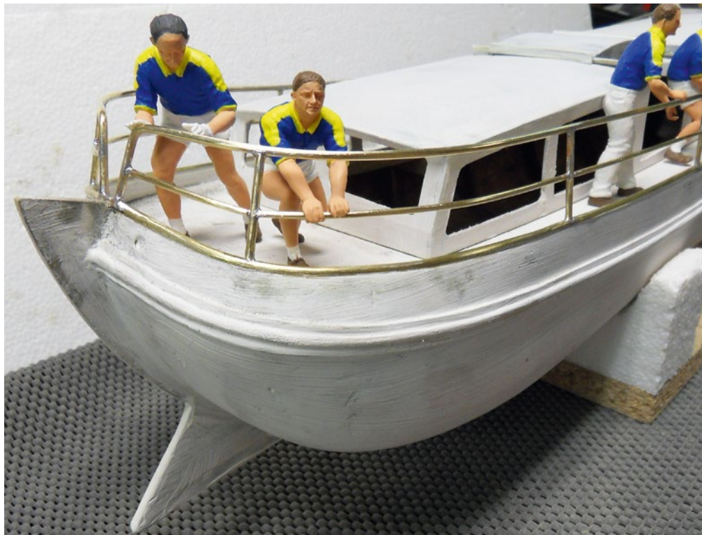
Die Reling wurde in vorgebohrte Löcher gesteckt und dann mit dem Schanzkleid verlötet
