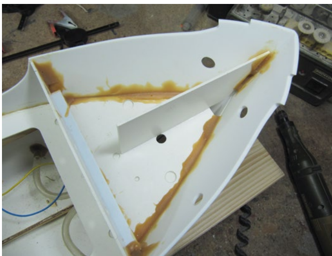
Als Decksauflage, die auch den Deckssprung vorgibt, ist ein senkrecht Schot im Bug eingeklebt
