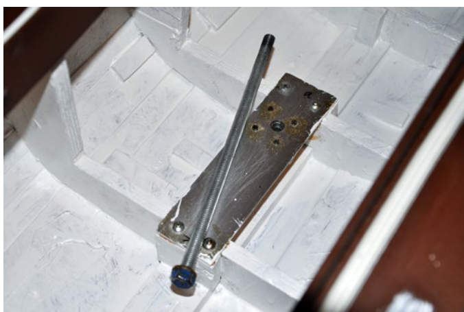
Rumpfunterteil mit Haltebolzen. Letzterer fixiert nicht den Kiel, sondern presst das Oberdeck auf den Unterrumpf
