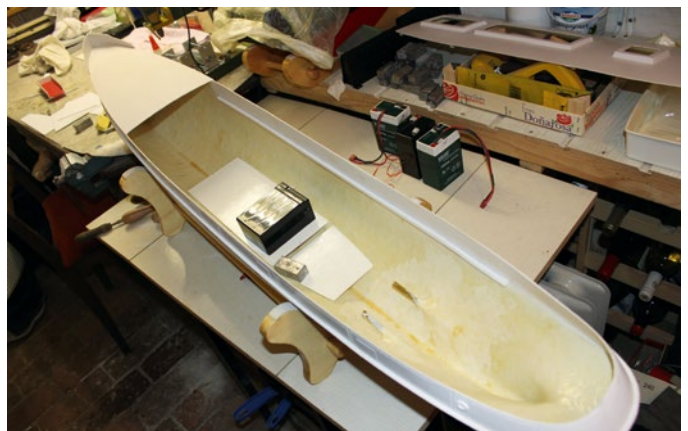
Eine erste Anprobe der Halteplatten für Akkus und Motoren gibt Aufschluss über die Raumaufteilung im Rumpf
