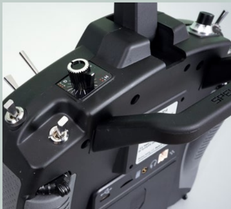
Über drei Drehgeber lassen sich proportionale Funktionen steuern
