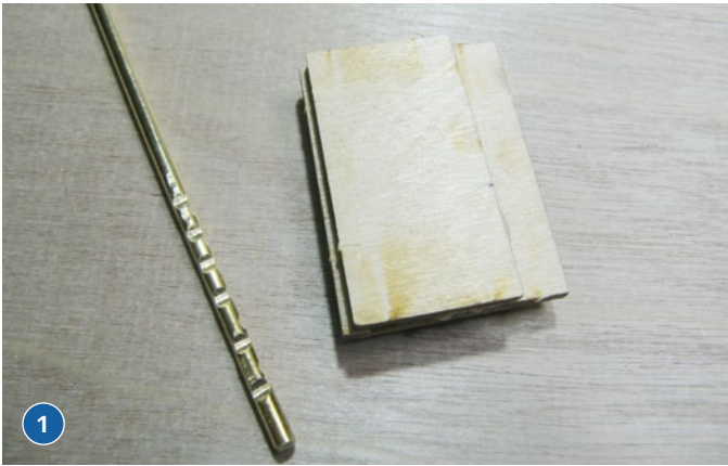
1) Aus Brettchen ist das Ruder zusammensetzen. Die nachträglich eingebrachten Vertiefungen in der Ruderwelle dienen nach dem Festkleben als Verdrehssicherung. 2) Einige Elemente sind stumpf auf Rumpf oder Deck zu kleben
