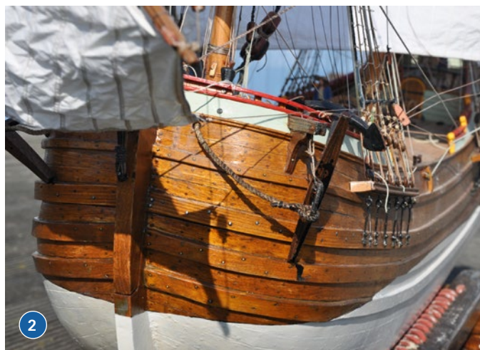
1) Besatzungsmitglied vor dem Großmast. Im Hintergrund noch zu erkennen eine Bilgepumpe. 2) Am Bug ist die Rumpfteilung am Steven erkennbar. Der Rumpf ist in Holz-Epoxi-Furnier-Bauweise entstanden. Außen war feinmaseriges Furnierholz erforderlich
