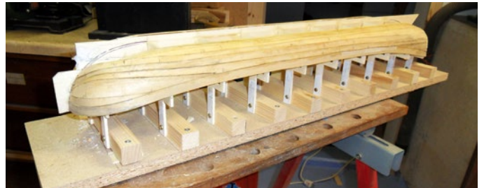
Um starke Rundungen nachbilden zu können, wurde das Holz gewässert und während der Trocknung in der späteren Form fixiert
