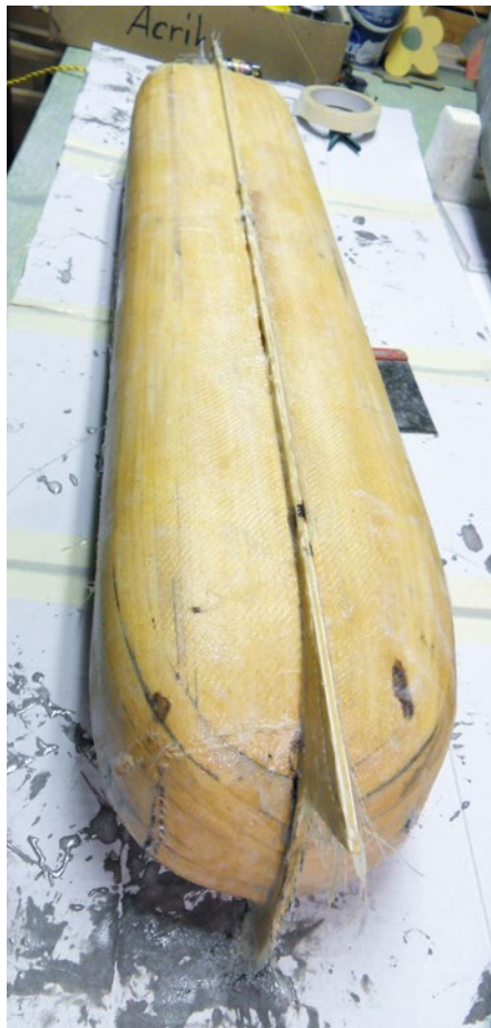
Von außen wurde der Rumpf mit Glasfaser und Epoxidharz versiegelt
