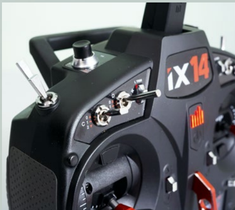
Die Schalter sind frei konfigurierbar und berührungsempfindlich für eine Sprachausgabefunktion
