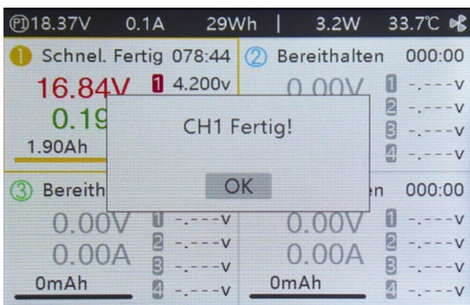
Der Ladevorgang ist beendet, der Akku ist voll aufgeladen und gut balanciert
