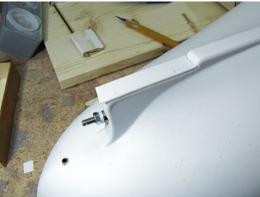
Unterfütterung der Ruderhacke zur Kompensation der Tiefziehradren
