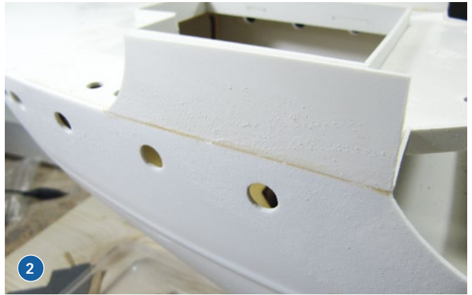
1) Aus Brettchen ist das Ruder zusammensetzen. Die nachträglich eingebrachten Vertiefungen in der Ruderwelle dienen nach dem Festkleben als Verdrehssicherung. 2) Einige Elemente sind stumpf auf Rumpf oder Deck zu kleben
