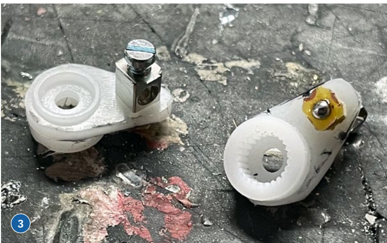
3) An den Ruderservos werden die Gestänge beweglich befestigt. 4) Eine Krimpzange für die Befestigung der Gestänge am Ruder
