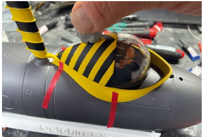
Die lackierte Kuppel wird aufgeklebt
