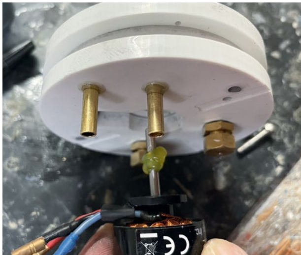
Die Motorwelle wird eingefettet und der Motor angeschraubt
