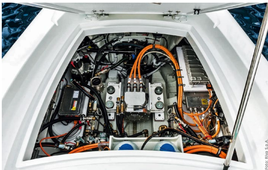
Die elektrische Antriebstechnik der EL-ISEO
