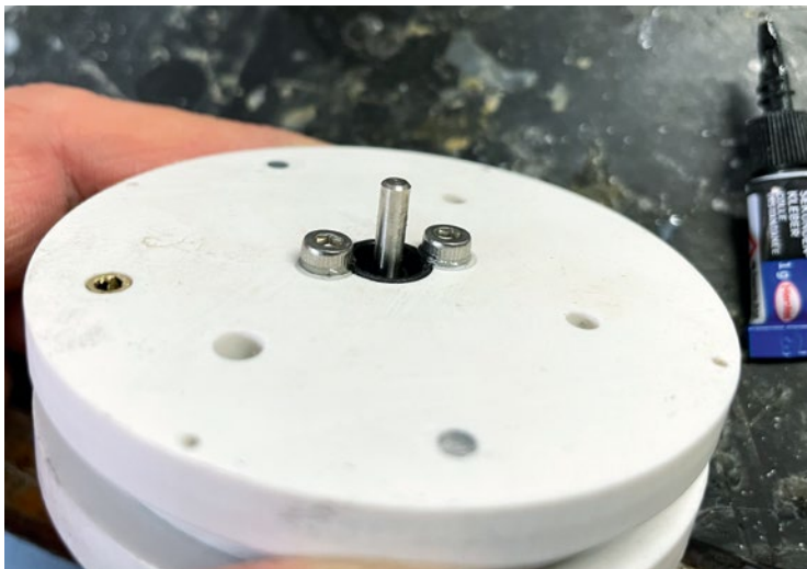
Der Simmerring für die Durchführung der Motorwelle wird eingepresst
