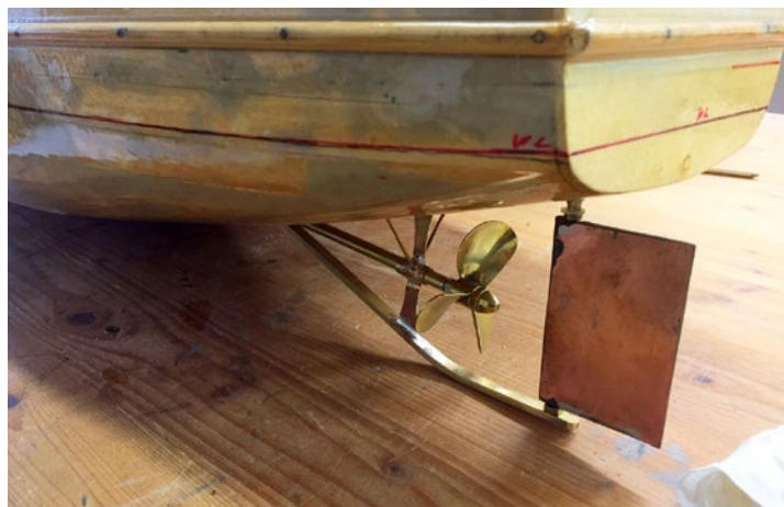
Der Antrieb entstand aus Messing, das Ruderblatt aus Kupfer
