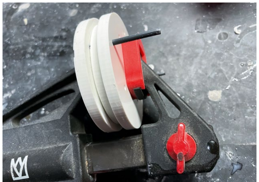
Anschließend werden die Teile des Verschlussrings zusammengeklebt
