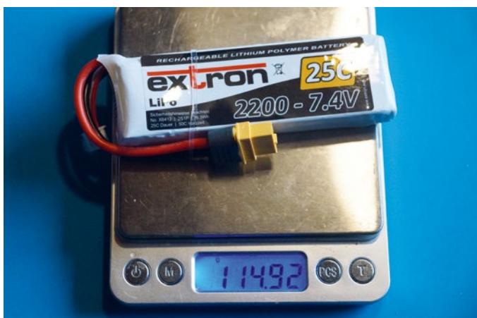
Kleiner Gewichtsvergleich: Mit neuer Technik und neuem Akku werden 350 g gespart. Dafür muss mit Felgengewichten nachgetrimmt werden
