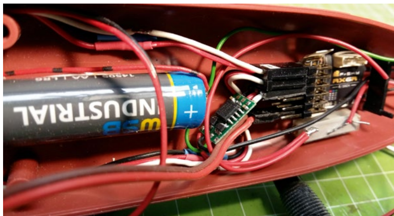
Der Empfänger und das Zweikanal-Schaltmodul sind im Bugbereich untergebracht
