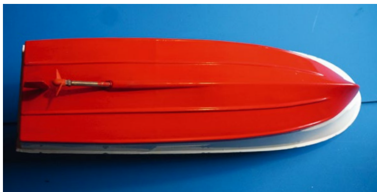
Ausgebessert, gespachtelt, neu lackiert und nichts mehr zu sehen
