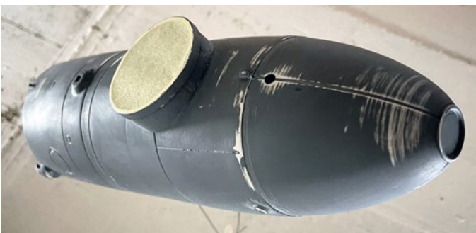
Nach sechs Schichten Einkomponenten-Füller wird der Rumpf nass geschliffen
