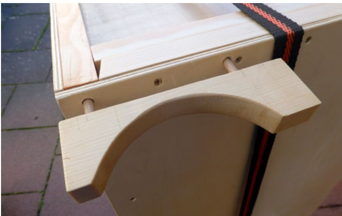
Oben hält eine eingesteckte Aufnahme das Rohr an seinem Platz
