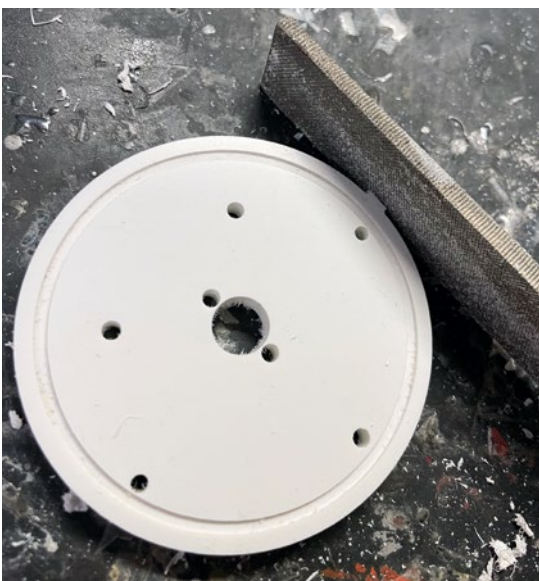
Die beiden Teile des Verschlussrings werden sorgfältig entgratet
