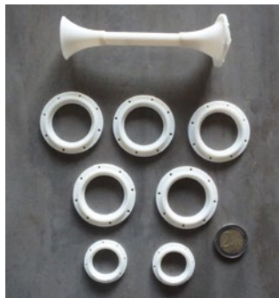
Die Beschlagteile im Maßstab 1:5 wurden selbst gedruckt
