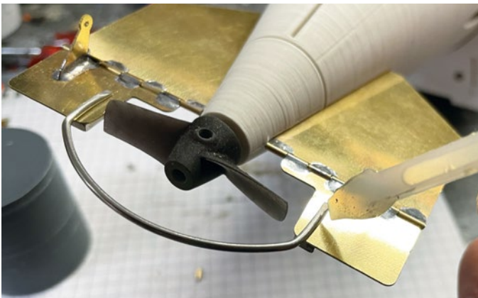
Der Seitenruderbügel wird an das montierte Ruder geklebt
