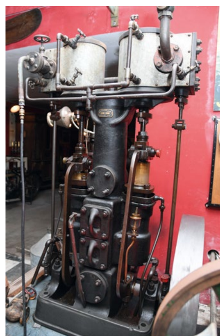
Die Maschine aus dem Wasserturm in Stade funktioniert bereits wieder
