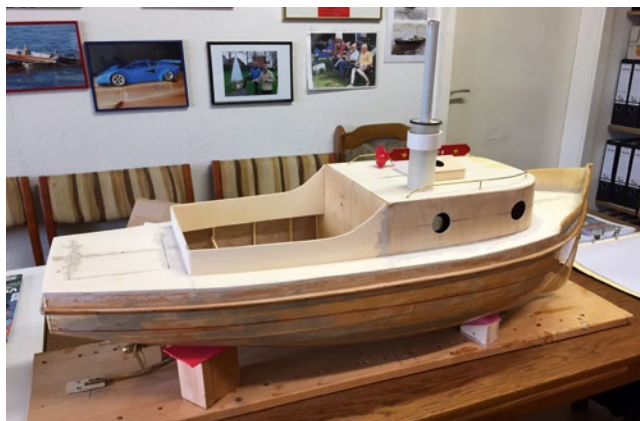
Die Aufbauten wurde ebenfalls aus 3-mm-Birkensperrholz gefertigt
