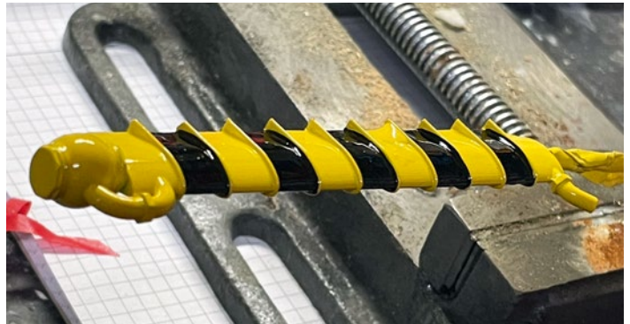
Der Schnorchel wird mit dem Pinsel lackiert
