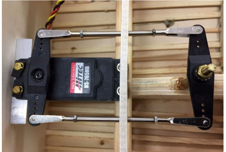
Das Ruder wird mit einem kurzen doppelten Gestänge angesteuert
