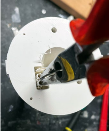
Zuerst müssen die überflüssigen Stützstrukturen entfernt werden
