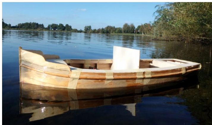
Bei der ersten Schwimmprobe wird die Zuladung von Ballast bestimmt
