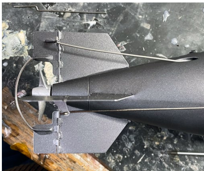
Das fertige Heck mit den angesteuerten Rudern
