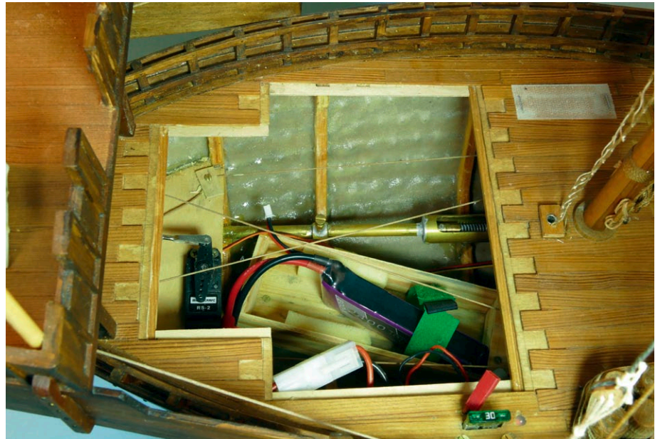
Die Schotführung unter Deck
