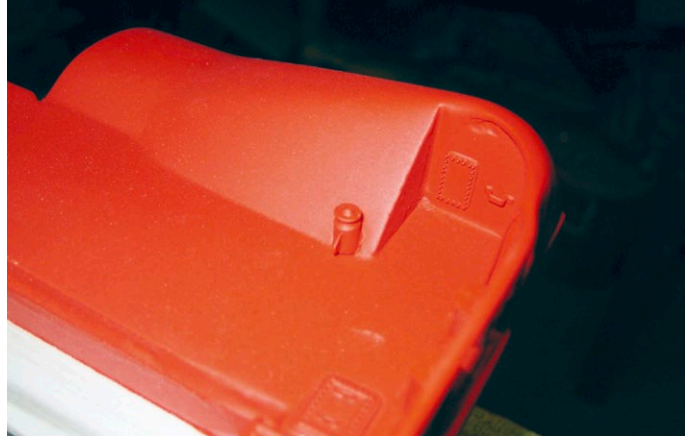
Dem sauberen Übergang von Rumpfheck und Schanz zur Heckrolle ging reichlich Schleifarbeit voraus, denn ursprünglich war das Ganze mal ein Hartschaumklotz, der in Form gebracht wurde
