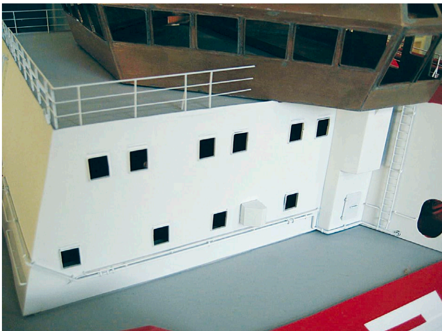
Einzelne Bereiche der Aufbauten sind miteinander verschraubt. Das gestattet saubere Übergänge beim Lackieren
