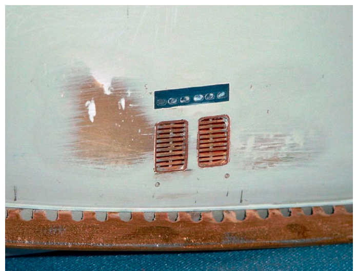
Detailaufnahme der Seekästen und der Schlingerkeile
