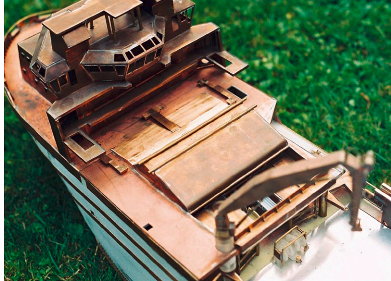
Phosphorbronzeblech ist das Material der Wahl bei den Aufbauten und erhielt gegenüber Polystyrol Vorzug
