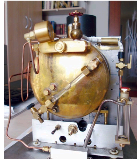
Dampfanlage mit neuem, großem Verdrängungsöler
