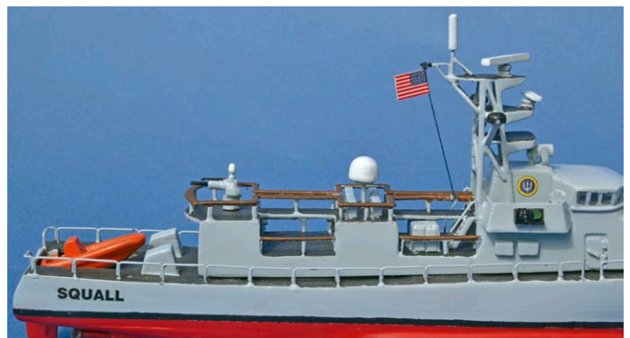
Das Heck des Modells: Hier kamen unter anderem Büroklammern für die Reling zum Einsatz
