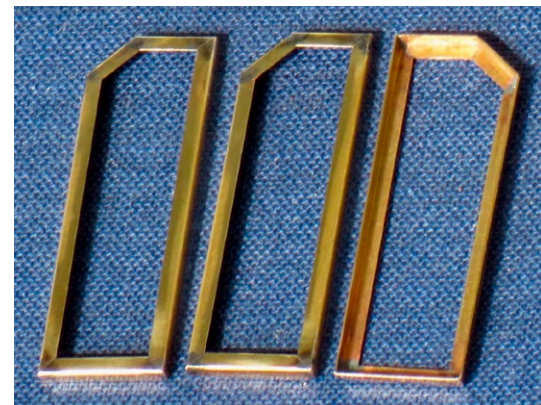
Abbildung 18: Sauber verputzte Rahmen, kein Stück überschüssiges Lötzinn
