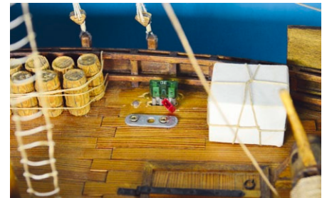
Der Ein-aus-Schalter als Sicherung für den Fahrstromkreis mit Abdeckung
