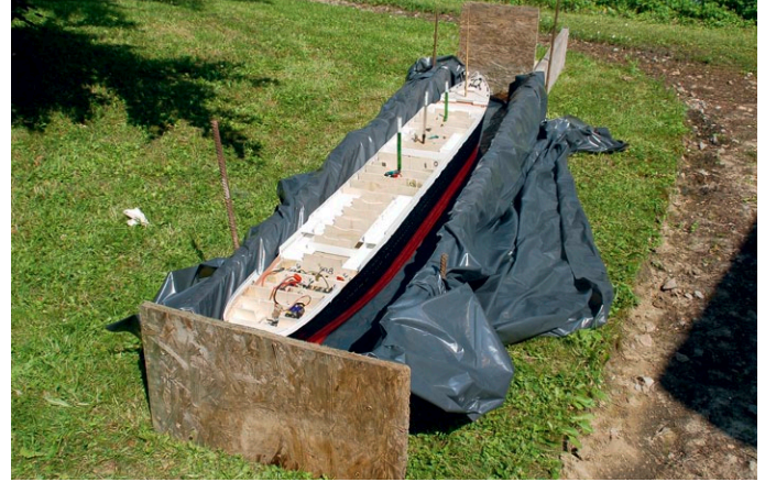
Erster Schwimmtest und Austrimmen des Modells im provisorischen Wasserbecken. Hier kam auch heraus, dass die Antriebsleistung nicht annähernd ausreichte
