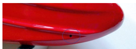
Das Entlüftungsloch für den Flutkanal wurde am Bug nachträglich gebohrt
