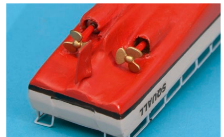
Das Modell verfügt über kein aktives Ruder, sondern wird durch die beiden Schrauben gesteuert
