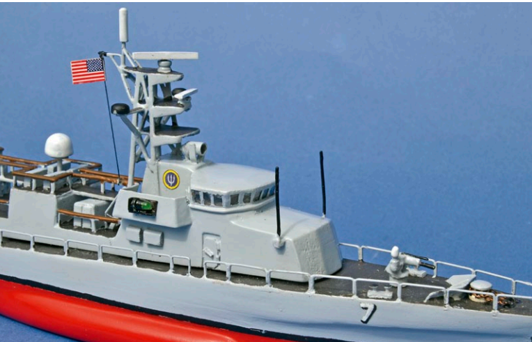
Das vordere Deckhaus. Die Fenster der Brücke bestehen aus Klarsichtfolie
