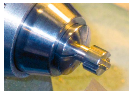
Abbildung 9: Nicht sehr viel weiter soll das Profil beim Plandrehen herausragen
