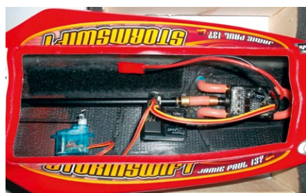
Ein Blick in das Innere des Modells: Hier finden Servo, Motor und Akku Platz
