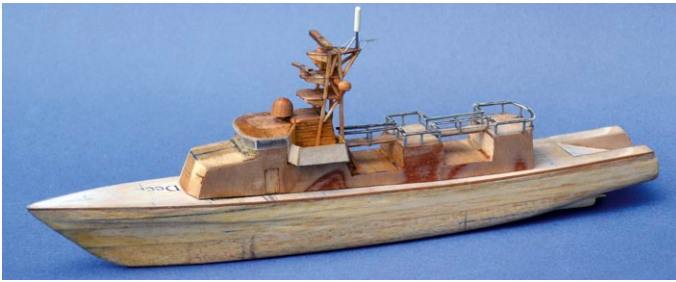
Das Modell im Rohbau. Hier fehlen noch die Schlingerwulste, die später realisiert wurden
