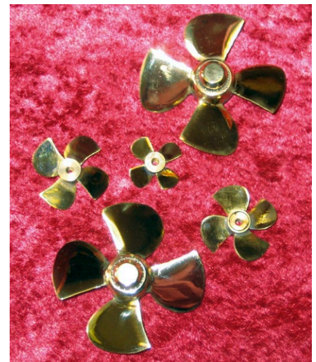
Fünf selbst hergestellte Propeller aus Messing waren für die Far Santana erforderlich
