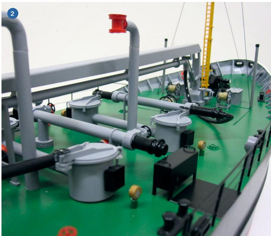
1) Verschiedene Teile wurden aus Polystyrol-Platten ausgeschnitten und in Kleinstarbeit zusammengesetzt. 2) Die Rohre an Deck sind ebenfalls aus Polystyrol gefertigt, anschließend wurden sie lackiert
