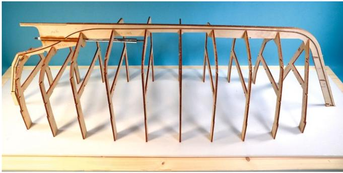
Die Spanten wurden auf der Helling aufgesetzt
