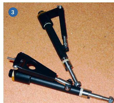
1) Zu Projektbeginn waren es noch zwei gekoppelte Zenoah 260, welche auf die 290er aufgerüstet wurden. 2) Bei den Resos fiel die Wahl auf zwei Cooper V2A von MHZ. Diese sind sehr kompakt konstruiert und lassen sich problemlos im Rumpf unterbringen. 3) Die beiden Powertrimms stammen von WD-200 – zunächst war nur einer im Betrieb, später wurde auf zwei umgebaut
