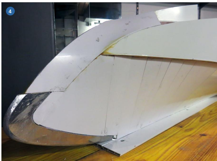
1) Die Form des späteren Sonnendecks bestimmt maßgeblich auch die oberen Befestigungspunkte der Rumpffplatten. 2) Der vordere Teil wird schrittweise mit 50 Millimeter breiten ABS-Streifen ausgekleidet. 3) Aufgrund der Rumpfform war die Einarbeitung einer Spritzwasser-abweisenden Kante erforderlich. 4) Der mit Aluminium verstärkte Steven ist ein Wesensmerkmal der SKY und später sichtbar gestaltet
