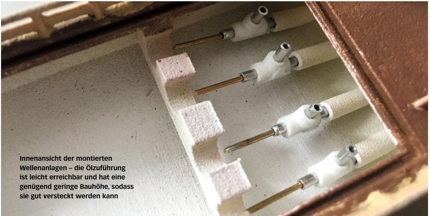
Der RC-Betrieb handelsüblicher Kunststoffbausätze ist mit modernen, kleinen Fernsteuerkomponenten gut möglich. Allerdings gibt es nur wenige kommerziell erhältliche Wellen mit Stevenrohr in passender Größe, besonders wenn sehr kleine Propeller verwendet werden sollen. Dieser Artikel soll Ihnen dabei helfen, ohne großen Aufwand eine 1-Millimeter-Welle mit Stevenrohr zu bauen.
