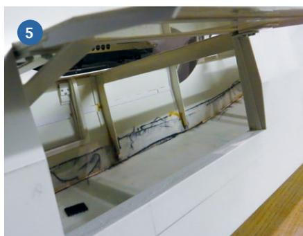
1) Der zweite Steven besteht aus zwei Elementen, die relativ viel vom Bug umschließen. 2) Der mittig im Rumpf verlaufende Flutkanal – hier gelb eingezeichnet – kann bis zu 4 Liter Wasser aufnehmen. 3) Öffnungen des Flutkanals im Heck. 4) Bei der zweiten Probefahrt am Königssee steht der Aufbau bereits in groben Zügen. 5) Die Tendergaragen waren wegen des Beachclubs seitlich in die Rumpfwand zu integrieren
