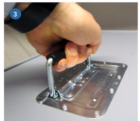
1) Mit einer Schablone lassen sich maßgenaue Öffnungen für Griffeinsätze erstellen. 2) Große Boxen erhielten seitlich eingelassene Griffe, da diese sicheres Tragen garantieren. 3) Alle verwendeten Griffe stammen aus dem Musik-Zubehör. Sie ragen wenig auf und sind daher zum Stapeln gut geeignet
