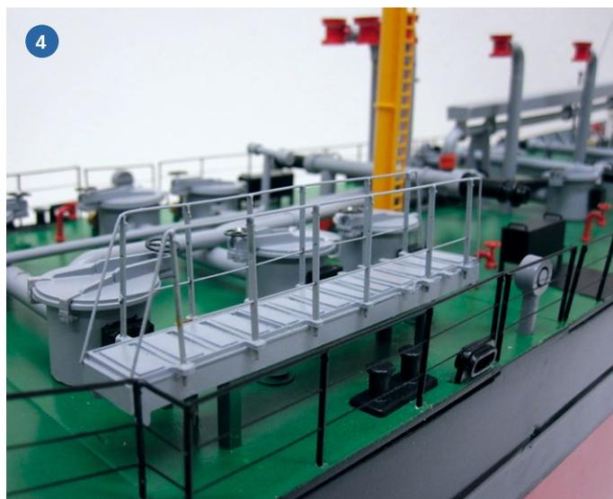
1) Der Rumpf stammt aus einem anderen Baukasten. Hier war zunächst noch ein Bugwulst vorhanden, der entfernt wurde. 2) Das Modell verfügt über eine funktionstüchtige Ankerwinde, die sich unter Deck befindet. 3) Das Deckshaus besteht zum größten Teil aus Polystyrol unterschiedlicher Dicke. 4) Die Relingen sind aus Metalldraht und ruhen auf Messingstützen
