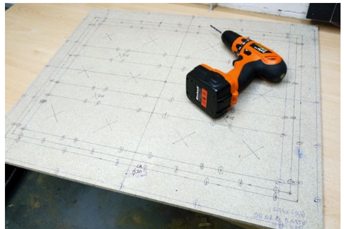
Die Topplatte enthält nicht nur diverse Bohrungen für die Verschraubung des Heizkastens mit dem oberen Aufbau sondern auch noch Öffnungen, für die später nötigen 120 mm-Lüfter samt deren Verkabelung
