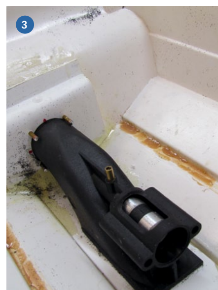
1) Die etwas abgetakelte und durchgerockte FLORIDA sollte wieder zu neuem Glanz erstrahlen. 2) Der Deckel ließ sich komplett vom Rumpf lösen und damit alle alten Komponenten entfernen sowie die Grundlage für den Einbau des Jets legen. 3) Die Rumpfdurchführungen für den Jetantrieb erfordern Präzision
