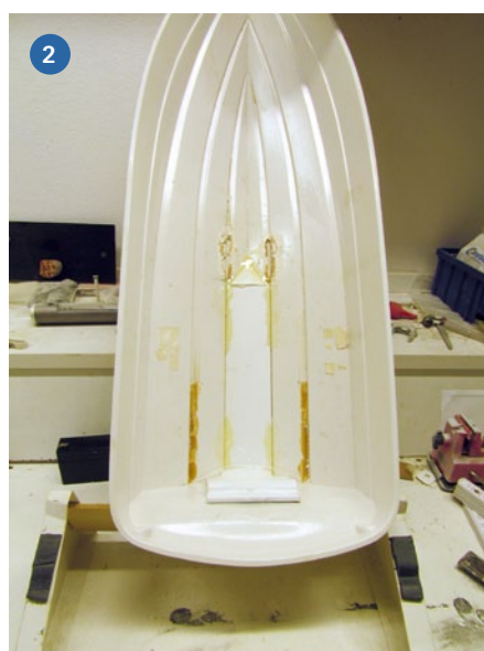
1) Die etwas abgetakelte und durchgerockte FLORIDA sollte wieder zu neuem Glanz erstrahlen. 2) Der Deckel ließ sich komplett vom Rumpf lösen und damit alle alten Komponenten entfernen sowie die Grundlage für den Einbau des Jets legen. 3) Die Rumpfdurchführungen für den Jetantrieb erfordern Präzision
