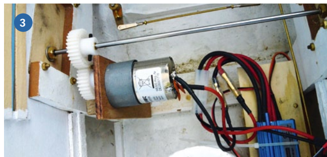
1) Von Nahem betrachtet erkennt man den Zylinder mitsamt Schiebesteuerung. 2) Eine Besonderheit beim Antrieb von Mississippi-Raddampfern sind die feststehenden Schaufeln. 3) Statt Dampf treibt dieser Elektrofahrmotor mit Fahrregler das Modell an
