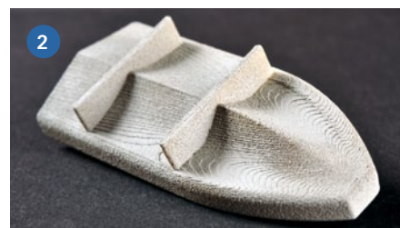
1+2) Beschlagteile aus dem 3D-Drucker hört sich vielversprechend an und kann es auch sein. Bei der CAPE ST. GEORGE erfordern diese Teile allerdings viel Nacharbeit, wie die Nahaufnahmen zeigen. Das verwendete Polyamid ist leider nicht schleifbar, sondern muss grundiert werden
