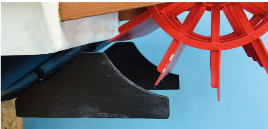
Unterhalb des Schaufelrads ist die Doppelruderkonstruktion angebracht
