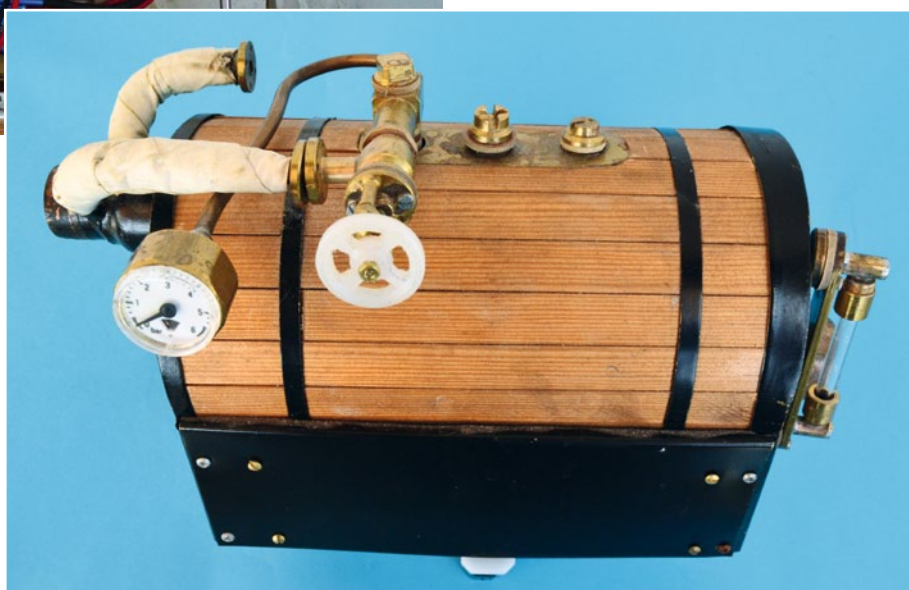
Der originale Flammrohrdampfkessel mit Manometer und Wasserstandsanzeiger in seiner ganzen Pracht
