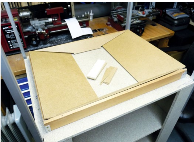
Was per CAD-System berechnet wurde, wird nun in die Tat umgesetzt. Die unter dem Lochblech genutzten Teile dienen der Verkleinerung des Volumens, um später die Luft so schnell wie möglich abziehen zu können
