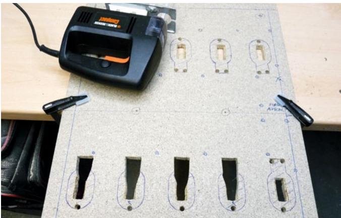
An etlichen Stellen müssen die passgenau geschnittenen Holzplatten aus dem Baumarkt noch mit den passenden Haltern, Löchern oder Bohrungen versehen werden. Beim Anzeichnen ist daher Vorsicht geboten – einmal mehr Messen als Sägen ist die Devise
