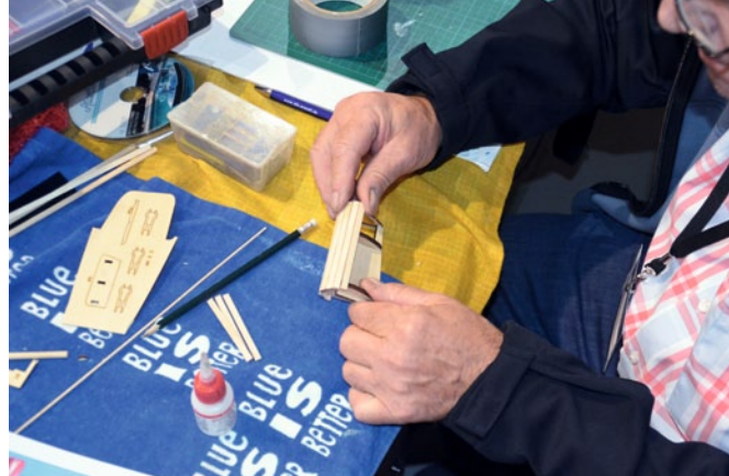
Die Einzelteile des Kielbretts werden sorgfältig verleimt
