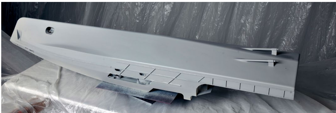
Die Grundierung ist drauf. Jetzt sind alle Kanten und Verzinkungen zu spachteln und zu schleifen
