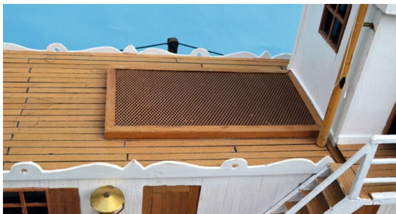
Ursprünglich für den Wärmeabzug der Dampfmaschine gedacht, dient diese Öffnung auf dem Oberdeck nun als Schallaustrittsöffnung
