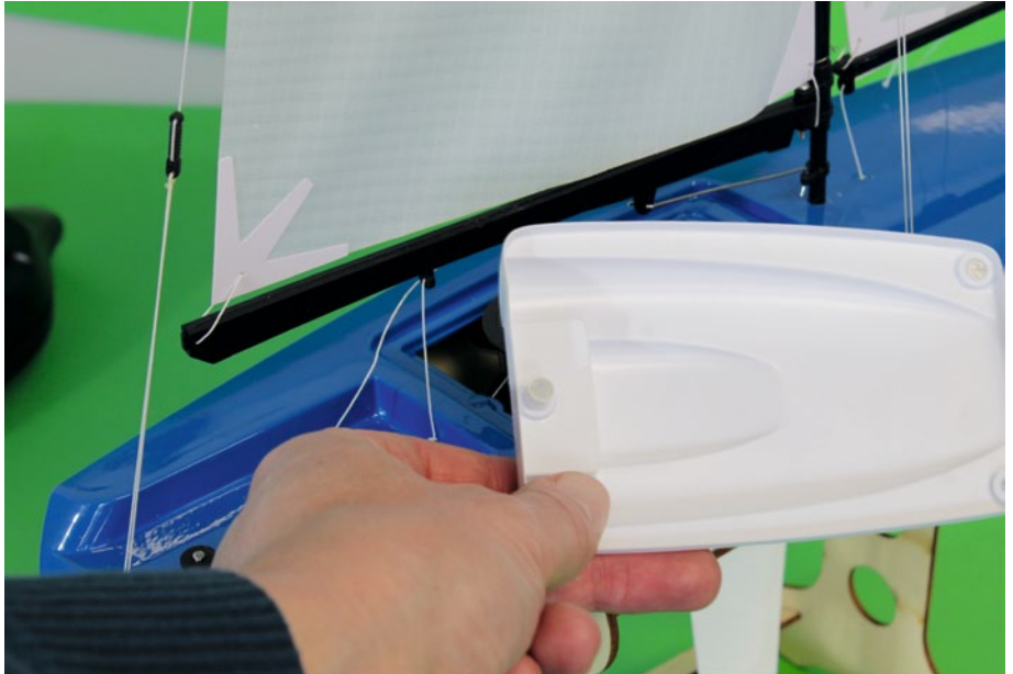
Magnete halten den Lukendeckel sicher an Position, doch ausreichenden Schutz gegen Wasser erreicht man nur über Abdichten mit Tesastreifen
