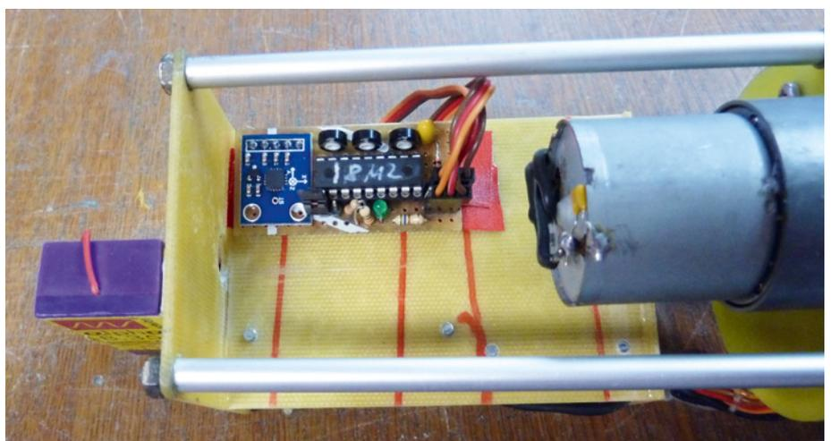
**Ein Bürstenmotor ist für den Tank abkommandiert. Daneben eine selbstgebaute Lagereglung**
