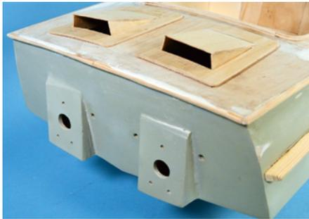
Die Z-Antriebe sind beim großen Modell auf nach außen ragende Keile zu platzieren. Hier zu erkennen die Bohrungen im grundierten Spiegel
