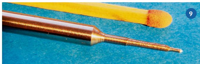
Nur die angeschliffene pyramidenförmige Spitze muss gehärtet sein
