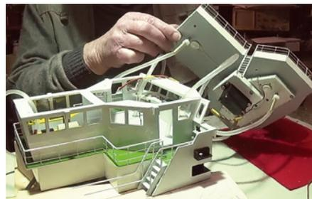
**Die Schläuche der Löschmonitore führen direkt durch die Kabine, waren also versteckt anzubringen - neben Kabeln für die Beleuchtung**
