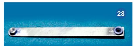
Der Messingblech-Streifen trägt zwei verschiedene Bohrbuchsen
