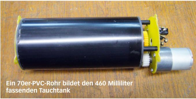
Ein 70er-PVC-Rohr bildet den 460 Milliliter fassenden Tauchtank
