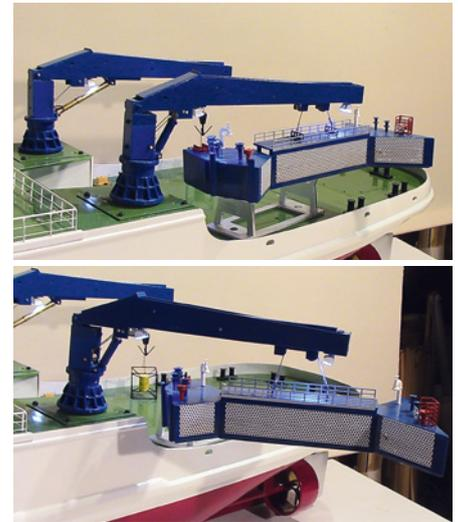
Ein Blickfang der SOLO ist der seitlich schwenkbare und herunterfahrende Ölfang-Ponton – zu erkennen sind auch hier wieder Leuchtelemente
