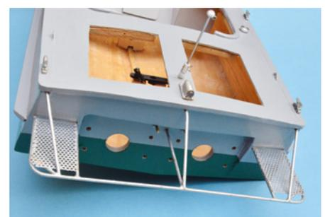
**Einbauvariante des Z-Antriebs beim 1:15-Modell mit nach innen liegendem Keil**
