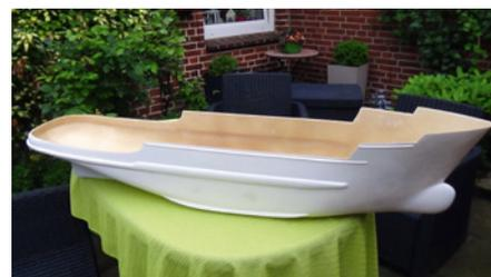
Basis des Modells bildete ein GFK-Fertigrumpf
