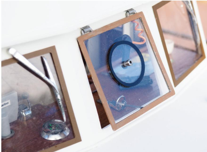
Scheibenwischer, ausklappbares Mittelfenster und ein kompletter Innenausbau wurden nachträglich realisiert
