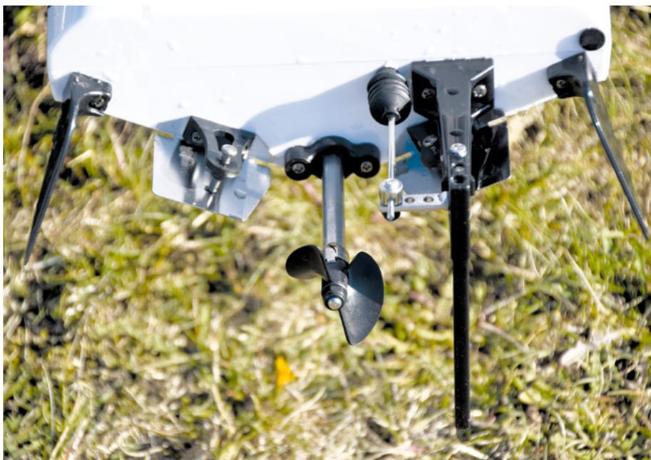
Zwei Turn-Finnen, zwei Trimmklappen, ein seitlich versetztes Ruder sowie die Wellenanlage schmücken das Heck des Modells
