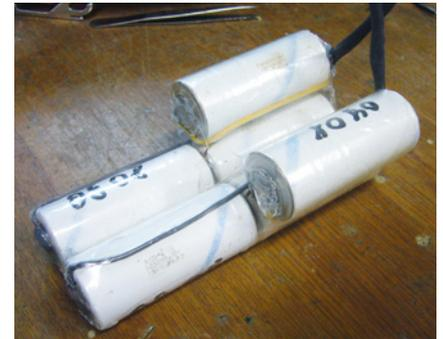
Statt NiCd-Akkus kommen moderne LiFePo-Akkus in 3s2p-Ausführung und auf die Rumpferhältnisse angepasste Abmessungen ins Modell
