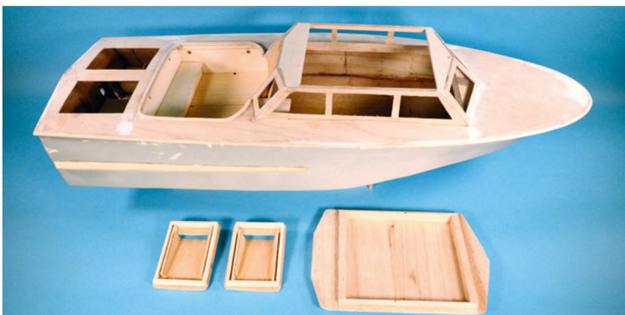
**Das Modell 066 im Rohbau mit Ausbauteilen. Gut zu erkennen sind die vielen Zugangsmöglichkeiten zum Rumpffinneren**
