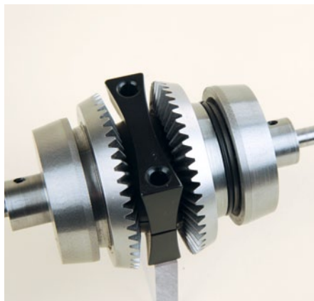
Die Umkehr-Einheit in der Endmontage
