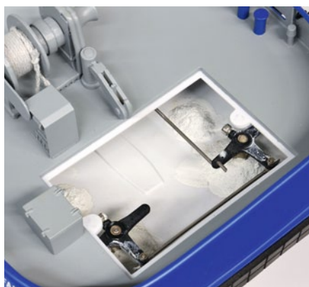
Über einen von Magneten gehaltenen Servicedeckel – auf diesem sitzt der Trossenbügel – besteht Zugriff zur Doppeleruderanlage
