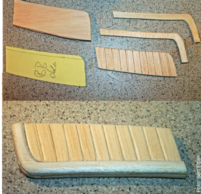
Baustufenfotos eines Sitzpolsters, bereits mit Harz getränkt
