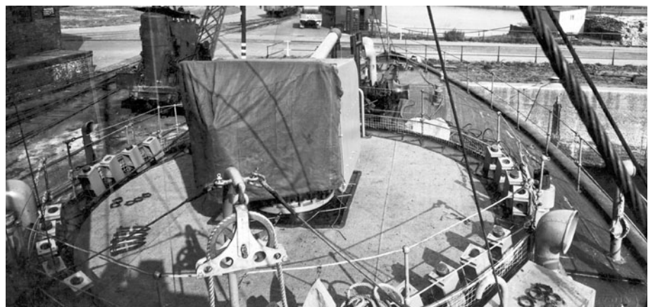
102-mm-Bereitschaftsgranaten stecken in schrägen Halterungen am Rand der Geschützplattform auf der Back
