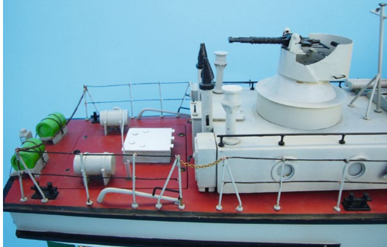
Das Achterdeck der 1:31-TÜMMLER. Über die Revisionsluke hat man Zugang zur Ruderanlage
