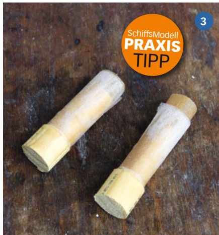
1) Ruderanlage mit versetzten Schrauben. Im Heck ging es ziemlich eng zu, was die Rudersteuerung erschwerte. 2) Turm mit Namenszug PLUVIÔSE aus geätztem Messing. 3) Zum Laminieren des Schornsteins wurde zunächst ein Holzrundstab in die gewünschte Form gebracht und dann „abgeformt“. 4) Dass die Torpedos in unterschiedliche Richtungen gehen, setzte man nur bei frühen U-Booten um
