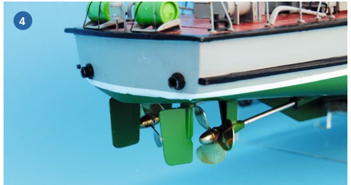
1) Fahrstand bei 1:31-TÜMMLER mit Signalnocken – sie waren etwas Besonderes beim Reedeschutzboot. 2) Pfahlmast der TÜMMLER mit Seilen und Abspannung TÜMMLER 1:25. Hier ist sogar eine funktionsfähige Beleuchtung realisiert. 3) Vordeck der 1:31-TÜMMLER mit Wellenbrecher. 4) Blick auf Ruder und Propeller der 1:31-TÜMMLER. Die Wellen lassen sich nach Demontage der Propeller ohne Ruderausbau herausziehen
