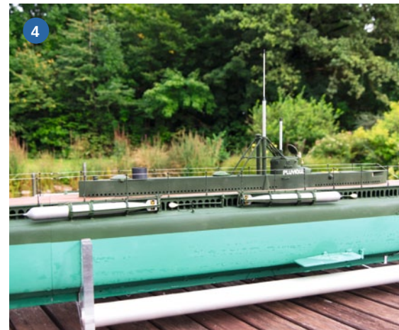
1) Ruderanlage mit versetzten Schrauben. Im Heck ging es ziemlich eng zu, was die Rudersteuerung erschwerte. 2) Turm mit Namenszug PLUVIÔSE aus geätztem Messing. 3) Zum Laminieren des Schornsteins wurde zunächst ein Holzrundstab in die gewünschte Form gebracht und dann „abgeformt“. 4) Dass die Torpedos in unterschiedliche Richtungen gehen, setzte man nur bei frühen U-Booten um
