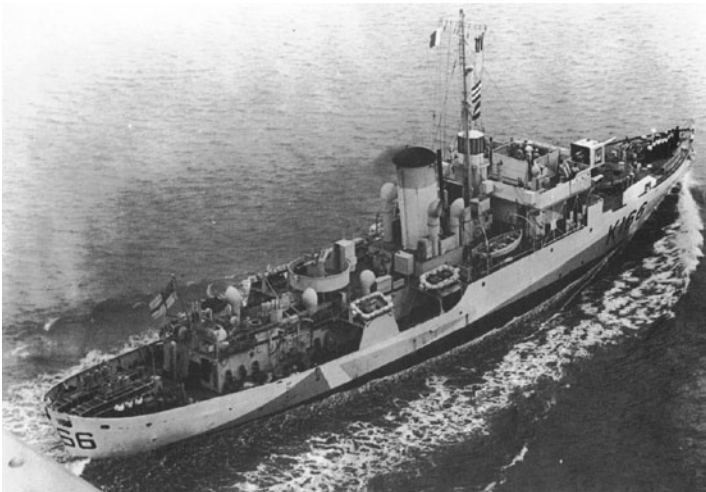
SNOWBERRY (Kennung K166) als mod-Version schon mit längerer Back und mit Radar Typ 271 vor Mast und Kamin, keine Minensuch-Einrichtung, parallele WABO-Bahnen, 40-mm-Mk VIII in runder Waffenwanne hinter dem Kamin
