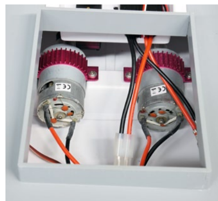
Beide Bürstenmotoren sind gemeinsam über einen Regler angesteuert. Rüstet man auf zwei Regler um, steigern sich die Manövriereigenschaften
