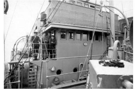
Brückenfront von HELIOTROPE. An der Mast-Achternkante fährt eine Strickleiter nach oben. Im Hintergrund sieht man die Davits für das geklinkerte Beiboot
