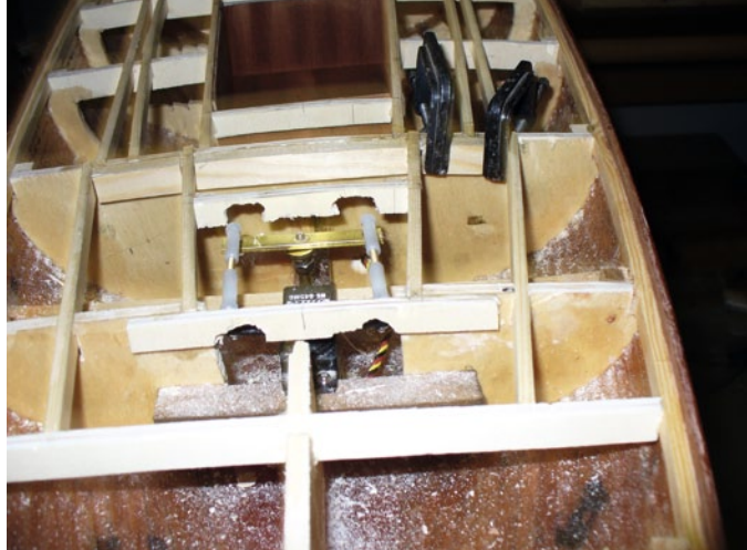
Gebaut wurde BENNY klassisch auf Spanten und beplankt mit edlen Mahagoni-Leisten
