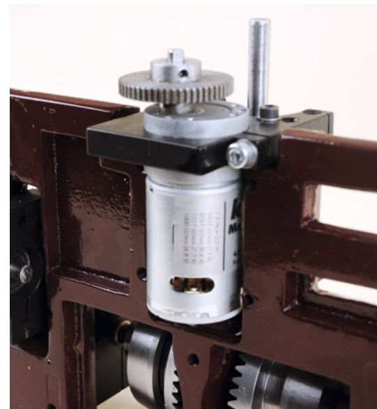
Die E-Starter-Einheit in der Endmontage. Gewährleistet wird die Funktion durch den Getriebemotor von Krick und den Freilauf
