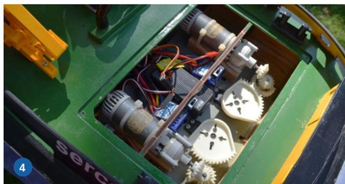
3) Damit die je sechs Bohrungen exakt sitzen, wird das Führungsteil erst mit zwei Schrauben fixiert und dann als Bohrschablone benutzt. 4) Die Motoren liegen auf höhenmäßig angepassten Fundamenten und sind zusätzlich gesichert. Sie lassen sich aber auch ohne größeren Aufwand ausbauen. Zwischen den Reglern liegt das Soundmodul
