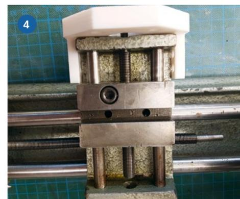
3) Das erste Prototypen-Modell entsteht im 3D-Drucker. 4) Blick von oben auf die gedruckte Motorhalterung für die X-Achse bei der ersten „Anprobe“
