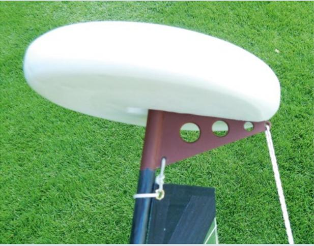
**300 g Auftrieb hat der scheibenförmige Körper, der sicher am Masttopp verschraubt ist**
