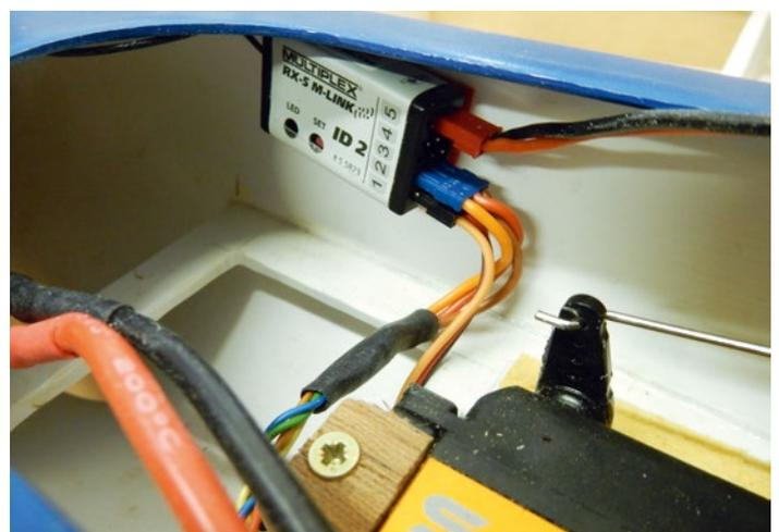
... während der Empfänger sich an der Innenwand des Rumpfs befindet. Da kommt auch im gekenterten Zustand kein Wasser hin
