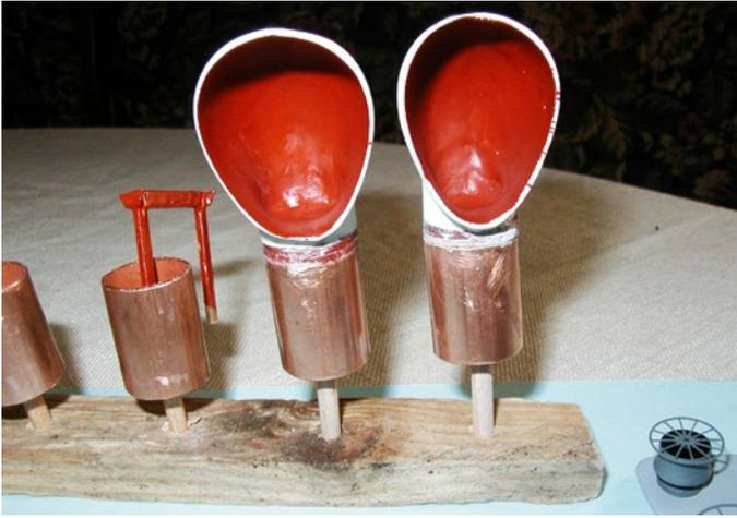
Die Unterteile der großen Lüfter bestehen aus Kupferrohr
