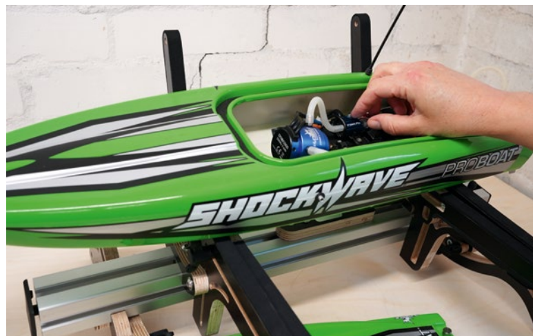
In Schrägstellung sind Arbeiten im Rumpfinneren sicher und komfortabel möglich
