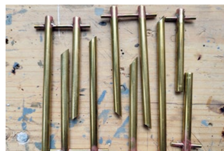
Gelötete Kreuzpoller aus 6-mm-Messingrohr mit 3-mm-Querrohr, ebenfalls aus Messing
