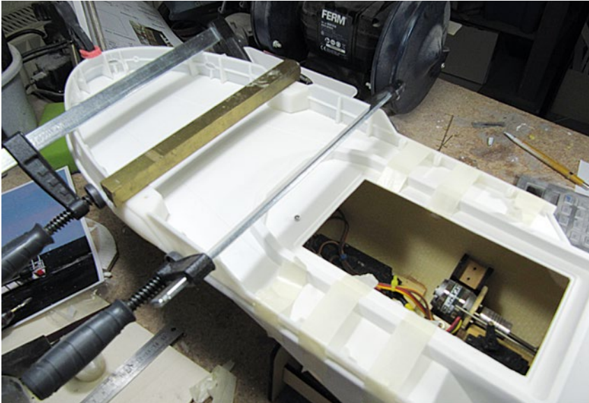
Exakte Positionierung des Schanzkleids und Verklebung mit Stabilit Express
