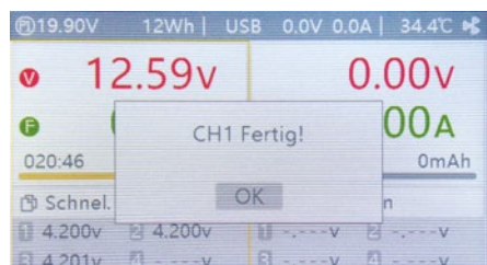
Der Ladevorgang ist beendet, der Akku ist voll aufgeladen und gut balanciert
