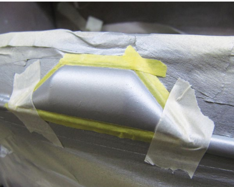
Trotz penibler Vorarbeit und speziellem Klebeband entstanden leider nicht überall saubere Farbkanten
