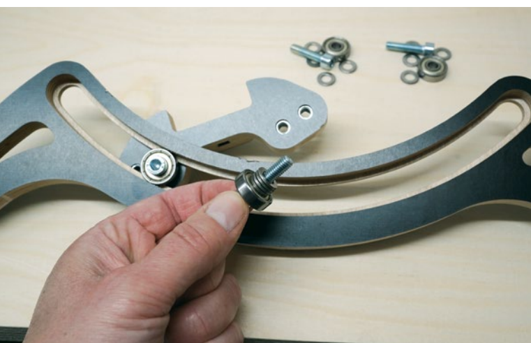
Kugellager und Belegscheiben ermöglichen später das Schwenken der Auflagen
