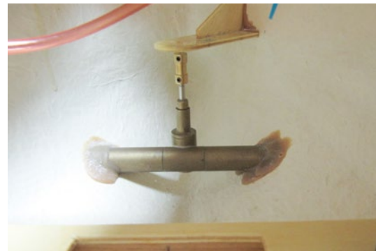
Der ursprünglich in der OUR LASS II verbaute Querstrahler funktionierte nicht zufriedenstellend – ein Austausch war erforderlich
