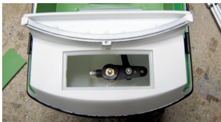
Die Ruderanlenkung des Tochterboots ist später leider nicht mehr veränderbar, da zu wenig Platz ist, um den Inbusschlüssel zu drehen
