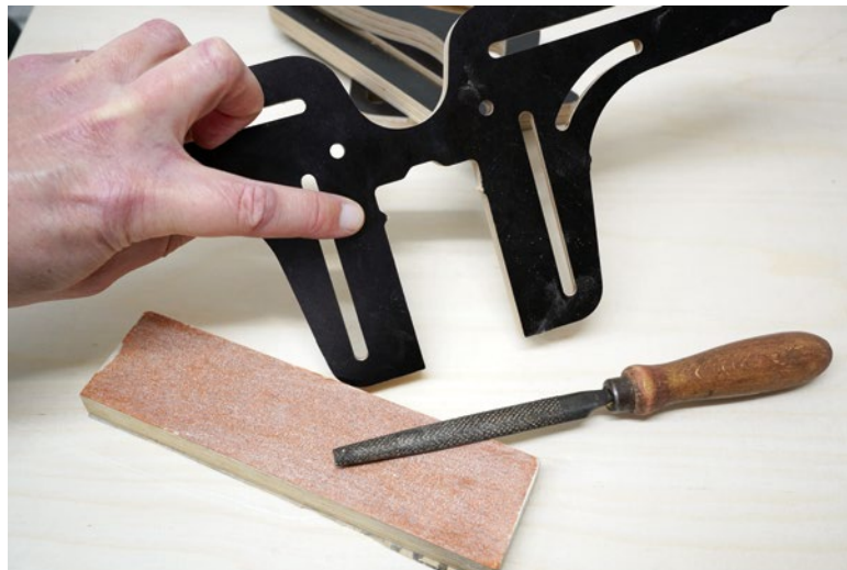
Schwer erreichbare Stellen sind mit Raspel und Schleifpapier zu bearbeiten
