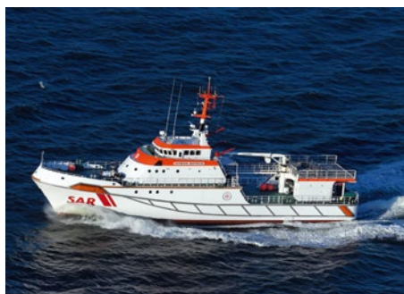
Maximal 25 kn schnell kann die HERMANN MARWEDE fahren. Die drei Motoren liefern zusammen 6.800 kW
