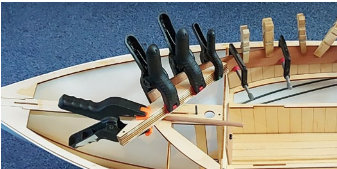
Vor dem Aufkleben des Decks ist der Süllrand „in Form“ zu bringen. Klammern und dem Bausatz beiliegende Formteile helfen dabei
