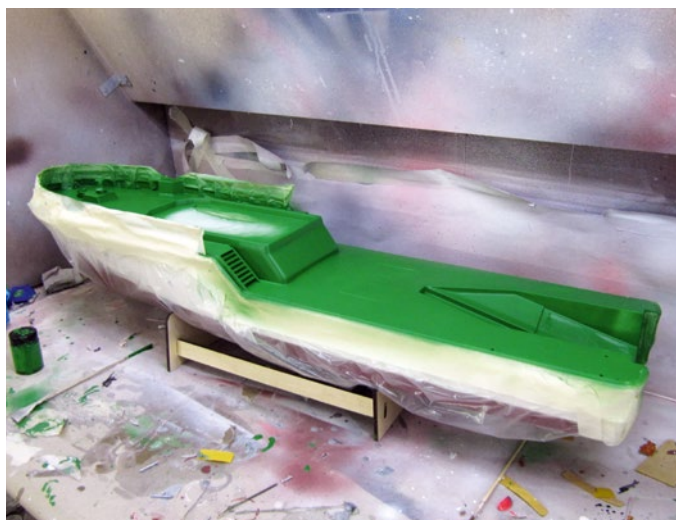
Aufgrund des speziellen 3D-Druck-Kunststoffs war eine gewissenhafte Grundierung vor dem Farbauftrag unerlässlich
