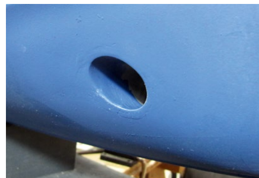
Vom Umbau ist nichts mehr zu sehen und der neue Querstrahler arbeitet tadellos
