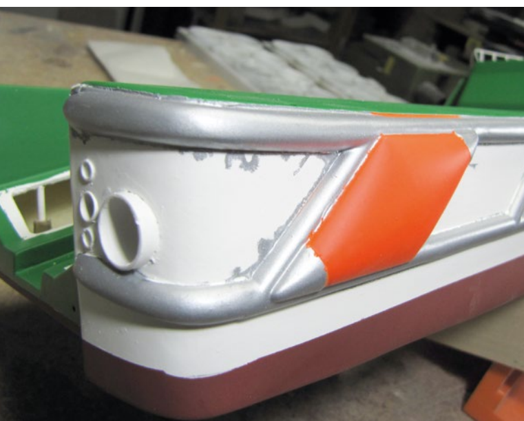
Trotz penibler Vorarbeit und speziellem Klebeband entstanden leider nicht überall saubere Farbkanten
