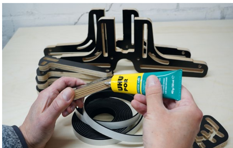
Etwas Uhu Por erhöht die Haftkraft der selbstklebenden Moosgummistreifen
