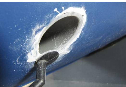
Kleine Spalten überbrückt Spachtel, der danach mit dem Pensschleifer zu glätten ist
