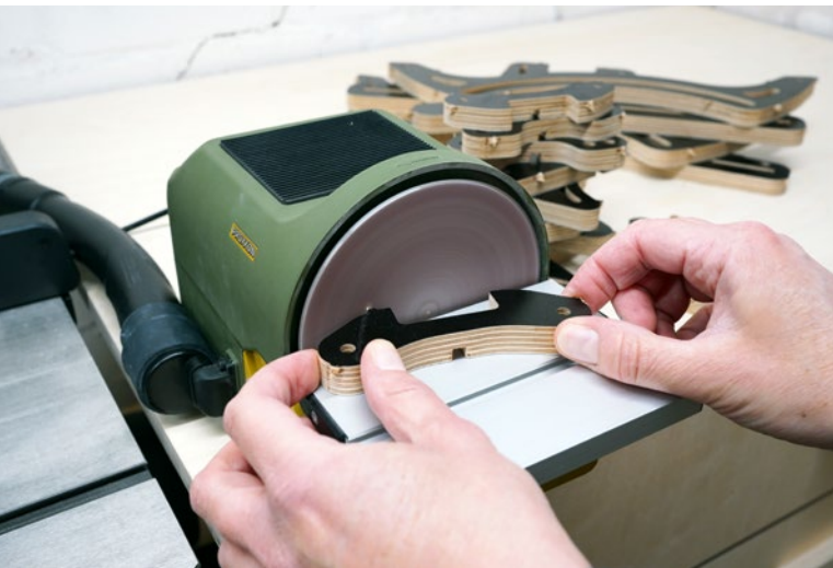
Beim Entgraten war der Proxxon-Tellerschleifer eine wertvolle Hilfe
