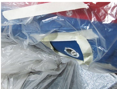
Vor dem Lackieren ist das Schiff zum Schutz vor dem Lackiersprühnebel abzukleben
