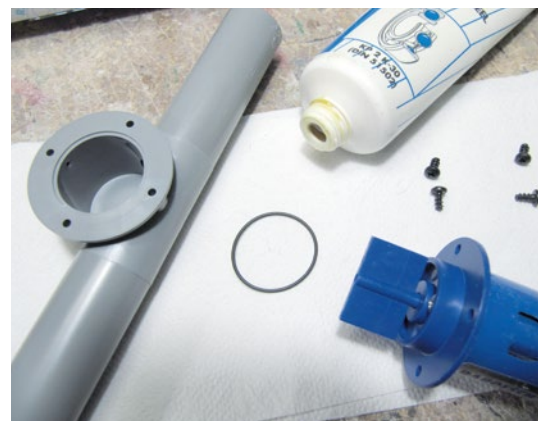
Vor dem Einbau des neuen Querstrahlruders von Raboesch wurde dieses gefettet und der Motor festgeschraubt
