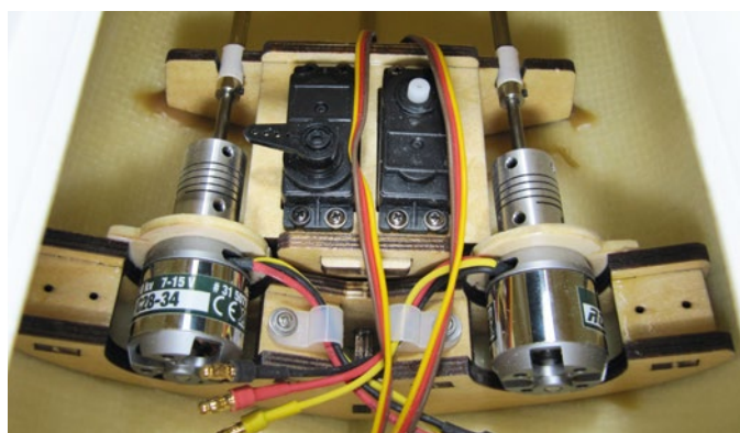
Statt der beiliegenden Bürstenmotoren wurde die FELIX SAND komplett mit Brushless-Technik ausgestattet
