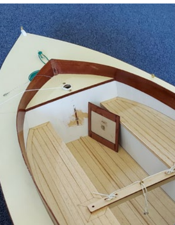
Die Tür-Attrappe wird von einem Magnet in Position gehalten und kann bei Bedarf ausgetauscht werden
