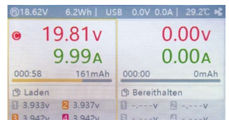
Farbige Markierungen der Zellennummern zeigen die Balancer-Aktivitäten
