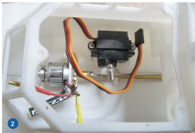
1) Der Bausatz kommt als Komplettpaket. Theoretisch bräuchte man nur einen Empfänger und einen Akku und könnte nach dem Zusammenbau losfahren. 2) Im engen Innenraum des Tochterboots SAPHIR findet ein leichter und kräftiger Brushless-Motor Platz
