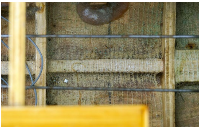
Als Schutz vor Wasser wurde der Rumpf innen mit Holzleim versiegelt, mit Mullbinden belegt und dann nochmals mit Holzleim versiegelt
