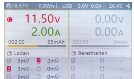
Zur Anzeige gehört auch die präzise Angabe der Innenwiderstände der Zellen
