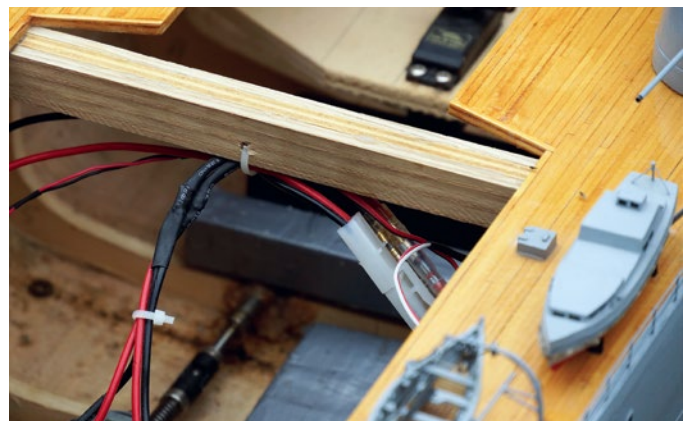
Ein Blick auf das „Skelett“ des Schiffsmodells zeigt, wie massiv es gebaut ist
