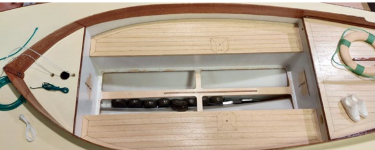
Das Gewicht im Kiel ist beim Testmodell entnehmbar. Darum waren kleine Anpassungen wie der Zugang zum Rumpfinneren umzusetzen
