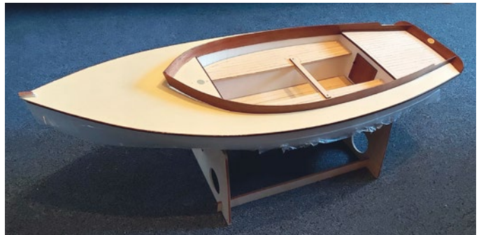
Mit Süllrand und Deck wirkt die BULLSEYE schon fast fertig, aber es bleibt noch reichlich zu tun: Lackieren, Aufriggen und der RC-Einbau
