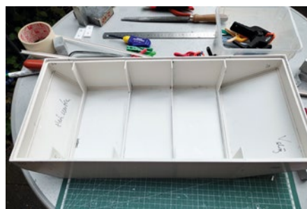
In die Kontaktstellen der Wände und für die Decksaufnahme wurden zusätzlich Winkel eingeklebt
