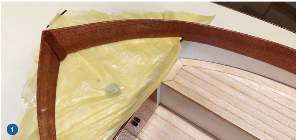
1) Lackieren des Süllrands. Eine Folie schützt das bereits mit Oracover-Folie bebügelte Deck. 2) Fertig lackierter Rumpf. Die exakte Position der Wasserlinie ließ sich zuvor mit Hilfe der selbst gebauten Zeichenhilfe sauber markieren
