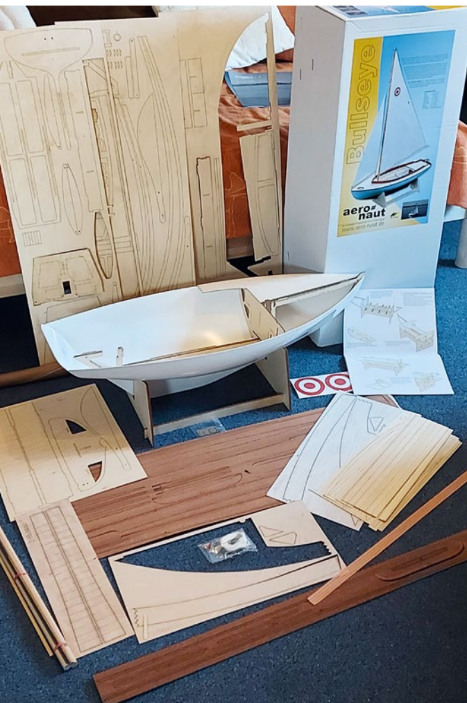
Gut 4 m 2 Holz, ein Kunststoffrumpf, zwei Segel und viele weitere Teile umfasst der aero-naut-Bausatz
