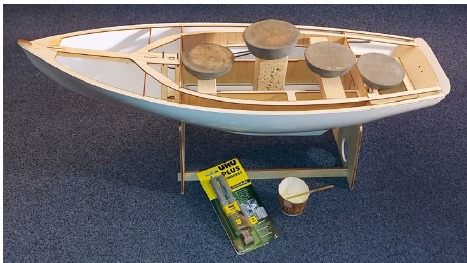
Mit ordentlichem Gewicht (fast 15 kg) beschwert, wird das Rumpferüst eingeleimt
