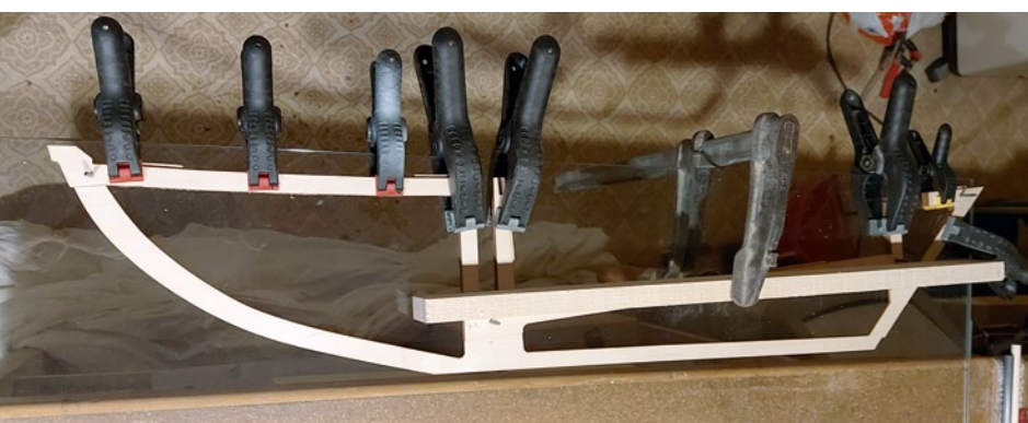
Die Bauteile der Kielverstärkung werden mit Bowdenzugrohrstücken gegen Verrutschen beim Kleben gesichert – das ist clever gemacht
