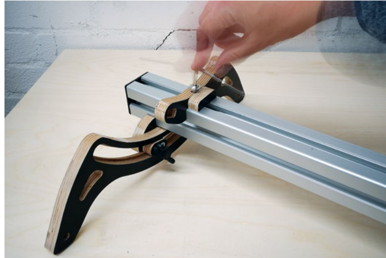
Auf dem Aluprofil können alle montierten Elemente flexibel fixiert werden
