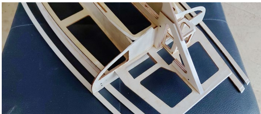
Etwas Schleifarbeit hilft beim optimalen Einpassen des Rumpferüsts
