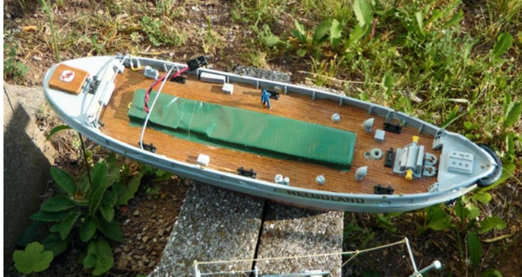
Gegen überkommendes Wasser schützt Abklebeband den Innenbereich
