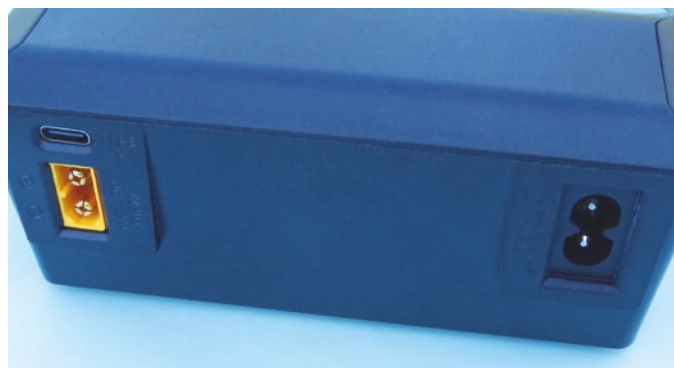
Rückseitig befinden sich die Anschlüsse für die Eingangsspannungen sowie der USB-C-Port
