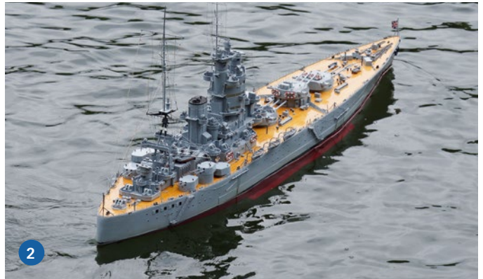
1) Optisch unterscheidet sich die HMS RODNEY deutlich von vergleichbaren Schiffen. Auf den ersten Blick könnte man denken, sie fährt rückwärts. 2) Majestätisch gleitet das 1:100 Modell durchs Wasser. Gut 50 kg Gewicht sind nötig, damit es auf Wasserlinie liegt
