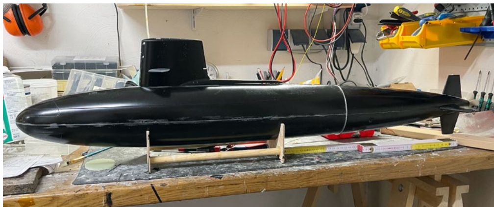
Die GFK-Teile ergeben zusammen ein stattliches Modell
