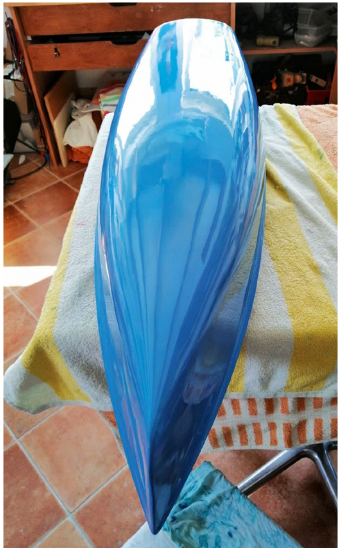
Aus der Urform entsteht die Negativform
