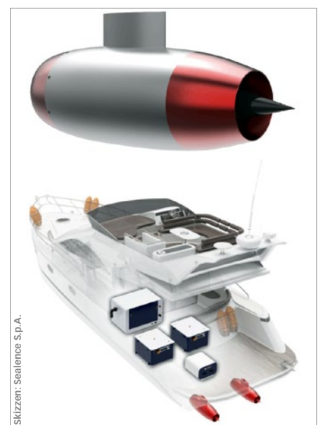
Der elektrische Jetmotor von DeepSpeed. Oben der einzelne Antrieb, darunter die Positionen des Doppel-Antriebs unter einer Yacht
