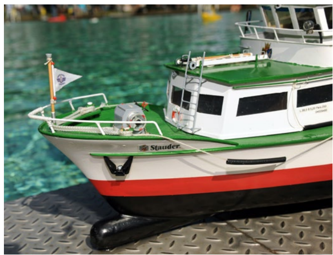
Durch die nachträglich angebaute Bugnase fährt das Schiff besser durch höhere Wellen
