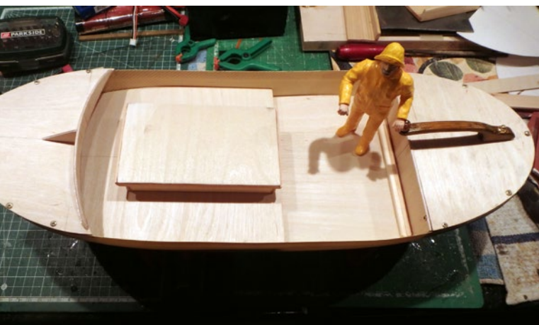
Der Verlauf des Decks passt sich den Einbauten an
