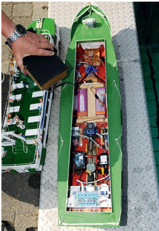
Die Komponenten der Fernsteuerung verteilen sich über das ganze Schiff
