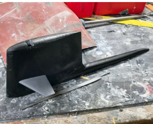
Die zwei Turmteile mit den Tiefenrudern sind zusammengebaut
