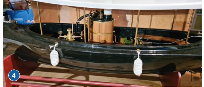
3) Der Kessel ist neu verkleidet und mit der Maschine auf dem Fundament montiert. 4) Die gesamte Dampfmaschine ist eingebaut
