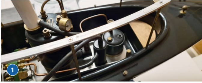
1) Die eingebaute Dampfmaschine, hier noch ohne Kesselverkleidung. 2) Empfänger und Akkus sind unter der Hinterbank verborgen
