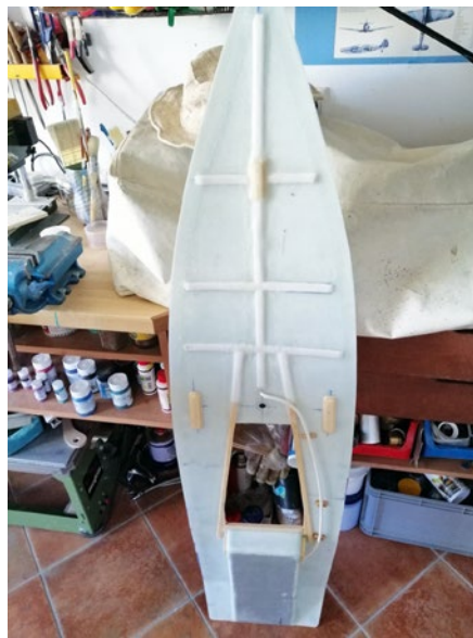
... in der die Decks aus sehr leichtem Sandwich-Laminat aufgebaut werden
