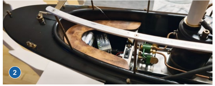
1) Die eingebaute Dampfmaschine, hier noch ohne Kesselverkleidung. 2) Empfänger und Akkus sind unter der Hinterbank verborgen
