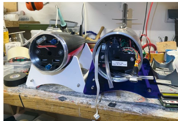
Bug- und Hecksektion haben komplett ausbaubare Technikeinschübe
