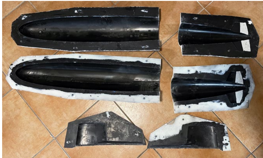
Die Form für das U-Boot besteht aus vier Rumpfteilen und zwei Turmteilen
