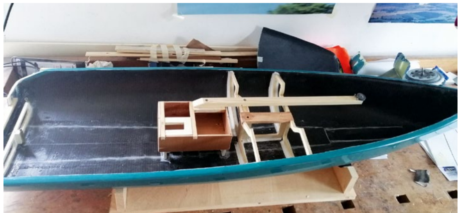
Alle Kräfte werden über ein Holzgestell aufgenommen, in dem auch die RC-Anlage ihren Platz findet
