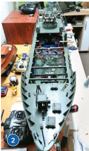
1) Als das Vorbild klar war, stand zuerst eine Rumpferlängerung an. 2) Den kompletten Aufbau kann man vom Rumpf abheben. 3) Die Ansteuerung der Beleuchtung erfolgt noch mit Servos und Schaltern
