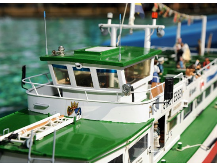
Schiffshorn, Suchscheinwerfer und zwei Rückspiegel sorgen für Übersicht auf der Brücke
