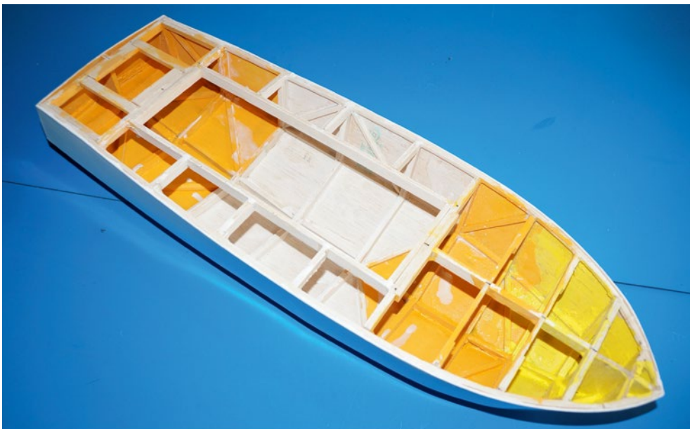
Die offene Rumpfschale wird noch ein- oder zweimal mit Parkettlack lackiert. Zu Kontrollzwecken färbte ich den transparenten Parkettlack mit Acrylfarbbrechen
