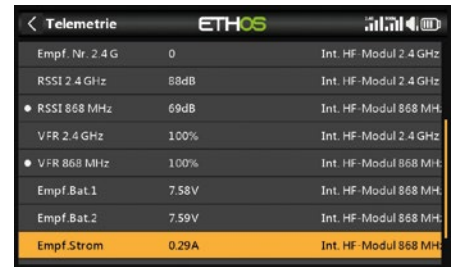
Die Spannungen beider Akkus des Empfängers sowie dessen Stromaufnahme lassen sich per Telemetrie überwachen
