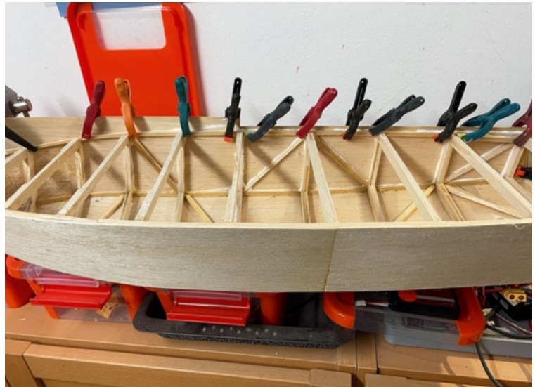
Die dritte Rumpfsseite wird mit Klammern am oberen Stringer gehalten. Von denen kann man nicht genug haben
