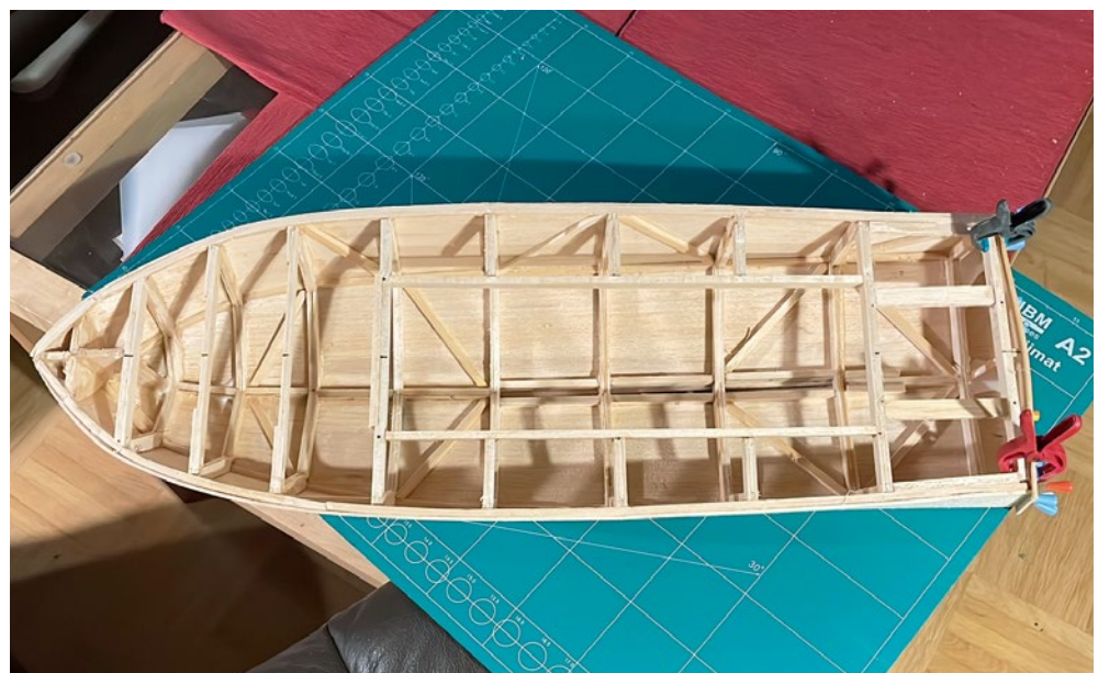
Die Rumpfschale vor dem Aufziehen des Decks. Jetzt sollte man den Motor mit der Welle und die Ruderanlage einbauen
