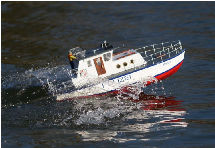
So steil sollte das Modell nicht bei Halbgas im Wasser stehen. Da muss am Rumpf etwas geändert werden
