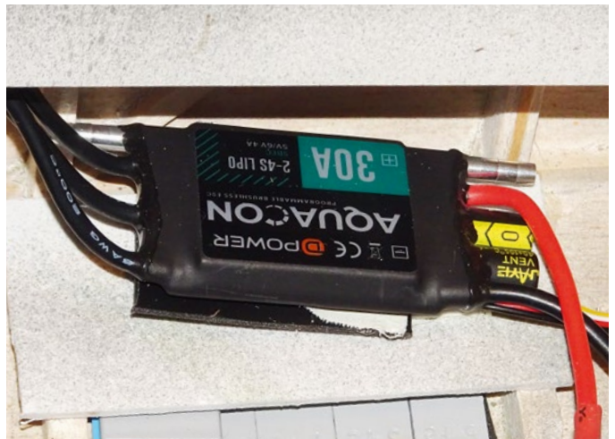
Der 30-A-Fahrtregler kann zwar an eine Wasserkühlung angeschlossen werden, aber bei der WESER ist das nicht nötig
