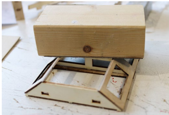
Der Deckel des Maschinenraums muss mit einem Schleifklotz geglättet werden
