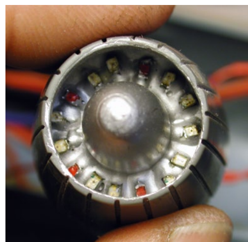
Die Düse des Haupttriebwerks mit ihrer LED-Bestückung
