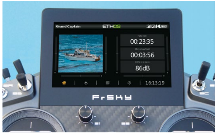
Mittig befindet sich der Ein-aus-Schalter, darüber sind zwei Dreh- und seitlich darunter zwei Tastgeber angebracht, unten sind ein Schiebekanal und sechs individuell belegbare Tasten vorhanden. Besser kann man ein Display nicht anordnen, es ist auch bei Sonnenlicht gut ablesbar
