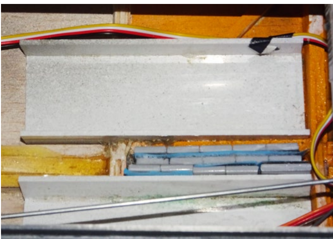
Die beiden Akkuauflagen sind aus 2-mm-ABS-Plattenmaterial
