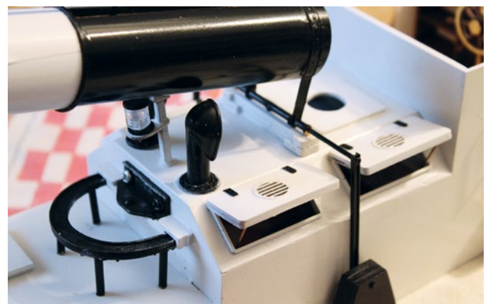
Der Schornstein kann manuell umgelegt werden
