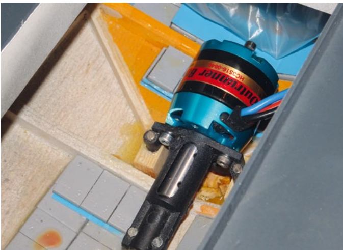
Der Hitec-Aussenläufer hat nur eine Drehzahl von 840 U/min/V, was bei einen 3s-LiPo vollkommen ausreicht, um dem Modell eine vorbildgetreue Geschwindigkeit zu ermöglichen
