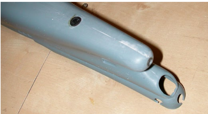
Separater Wasserstrahlaustritt in der Bugnase für die Rückwärtsfahrt
