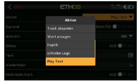
Für Text-to-Speech muss eine spezielle Funktion angelegt und als Aktion „Play Text“ gewählt werden
