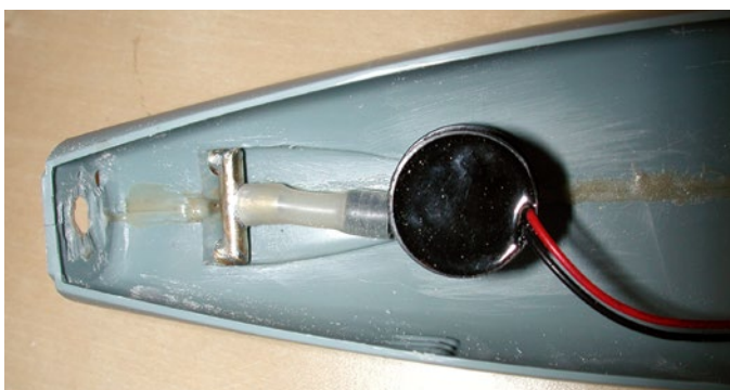
Das ursprüngliche T-Stück für den Wasserstrahlaustritt am Heck
