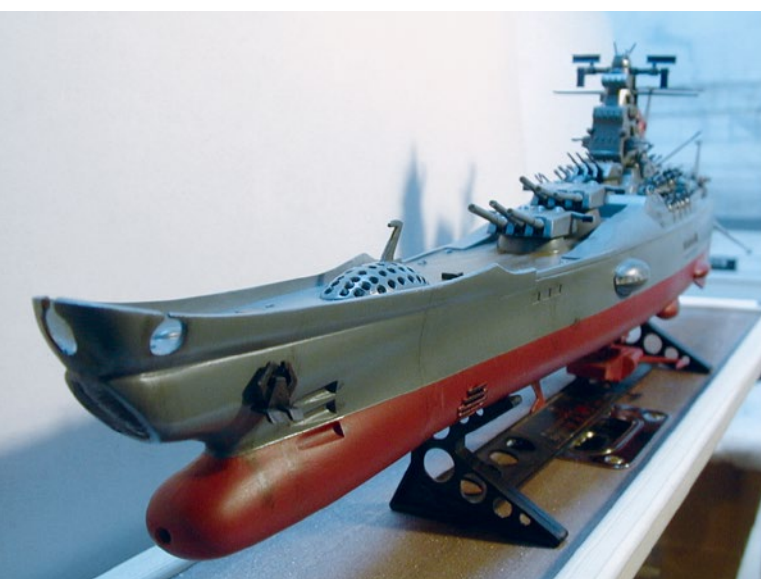
Die Bugansicht. Unter der gelochten Abdeckung befindet sich der Lautsprecher
