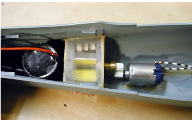
Das Eigenbau-Bugstrahlruder erwies sich letztendlich als zu schwach
