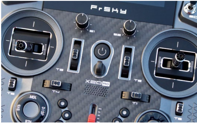
Mittig befindet sich der Ein-aus-Schalter, darüber sind zwei Dreh- und seitlich darunter zwei Tastgeber angebracht, unten sind ein Schiebekanal und sechs individuell belegbare Tasten vorhanden. Besser kann man ein Display nicht anordnen, es ist auch bei Sonnenlicht gut ablesbar
