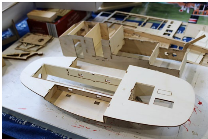
Das Innengerüst, das gleichzeitig Motorträger ist, wird aus Sperrholz zusammengesetzt
