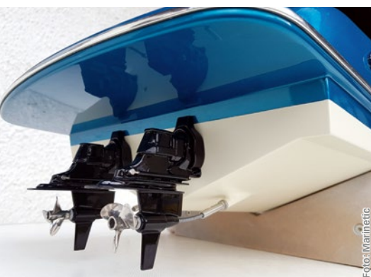
Das Heck des Marinetic-Modells der 35L mit zwei Mercruiser Z-Drive-Antrieben
