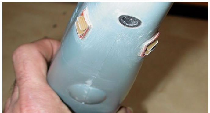
Die „Kiemen“ für das Bugstrahlruder, davor der Wassereinlass für Rückwärts
