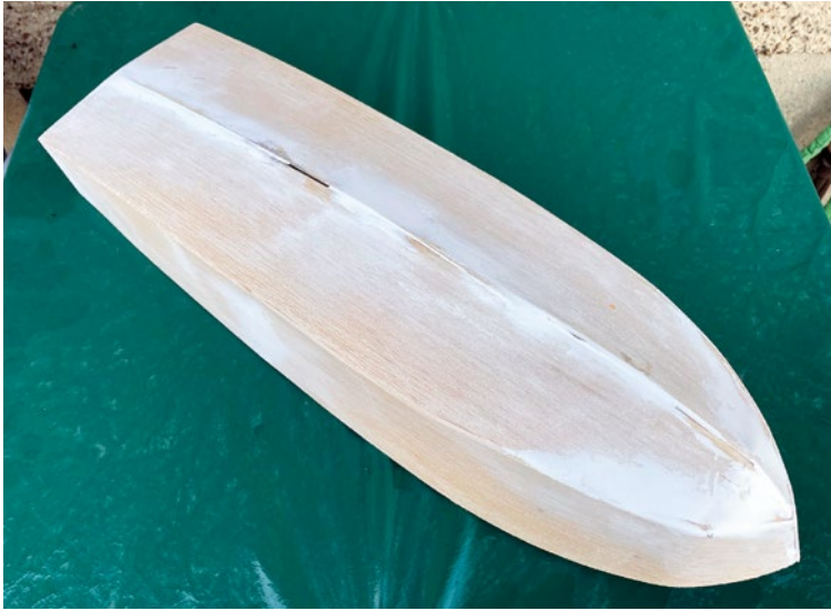
Die fertige Rumpfschale von unten. Ganz ohne Spachteln geht es doch nicht, wie die weißen Stellen zeigen
