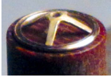
Abbildung 16: Nur mit einer Lötihilfe bekommt man den Stern gut zentriert
