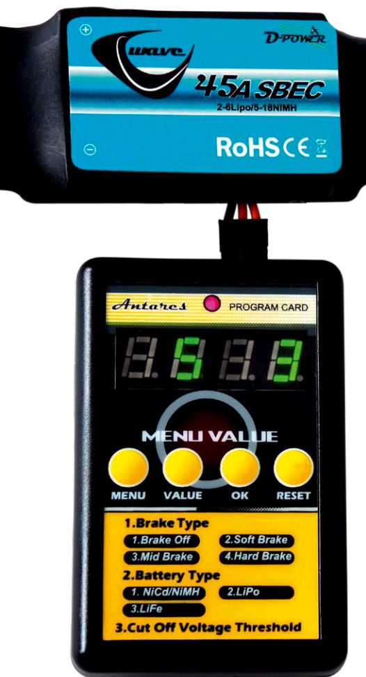
Mit der Antares Prog-Card sind Wave-Regler schnell und einfach zu programmieren
