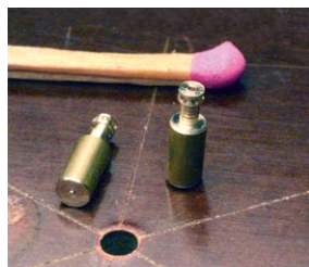
Abbildung 23: Die 3-mm-Bohrung muss oben entgratet werden
