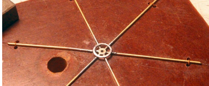
Abbildung 26: Das Auflöten des Rings muss nicht sauber aussehen
