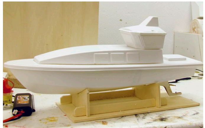
Der Schiffsaufbau wurde hier nur zur Passprobe aufgesetzt
