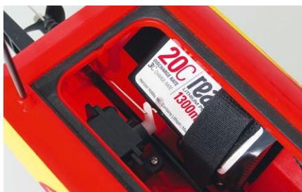
Klettverbindungen sichern den 3s-LiPo, der langen Fahrspaß ermöglicht
