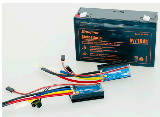
Zwei Fahrtenregler und ein schwerer Bleiakku sind zum Betrieb erforderlich
