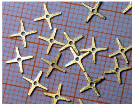
Abbildung 07: Die „Sterne“ abgesägt und entgratet
