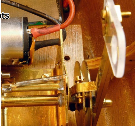
Die äußere Scheibe wird von der inneren über die am oberen Rand der Scheiben sichtbaren Klinke mitgenommen
