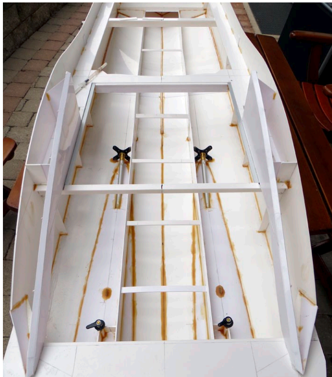
Mittig im Rumpf verläuft der noch nicht verschlossene Flutkanal bis zur Trennwand. Links und rechts davon sind die schwarzen Motorhalterungen befestigt
