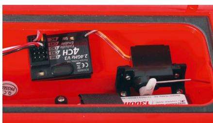
Das wasserdichte, stollgenaue Mini-Servo überzeugt ebenso wie die Empfangsanlage
