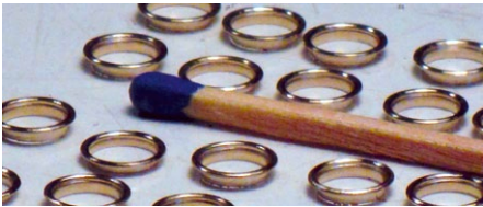
Abbildung 12: Die Oberseiten der Ringe sind gerundet und poliert
