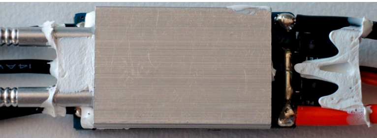
Wave 45 und 65 sind an der Platinenunterseite mit einem 6 Millimeter dicken Alukühlblock mit Schlauchanschluss zwecks Wasserkühlung ausgestattet
