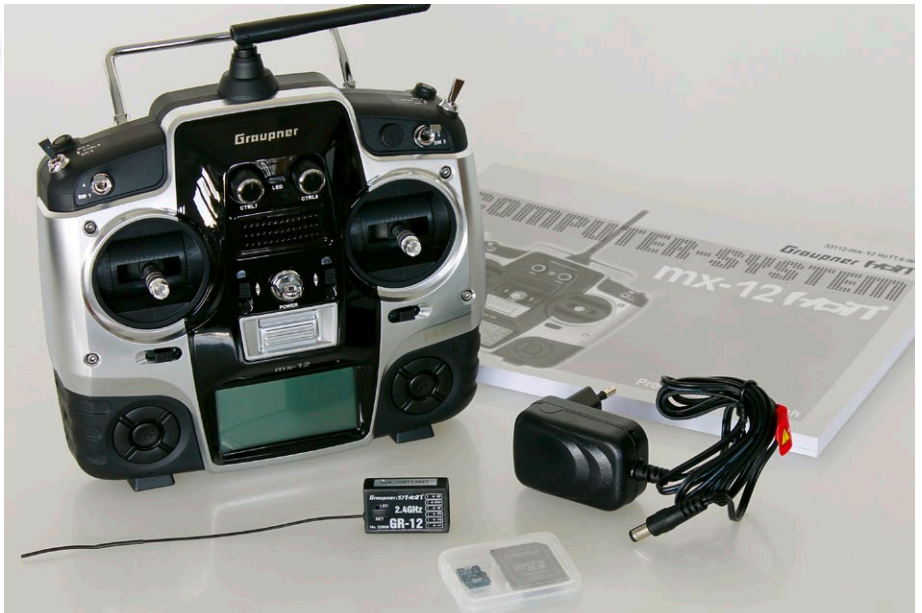
Praktisch für die Umsetzung von Sonderfunktionen ist ein guter Computer-Sender wie die mx-12 mit Sechskanalempfänger GR-12
