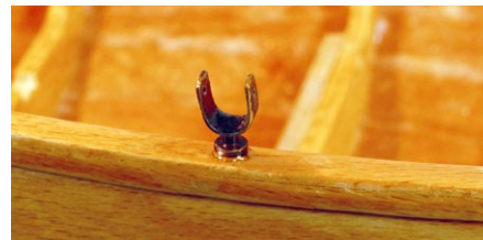
Die Riemen sind in drehbaren Gabeln, Dollen genannt, gelagert
