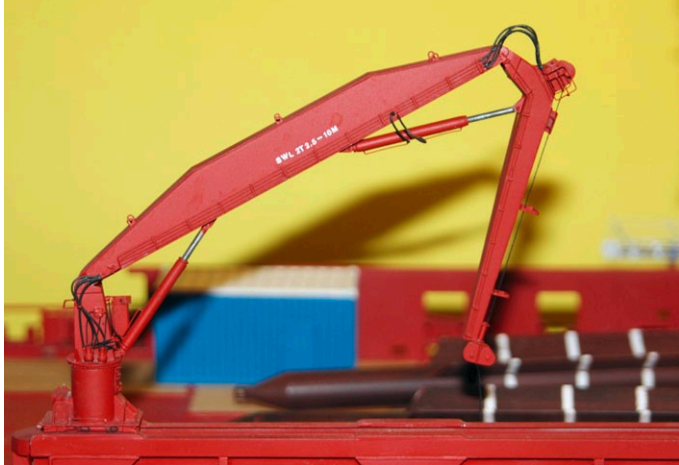
Der Hydraulikkran auf der steuerbord Cargorail ist manuell beweglich
