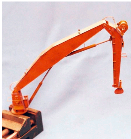
Der große Hydraulikkran nach dem Sandstrahlen. Der Kran ist komplett aus Bronze und Messing angefertigt
