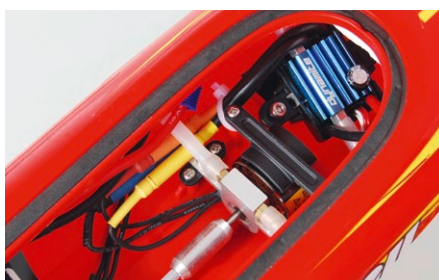
Dreamteam: hochdrehender, kraftvoller Außenläufer zusammen mit wassergekühlten 30-Ampere-Regler
