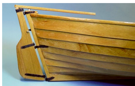
Das Flächenruder am Heck des Modells dient als „stille Reserve“, um das Boot auch ohne die Riemen manövrierfähig zu halten
