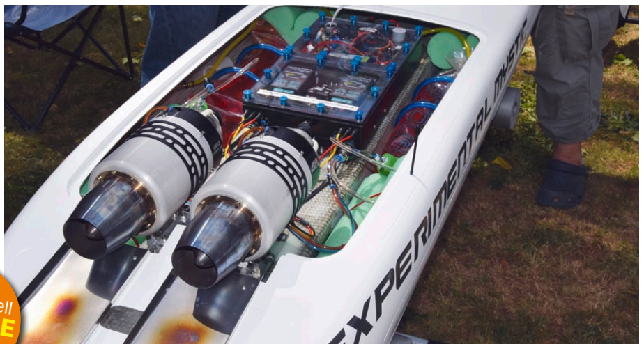
Die MYSTIC C5000 von Matthias Gneuß wird direkt – keine Schiffsschrauben – von zwei Strahltriebwerken beschleunigt
