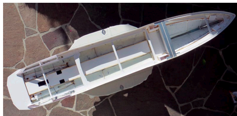
Mittig sieht man den jetzt verschlossenen Flutkanal. Bei einer Länger von 1.760 Millimeter sind die beiden Trennwände mit Aluminiumprofil-Verstärkung eingebracht
