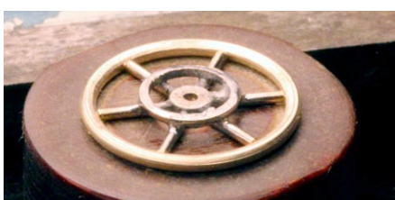
Abbildung 36: Passt, es kann gelötet werden, und zwar mit einem heizstarken Lötkolben für blitzschnelle Wärmeübertragung
