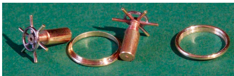
Abbildung 33: Den Abstechring kann man vermeiden, wenn man die Hauptschneide des Stechstahls leicht schräg anschleift
