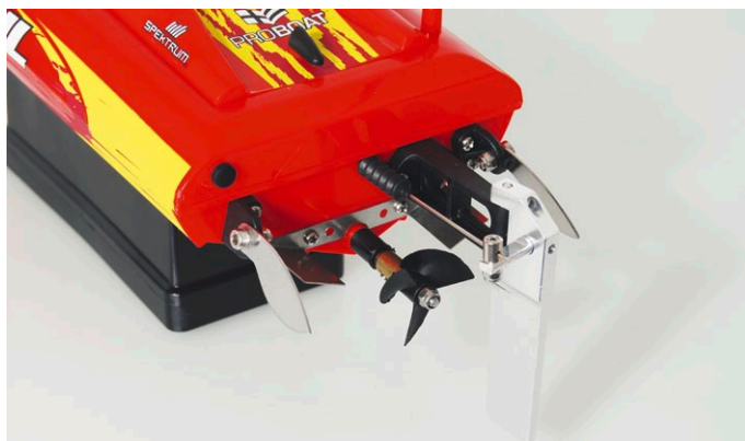
Wertige und praxistaugliche Komponenten sind am Heckspiegel montiert: Finnen, Keilruder, Dreiblattschraube und Trimmbleche
