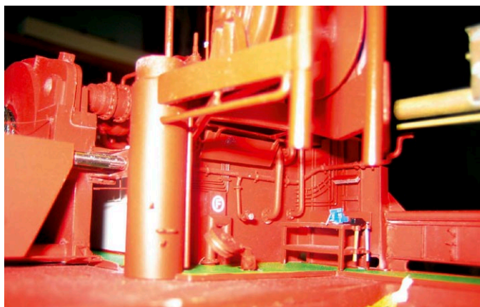
Die Nische vor der Cargorail Steuerbord. Neben etlichen Hydraulikleitungen und Stromkabeln befindet sich in dieser Nische eine Werkbank mit Schraubstock. Gut zu erkennen sind der Vorschlaghammer und einige Montiereisen. Damit werden die Bolzen der schweren Schäkel bearbeitet
