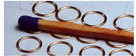
Abbildung 14: Die Unterseiten der Ringe bleiben nahezu eben
