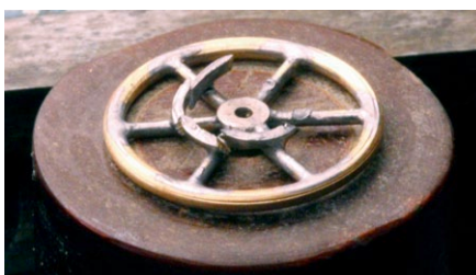
Abbildung 37: Hier erkennt man noch überschüssiges Zinn
