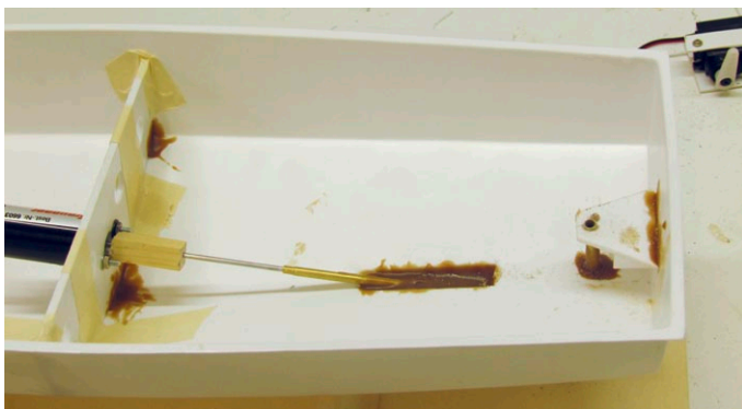
Das Stevenrohr wird mit reichlich Klebstoff fixiert
