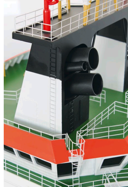
Geätzte Reling, saubere Lackierungen, sehr gut gestaltete Abgasrohre und vieles mehr zeichnet die NORDIC aus
