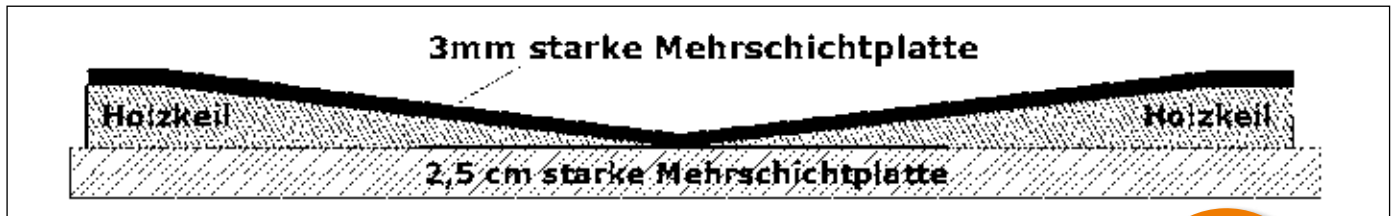
Zeichnung 2: Prinzipskizze zum hinteren Rumpfaufbau
