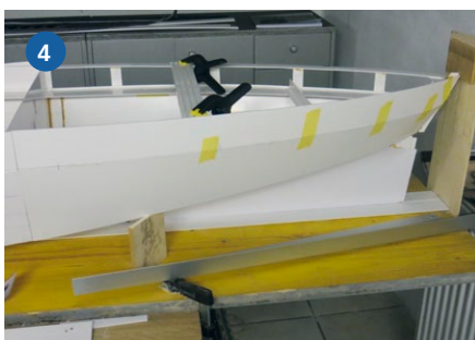
3) Die ersten Spanten wurden montiert, ebenso die linken und rechten Seitenteile sowie der Heckspant mit vorbereiteten Wellentunnelöffnungen. Mit Hilfe eines Kreuzlasers geht der Bau in Richtung Spitze voran
