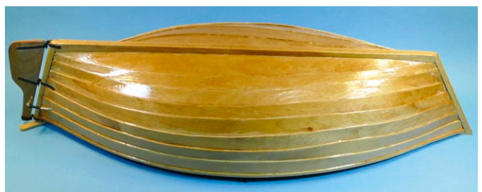
Der Rumpf des Ruderboots wurde wie beim Vorbild beplankt
