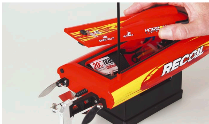
Einen effektiven Spritzwasserschutz gewährt der gut schließende Deckel
