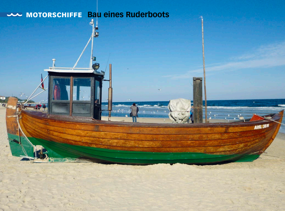
Ein Ahlbecker Fischerboot in Klinkerbauweise von 1915. An ein solches ist auch das Modell angelehnt
