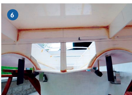
6) Blick von hinten auf die Wellentunnel, mit den Rudern. Mittig der Ausschnitt für den Flutkanal.
