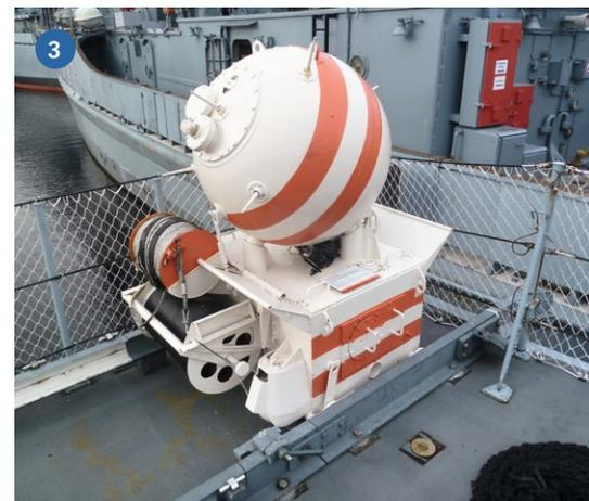
1) Einer der zwei Täuschkörperwurfanlagen. Sie dienen zur Täuschung und Ablenkung von Infrarot- und radargesteuerten Flugkörpern. 2) Einer der Startcontainer der Flugkörper wurde aufgeschnitten und mit einer Raketenattrappe ausgestattet. 3) Die GEPARD war auch zum Minenlegen ausgerüstet. Verschiedene Minentypen sind auf dem Achterdeck zu betrachten
