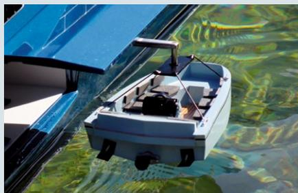
Der Tendarausschub erfolgt über ein Alu-Flachprofil. Es ist im nicht sichtbaren Bereich gezahnt und lässt sich dadurch von einem Getriebemotor ein- und ausfahren
