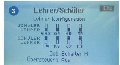
1) Am Beispiel der DX9: Zuordnung der Trackerkanäle auf 6-8 und das Stabi kommt auf 9. Die Trackerkanäle müssen an der Brille ebenfalls eingestellt werden. 2) Die Kanäle werden Gebern zugeordnet, damit man die Funktion des Gimbals manuell prüfen kann. 3) Die Lehrer-Schüler-Einstellungen: Sinnvoll ist es, die Tracker-Funktion mit einem Schalter ausschalten zu können. Hier übernimmt das der Schalter H
