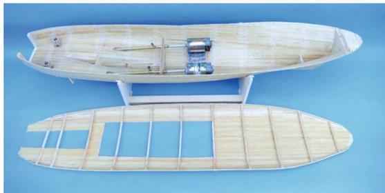
Rumpf und Deck konnten nach dem Bau getrennt werden, um den Antriebseinbau vorzunehmen
