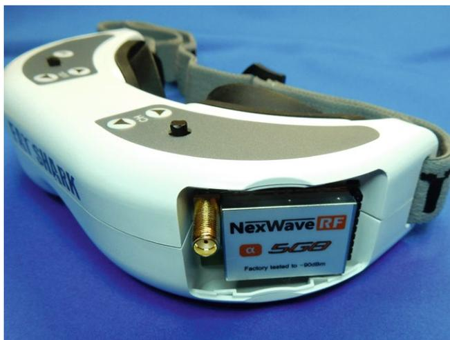
Das 5,8-Gigahertz-Modul muss nachgerüstet werden
