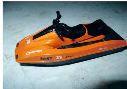
Auf in V-Form gebrachte ABS-Platten baut der Rumpf des Jet-Skis auf – wie beim Tender. Sitzfläche und Front entstanden aus vorgeformten Styrodur-Streifen. Verschliffen und verspachtelt stellt sich ein sehr realistischer Eindruck ein
