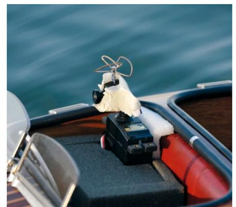
Fahrt mit der Kamera auf einem Servo montiert
