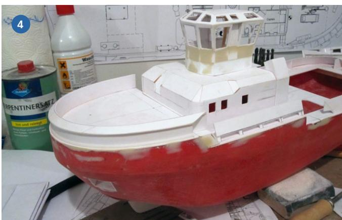
1) Das Backdeck wird auf den Rumpf aufgesetzt und das Übermaß abgeschnitten. 2) Die Decks sind mit den nötigen Öffnungen versehen und der untere Aufbau nimmt erste Formen an. Man sieht die Unterkonstruktion. 3) Die Schrägen wurden angekippt. Die Brücke entsteht in der gleichen Weise. 4) Bei der vorderen Schanz entstand erst die Rückwand, dann folgten die geraden Wände hinter der Aushöhlung
