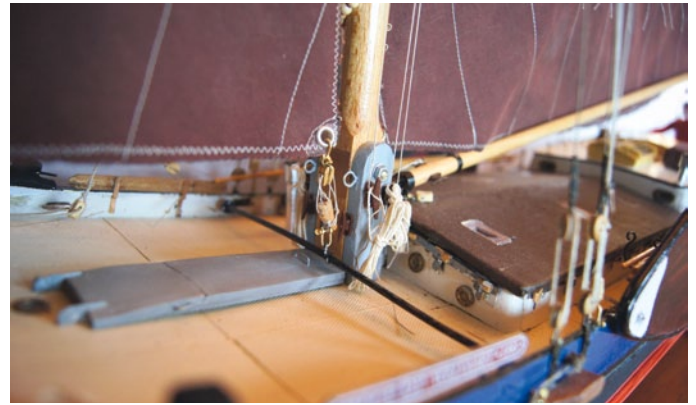
Der rechteckige Mastfuß des 800 mm langen Masts wurde von mir zurecht geschliffen
