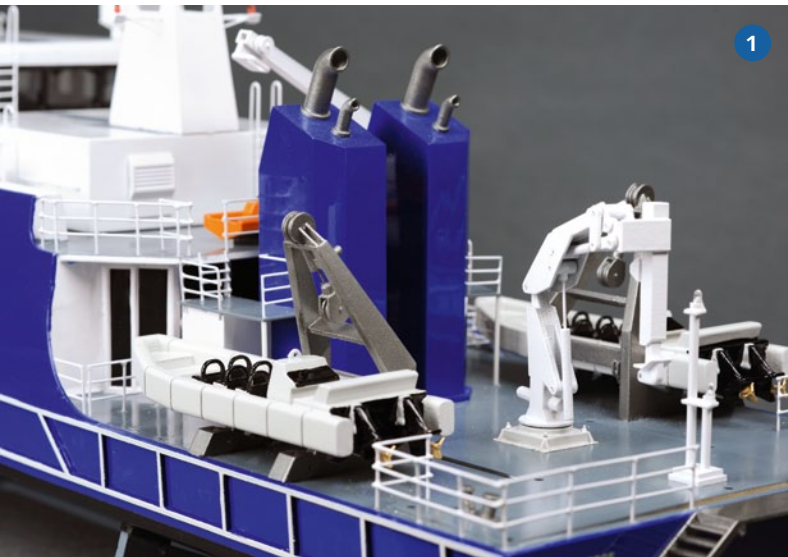
1) Die CAPE ST. GEORGE ist von einer Fülle an Ausrüstungsgegenständen gekennzeichnet – viele sind 3D-Druck-Teile. 2) Ein großes Problem beim Erstellen von Reling, Handläufen und Treppen bestand mit dem Messingdraht, der als rollierter Draht beilag und somit nicht glatt ist. 3) Links ist der rollierte Draht und rechts der gezogene Draht zu sehen. Letzterer ist gerade und glatt
