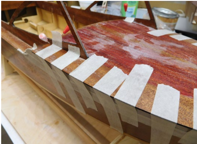
Das vordere Deck wird beim Verkleben mit Krepfstreifen auf den Rumpf gedrückt
