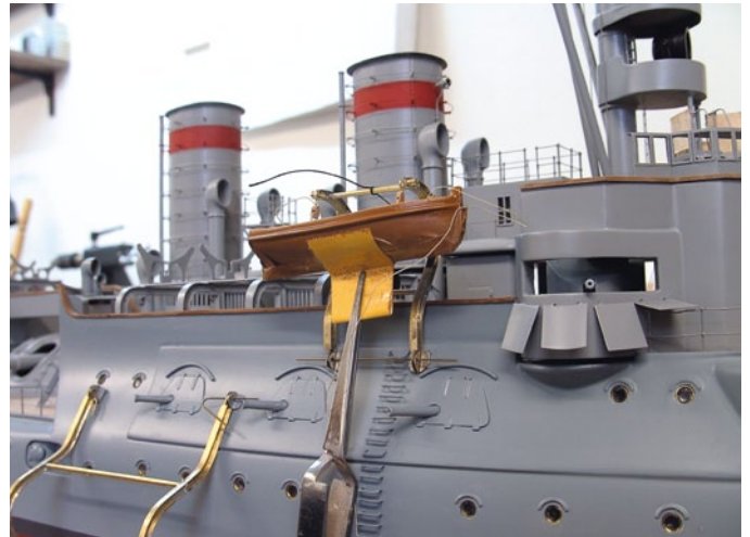
Bei den Klappdavits ist auf den Drehpunkt zu achten. Dafür sind S-förmige Grundkörper herzustellen. Das alles muss zum Beiboot und zur entsprechenden Rumpfkontur der BRANDENBURG passen
