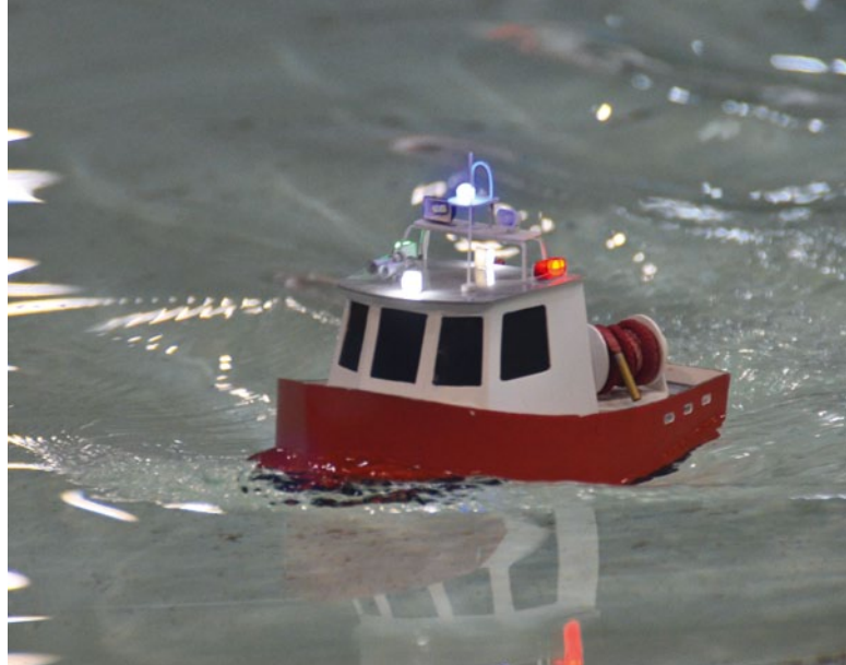
Als Funkellicht dient eine normale blaue LED. Ihre Ansteuerung im programmierbaren Blitzmodus erfolgt von der Platine aus
