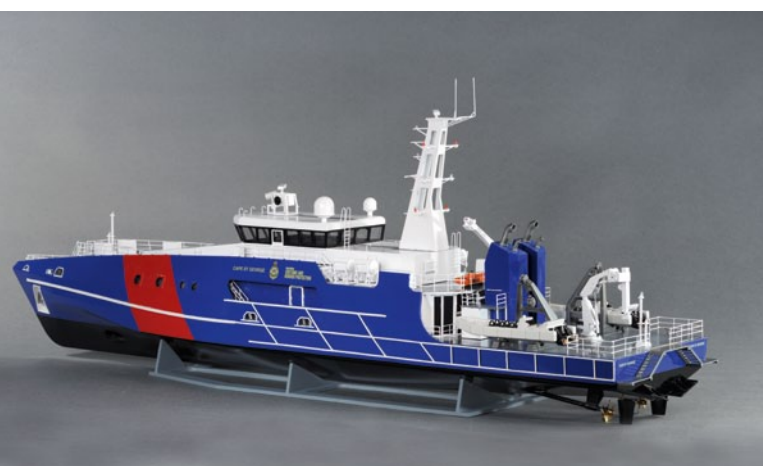
Stilprägend sind die großzügig am Rumpf angebrachten Scheuerleisten. Bemerkenswert ist aber auch das flach bauende Heck
