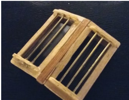
Etwas Kleinarbeit war für das Oberlicht notwendig. Dieses besteht aus siebzehn Leisten, einer Verglasung und Scharnieren
