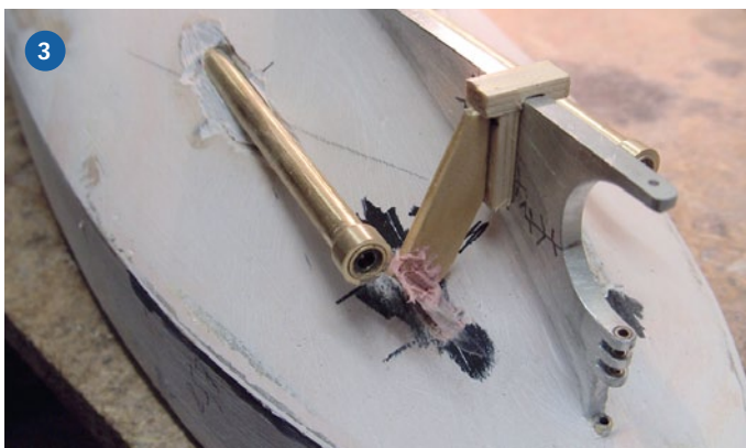
1) Zugunsten einer stabilen Bauweise sind Ruder und Bug aus massivem Alu gefertigt. Sollte mal irgendetwas im Wasser im Weg sein, verursacht das keine Schäden. 2) Die Rudereinheit und die Stevenrohre mit selbstgebauten, kugelgelagerten Wellen sind alle selbst gefertigt. Das Ruderscharnier ist besonders stabil ausgeführt. 3) Einfache Konstruktion zur Herstellung der Spreizwinkel. 4) Wellenparallelität ist ein wichtiges Kriterium. Sie lässt sich mit dieser Hilfsvorrichtung erzielen. Damit der Lochabstand beider Brettchen identisch ist, müssen sie unbedingt zusammen gebohrt werden. 5) Um den Freilauf beider Propeller zu gewährleisten, dienen zwei passende Holzscheiben. Sitzt hier alles richtig, kann auch der passende Motorantrieb ausgesucht werden
