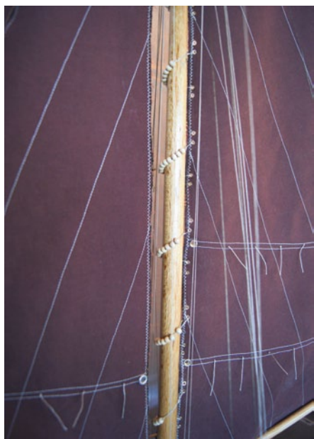
Die größte Herausforderung stellten die Segel dar. Alleine in den Lieken sind insgesamt 51 Kauschen angebracht
