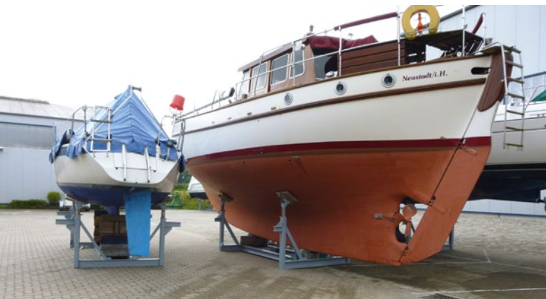
Links ein moderner Leichtdeplacementkreuzer und rechts ein Spitzgatter vom Typ COLIN ARCHER. Das Überwasserschiff hat gewisse Ähnlichkeiten, das Unterwasserschiff nicht. Doch das ließe sich durch Verzerren näherungsweise erreichen
