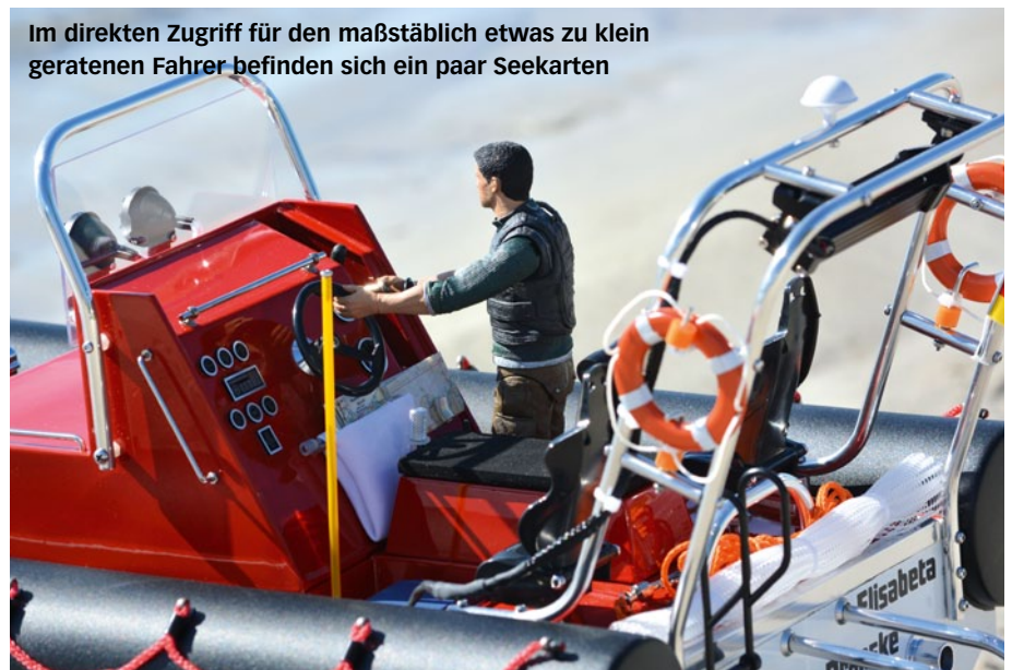
Es wirkt, als bestünde der Geräteträger aus verchromten Rohren, tatsächlich handelt es sich um auf Hochglanz poliertes Alu
