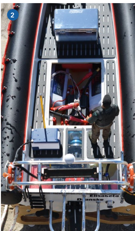
1) Die Umkehrung des Schubs beim Jet erfolgt durch eine Calzoni-Klappe. 2) Beide LiPo-Akkus sind mittig im Rumpf platziert und lassen sich zwecks Einstellung der Schwimmelage etwas verschieben. 3) Der „Durchblick“ mag ungewöhnlich erscheinen, ist jedoch äußerst praktisch bei Wartungs- oder Einstellarbeiten
