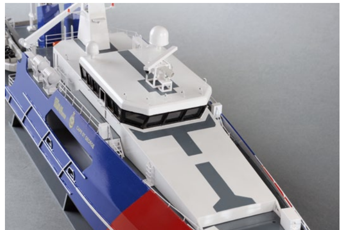
Einen sehr modernen Eindruck vermittelt die Bauweise des oberen Fahrstands. Dass die Oberflächen so glatt erscheinen, war nur durch sorgfältige Spachtelarbeit möglich
