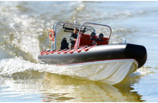
Hier gut zu erkennen ist die Verdrängung des Wassers flach zur Seite weg
