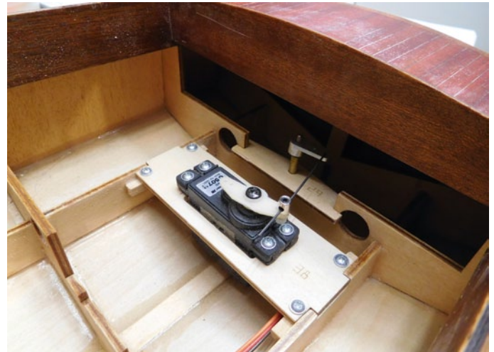
Die Ruderanlenkung ist extrem kurz und damit sehr präzise
