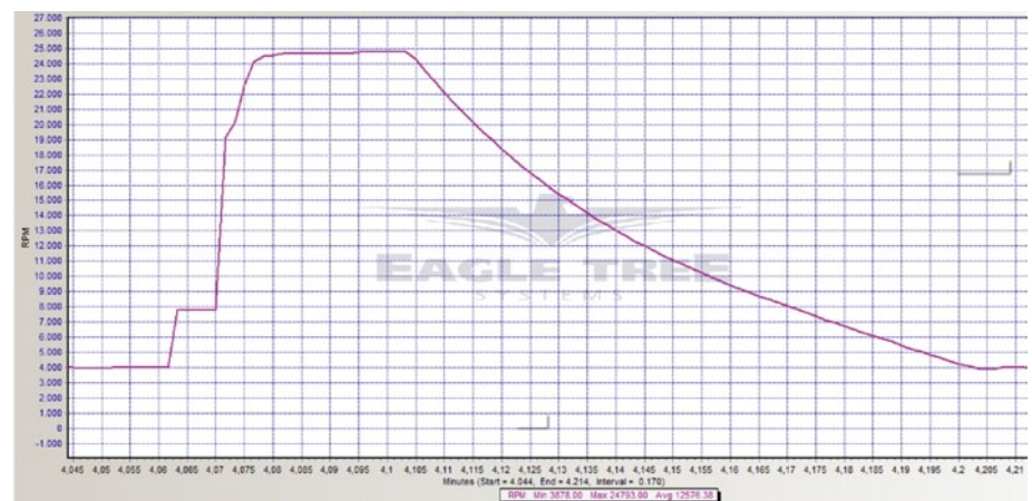
In nur wenigen Sekunden fährt der Fräsmotor von kleinster bis höchster Drehzahl hoch, beim ebenso raschen Herunterregeln sorgt die Elektronik für eine sanfte und langsame Abbremsung des Motors
