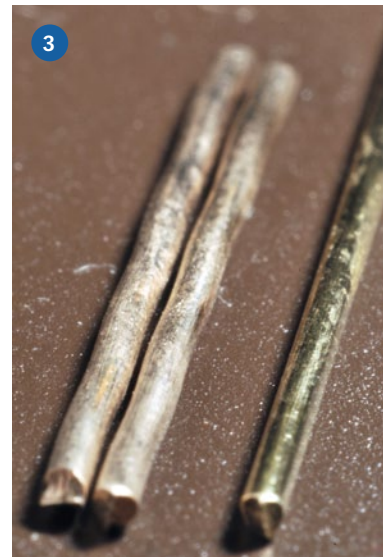
1) Die CAPE ST. GEORGE ist von einer Fülle an Ausrüstungsgegenständen gekennzeichnet – viele sind 3D-Druck-Teile. 2) Ein großes Problem beim Erstellen von Reling, Handläufen und Treppen bestand mit dem Messingdraht, der als rollierter Draht beilag und somit nicht glatt ist. 3) Links ist der rollierte Draht und rechts der gezogene Draht zu sehen. Letzterer ist gerade und glatt
