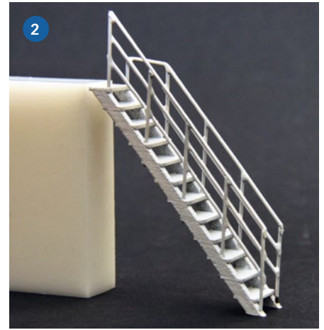
1) Aufgesteckt auf Halterungen lassen sich die Lackierarbeiten nach dem Lötten am effektivsten umsetzen. 2) Hier mal als Beispiel eine Treppe aus einem 3D-Druck-Teil, deutlich erkennbar ist die Riefenstruktur, mit Handläufen
