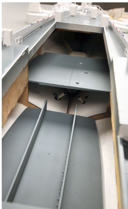
Die geklemmten Einbaudecks mit RC-Technik. Dass man sie herausnehmen kann, hilft bei Wartungsarbeiten
