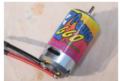
Da die passenden Bohrungen für einen Bürstenmotor der 600er-Serie bei der CAPRI bereits vorhanden sind, lässt sich dieser sehr einfach einsetzen
