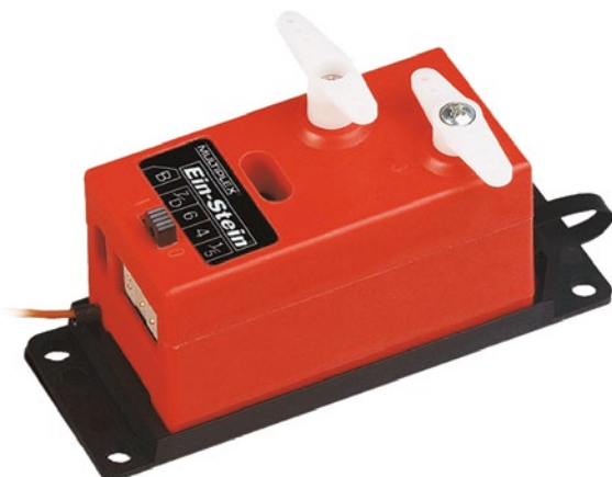
Wenn es um innovative Ideen ging, ist Multiplex schon immer ganz vorne mit dabei gewesen, wie auch der „Ein-Stein“ von 1997 zeigt. In ihm sind ein Empfänger mit zwei Servos und fünf freien Plätzen enthalten, was viel Platz sparte
