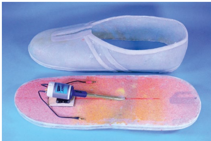
Der Antriebsmotor sitzt im Inneren des Schuhs auf der Sohle, Schraube und Ruder werden anschließend außen angebracht
