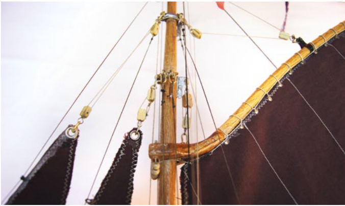
Der Gaffelbaum wurde zurecht gesägt und mithilfe einer Feile in die richtige Form gebracht
