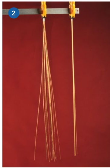
1) Die CAPE ST. GEORGE ist von einer Fülle an Ausrüstungsgegenständen gekennzeichnet – viele sind 3D-Druck-Teile. 2) Ein großes Problem beim Erstellen von Reling, Handläufen und Treppen bestand mit dem Messingdraht, der als rollierter Draht beilag und somit nicht glatt ist. 3) Links ist der rollierte Draht und rechts der gezogene Draht zu sehen. Letzterer ist gerade und glatt
