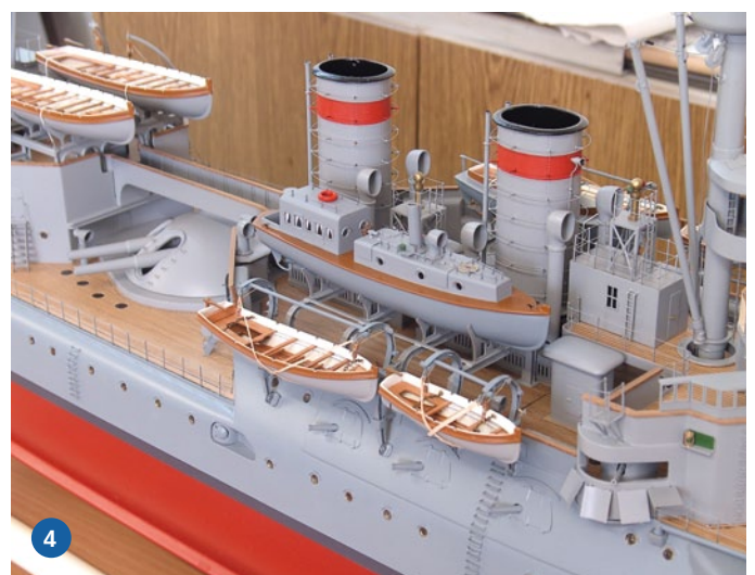
1) Die Träger für die Beiboote sind selbstverständlich exakt der Rumpfform angepasst. 2) Korrekt angebaut kann man die Beiboote auch zu Wasser lassen. Das Bild gibt außerdem einen Eindruck davon wieder, wie viele Details sich an einem Schiff wie der BRANDENBURG realisieren lassen. 3) Ein Blick auf das Modell im demontierten Zustand. Unter dem vorderen Geschützturm befinden sich Ladebuchse und Ein-Aus-Schalter. 4) Die große Barkasse war dem Transport von höheren Offizieren vorbehalten
