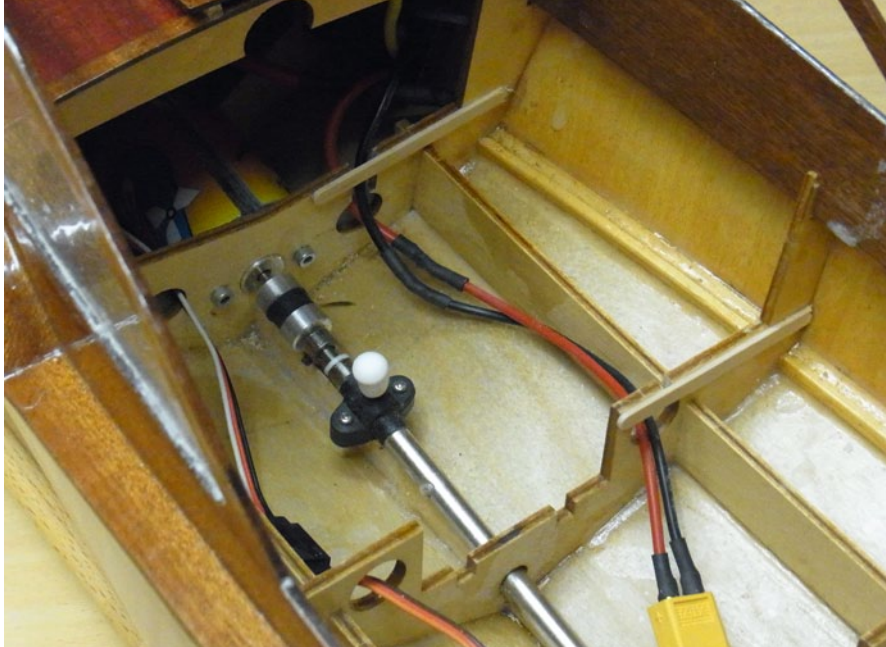
Der fertige Motor- und Welleneinbau mit gedämpfter Wellenkupplung
