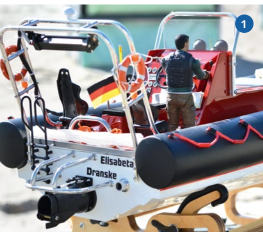
1) Die Umkehrung des Schubs beim Jet erfolgt durch eine Calzoni-Klappe. 2) Beide LiPo-Akkus sind mittig im Rumpf platziert und lassen sich zwecks Einstellung der Schwimmelage etwas verschieben. 3) Der „Durchblick“ mag ungewöhnlich erscheinen, ist jedoch äußerst praktisch bei Wartungs- oder Einstellarbeiten
