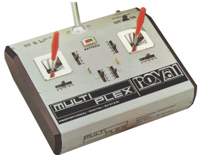
Langgedienten Schiffmodellbauern dürfte die Fernsteuerung Multiplex Royal aus dem Jahr 1971 noch gut in Erinnerung sein. Sie war eine der ersten Sender nach moderner Bauart und bot eine hohe Übertragungssicherheit
