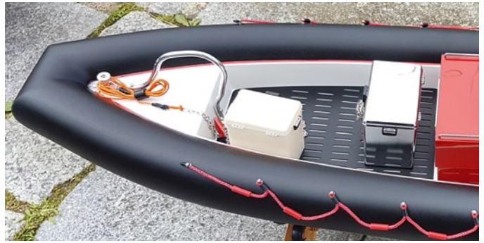
Viel Mühe wurde in die Umsetzung von Details wie dem Haltegriff, einem Sandanker oder dem Bodenbelag gesteckt, der aus GFK-Plattenmaterial gefräst ist
