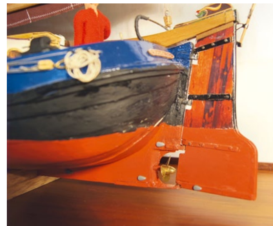
Die Decals am Ruder mussten sorgfältig einzeln zwischen den Scharnierbändern eingeklebt werden
