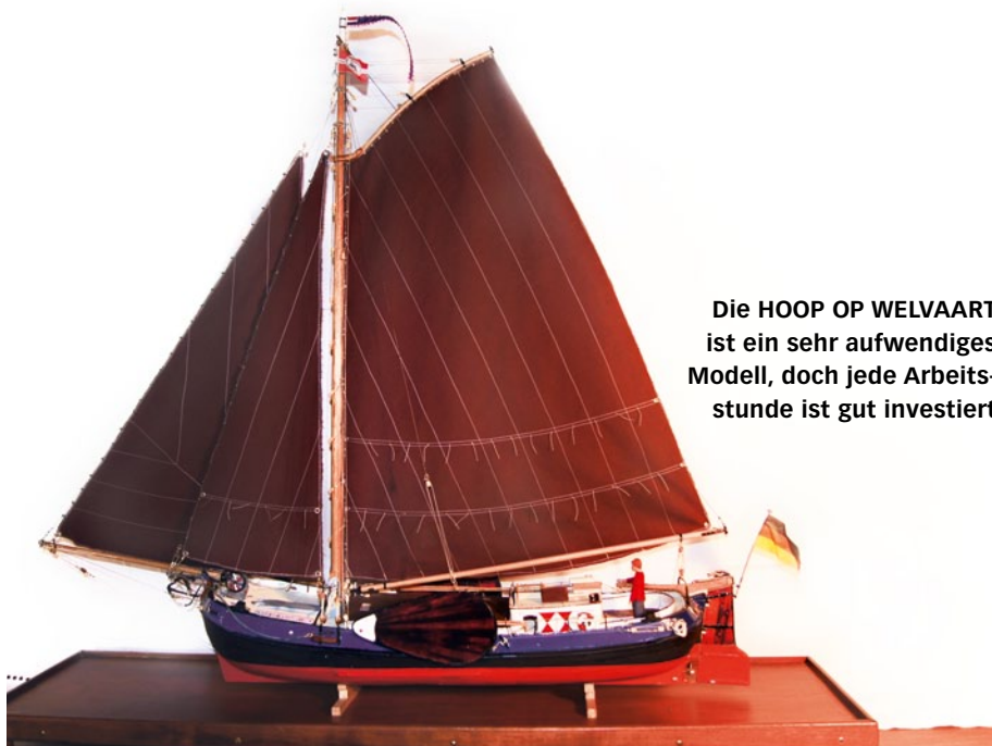
Die größte Herausforderung stellten die Segel dar. Alleine in den Lieken sind insgesamt 51 Kauschen angebracht
