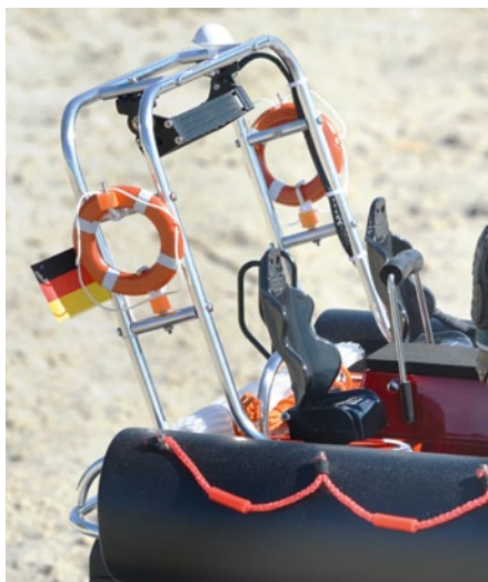
Es wirkt, als bestünde der Geräteträger aus verchromten Rohren, tatsächlich handelt es sich um auf Hochglanz poliertes Alu
