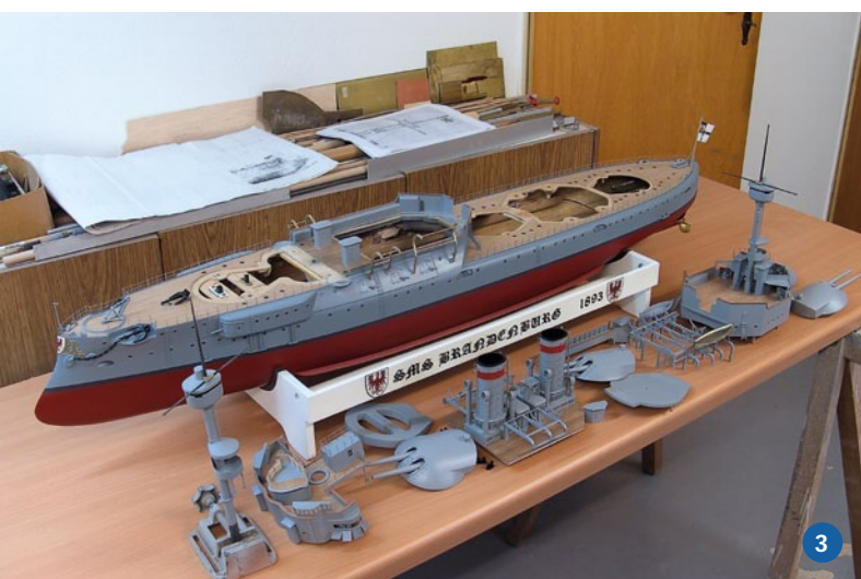
1) Die Träger für die Beiboote sind selbstverständlich exakt der Rumpfform angepasst. 2) Korrekt angebaut kann man die Beiboote auch zu Wasser lassen. Das Bild gibt außerdem einen Eindruck davon wieder, wie viele Details sich an einem Schiff wie der BRANDENBURG realisieren lassen. 3) Ein Blick auf das Modell im demontierten Zustand. Unter dem vorderen Geschützturm befinden sich Ladebuchse und Ein-Aus-Schalter. 4) Die große Barkasse war dem Transport von höheren Offizieren vorbehalten
