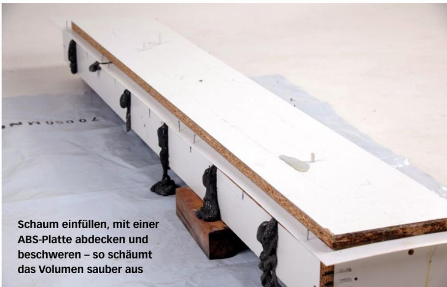
Schaum einfüllen, mit einer ABS-Platte abdecken und beschweren – so schäumt das Volumen sauber aus
