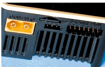
Die linke Seite mit den Anschlüssen für Akku, Servo, Balancer und dem Slot für eine Micro-SD Karte
