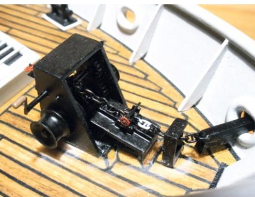
Die Ankerwinde ist ein besonders Schmuckstück des Küstenwachboots. Sie besteht aus diversen Zahnrädern und Kunststoffprofilen. Der Anker wurde zugekauft und umgebaut
