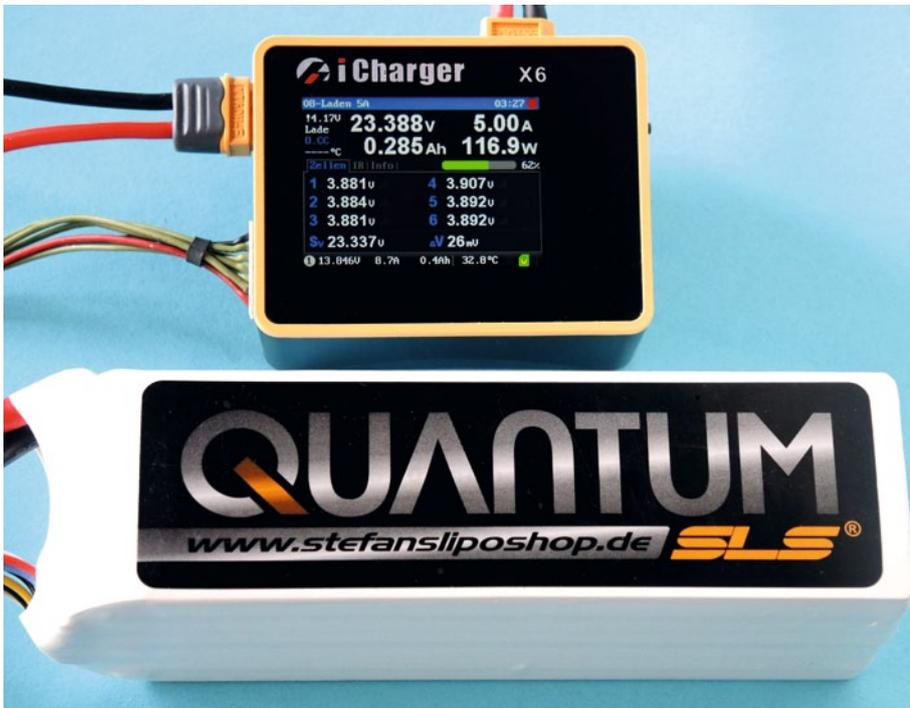
X6-Lader beim Laden eines 6s-LiPos mit 5.000 mAh Kapazität vom Typ Quantum
