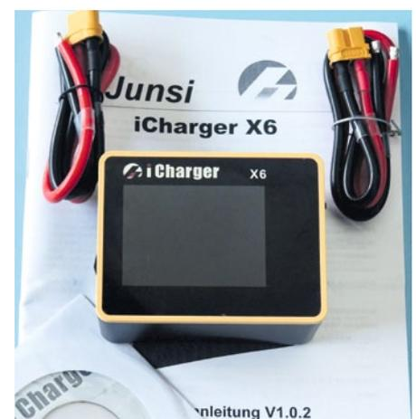
Der X6-Lader wird mit zwei Kabeln mit XT60-Stecker und deutscher Bedienungsanleitung geliefert
