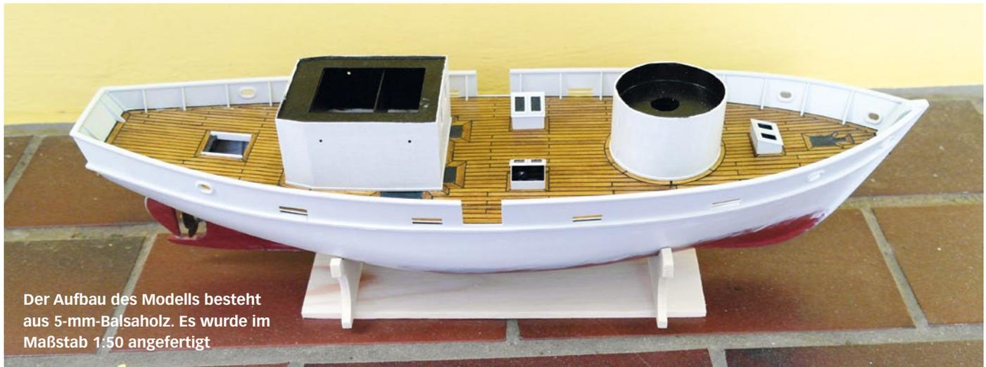
Der Aufbau des Modells besteht aus 5-mm-Balsaholz. Es wurde im Maßstab 1:50 angefertigt
