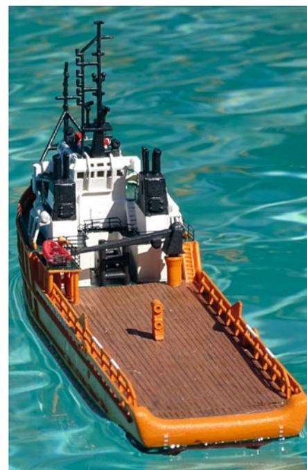
Ein Highlight des Modells ist das Echtholzdeck. Auf dem Achterdeck wird dazu ein dünnes Holzfunier aus Zeder eingefügt. Auf dieses wird die Struktur von Holzleisten aufgezeichnet
