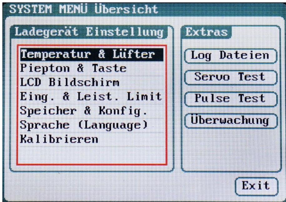
System-Menü, in dem sich die entsprechenden Lader-Einstellungen vornehmen lassen. Außerdem stehen noch drei Extrafunktionen zur Verfügung, darunter auch ein Servo Tester
