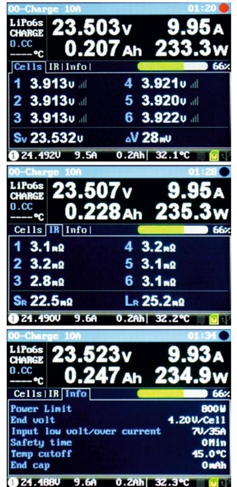
Bei den Lade/Entlade-Vorgängen werden alle relevanten Daten auf drei Displayfenster Cells, IR und Info angezeigt
