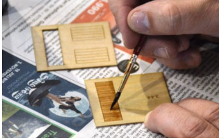
Die Kassettenteile werden gebeizt
