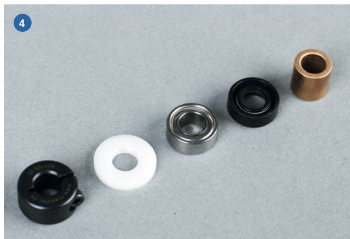
1) Fertig montierte Wellenanlage – sie setzt sich aus entscheidenden Komponenten zusammen und löst alle im Artikel beschriebenen, Wellentypischen Probleme. 2) Die Montage des Props auf der Welle erfolgt optimaler Weise per Konus. 3) Während das Aufmacherfoto dieses Artikels das Lager Außenbords zeigt, hier ein Blick auf das Lager Innenbords. 4) Alle Lager-Teile im Schiffsinneren Bereich entsprechend ihrer Lagerfolge und dem Stellung
