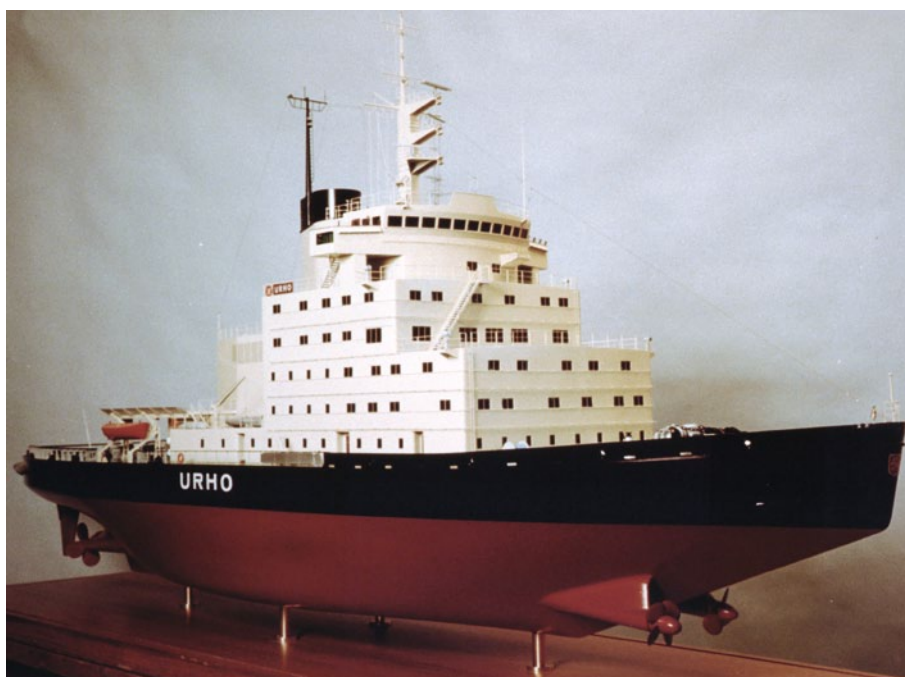
Das Modell des Eisbrechers URHO zeigt, das Wellenanlagen sowohl hinten als auch vorne platziert sein können
