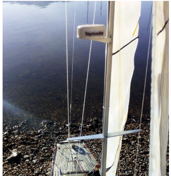
Aus einfachen Mitteln einen großen Effekt erzielen: Diesem Motto ist Marcello Ciola auch bei seinem Radar treu geblieben. Er aus einem Deckel einer Plastikflasche, die mit einem Dremel glatt geschliffen und mit weißer Farbe angestrichen wurde. Darauf ist ein Firmenname zu sehen, über den nochmals mit Klarlack gestrichen wurde
