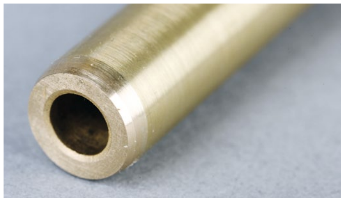
Hier ist das Lager Außenbords bereits im Stevenrohr verpresst – der Teflonring liegt dann, außen auf der Welle platziert, dagegen
