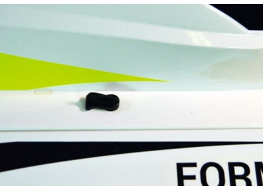
Die aufgesetzte Fahrererkabine mit den seitlichen Knebeln zum Verschließen
