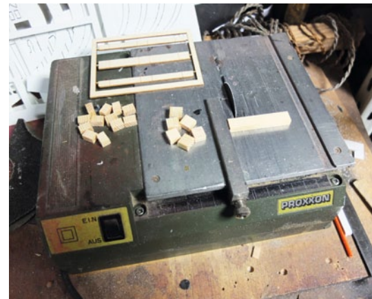
Eine kleine Kreissäge hilft dabei, die Füße herzustellen – natürlich gelingt das auch beispielsweise mit einer normalen Gehrungs-Handsäge
