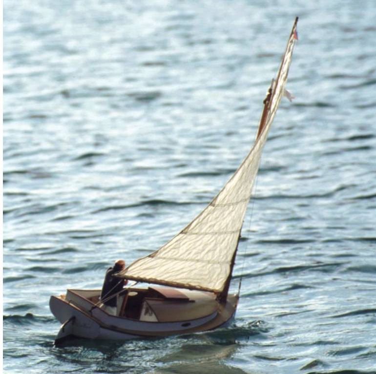
Das nur 550 Millimeter lange CATBOAT wurde mit einem Programm entwickelt und segelt lediglich mit seinem originalgetreuen Ballastschwert dank der großen Breite auch bei kräftigem Wind
