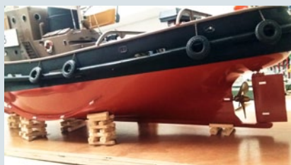
1) Der verbreiterte Rumpf ist fertig. 2) Das offene Beiboot, das bereits nach dem ersten Umbau so bestand, wurde beibehalten. 3) Das Radar am vorderen Mast wird über ein umgebautes Mikroservo angetrieben. Die Auslösefunktion des Schlepphakens wurde mit einem Hubmagneten realisiert
