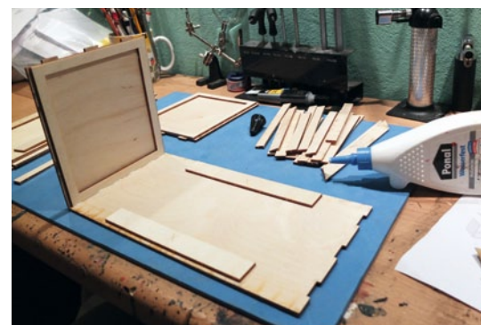
Die vorsortierten und vorgefertigten Bauteile lassen sich sehr gut mit Holzleim verkleben
