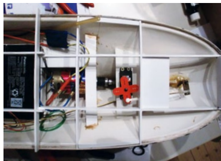
Der ursprünglich eingebaute Motor – ein Elefant von Conrad – kam wieder zum Einsatz. Der Fahrregler wurde direkt daneben angebracht, vorrangig, um keine überlangen Motorkabel zu haben
