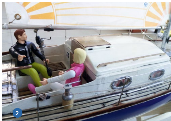
1) Dieser Flaschenzug für die Großschot entstand aus 0,3 Millimeter dickem, schwarzem Papier. 2) Beim Auftakeln wird der obere Block mit lösbaren Hacken am Großbaum befestigt. 3) Auf der Spitze der Relingstütze und auf Höhe von 20 Millimeter wurden mit Sekundenkleber Perlen in Innoxfarbe aufgeklebt
