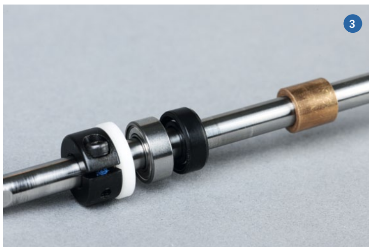
1) Fertig montierte Wellenanlage – sie setzt sich aus entscheidenden Komponenten zusammen und löst alle im Artikel beschriebenen, Wellentypischen Probleme. 2) Die Montage des Props auf der Welle erfolgt optimaler Weise per Konus. 3) Während das Aufmacherfoto dieses Artikels das Lager Außenbords zeigt, hier ein Blick auf das Lager Innenbords. 4) Alle Lager-Teile im Schiffsinneren Bereich entsprechend ihrer Lagerfolge und dem Stellung
