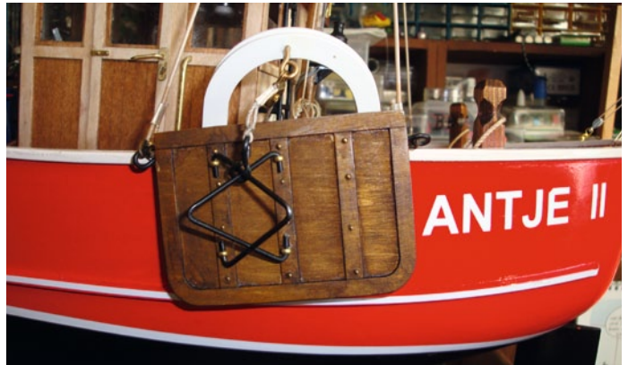
Die Scherbretter entstehen. Dazu wird zunächst das Holz gebeizt und dann die Metallteile angebracht
