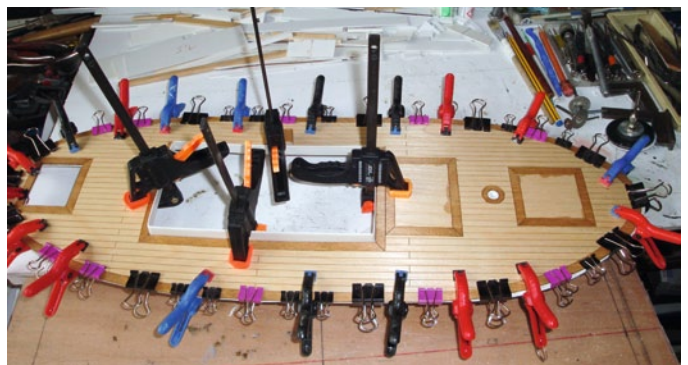
Unter dem Holzdeck befindet sich ein tiefgezogenes ABS-Deck, so ergibt sich die Balkenbucht
