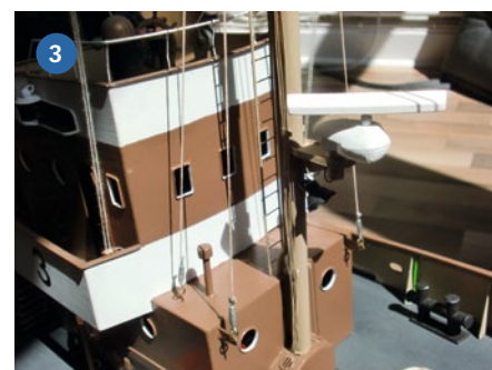
1) Der verbreiterte Rumpf ist fertig. 2) Das offene Beiboot, das bereits nach dem ersten Umbau so bestand, wurde beibehalten. 3) Das Radar am vorderen Mast wird über ein umgebautes Mikroservo angetrieben. Die Auslösefunktion des Schlepphakens wurde mit einem Hubmagneten realisiert
