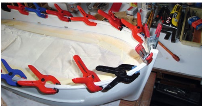
Auch die Handläufe entstehen aus einem Kunststoffprofil
