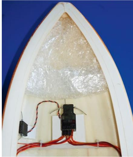
**Kleiner Tipp: Luftpolsterfolie ist ein wirkungsvoller, flexibler Auftriebskörper**
