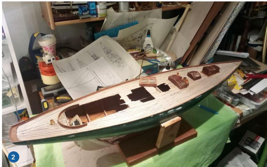
1) Der Steuerstand wird vor dem Segeln von oben schräg nach unten eingeschoben und mit Klettverschluss bug- und heckseitig hängend befestigt. 2) Die Kalfaterung ist aufgebracht, nun geht es beim Decksaufbau in die finale Phase
