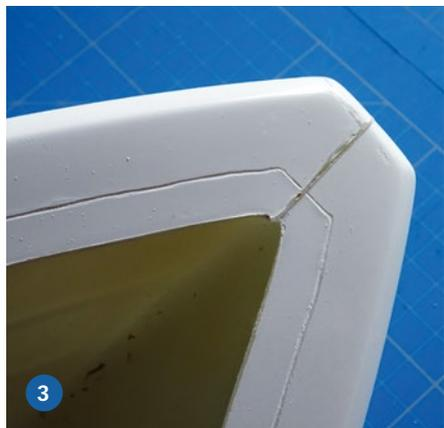
1) Erste „Werftprobefahrt“ mit provisorisch abgeklebtem Deck. Für zeitgemäßen Vorschub sorgen Außenläufer von Krick, die mit je 3.500 kv sehr gut zum Konzept des Modells passen. 3) Die GFK-Teile sind von sehr guter Qualität. Die Rumpfspitze mit der Mittelnah und dem Anriss für das Deck
