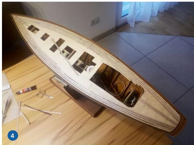
3) Der Erbauer fertigte ein neues Ruder aus Balsaholz (unten) mit doppelter Fläche wie ursprünglich an, um die Steuerbarkeit zu verbessern. 4) Nachdem das Deck die richtige Form hatte, wurden die erforderlichen Ausschnitte eingebracht
