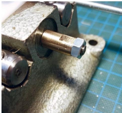
Montiert: Gewindehülse mit Kontermutter
