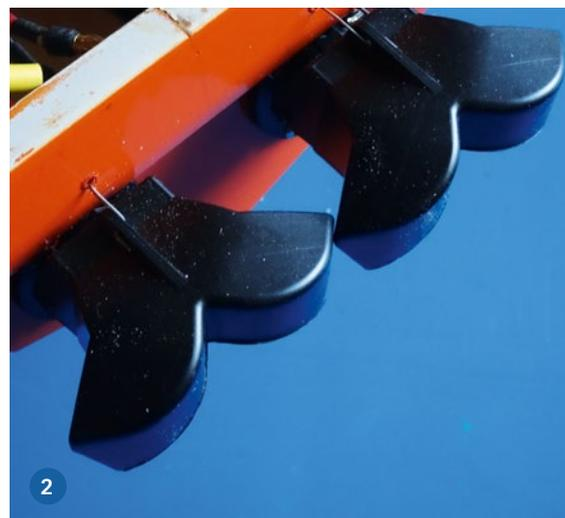
1) Das Testmodell hat vier Servos bekommen: zwei für die Lenkung und zwei für die Umkehrschubklappen. Der Empfänger sitzt relativ weit vorn im Rumpf. Die Kabel zu den Servos und Reglern werden sicher gebündelt dorthin geführt. 2) Leider sind die Anrisse für die Antrieb etwas zu eng zusammen. Daher stoßen die Umkehrschubklappen aneinander
