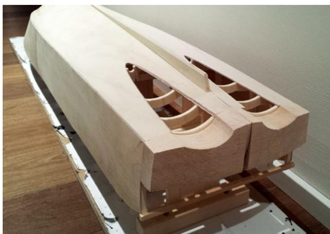
Die Tunnel für die Antriebe wurden zunächst ausgeschnitten ...
