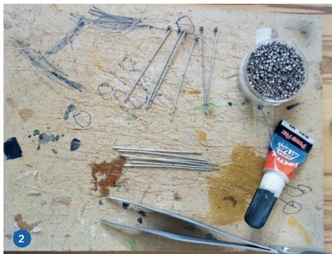
1) Die jeweiligen Winschen der Focksegel wurden durchgebohrt, damit die beiden Fockschoten ins Innere des Decks geführt werden können. 2) Die Relingstützen entstanden aus Edelstahlraht mit gleichfarbigen kleinen Perlen
