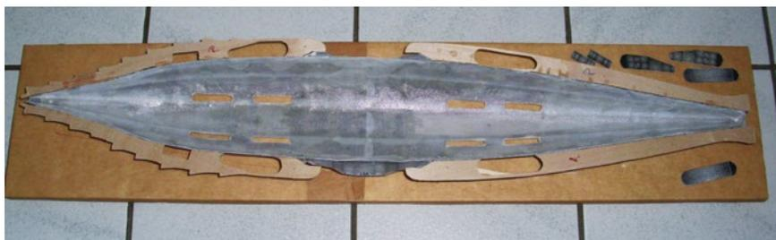
Die Basis der NAUTILUS war ein Papiermodell. Durch GFK-Schichten im Inneren konnten Stabilität und Wasserdichtigkeit hergestellt werden
