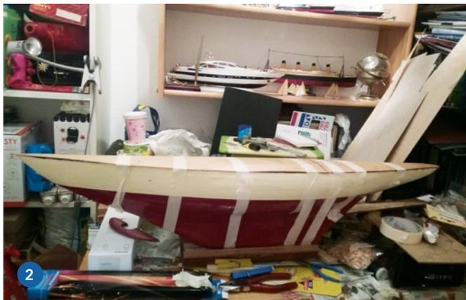
1) Um das passende Deck zum bereits fertigen Rumpf zu fertigen, wurden zwei Birkenholzplatten mit den Abmessungen 600 x 300 x 1,5 mm in Längsrichtung zusammengeklebt. 2) Das Deck wurde in Wasser eingeweicht und danach provisorisch mit Klebeband auf den Rumpf geklebt. Nach der Trocknung über Nacht hatte es die erforderliche Krümmung
