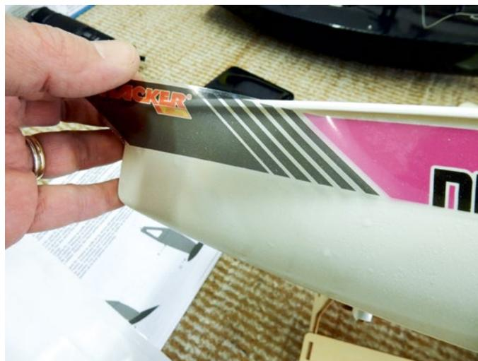
... sie können dadurch präzise und blasenfrei positioniert werden
