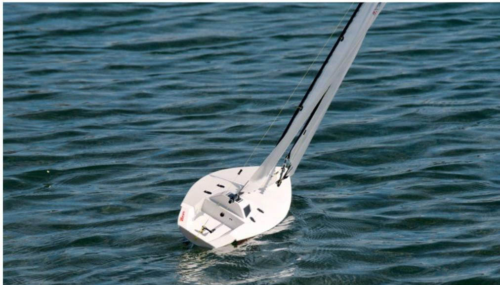
Hart am Wind stehen die Segel fast mittschiffs, die Höhe am Wind ist sehr gut
