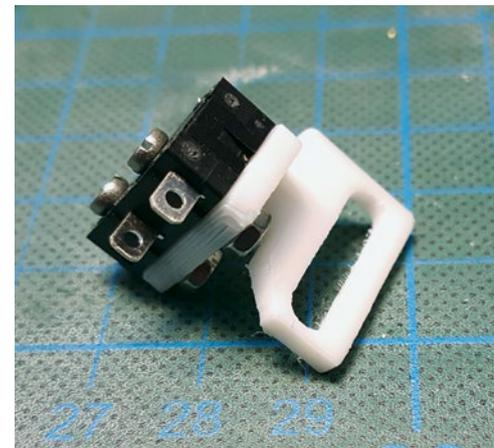
Gedruckte Halterung für Mikroschalter
