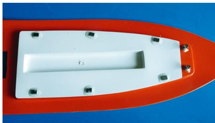
Das Zwischendeck wird von sechs Magneten auf dem Deck gehalten. Die zwei Schrauben vorne dienen der Halterung des Aufbaus, der ebenfalls mit Magneten gesichert wird
