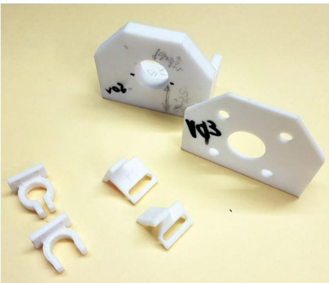
**Mehrere Schritte waren nötig, bis die finale Gestaltung der gedruckten Bauteile feststand**
