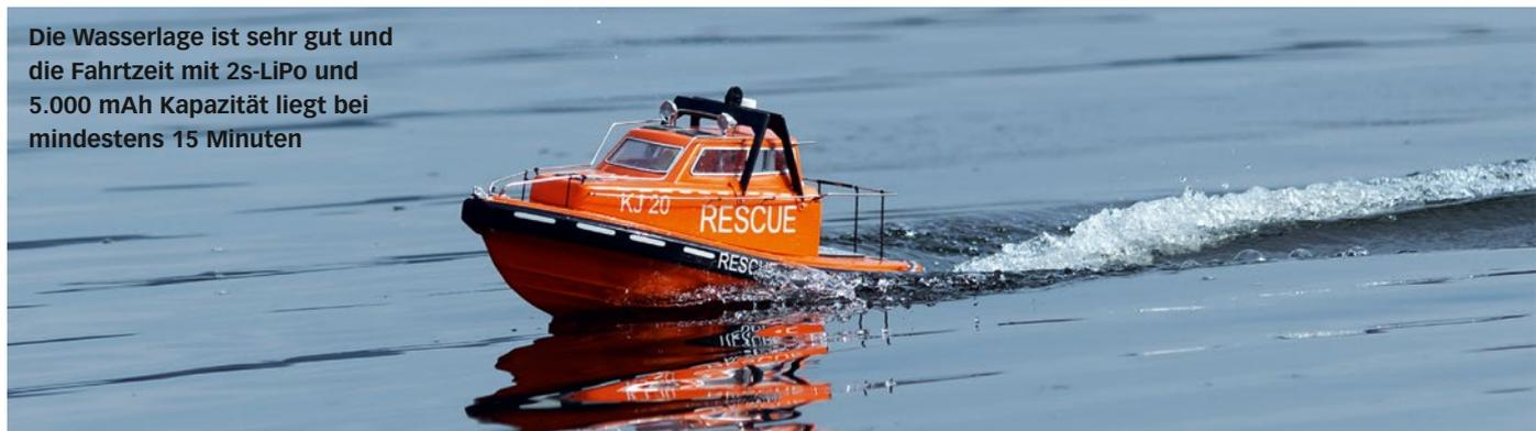
Die Wasserlage ist sehr gut und die Fahrtzeit mit 2s-LiPo und 5.000 mAh Kapazität liegt bei mindestens 15 Minuten
