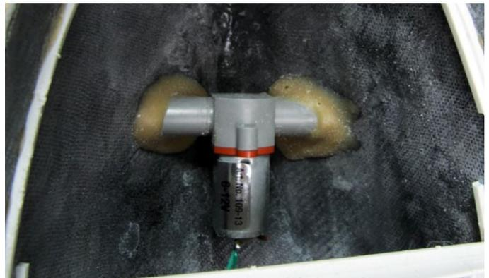
Im Bug ist ein Raboesch-Querstrahler eingesetzt
